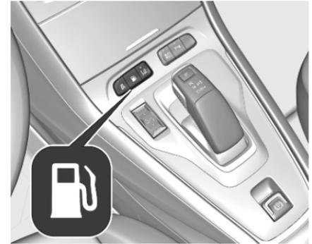
☞ drücken. Nach der Druckabsenkung wird die Tankklappe entriegelt und springt leicht heraus.
