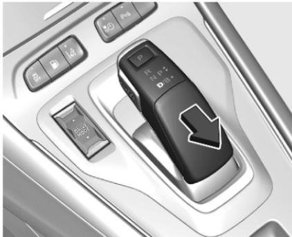
Zum Aktivieren von **B D** auswählen und den Wählhebel nach hinten drücken. Zum Schalten aus der Stellung **B** den Wählhebel erneut nach hinten drücken.
