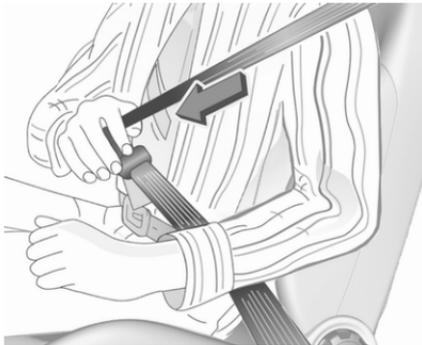
Den Sicherheitsgurt aus dem Aufroller herausziehen, unverdreht über den Körper legen und die Schlos­zunge in das Gurtschloss einführen, bis sie einrastet. Sicherstellen, dass der Gurt während der Fahrt eng am Körper anliegt.
