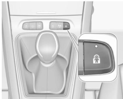
Fernbedientes System, mit dem das Öffnen der hinteren Türen über die Türinnengriffe und die Bedienung der hinteren Fensterheber verhindert werden können.
