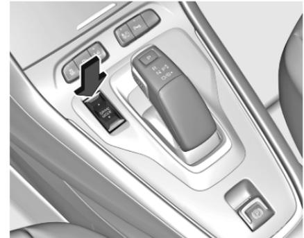
5. Zur Verwendung der reservierten elektrischen Energie in den Elektromodus wechseln.
