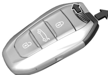
Die Arretierung drücken, um den integrierten Schlüssel zu entnehmen.
