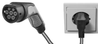
Das Kabel am Ladeanschluss des Fahrzeugs und an der Haushaltssteckdose anschließen.
