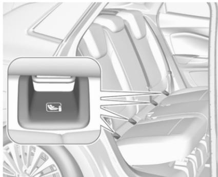
Für das Fahrzeug zugelassene ISOFIX-Kindersicherheitssysteme an den ISOFIX-Befestigungen befestigen. Die speziellen Positionen für ISOFIX-Kindersicherheitssysteme sind in der Tabelle mit ISOFIX gekennzeichnet ↷ 52.
