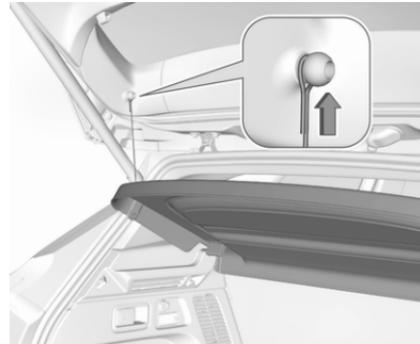
Die Haltegurte an der Heckklappe aushaken.
