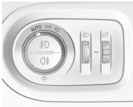
Bei aktivierter automatischer Lichtsteuerung und laufendem Motor schaltet das System abhängig von den äußeren Lichtverhältnissen und den Informationen des Wischersystems zwischen Tagfahrlicht und Scheinwerfern automatisch um.
