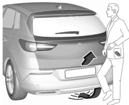
Um die Heckklappe zu öffnen oder zu schließen, den Fuß im mittleren Bereich unter dem hinteren Stoßfänger schnell vor und zurück bewegen. Den Fuß nicht unter dem Stoßfänger halten. Der elektronische Schlüssel muss sich außerhalb des Fahrzeugs in einem Umkreis von ca. 1 m um die Heckklappe befinden. Sobald die Fußbewegung vom Sensor erkannt wird, betätigt das System nach einer kurzen Verzögerung die Heckklappe.
