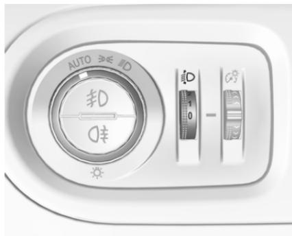
Zur Anpassung der Leuchtweite an die Fahrzeuglast, um die Blendwirkung zu reduzieren, Daumenrädchen  $\text{D}$  in die gewünschte Stellung drehen.
