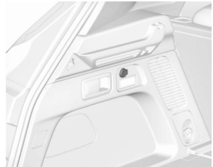
Eine weitere 12-V-Steckdose befindet sich an der linken Seitenwand des Laderaums.
