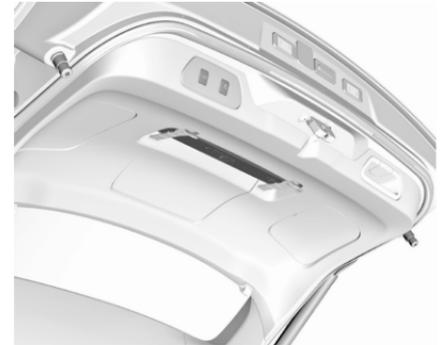
Warndreieck im Fach innen an der Heckklappe verstauen und mit dem Klettband sichern.
