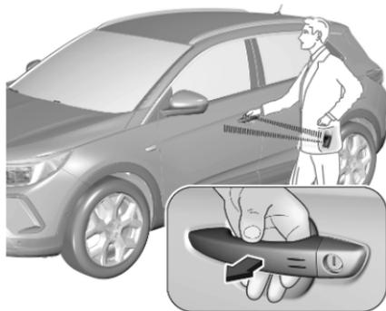
Der elektronische Schlüssel muss sich außerhalb des Fahrzeugs in einem Umkreis von ca. 1 m um die entsprechende Türseite befinden.
