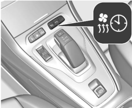
Der Betriebsstatus der Vortemperierung wird durch eine LED angezeigt.
