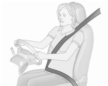
Die Höhe so einstellen, dass der Sicherheitsgurt über die Schulter verläuft. Der Gurt darf nicht über den Hals oder den Oberarm laufen.
