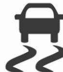
ESC und Traktionskontrolle sind nach jedem Motorstart funktionsfähig, sobald die Kontrollleuchte
