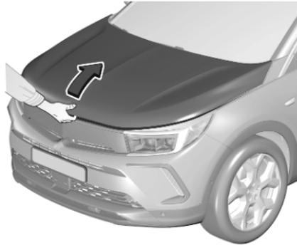
Schnappriegel hochdrücken und Motorhaube öffnen.
