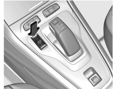
Der Allradmodus wird über den Fahrmodusschalter aktiviert. Die Aktivierung wird im Fahrerinfodisplay und im Info-Display angezeigt.
