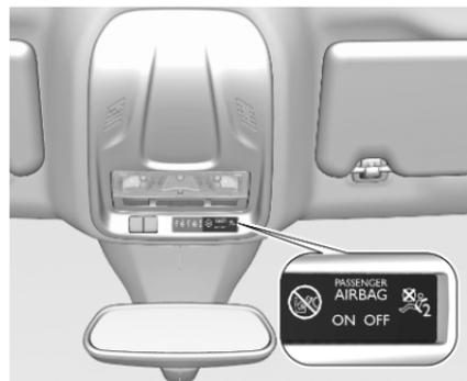
Wenn die Kontrollleuchte
