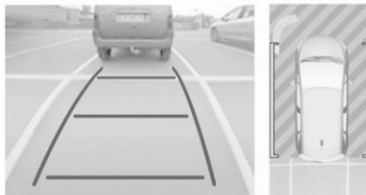
Der Bildschirm im Info-Display ist zweigeteilt. Rechts erscheint ein Bild des Fahrzeugs von oben, links die Ansicht von hinten oder vorn. Die Einparksensoren ergänzen die Informationen zur Ansicht von oben.
