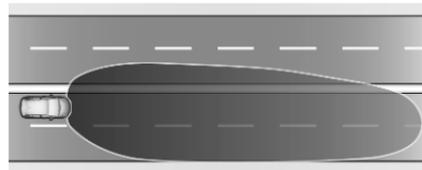
Wird bei einer Geschwindigkeit über 105 km/h automatisch aktiviert. Die Leuchtweite wird an die höhere Autobahngeschwindigkeit angepasst. Ohne Gegenverkehr wird die Sicht auf der Fahrzeugseite erhöht. Bei vorausfahrenden Fahrzeugen bzw. beim Überholen wird der andere Verkehrsteilnehmer weniger geblendet.
