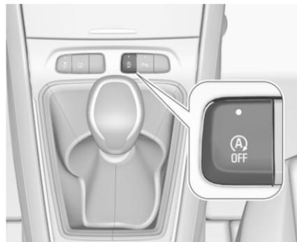
Die Stopp-Start-Automatik lässt sich durch Drücken von
