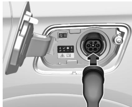
6. Den Fahrzeugstecker des Ladekabels am Ladeanschluss des Fahrzeugs anschließen.
