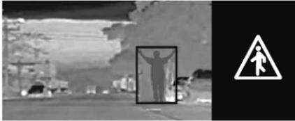
Steht eine Kollision unmittelbar bevor, wird das erkannte Objekt in einem roten Rahmen angezeigt und ein Warnsymbol ausgelöst.
