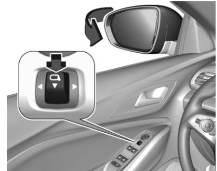
Die Spiegeltaste nach hinten ziehen. Beide Außenspiegel werden eingeklappt.
