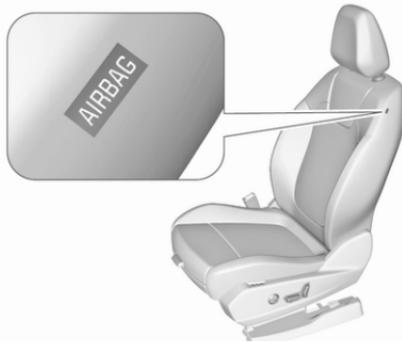
Das Seiten-Airbag-System besteht aus je einem Airbag in der Sitzlehne jedes Vordersitzes. Diese Stellen sind mit dem Wort **AIRBAG** gekennzeichnet.
