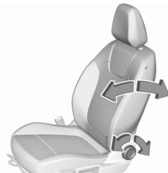
Handrad drehen. Zum Einstellen Rückenlehne entlasten.
