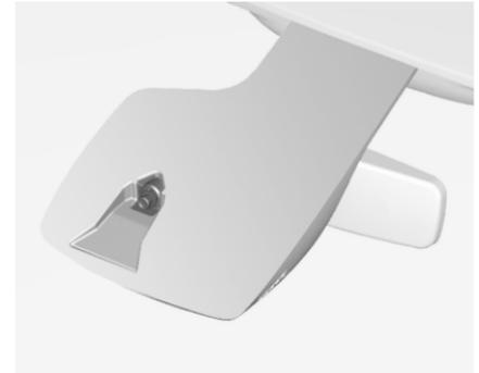
Windschutzscheibenaufkleber wie etwa Autobahnvignetten o.ä. nicht im Bereich des Innenspiegels anbringen. Sensor frei von Staub, Schmutz und Eis halten. Andernfalls könnten die Abtastzone des Regen-/Lichtensors und der Sichtbereich der Kamera im Spiegelgehäuse beeinträchtigt werden.
