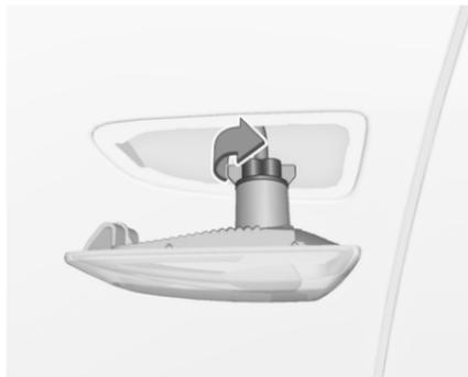
2. Lampenfassung rechtsherum drehen und aus der Leuchteinheit entfernen.
