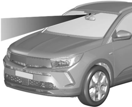
Das aktivierte System beobachtet mithilfe einer Kamera oben an der Windschutzscheibe die Spurmarkierungen. Das System lenkt das Fahrzeug in der erkannten Fahrspur. Der Fahrer spürt dabei, wie sich das Lenkrad dreht.
