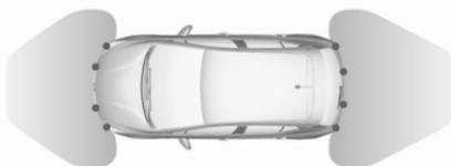
Das System arbeitet mit Ultraschall-Parksensoren im hinteren und vorderen Stoßfänger.
