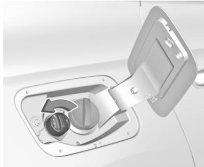
4. Die Schutzkappe vom Einfüllstutzen abschrauben.
