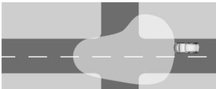
Wird automatisch bei einer Geschwindigkeit bis ca. 50 km/h aktiviert. Der Lichtstrahl ist breit gestreut, um den Gegenverkehr nicht zu blenden.
