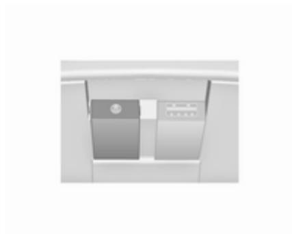
Unter der Abdeckung in der Mittelkonsole befindet sich eine AUX-Buchse zum Anschluss externer Audioquellen.
