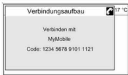
Den angezeigten SAP-Passcode am Mobiltelefon eingeben (ohne Leerzeichen). Im Infotainment-Display wird der PIN-Code des Mobiltelefons angezeigt.
