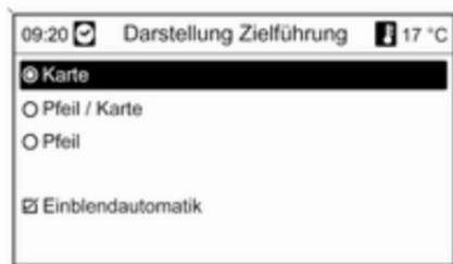
Mit der Option **Einblendautomatik** kann ausgewählt werden, ob Zielführungsinformationen der Navigation in anderen Betriebsarten (z. B. Radio) in Einblendfenstern angezeigt werden sollen. Nach einer bestimmten Zeit oder durch Drücken der Taste **BACK** werden die Informationen ausgeblendet.
