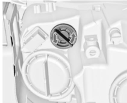
1. Lampenfassung nach links drehen und lösen.
