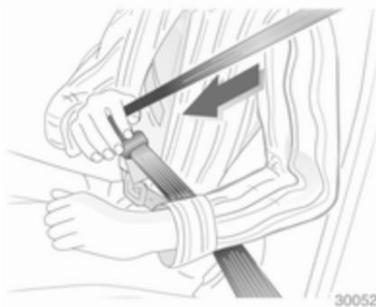
Den Gurt aus dem Aufroller herausziehen, unverdreht über den Körper legen und die Schlosszunge in das Gurtschloss einstecken, bis sie einrastet. Den Beckengurt während der Fahrt durch Ziehen am Schultergurt regelmäßig spannen. Sicherheitsgurt anlegen → 87
