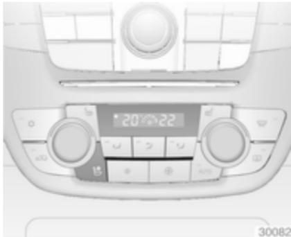
Je nach gewünschter Lüftungsleistung bei eingeschalteter Zündung Taste
