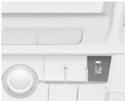
Wenn das System einen unbeabsichtigten Spurwechsel erkennt, schaltet die Kontrollleuchte
