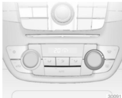
Rechten Drehknopf drehen. Die gewählte Gebläsegeschwindigkeit ist anhand der Anzahl der Segmente auf dem Display erkennbar.
