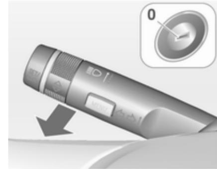
Scheinwerfer, Rückleuchten, Rückfahrlicht und Kennzeichenleuchte beleuchten für eine einstellbare Zeit nach dem Verlassen des Fahrzeugs die Umgebung.
