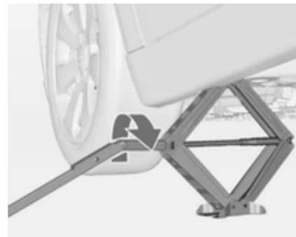
4. Wagenheber auf die erforderliche Höhe einstellen, bevor er direkt unter dem Ansatzpunkt so positioniert wird, dass er nicht wegrutschen kann.
