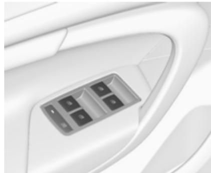
Zur Deaktivierung der elektrischen Fensterbetätigung der Hintertüren Schalter
