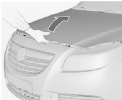
Verschlusshaken nach rechts ziehen und Motorhaube öffnen.
