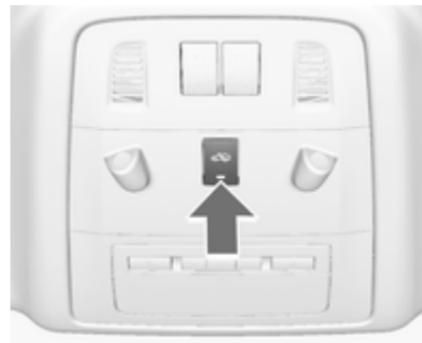
Die Überwachung des Fahrzeuginnenraums und der Fahrzeugneigung ausschalten, wenn Personen oder Tiere im Fahrzeug bleiben, da durch Bewegung verursachte Ultraschallsignale die Alarmanlage auslösen. Auch auf Fahren oder Zügen ausschalten.
