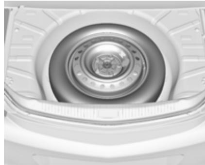
Das Reserverad befindet sich im Laderaum unter der Abdeckung des Laderaumbodens. Es ist mit einer Flügelmutter in der Vertiefung fixiert.
