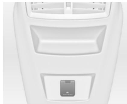
Eine 230-V-Zubehörsteckdose befindet sich in der hinteren Mittelkonsole. Bei eingeschalteter Zündung und einem angesteckten Gerät leuchtet eine LED auf der Steckdose grün.
