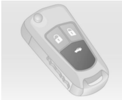
Auf der Funkfernbedienung Taste
