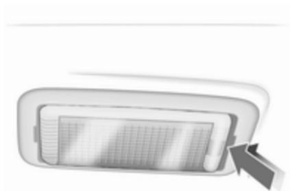
1. Leuchte mit Schraubendreher lösen und herausnehmen.
