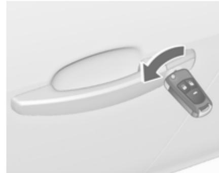
Fahrtür durch Drehen des Schlüssels im Schloss manuell entriegeln. Zündung einschalten und Zentralverriegelungstaste
