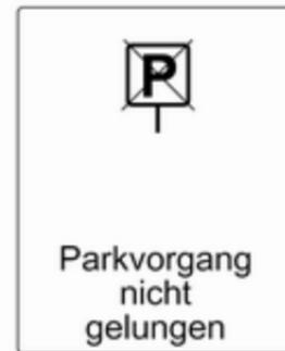
Wenn während der Einpark-Anweisungen ein Gegenstand erkannt wird, erscheint **STOP** im Driver Information Center. Nach Entfernen des Gegenstands wird das Einparkmanöver fortgesetzt. Das System wird deaktiviert, wenn der Gegenstand nicht entfernt
