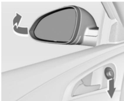
Bedienelement auf **O** drehen und dann hinunterdrücken. Beide Außenspiegel werden eingeklappt.
