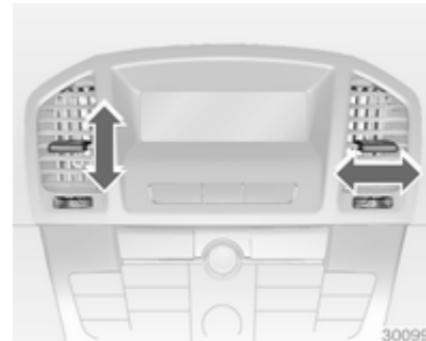
Zum Öffnen der Düse das Einstellrädchen auf **I** drehen und die Luftmenge am Auslass der Düse einstellen.
