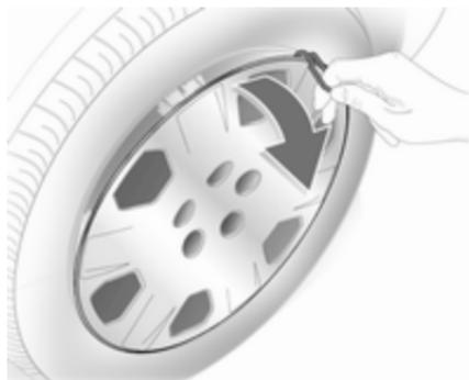
1. Radmutternkappen mit Schraubendreher lösen und abnehmen. Radabdeckung mit dem Haken
