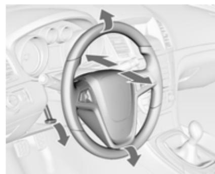
Griff entriegeln, Lenkrad einstellen, Griff einrasten und darauf achten, dass er komplett verriegelt ist. Lenkrad nur bei stehendem Fahrzeug und gelöster Lenk Sperre einstellen. Airbag-System ↻ 51, Zündschlossstellungen ↻ 133.
