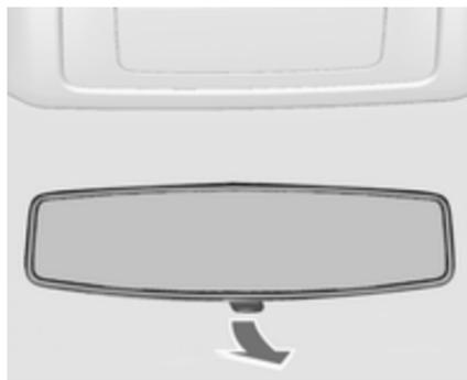
Hebel an der Unterseite verstellen, um die Blendwirkung zu reduzieren. Innenspiegel ↻ 34, Automatisches Abblenden ↻ 34.
