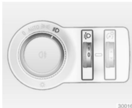
Zur Anpassung der Scheinwerfer-Leuchtweite an die Fahrzeuglast, um Blendwirkung zu reduzieren: Knopf in gewünschte Stellung drehen.
