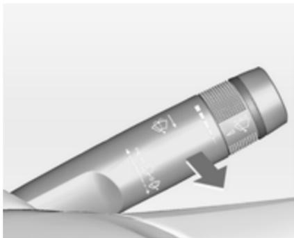
Hebel ziehen. Waschflüssigkeit spritzt auf die Windschutzscheibe und der Wischer wird für einige Wischbewegungen eingeschaltet. Bei eingeschalteten Scheinwerfern spritzt zusätzlich Waschflüssigkeit auf die Scheinwerfer. Anschließend ist die Scheinwerferwaschanlage 2 Minuten außer Betrieb.
