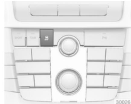
Für extremes Hochleistungsfahren kann die Stabilitätsregelung deaktiviert werden: Taste
