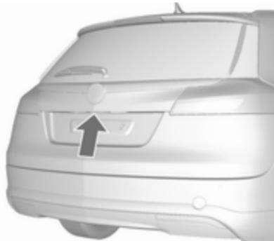
Zum Öffnen der Hecktür den Touchpad-Schalter unter der Hecktürleiste drücken und halten, bis das Öffnen beginnt.
