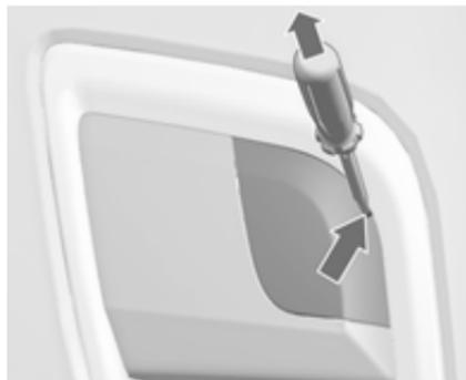
**Insignia OPC:** Einen Schraubendreher in den Schlitz an der oberen Ecke der Abdeckung einführen. Die Abdeckung durch Ziehen des Schraubendrehers abnehmen.
