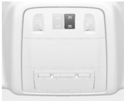
Sonnenrollo durch Drücken der Taste ☀️ oder ☀️ schließen oder öffnen.
