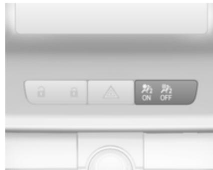
Solange die Kontrollleuchte
