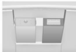
Unter der Abdeckung in der Mittelkonsole befindet sich eine USB-Buchse zum Anschluss externer Audioquellen.
