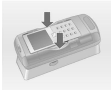
Bei geöffneten Seitenhalterungen das Mobiltelefon senkrecht in den Adapter einsetzen (siehe obige Abbildung), bis die Seitenhalterungen einrasten.
