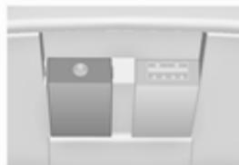
Unter der Abdeckung in der Mittelkonsole befindet sich eine AUX-Buchse zum Anschluss externer Audioquellen.
