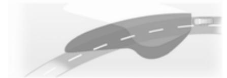
Der Lichtstrahl wird auf Basis des Lenkradwinkels und der Geschwindigkeit geschwenkt, was die Ausleuchtung von Kurven verbessert.
