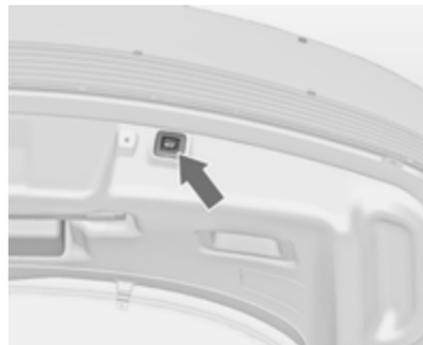
Zum Schließen Taste
