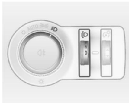
Zur Anpassung der Leuchtweite an die Fahrzeuglast, um Blendwirkung zu reduzieren: Daumenrädchen  $\odot$  in die gewünschte Stellung drehen.
