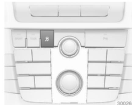
Die Traktionskontrolle kann ausgeschaltet werden, wenn ein Durchdrehen der Antriebsräder erwünscht ist: Taste
