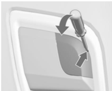
**Insignia OPC:** Einen Schraubendreher in den Schlitz an der oberen Ecke der Abdeckung einführen. Abdeckung durch vorsichtiges Abwärtsbewegen des Schraubendrehers lösen. Um Schäden zu vermeiden, wird empfohlen, ein Tuch zwischen Schraubendreher und Rahmen zu legen.
