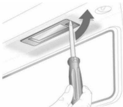
1. Schraubendreher in das Lampengehäuse einstecken, zur Seite drücken und Feder entriegeln.
