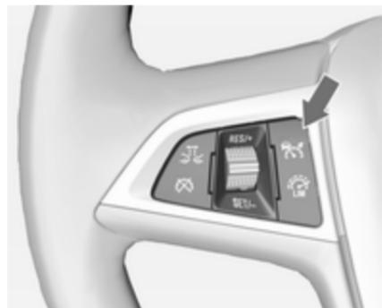
Zum Einschalten des adaptiven Geschwindigkeitsreglers Taste
