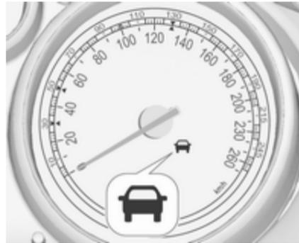
Wenn das System ein vorausfahrendes Fahrzeug in der Fahrspur erkennt, leuchtet die Kontrollanzeige für ein erkanntes vorausfahrendes Fahrzeug
