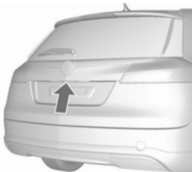
Zum Öffnen der Hecktür den Touchpad-Schalter unter der Hecktürleiste drücken und halten, bis das Öffnen beginnt.
