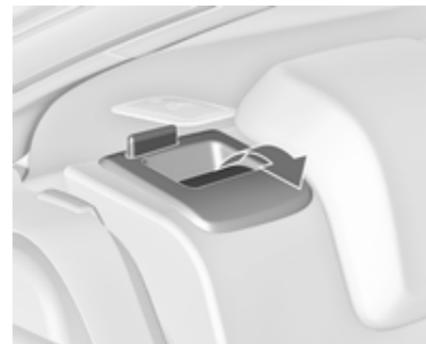
Zum Hochklappen Rückenlehnen anheben und in eine aufrechte Position führen, bis sie hörbar einrasten.
