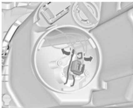
3. Federdrahtbügel nach vorn aus den Haltenasen ausrasten und nach unten schwenken.
