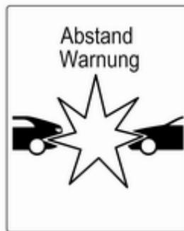
Beim zu schnellen Heranfahren an ein vorausfahrendes Fahrzeug wird die Auffahrwarnungsmeldung im Fahrerinformationszentrum angezeigt. Gleichzeitig ertönt ein Warnton. Betätigen sie das Bremspedal, wenn es die Situation erfordert.
