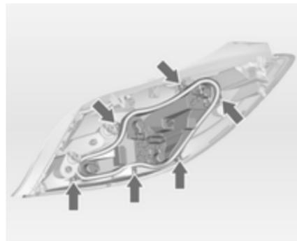
4. Schrauben lösen und Lampenfassung herausnehmen.
