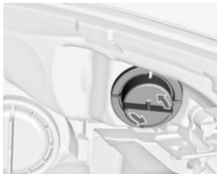
1. Lampenträger nach links drehen und lösen.
