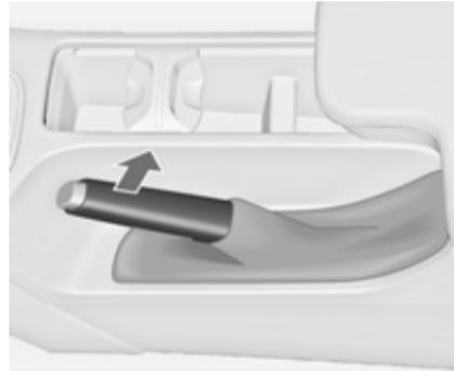
Parkbremse immer ohne Betätigung des Entriegelungsknopfes fest anziehen; bei Gefälle oder Steigung so fest wie möglich.
