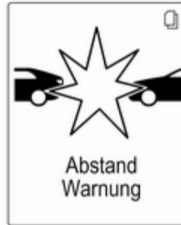
Beim zu schnellen Heranfahren an ein vorausfahrendes Fahrzeug wird die Auffahrwarnungsmeldung im Fahrerinformationszentrum angezeigt. Gleichzeitig ertönt ein Warnton. Betätigen sie das Bremspedal, wenn es die Situation erfordert.
