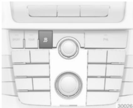
Für extremes Hochleistungsfahren kann die ESC deaktiviert werden: Taste
