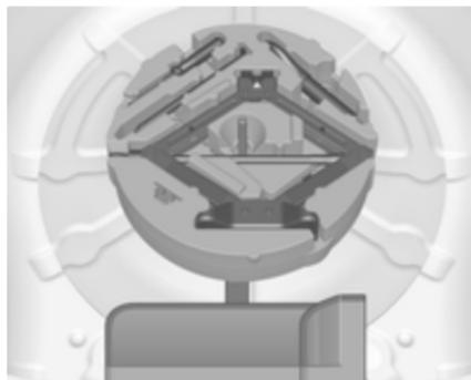
Wagenheber und Wagenwerkzeug befinden sich in einem Staufach im Laderaum unter dem Reserverad. Reserverad ↗ 231.
