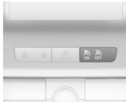
Solange die Kontrollleuchte
