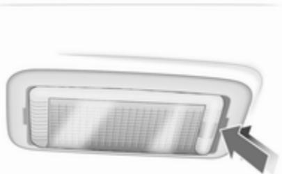
1. Leuchte mit Schraubendreher lösen und herausnehmen.
