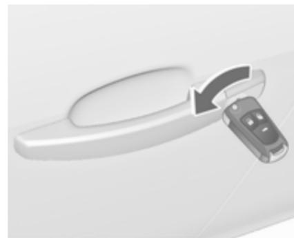
Fahrtür durch Drehen des Schlüssels im Schloss manuell entriegeln. Zündung einschalten und Zentralverriegelungstaste
