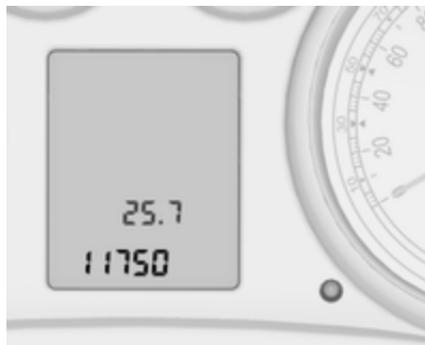
Das Fahrerinformationszentrum (FIZ) befindet sich im Kombiinstrument zwischen dem Tachometer und dem Drehzahlmesser. Es steht als Middlevel-Display, Uplevel-Display oder Uplevel-Kombi-Display zur Verfügung.
