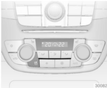
Je nach gewünschter Lüftungsleistung bei eingeschalteter Zündung Taste
