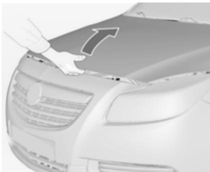
Verschlusshaken nach rechts ziehen und Motorhaube öffnen.
