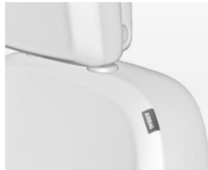
Das Seiten-Airbag-System besteht aus einem Airbag in der Rückenlehne jedes Vordersitzes und in den Rückenlehnen der äußeren Rücksitze. Diese Stellen sind mit dem Wort **AIRBAG** gekennzeichnet.
