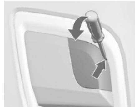
**Insignia OPC:** Einen Schraubendreher in den Schlitz an der oberen Ecke der Abdeckung einführen. Abdeckung durch vorsichtiges Abwärtsbewegen des Schraubendrehers lösen. Um Schäden zu vermeiden, wird empfohlen, ein Tuch zwischen Schraubendreher und Rahmen zu legen.
