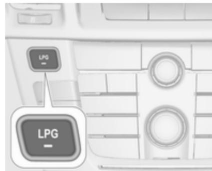
Durch Drücken der Taste **LPG** kann zwischen Benzin- und Flüssiggasbetrieb umgeschaltet werden. Die LED-Leuchte
