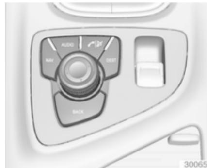
Eine Funktion mit den Tasten der Multifunktionseinheit auswählen. Das Menü der gewählten Funktion wird angezeigt.
