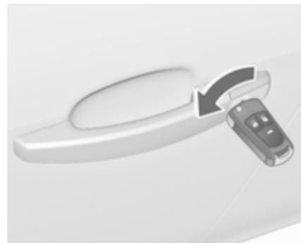
Fahrtür durch Drehen des Schlüssels im Schloss manuell entriegeln. Zündung einschalten und Zentralverriegelungstaste
