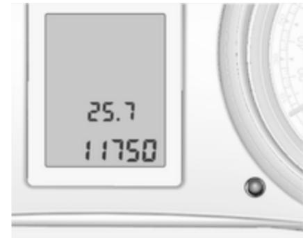
In der unteren Zeile wird die zurückgelegte Strecke in Kilometer angezeigt.
