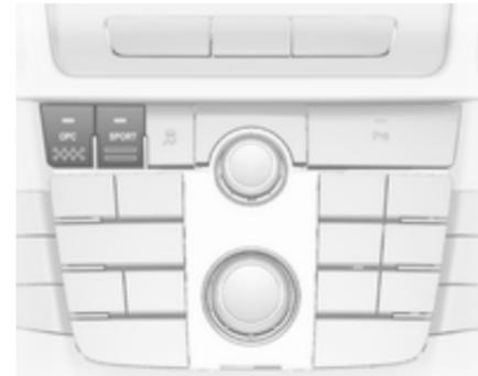
Das Fahrsystem OPC Flex Ride ermöglicht es dem Fahrer, zwischen drei Fahrmodi zu wählen:
