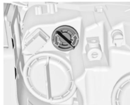
1. Lampenträger nach links drehen und lösen.
