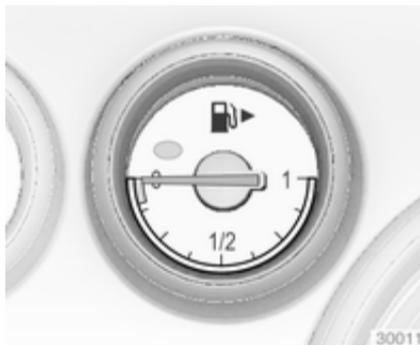
Anzeige von Kraftstofffüllstand bzw. Gasfüllstand im Tank je nach Betriebsart.
