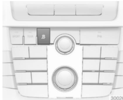
Für extremes Hochleistungsfahren kann die ESC deaktiviert werden: Taste
