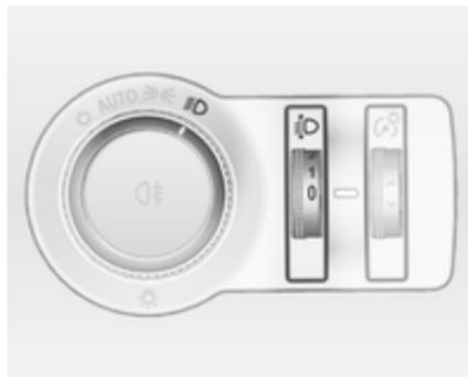
Zur Anpassung der Leuchtweite an die Fahrzeuglast, um Blendwirkung zu reduzieren: Daumenrädchen
