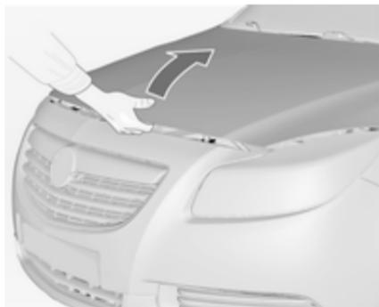
Verschlusshaken nach rechts ziehen und Motorhaube öffnen.
