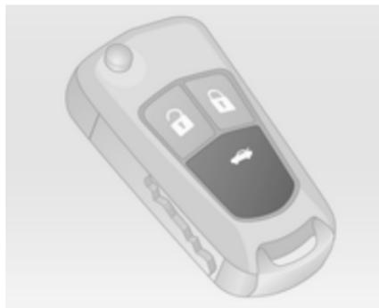
Bei ausgeschalteter Zündung Taste
