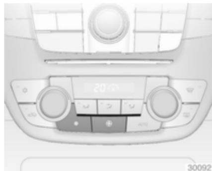
Linke Taste ⌘ zum Herabsetzen der Gebläsegeschwindigkeit drücken, oder Taste ⌘ zum Erhöhen der Gebläsegeschwindigkeit drücken. Die Gebläsegeschwindigkeit ist anhand der Anzahl der Segmente auf dem Display erkennbar.
