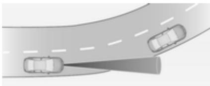
Ausgehend von der Zentrifugalkraft berechnet der adaptive Geschwindigkeitsregler einen voraussichtlichen Weg. Der berechnete Weg berücksichtigt die aktuellen Kurveneigenschaften, kann jedoch keine späteren Änderungen der Kurvenspur vorhersehen. Das System kann daher ein vorausfahrendes Fahrzeug aus dem Erkennungsbereich verlieren oder ein Fahrzeug erkennen das sich nicht auf der verwendeten Fahrspur befindet. Dies kann beim Einfahren in eine
