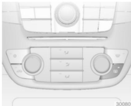
Die Heizung wird durch Drücken der Taste
