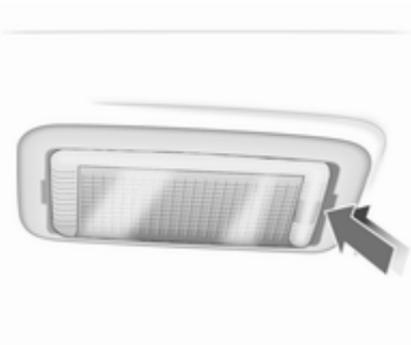
1. Leuchte mit Schraubendreher lösen und herausnehmen.
