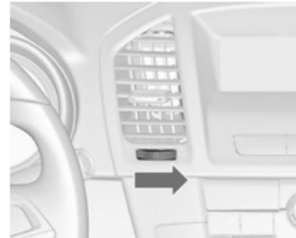
Zum Öffnen der Düse Einstellrädchen auf
