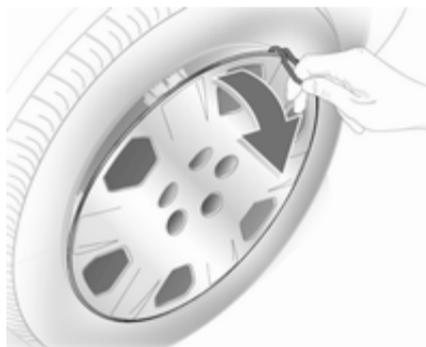
1. Radmutternkappen mit Schraubendreher lösen und abnehmen. Radabdeckung mit dem Haken abziehen. Wagenwerkzeug ↗ 226.
