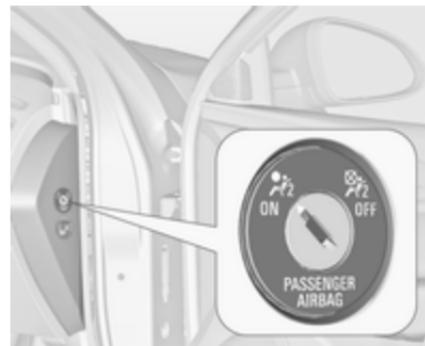
Das Beifahrer-Airbag-System kann mit dem Schlüssel über einen Schalter an der rechten Seite der Instrumententafel deaktiviert werden.
