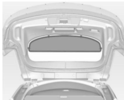
Um den Laderaum komplett abzudecken, die Blende an vier Befestigungspunkten an der Innenseite der Hecktür anbringen.
