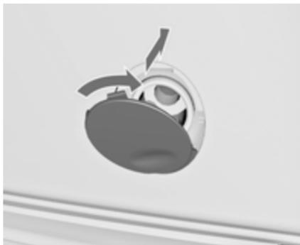
Abdeckung am Boden einsetzen, im Uhrzeigersinn leicht drehen und schließen.
