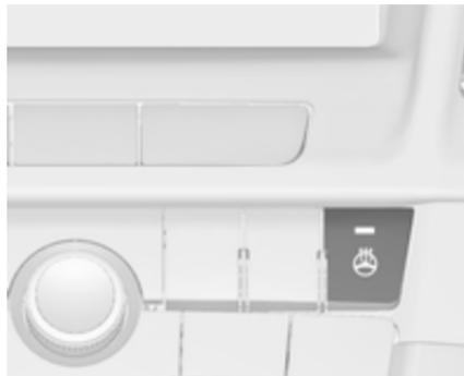
Die Heizung durch Drücken der Taste
