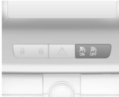
Solange die Kontrollleuchte
