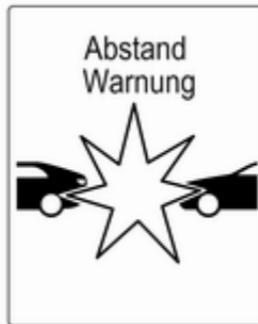
Beim zu schnellen Heranfahen an ein vorausfahrendes Fahrzeug wird die Auffahrwarnungsmeldung im Driver Information Center angezeigt. Gleichzeitig ertönt ein Warnton. Betätigen sie das Bremspedal, wenn es die Situation erfordert.
