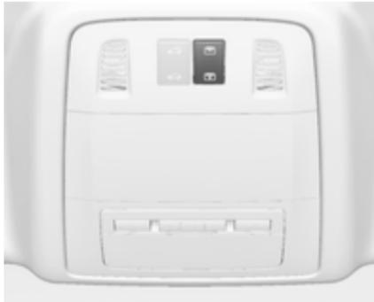
Sonnenrollo durch Drücken des Schalters ☒ oder ☑ schließen oder öffnen.
