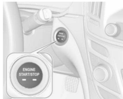
An-/Aus-Schalter: Taste **Engine Start/Stop** kurz drücken
