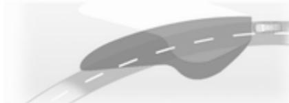
Der Lichtstrahl wird auf Basis des Lenkwinkels und der Geschwindigkeit geschwenkt, was die Ausleuchtung von Kurven verbessert.
