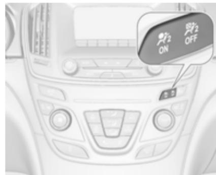
Solange die Kontrollleuchte
