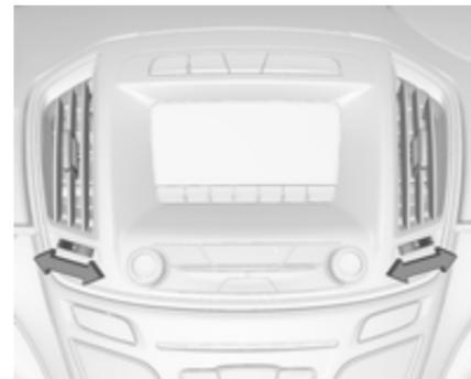
Zum Öffnen der Düse Einstellrädchen auf
