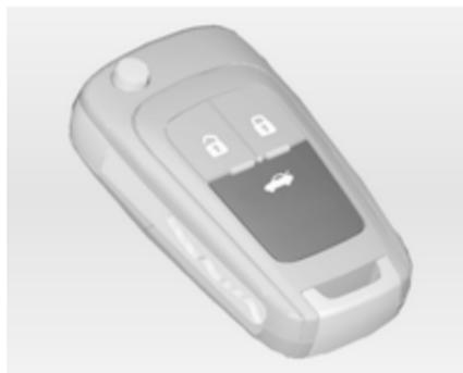
Bei ausgeschalteter Zündung Taste
