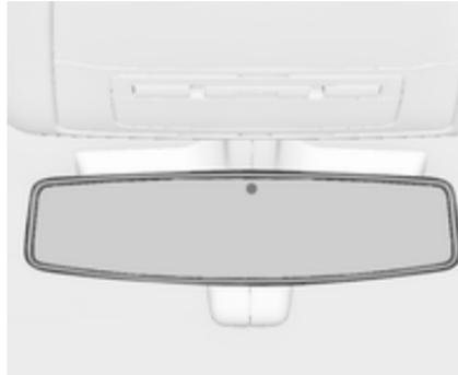
Eine Blendung durch nachfolgende Fahrzeuge bei Nacht wird durch das Abblenden des Innenspiegels verringert.
