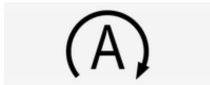
Bei einem Autostop bleiben Heizleistung und Bremskraft erhalten.
