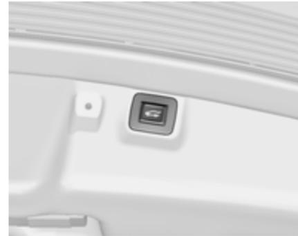
4. Die Taste auf der Innenseite der geöffneten Heckklappe drücken und 3 Sekunden lang halten.
