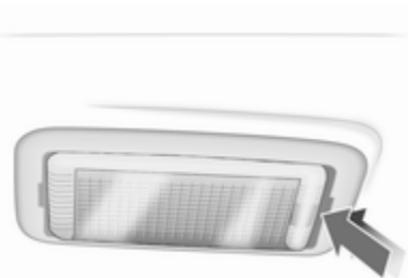
1. Leuchte mit Schraubendreher lösen und herausnehmen.
