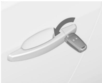
Fahrtür durch Drehen des Schlüssels im Schloss manuell entriegeln. Zündung einschalten und Zentralverriegelungstaste
