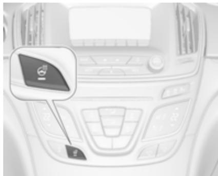
Die Heizung durch Drücken der Taste
