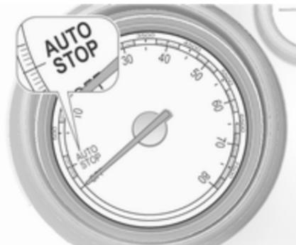
Ein Autostop wird auf dem Drehzahlmesser angezeigt, indem die Nadel auf der Position **AUTOSTOP** steht. Bei bestimmten Versionen leuchtet bei einem Autostopp des Motors eine Kontrollleuchte im Instrument auf.
