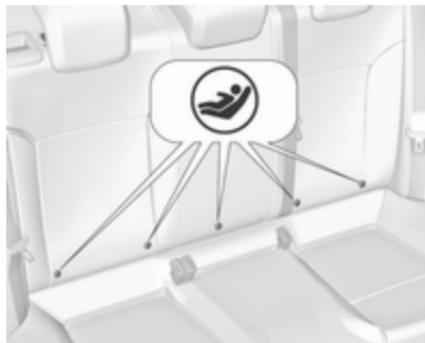
Für das Fahrzeug zugelassene ISOFIX Kindersicherheitssysteme an ISOFIX Befestigungsbügel befestigen. Die speziellen Positionen für ISOFIX Kindersicherheitssysteme sind in der Tabelle mit IL gekennzeichnet ↗ 67.
