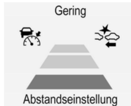
Beachten Sie, dass die Einstellung der Warnempfindlichkeit mit der Abstandswarnung des adaptiven Geschwindigkeitsreglers zusammenhängt ⇨ 186. Durch Ändern der Warnempfindlichkeit wird auch die Einstellung der Abstandswarnung des adaptiven Geschwindigkeitsreglers geändert.
