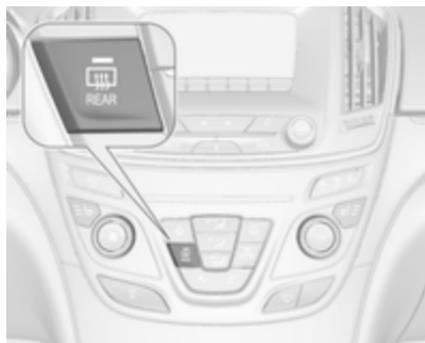
Wird durch Drücken der Taste
