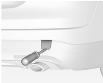
**Country Tourer:** Mit einem Schraubendreher in den Schlitz unten an der Abdeckung fahren. Abdeckung durch vorsichtiges Abwärtsbewegen des Schraubendrehers lösen. Um Schäden zu vermeiden, wird empfohlen, ein Tuch zwischen Schraubendreher und Rahmen zu legen.
