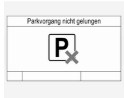
Wenn während der Einpark-Anweisungen ein Gegenstand erkannt wird, erscheint **Stop** im Driver Information Center. Nach Entfernen des Gegenstands wird das Einparkmanöver fortgesetzt. Das System wird deaktiviert, wenn der Gegenstand nicht entfernt
