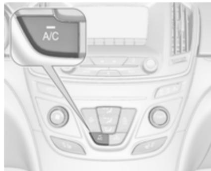
Taste **A/C** drücken, um die Kühlung einzuschalten. Die Betätigung wird durch die LED auf der Taste angezeigt. Die Kühlung ist nur bei laufendem Motor und eingeschaltetem Klimatisierungsgebläse funktionsfähig.
