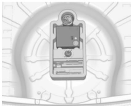
Das Reifenreparaturset befindet sich in einem Staufach unter der Abdeckung des Laderaumbodens.
