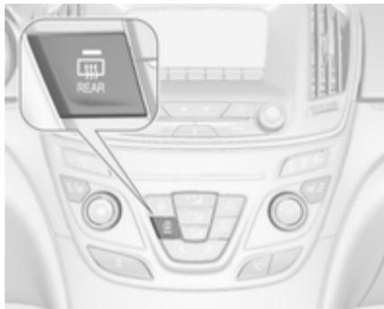
Wird durch Drücken der Taste
