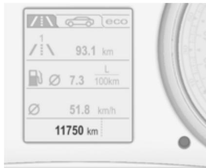
Die erfasste Gesamtfahrstrecke wird in km angezeigt.
