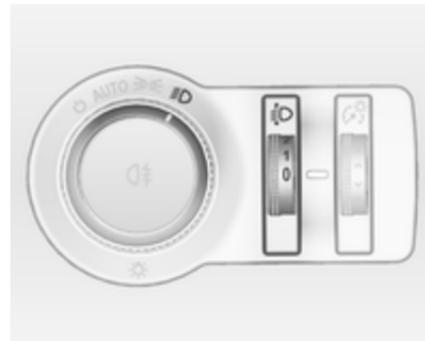
Zur Anpassung der Leuchtweite an die Fahrzeuglast, um Blendwirkung zu reduzieren: Daumenrädchen  $\equiv \text{D}$  in die gewünschte Stellung drehen.
