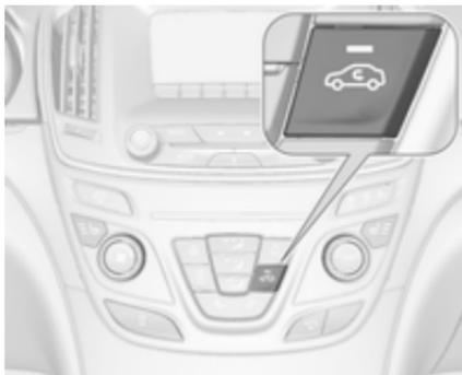
Zum Einschalten des Umluftbetriebs Taste
