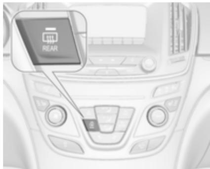
Die Heizung wird durch Drücken der Taste
