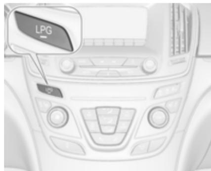
Durch Drücken der Taste **LPG** kann zwischen Benzin- und Flüssiggasbetrieb umgeschaltet werden. Die LED-Statusleuchte **■** zeigt den aktuellen Betriebsmodus.
