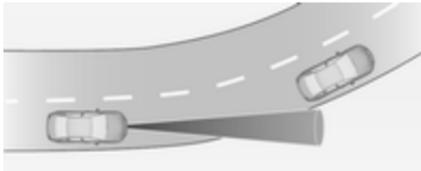
Ausgehend von der Zentrifugalkraft berechnet der adaptive Geschwindigkeitsregler einen voraussichtlichen Weg. Der berechnete Weg berücksichtigt die aktuellen Kurveneigenschaften, kann jedoch keine späteren Änderungen der Kurvenspur vorhersehen. Das System kann daher ein vorausfahrendes Fahrzeug aus dem Erkennungsbereich verlieren oder ein
