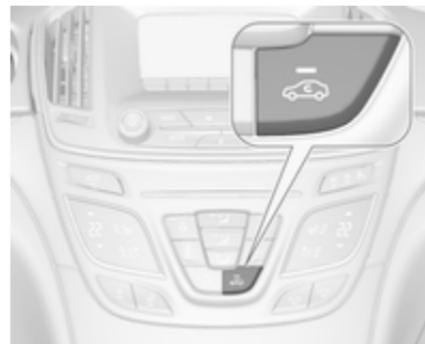
Zum Einschalten des Umluftbetriebs Taste
