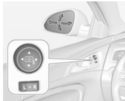
Gewünschten Außenspiegel durch Schalten des Bedienelements zum linken (L) bzw. rechten Spiegel (R)
