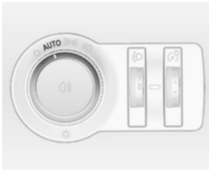
Bei aktiviertem automatischen Fahrlicht und laufendem Motor schaltet das System abhängig von den Lichtverhältnissen und den Informationen des Regensensors automatisch zwischen Tagfahrlicht und Abblend-/Fernlicht um.
