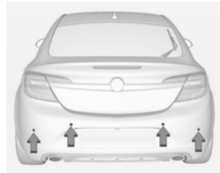
Die Front-Heck-Einparkhilfe misst die Entfernung zwischen dem Fahrzeug und Hindernissen vor und hinter dem Fahrzeug. Das System gibt akustische Signale aus und zeigt Meldungen auf dem Display an.
