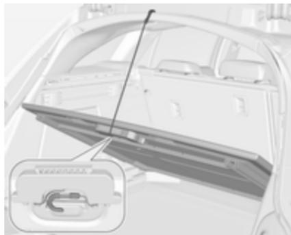
Um Zugang zum Reserverad bzw. Reifenreparaturset zu erhalten, Laderaumboden anheben und Halteriemmen an der Oberkante der Heckklappe in der Vertiefung einhängen. Laderaumboden nur unbeladen anheben und oben fixieren.
