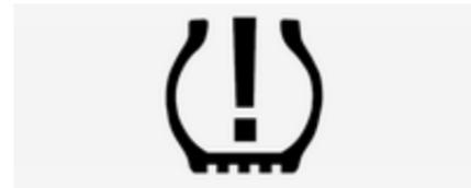
Wenn niedriger Reifendruck erkannt wird, wird dies durch die Kontrollleuchte (⚠) gemeldet ⇨ 111.
