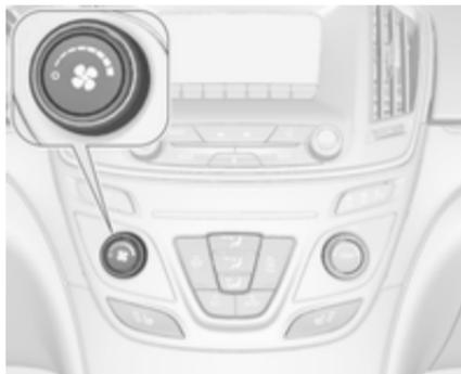
Luftstrom durch Drehen des Reglers
