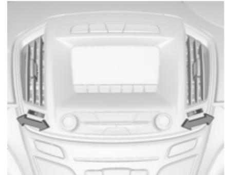
Zum Öffnen der Düse Einstellrädchen auf I drehen. Die Einstellung der Luftmenge am Düsenausgang erfolgt durch Drehen des Einstellrädchen.
