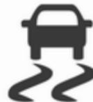
Wenn das ESC eingreift, blinkt die Kontrollleuchte
