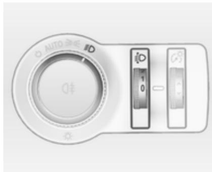
Zur Anpassung der Leuchtweite an die Fahrzeuglast, um Blendwirkung zu reduzieren: Daumenrädchen
