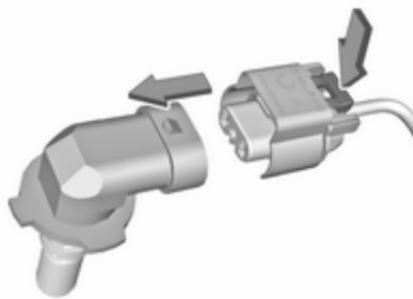
2. Die Lampenfassung durch Drücken der Haltnase vom Stecker lösen.
