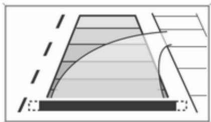
Die Fahrzeugsur wird entsprechend des Lenkwinkels angezeigt.
