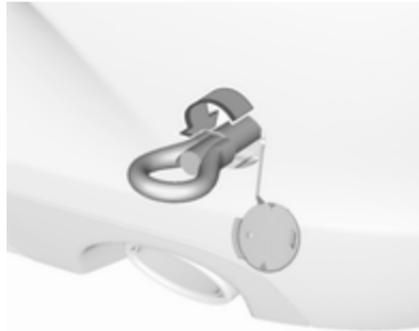
Abschleppöse bis zum Anschlag in waagrechtter Stellung einschrauben.
