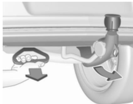
Den Griff unter der hinteren Stoßfängerverkleidung links neben dem Nummernschild in einem Winkel von ca. 45° Richtung Boden ziehen.
