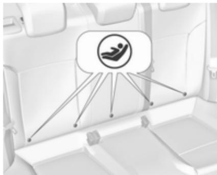
Für das Fahrzeug zugelassene ISOFIX Kindersicherheits-systeme an ISOFIX Befestigungsbügeln befestigen. Die speziellen Positionen für ISOFIX Kindersicherheits-systeme sind in der Tabelle mit IL gekennzeichnet ↗ 68.
