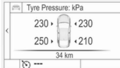
Systemstatus und Druckwarnungen werden mittels einer Meldung zum betreffenden Reifen im Driver Information Center angezeigt.
