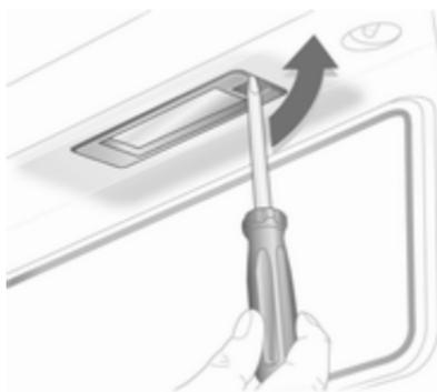
1. Schraubendreher in das Lampengehäuse einstecken, zur Seite drücken und Feder entriegeln.
