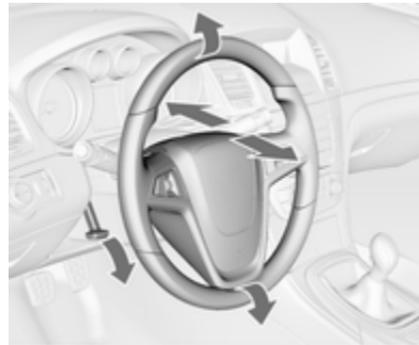
Griff entriegeln, Lenkrad einstellen, Griff einrasten und darauf achten, dass er komplett verriegelt ist. Lenkrad nur bei stehendem Fahrzeug und gelöster Lenkradsperre einstellen.
