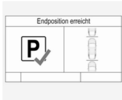
Ein erfolgreiches Einparkmanöver wird durch eine Endpositionsmeldung angezeigt.
