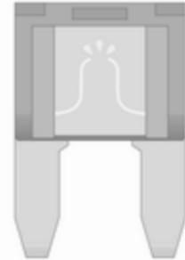
Je nach Ausführung lässt sich eine durchgebrannte Sicherung anhand des geschmolzenen Drahtes erkennen. Sicherung nur dann ersetzen, wenn die Ursache für die Störung behoben wurde.
