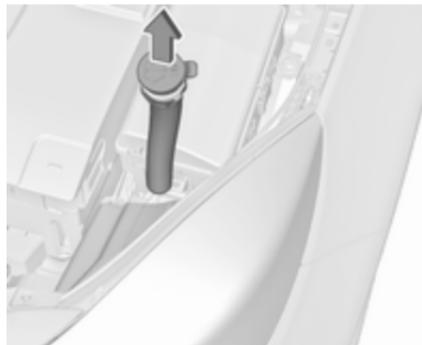
Einfüllrohr an der linken Fahrzeugseite aus dem Waschflüssigkeitsbehälter ziehen.
