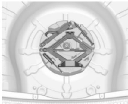
Der Wagenheber inkl. Radschlüssel, das Wagenwerkzeug, der Verlängerungsbolzen zur Befestigung des schadhaften Rades und die Abschleppöse befinden sich im Werkzeugkasten, welcher unterhalb des Reserverads im Laderaum verstaut ist. Reserverad ↗ 282.
