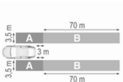
Die Sensoren des Systems decken einen parallelen Bereich von ca. 3,5 m an beiden Fahrzeugseiten und bei der Toter-Winkel-Warnung (A) ca. 3 m nach hinten, beim Spurwechselassistenten (B) ca. 70 m nach hinten in parallelen Fahrspuren ab. Die Zonen beginnen am jeweiligen Außenspiegel. Höhenmäßig wird ein Bereich zwischen etwa 0,5 m und 2 m über dem Boden abgedeckt.
