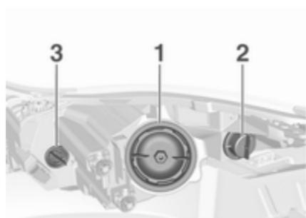
**Bi-Halogen-Scheinwerfer (1)** mit einer Lampe für Abblend- und Fernlicht
