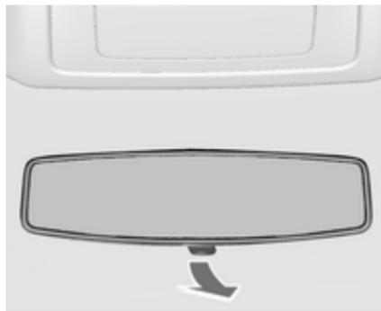
Hebel an der Unterseite verstellen, um die Blendwirkung zu reduzieren.
