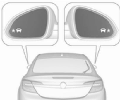
Das System kann in der Fahrzeugpersonalisierung ein- und ausgeschaltet werden.
