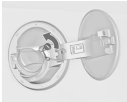
Die Schutzkappe vom Einfüllstutzen abschrauben.
