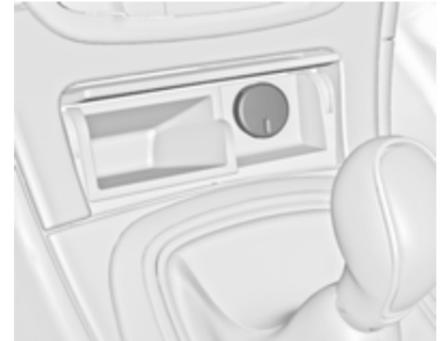
Unterhalb der Bedienelemente der Klimatisierung befindet sich hinter der Staufachabdeckung eine 12-Volt-Zubehörsteckdose. Zum Öffnen auf die Abdeckung drücken.
