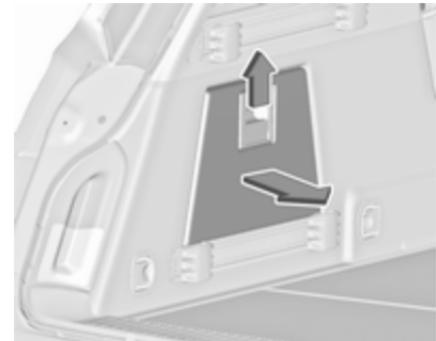
2. Abdeckung in Seitenverkleidung lösen und herausnehmen.
