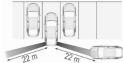
Die Sensoren des Systems decken einen Bereich von ca. 20 m seitlich links oder rechts hinter dem Fahrzeug ab.
