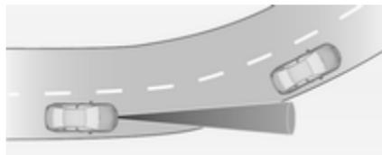
Ausgehend von der Zentrifugalkraft berechnet der adaptive Geschwindigkeitsregler einen voraussichtlichen
