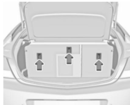
Zusätzlich zur ISOFIX-Befestigung den Top-Tether-Befestigungsgurt an den Top-Tether-Befestigungsösen verankern. Der Gurt muss zwischen den beiden Führungsstangen der Kopfstütze verlaufen.
