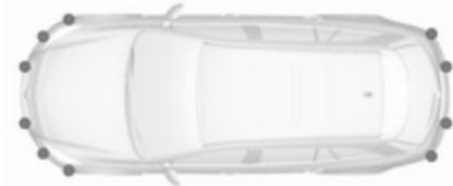
Die erweiterte Einparkhilfe leitet den Fahrer durch Anweisungen im Driver Information Center und akustische Signale in eine Parklücke. Der Fahrer muss selbst beschleunigen, bremsen, lenken und schalten.
