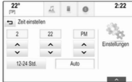
Bildschirmtaste **Auto** unten im Display wählen. Entweder den Modus **Ein - RDS** oder den Modus **Aus - Manuell** aktivieren.
