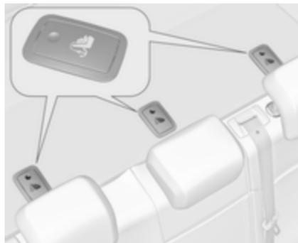
Die durch das Kindersitzsymbol gekennzeichnete Klappe der benötigten Befestigungsöse öffnen.
