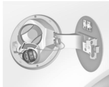
4. Die Schutzkappe vom Einfüllstutzen abschrauben.
