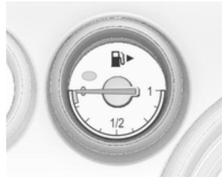
Zeigt je nach Betriebsmodus den Füllstand des Kraftstofftanks oder des Gastanks an.
