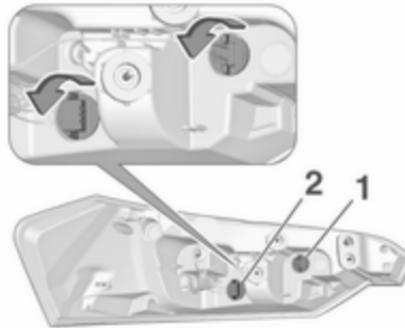
4. Die Lampenfassung nach links drehen und herausnehmen. Folgende Glühlampen ggf. herausziehen und auswechseln:
