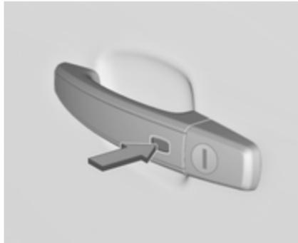
Elektronisches Schlüsselsystem: Das Entriegeln des Fahrzeugs durch Drücken der Taste an einem beliebigen Außentürgriff deaktiviert die Diebstahlwarnanlage.
