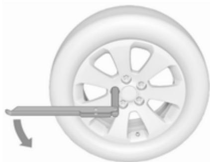
2. Radschraubenschlüssel herausklappen und sicherstellen, dass er gut sitzt. Jede Radmutter um eine halbe Drehung lösen.
