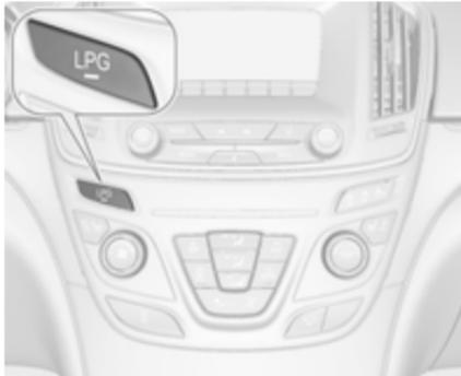
Auf **LPG** drücken, um zwischen Benzin- und Flüssiggasbetrieb umzuschalten, sobald die erforderlichen Parameter (Kühlmitteltemperatur, Gastemperatur und Mindestdrehzahl des Motors) erreicht sind. Die Anforderungen sind normalerweise nach etwa 60 Sekunden (je nach Außentemperatur) und der ersten festen Betätigung des Gaspedals erreicht. Der LED-Status zeigt den aktuellen Betriebsmodus.
