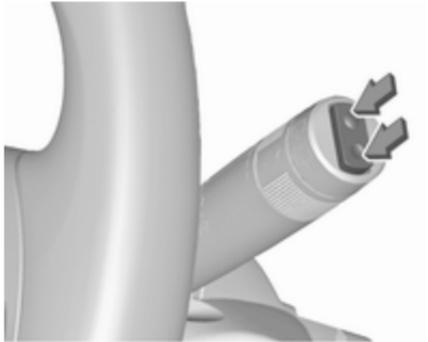
Zur Betätigung des Heckscheibenwischers Wippschalter drücken:
