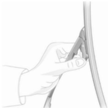
Wischerarm anheben. Beide Riegel am Wischerarm drücken, Wischerblatt ausrasten und abziehen.
