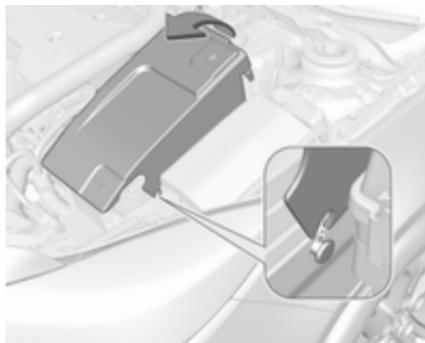
Die Fahrzeugbatterie befindet sich unter einer Abdeckung. Zum Batteriewechsel die Abdeckung entfernen. Abdeckung hinten anheben und vorne lösen.
