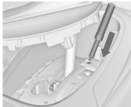
3. Spezialwerkzeug so weit wie möglich in die Öffnung einführen und den Wählhebel aus der Stellung **P** bzw. **N** bewegen. Wenn **P** bzw. **N** wieder eingelegt wird, wird der Wählhebel wieder in dieser Stellung gesperrt. Ursache für die Stromunterbrechung von einer Werkstatt beheben lassen.
