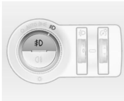
Wird durch Drücken von  $\#D$  bedient. Lichtschalter in Stellung **AUTO**: Beim Einschalten der Nebelscheinwerfer werden die Scheinwerfer automatisch eingeschaltet.
