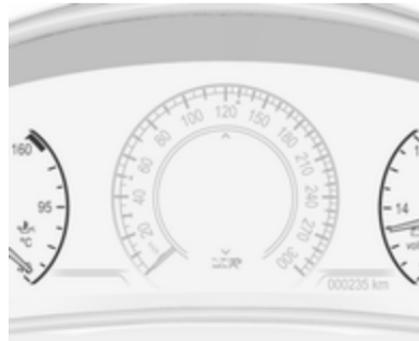
Abhängig von den Einstellungen des Uplevel-Displays werden die Instrumente für „Öltemperatur“, „Öldruck“ und „Batteriespannung“ auch links und rechts neben dem Tachometer angezeigt.
