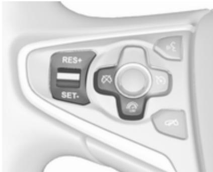
☞ drücken. Die Kontrollleuchte ☞ im Instrument leuchtet weiß. Wenn zuvor der Geschwindigkeitsregler oder der adaptive Geschwindigkeitsregler aktiviert wurde, wird dieser beim Aktivieren des Geschwindigkeitsbegrenzers ausgeschaltet. Die Kontrollleuchte ☞ erlischt.
