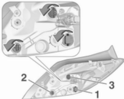
4. Die Lampenfassung nach links drehen und herausnehmen. Glühlampen herausziehen oder -drehen und wechseln:
