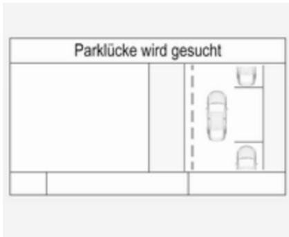
Wenn das Fahrzeug bei aktiviertem System an einer Reihe geparkter Autos vorbeifährt, beginnt die erweiterte Einparkhilfe nach einer geeigneten Parklücke zu suchen. Wird eine geeignete Parklücke entdeckt, erfolgen eine optische Rückmeldung und ein akustisches Signal im Driver Information Center.
