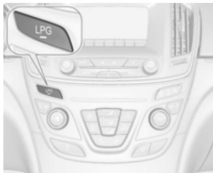
Durch Drücken von **LPG** kann zwischen Benzin- und Flüssiggasbetrieb umgeschaltet werden. Die LED-Statusleuchte
