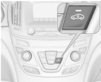
Zum Einschalten des Umluftbetriebs
