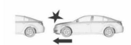
Wenn der Abstand zu einem vorausfahrenden Fahrzeug zu gering wird oder Sie sich einem anderen Fahrzeug zu schnell nähern, wird im Driver Information Center das Kollisionswarnsymbol angezeigt.
