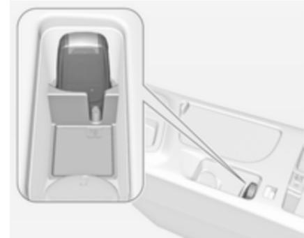
Ablagefach in der Mittelkonsole durch Anheben der Armlehne öffnen. Elektronischen Schlüssel in die Transmitterausparung einstecken.
