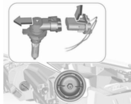
3. Die Lampenfassung durch leichtes Aufbiegen der Haltenase vom Stecker lösen.
