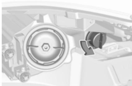
1. Kappe nach links drehen und aus dem Reflektor ziehen.
