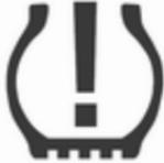
Wenn niedriger Reifendruck erkannt wird, wird dies durch die Kontrollleuchte (⚠) gemeldet ⇨ 113.
