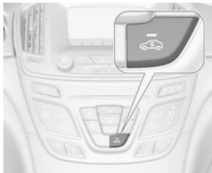
Zum Einschalten des Umluftbetriebs 🚗 drücken. Die Betätigung wird durch die LED auf der Taste angezeigt.
