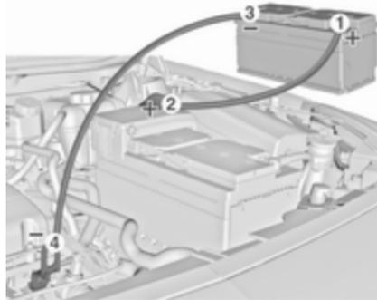
Reihenfolge für das Anschließen der Kabel:
