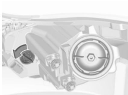
1. Lampenfassung durch Drehen nach links lösen. Lampenfassung aus dem Gehäuse ziehen.
