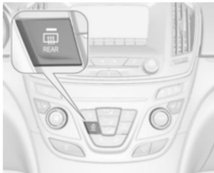
Wird durch Drücken von
