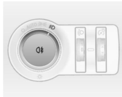
Wird durch Drücken von  $D\#$  bedient. Lichtschalter in Stellung **AUTO**: Beim Einschalten der Nebelschlussleuchte werden die Scheinwerfer automatisch eingeschaltet.
