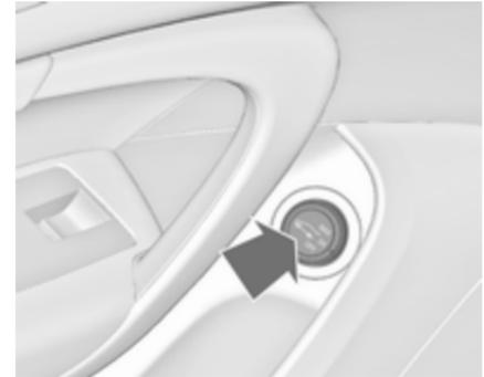
So lange auf
