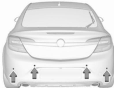
Die Front-Heck-Einparkhilfe misst die Entfernung zwischen dem Fahrzeug und Hindernissen vor und hinter dem
