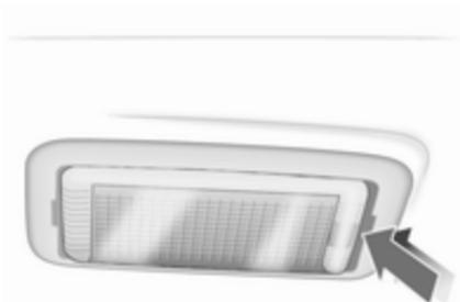
1. Leuchte mit Schraubendreher lösen und herausnehmen.
