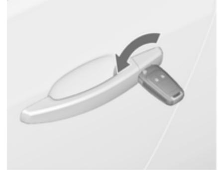
Fahrtür durch Drehen des Schlüssels im Schloss manuell entriegeln. Zündung einschalten und Zentralverriegelungstaste
