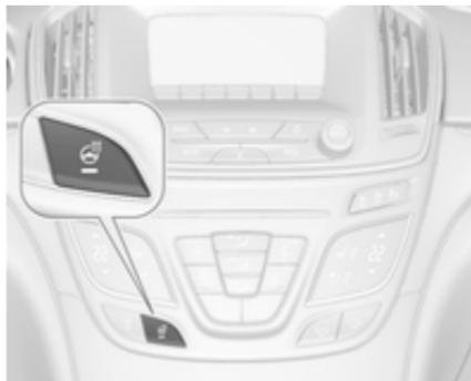
Die Heizung durch Drücken von
