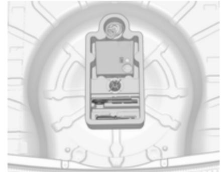
Das Wagenwerkzeug und die Abschleppöse befinden sich zusammen mit dem Reifenreparaturset in einem Werkzeugkasten unter der Abdeckung des Laderaumbodens.
