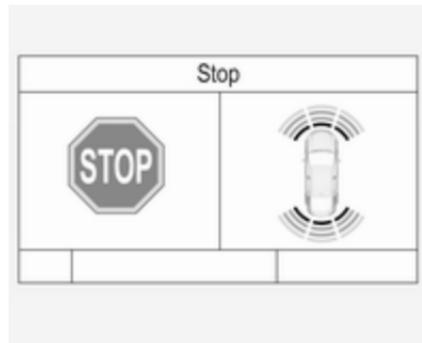
Die vom System vorgeschlagene Parklücke wird angenommen, wenn der Fahrer das Fahrzeug spätestens 10 Meter nach Anzeige der Stoppschildmeldung anhält. Das System berechnet die optimale Route in die Parklücke. Dann führt es den Fahrer durch detaillierte Anweisungen in die Lücke.
