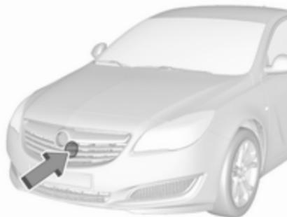
Das Radargerät ist hinter dem Kühlergrill unterhalb des Markenemblems montiert.
