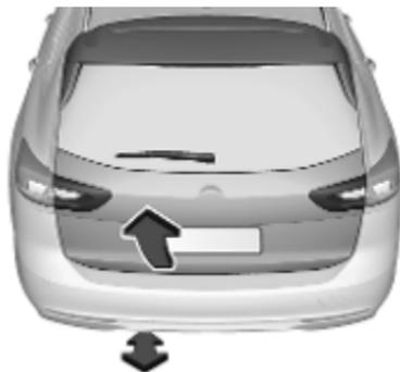
Um die Heckklappe zu öffnen oder zu schließen, den Fuß im mittleren Bereich unter dem hinteren Stoßfänger schnell vor und zurück bewegen. Den Fuß nicht unter dem Stoßfänger halten. Der elektronische Schlüssel muss sich außerhalb des Fahrzeugs in einem Umkreis von ca. 1 m um die Heckklappe befinden. Sobald die Fußbewegung vom Sensor erkannt wird, betätigt das System nach einer kurzen Verzögerung die Heckklappe.
