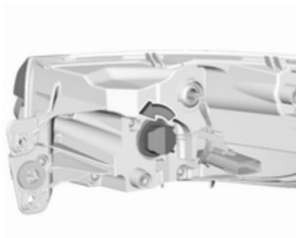
3. Die Lampenfassung des Blinkers links herum aus der Leuchteinheit drehen und abnehmen.
