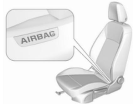
Das Seiten-Airbag-System besteht aus einem Airbag in der Rückenlehne jedes Vordersitzes und in den Rückenlehnen der äußeren Rücksitze. Diese Stellen sind mit dem Wort **AIRBAG** gekennzeichnet.
