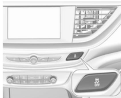
Die Traktionskontrolle kann ausgeschaltet werden, wenn ein Durchdrehen der Antriebsräder erwünscht ist:
