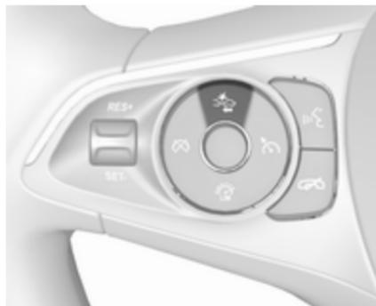
Beim ersten Drücken der Taste wird die aktuelle Einstellung im Fahrerinfodisplay angezeigt. Durch erneutes Drücken der Taste wird die Einstellung geändert. Die ausgewählte Einstellung bleibt aktiv, bis sie erneut geändert wird. Der Zeitpunkt der Warnung hängt von der Fahrgeschwindigkeit ab. Je höher die Fahrgeschwindigkeit, desto größer die Entfernung, ab der die Warnung ausgegeben wird. Beim Auswählen des Warnzeitpunkts die Verkehrs- und Witterungsbedingungen berücksichtigen.
