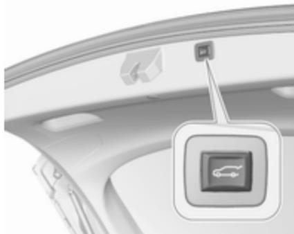
Zum Schließen auf
