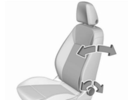
Handrad drehen. Zum Einstellen Rückenlehne entlasten.
