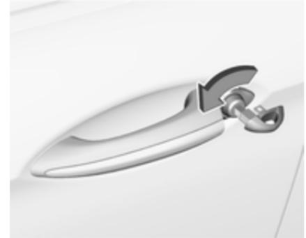
Die Fahrertür durch Einsetzen und Drehen des Schlüsselblatts im Schließzylinder von Hand entriegeln.
