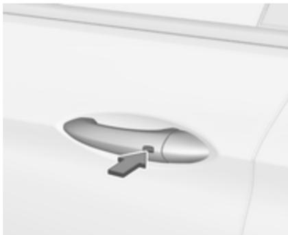
Elektronisches Schlüsselsystem: Beim Entriegeln des Fahrzeugs durch Drücken der Taste an einem Außentürgriff wird die Diebstahlwarnanlage deaktiviert.
