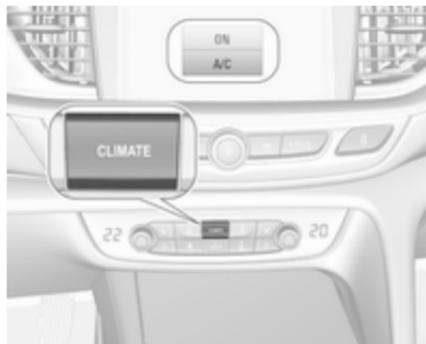
Zum Öffnen des Menüs auf **Climate** drücken und die Klimaanlage über die Schaltfläche **A/C** ein- oder ausschalten.
