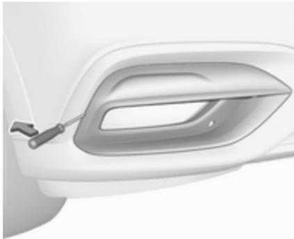
Die Spitze des Schlitzschraubendrehers mit einem Tuch umwickeln, um den Lack zu schützen. Die Frontplatte durch Einsetzen des Schraubendrehers in die Aussparung heraushebeln und entfernen.
