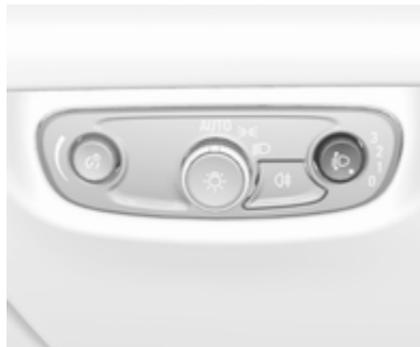
Zur Anpassung der Leuchtweite an die Fahrzeuglast, um die Blendwirkung zu reduzieren: Daumenrädchen
