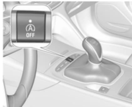
Die Stopp-Start-Automatik lässt sich durch Drücken von
