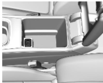
Unter der hochklappbaren Armlehne befinden sich zwei USB-Anschlüsse zum Laden von elektronischen Geräten. Diese Anschlüsse verfügen auch über eine Datenverbindung zum Infotainment-System.
