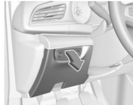
Bei Linkslenkern befindet sich der Sicherungskasten hinter einer Abdeckung in der Instrumententafel.
