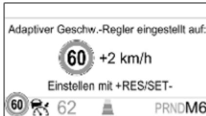
Wenn eine neue festgelegte Geschwindigkeit definiert wurde, wird eine Bestätigungsmeldung angezeigt. Während dieses Zeitraums kann die Abweichung zur festgelegten Geschwindigkeit angepasst werden.
