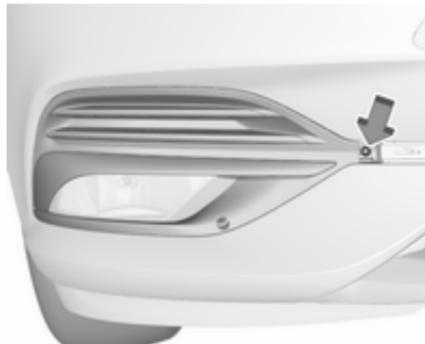
Die Schraube mit dem Torx-Schraubendreher lösen und die Frontplatte entfernen.
