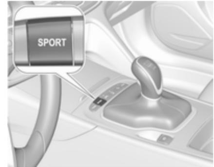
Bei Fahrzeugen mit Flex-Ride-Fahrmodi kann der Fahrer durch Auswahl des Sport-Modus die Beschleunigung des adaptiven Geschwindigkeitsreglers leicht erhöhen. Diese Funktion kann im Flex-Ride-Visualisierungsmenü deaktiviert werden ↪ 190.
