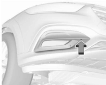
Die Schraube mit einem Torx-Schraubendreher lösen.
