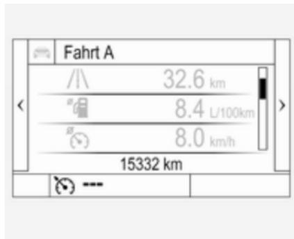
Die erfasste Gesamtfahrstrecke wird in km angezeigt.
