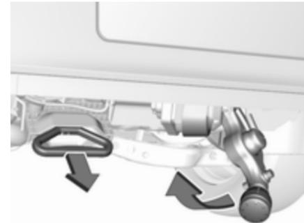
Den Griff unter der hinteren Stoßfängerverkleidung links vom Nummernschild in einem Winkel von etwa 45° Richtung Boden ziehen.
