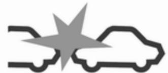
Wenn der Zeitabstand zum vorausfahrenden Fahrzeug sich zu sehr verringert und eine Kollision droht, wird das Aufprallwarnsymbol im Fahrerinfodisplay eingeblendet und der Fahrer wird durch einen rot blinkenden LED-Streifen oder durch ein vom Head-up-Display im Sichtfeld des Fahrers auf die Windschutzscheibe projiziertes Popup-Symbol gewarnt.
