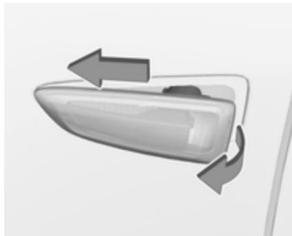
1. Lampengehäuse nach vorn schieben und an der Rückseite abziehen.
