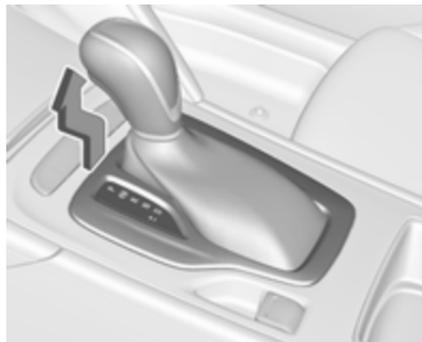
2. Die Wählhebel-Verkleidung von der Mittelkonsole lösen. Den Finger in die Ledertasche neben dem Wählhebel stecken und die Zierleiste vorsichtig nach oben ziehen; dort ist ein Kabel angebracht. Die Verkleidung leicht nach vorn schieben, da sie auf der Rückseite klappbar ist. Lose Verkleidung nach links kippen, um das Kabel nicht zu spannen.
