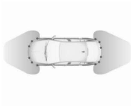
Die erweiterte Einparkhilfe ist immer mit der Front-Heck-Einparkhilfe kombiniert. Beide Systeme nutzen dieselben Sensoren im vorderen und hinteren Stoßfänger.
