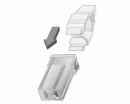
Die Sicherung mit dem Sicherungszieher greifen und herausziehen.
