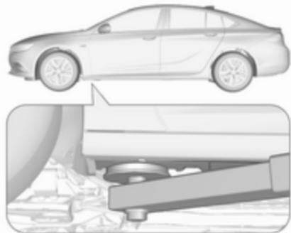
Vordere Arme der Hebebühne mittig unter den entsprechenden Wagenheberaufnahmen positionieren.
