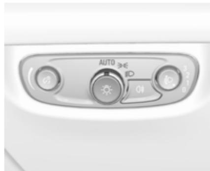
**AUTO** : Automatisches Fahrlicht, schaltet automatisch zwischen Tagfahr- und Abblendlicht um
