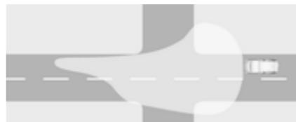
Wird automatisch bei Geschwindigkeiten bis ca. 55 km/h und in Situationen mit Außenumgebungslicht aktiviert. Der breite Strahl ist so definiert, dass andere Verkehrsteilnehmer möglichst wenig geblendet werden.
