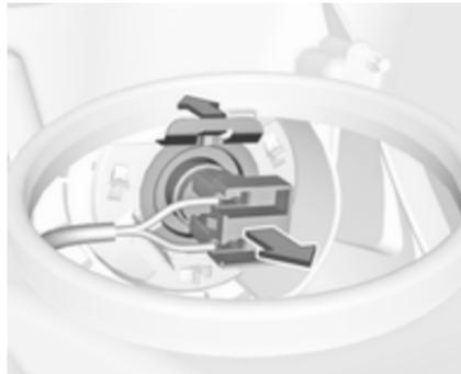
2. Lampenfassung lösen, indem deren Halterung nach vorn gedrückt wird. Die Lampenfassung aus dem Reflektorgehäuse ziehen.
