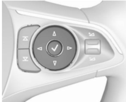
Über die Tasten rechts am Lenkrad eines der Menüs **Info**, **i** oder
