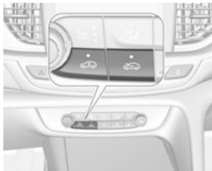
Zur Aktivierung des Außenluftmodus
