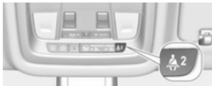
☹<sup>2</sup> für den Beifahrersitz leuchtet oder blinkt rot in der Dachkonsole, wenn der Sitz belegt ist.
