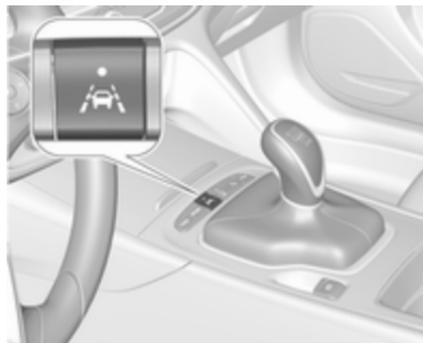
Der Spurhalteassistent wird durch Drücken auf
