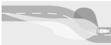
Je nach Lenkwinkel und Geschwindigkeit werden spezielle LED zusätzlich eingeschaltet, um in Kurven das Scheinwerferlicht zu verbessern. Diese Funktion ist bei einer Geschwindigkeit zwischen 40 km/h und 70 km/h aktiviert.
