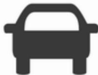
Wenn das System ein vorausfahrendes Fahrzeug in der Fahrspur erkannt hat, leuchtet die Kontrollleuchte für ein erkanntes vorausfahrendes Fahrzeug
