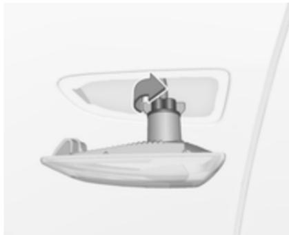
2. Lampenfassung nach links drehen und aus dem Gehäuse ziehen.
