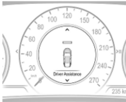
Wenn das System eingeschaltet, aber inaktiv ist, wird vor dem Fahrzeugsymbol ein weißer Balken in der festgelegten Abstandsposition angezeigt.
