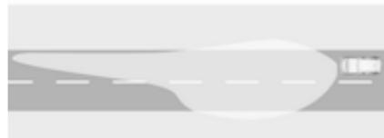
Wird beim Fahren in ländlichen Gebieten automatisch bei Geschwindigkeiten über ca. 55 km/h aktiviert.
