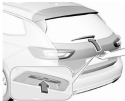
Zum Öffnen der Heckklappe die Taste unter der Heckklappenleiste drücken, bis sich die Heckklappe bewegt. Wenn das Fahrzeug verriegelt ist, muss sich der elektronische
