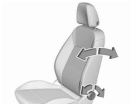
Handrad drehen. Zum Einstellen Rückenlehne entlasten.
