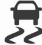
Die elektronische Stabilitätsregelung ist nach jedem Motorstart funktionsfähig, sobald die Kontrollleuchte
