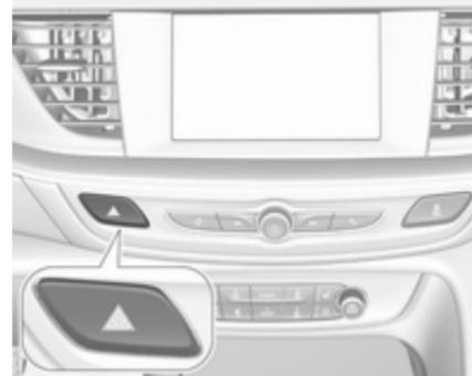
Bei einem Unfall mit Airbagauslösung wird der Warnblinker automatisch eingeschaltet.
