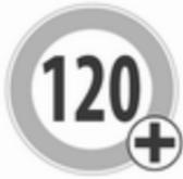
Zudem werden in der unteren Zeile des Fahrerinfodisplays permanent die aktuell gültigen Geschwindigkeitsbegrenzungen angezeigt. Wenn eine Geschwindigkeitsbegrenzung mit zusätzlichem Verkehrsschild verfügbar ist, wird in diesem Bereich ein + Symbol angezeigt.
