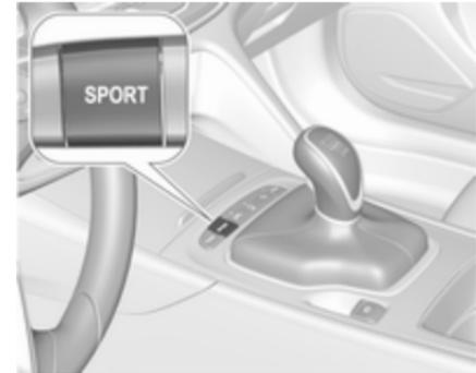
Bei Fahrzeugen mit Flex-Ride-Fahrmodi kann der Fahrer durch Auswahl des Sport-Modus die Beschleunigung des adaptiven Geschwindigkeitsreglers leicht erhöhen. Diese Funktion kann im Flex-Ride-Visualisierungsmenü deaktiviert werden ↪ 188.
