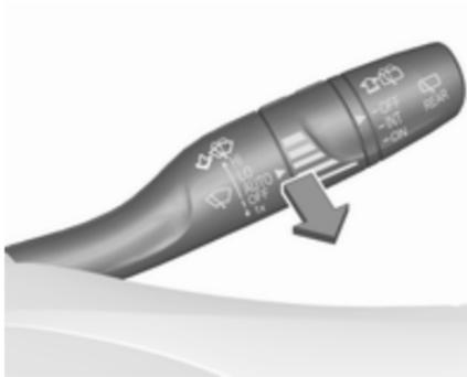
Hebel ziehen. Waschflüssigkeit spritzt auf die Windschutzscheibe und der Wischer wird für einige Wischbewegungen eingeschaltet. Waschflüssigkeit ↪ 253.
