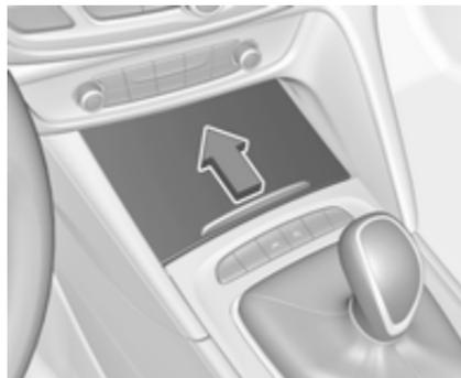
Ein Ablagefach befindet sich in der Mittelkonsole. Abdeckung nach vorn drücken.
