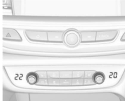
Temperaturvoreinstellungen für Fahrer und Beifahrer separat über den linken und den rechten Drehreg-
