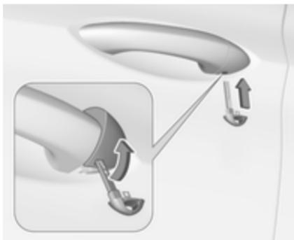
Das Schlüsselblatt in die Aussparung am unteren Rand der Kappe stecken und den Schlüssel nach oben schwenken.
