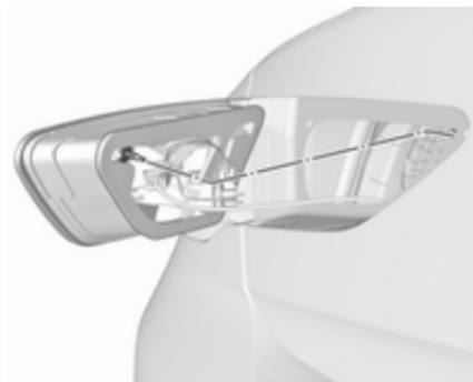
3. Leuchteinheit vorsichtig aus der Aussparung nehmen und entfernen. Darauf achten, dass das Kabel nicht abgezogen wird.
