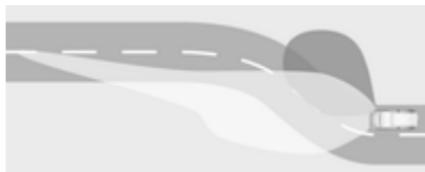
Je nach Lenkwinkel und Geschwindigkeit werden spezielle LED zusätzlich eingeschaltet, um in Kurven das Scheinwerferlicht zu verbessern. Diese Funktion ist bei einer Geschwindigkeit zwischen 40 km/h und 70 km/h aktiv. Bei aktiviertem Fernlicht wird die Lichtstärke des Kurvenlichts erhöht.
