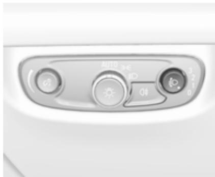
Zur Anpassung der Leuchtweite an die Fahrzeuglast, um die Blendwirkung zu reduzieren: Daumenrädchen
