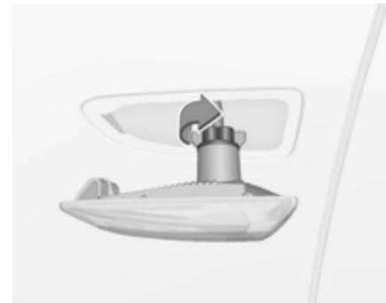
2. Lampenfassung nach links drehen und aus dem Gehäuse ziehen.
