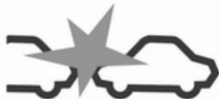
Wenn der Zeitabstand zum vorausfahrenden Fahrzeug sich zu sehr verringert und eine Kollision droht, wird das Aufprallwarnsymbol im Fahrerinfodisplay eingeblendet und der Fahrer wird durch einen rot blinkenden LED-Streifen oder durch ein vom Head-up-Display im Sichtfeld des Fahrers auf die Windschutzscheibe projiziertes Popup-Symbol gewarnt.
