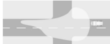
Wird automatisch bei Geschwindigkeiten bis ca. 50 km/h aktiviert. Der breite Strahl ist so definiert, dass andere Verkehrsteilnehmer möglichst wenig geblendet werden.
