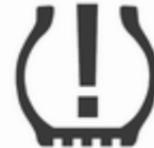
Wenn niedriger Reifendruck erkannt wird, wird dies durch die Kontrollleuchte (⚠) gemeldet ⇨ 115.
