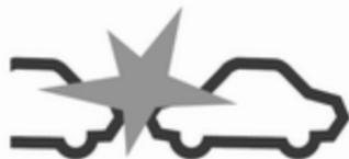
Bei zu schneller Annäherung an einen erkannten Fußgänger leuchtet das Auffahrwarnungssymbol im Fahrerinfodisplay auf und im Head-up-Display wird das Symbol  $\star$  im Sichtfeld des Fahrers auf die Windschutzscheibe projiziert. Ein Warnton wird ausgegeben. Das Bremssystem kann sich auf ein Bremsen Fahrers vorbereiten, weshalb es zu einer kurzen, leichten Verlangsamung kommen kann. Das Bremspedal weiter wie erforderlich betätigen.
