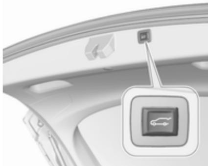
Zum Schließen auf
