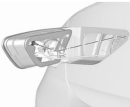
3. Leuchteneinheit vorsichtig aus der Aussparung nehmen und entfernen. Darauf achten, dass das Kabel nicht abgezogen wird.
