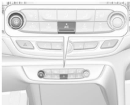
**A/C** drücken, um die Kühlung einzuschalten. Die Betätigung wird durch die LED auf der Taste angezeigt. Die
