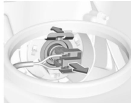
2. Lampenfassung lösen, indem deren Halterung nach vorn gedrückt wird. Die Lampenfassung aus dem Reflektorgehäuse ziehen.
