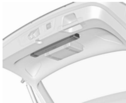
Das Warndreieck an der Innenverkleidung der Heckklappe verstauen und mit den Bändern sichern.
