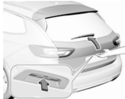
Nach dem Entriegeln die Taste unter der Heckklappenleiste drücken und die Heckklappe öffnen.
