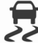
Die elektronische Stabilitätsregelung ist nach jedem Motorstart funktionsfähig, sobald die Kontrollleuchte
