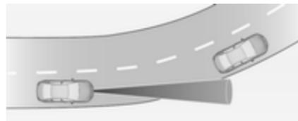
Ausgehend von der Zentrifugalkraft berechnet der adaptive Geschwindigkeitsregler einen voraussichtlichen Weg. Der berechnete Weg berücksichtigt die aktuellen Kurveneigenschaften, kann jedoch keine späteren Änderungen der Kurvenspur vorhersehen. Das System kann daher ein vorausfahrendes Fahrzeug aus dem Erkennungsbereich verlieren oder ein Fahrzeug erkennen, das sich nicht auf der verwendeten Fahrspur befindet. Dies kann beim Einfahren in eine Kurve oder beim Ausfahren aus einer
