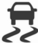
Die Traktionskontrolle ist nach jedem Motorstart funktionsfähig, sobald die Kontrollleuchte
