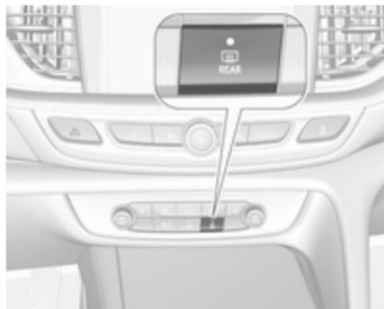
Die Heizung der Heckscheibe und der Außenspiegel wird durch Drücken auf
