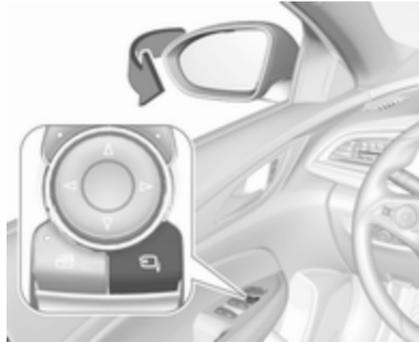
drücken. Beide Außenspiegel werden eingeklapt.
