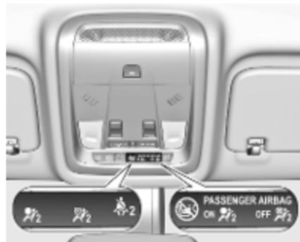
Wenn die Kontrollleuchte
