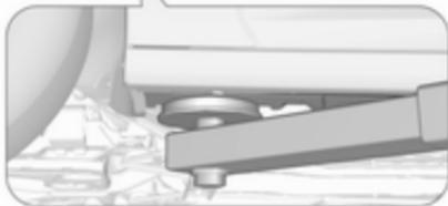
Vordere Arme der Hebebühne mittig unter den entsprechenden Wagenheberaufnahmen positionieren.
