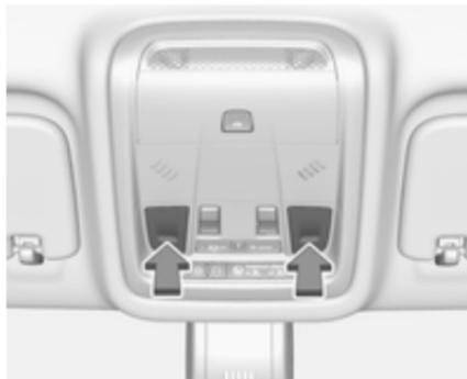
Wird durch Drücken des entsprechenden Leselichtschalters eingeschaltet.
