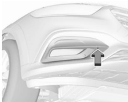
Die Schraube mit einem Torx-Schraubendreher lösen.
