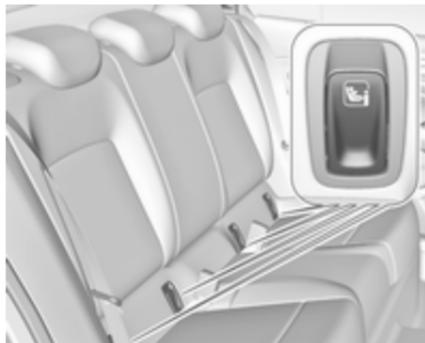
Für das Fahrzeug zugelassene ISOFIX-Kindersicherheitssysteme an den ISOFIX-Befestigungen befestigen. Die speziellen Positionen für ISOFIX-Kindersicherheitssysteme sind in der Tabelle mit ISOFIX gekennzeichnet ⇨ 72.
