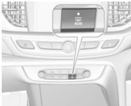
Die Heizung der Heckscheibe und der Außenspiegel wird durch Drücken auf
