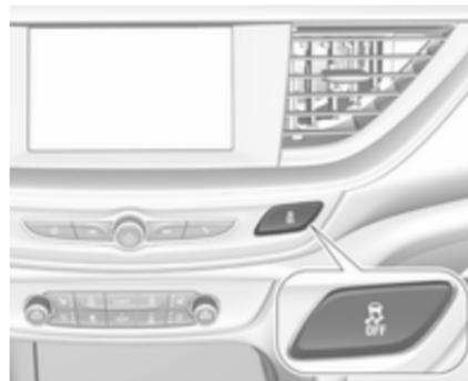
Die Traktionskontrolle kann ausgeschaltet werden, wenn ein Durchdrehen der Antriebsräder erwünscht ist:
