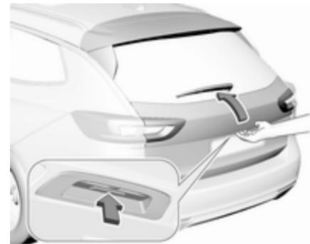
Zum Öffnen der Heckklappe die Taste unter der Heckklappenleiste drücken, bis sich die Heckklappe bewegt. Wenn das Fahrzeug verriegelt ist, muss sich der elektronische
