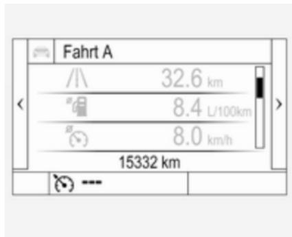
Die erfasste Gesamtfahrstrecke wird in km angezeigt.
