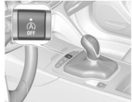
Die Stopp-Start-Automatik lässt sich durch Drücken von
