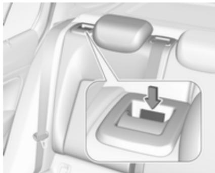
Die Rückenlehnen sind korrekt eingerastet, wenn die roten Markierungen an den Entriegelungsgriffen auf beiden Seiten nicht mehr sichtbar sind.
