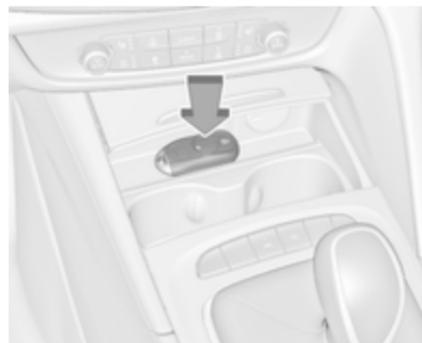
Die Abdeckung der Mittelkonsole vor dem Wählhebel öffnen. Elektronischen Schlüssel wie in der Abbildung
