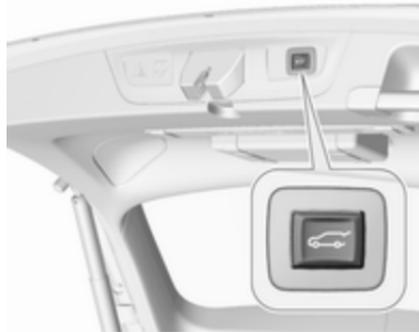
4. Die Taste
