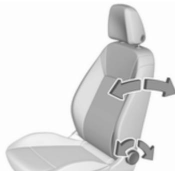
Handrad drehen. Zum Einstellen Rückenlehne entlasten.
