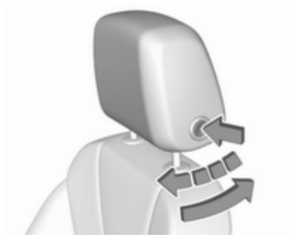
Die Entriegelungstaste drücken und das Polster der Kopfstütze langsam nach vorn ziehen. Sie rastet in verschiedenen Positionen ein.
