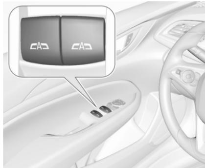
Schalter **CAD** des betreffenden Fensters zum Öffnen drücken bzw. zum Schließen ziehen.
