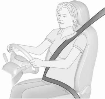
Bei starker Beschleunigung oder Verzögerung des Fahrzeugs blockieren die Sicherheitsgurte, um die Insassen in ihrer Sitzposition zu halten. Dadurch wird die Verletzungsgefahr deutlich verringert.
