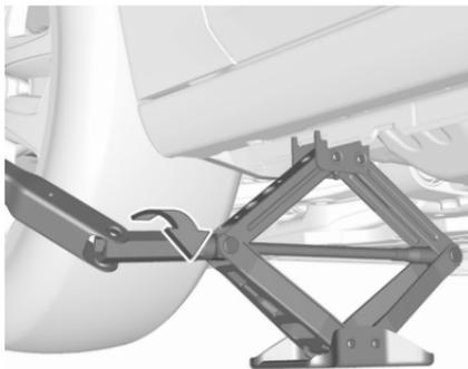
Radschlüssel ansetzen und den korrekt ausgerichteten Wagenheber hochkurbeln, bis das Rad vom Boden abhebt.
