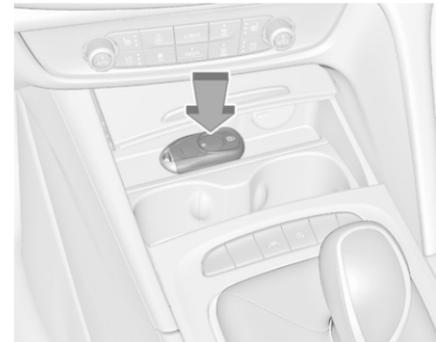
Die Abdeckung der Mittelkonsole vor dem Wählhebel öffnen. Elektronischen Schlüssel wie in der Abbildung
