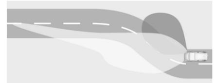
Bestimmte LEDs und deren Intensität werden je nach Kurvenrichtung und Fahrgeschwindigkeit zusätzlich angepasst, um die Ausleuchtung der Kurve zu verbessern.
