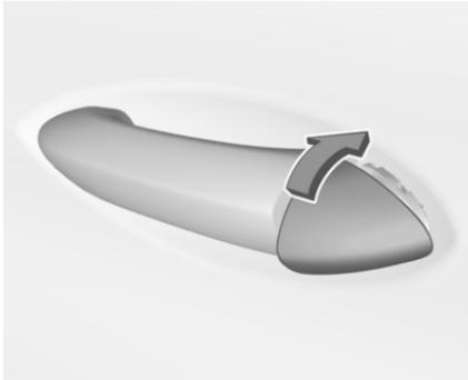
Nach dem Verriegeln den Schließzylinder mit der Kappe bedecken: Die Kappe mit der unteren Seite in die Aussparung einsetzen und drücken, bis sie an der Oberseite einrastet.
