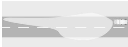
Wird außerorts ab einer bestimmten Fahrgeschwindigkeit automatisch aktiviert. Die eigene Fahrbahn und deren Rand werden besser ausge-
