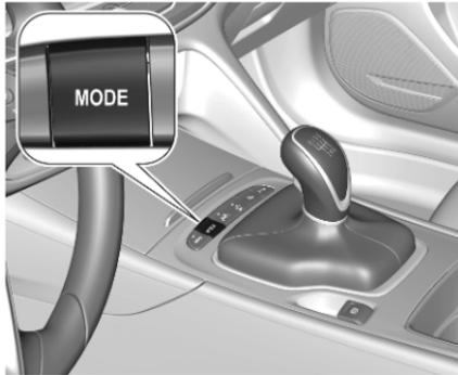
Bei Fahrzeugen mit FlexRide-Fahrmodi kann der Fahrer durch Auswahl des Sport-Modus die Beschleunigung des adaptiven Geschwindigkeitsreglers leicht erhöhen. Diese Funktion kann im FlexRide-Visualisierungsmenü deaktiviert werden ↪ 184.
