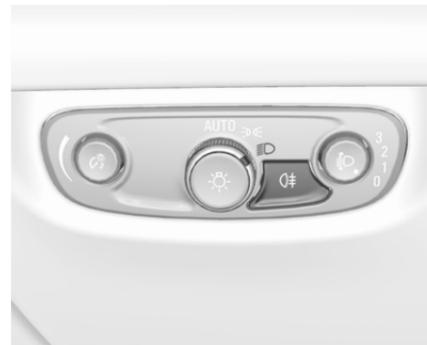
Wird durch Drücken von  $\text{☞#}$  bedient. Lichtschalter in Stellung **AUTO**: Beim Einschalten der Nebelschlussleuchte werden die Scheinwerfer automatisch eingeschaltet.
