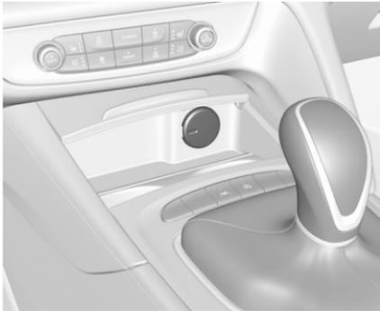
Eine 12-V-Zubehörsteckdose befindet sich in der Mittelkonsole. Bei ausgeschalteter Zündung ist diese Steckdose deaktiviert.
