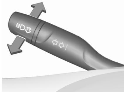
Zum Umschalten von Abblend- auf Fernlicht den Hebel drücken.
