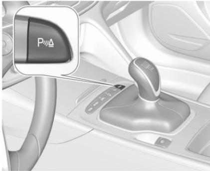
Wenn die LED in der Einparkhilfe-Taste **P** mit einem Dreieck und einem Auto-Symbol leuchtet, ist das System betriebsbereit.
