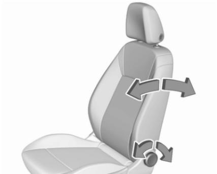
Handrad drehen. Zum Einstellen Rückenlehne entlasten.
