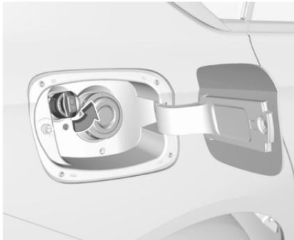
4. Die Schutzkappe vom Einfüllstutzen abschrauben.
