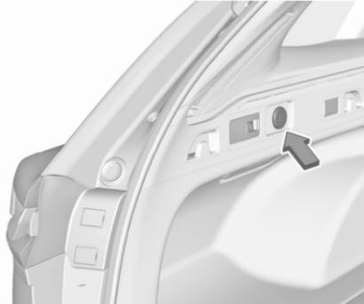
Eine 12-V-Zubehörsteckdose befindet sich an der linken Laderaumwand. Bei ausgeschalteter Zündung bleibt diese Steckdose aktiviert.
