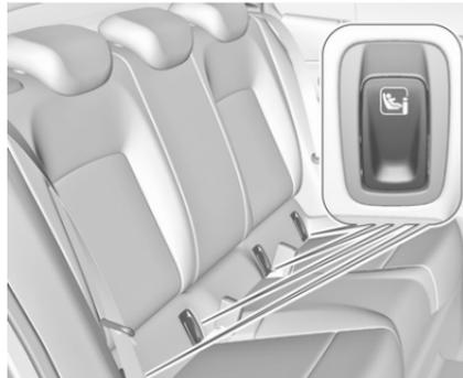
Für das Fahrzeug zugelassene ISOFIX-Kindersicherheitsysteme an den ISOFIX-Befestigungen befestigen. Die speziellen Positionen für ISOFIX-Kindersicherheitsysteme sind in der Tabelle mit ISOFIX gekennzeichnet ⇨ 74.
