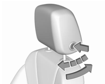
Die Entriesselungstaste drücken und das Polster der Kopfstütze langsam nach vorn ziehen. Sie rastet in verschiedenen Positionen ein.
