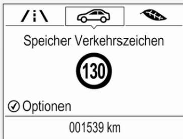
Wenn beim Baselevel-Display die Verkehrszeichen-Assistent-Seite angezeigt wird, auf ✓ an der Fernbedienung am Lenkrad drücken.
