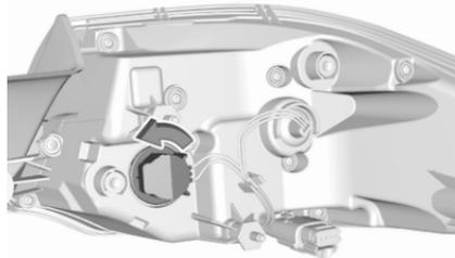
4. Die Lampenfassung des Blinkers links herum aus der Leuchteinheit drehen und abnehmen.
