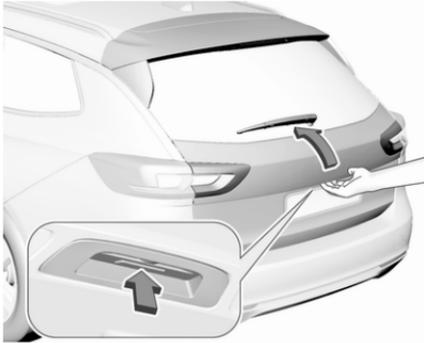
Nach dem Entriegeln die Taste unter der Heckklappenleiste drücken und die Heckklappe öffnen.
