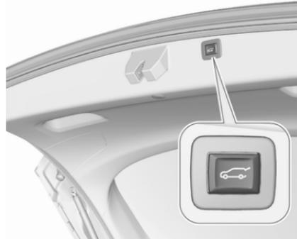
Zum Schließen auf
