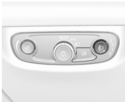
Zur Anpassung der Leuchtweite an die Fahrzeuglast, um die Blendwirkung zu reduzieren: Daumenrädchen  $\text{D}$  drücken und in die gewünschte Stellung drehen.
