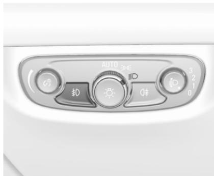
Wird durch Drücken von  $\text{☞D}$  bedient. Lichtschalter in Stellung **AUTO**: Beim Einschalten der Nebelscheinwerfer werden die Scheinwerfer automatisch eingeschaltet.
