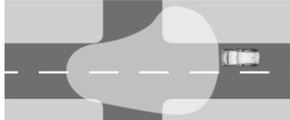
Wird ab einer bestimmten Fahrgeschwindigkeit automatisch aktiviert. Der breite Strahl ist so definiert, dass andere Verkehrsteilnehmer möglichst wenig geblendet werden.
