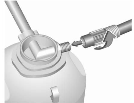
2. Typ 1: Kompressor-Luftschlauch auf den Anschluss der Dichtmittelflasche schrauben und Dichtmittelflasche in die Halterung am Kompressor einsetzen.
