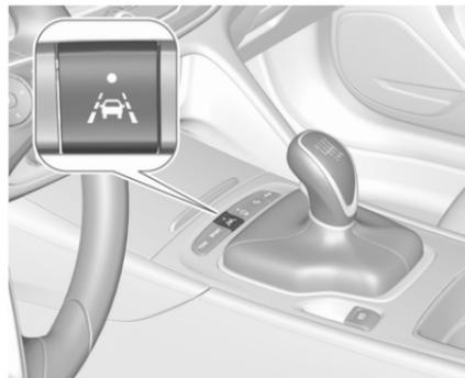
Der Spurhalteassistent wird beim Starten des Motors und beim Drücken auf
