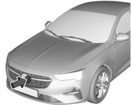
Das Radargerät ist hinter dem Kühlergrill oder unterhalb des Markenemblems angebracht.
