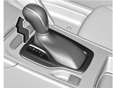
2. Die Wählhebel-Verkleidung von der Mittelkonsole lösen. Den Finger in die Ledertasche neben dem Wählhebel stecken und die Zierleiste vorsichtig nach oben ziehen; dort ist ein Kabel angebracht. Die Verkleidung leicht nach vorn schieben, da sie auf der Rückseite klappbar ist. Lose Verkleidung nach links kippen, um das Kabel nicht zu spannen.
