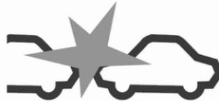
Wenn der Zeitabstand zum vorausfahrenden Fahrzeug sich zu sehr verringert und eine Kollision droht, wird das Aufprallwarnsymbol im Fahrerinfodisplay eingeblendet und der Fahrer wird durch einen rot blinkenden LED-Streifen oder durch ein vom Head-up-Display im Sichtfeld des Fahrers auf die Windschutzscheibe projiziertes Popup-Symbol gewarnt.
