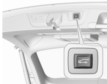
4. Die Taste
