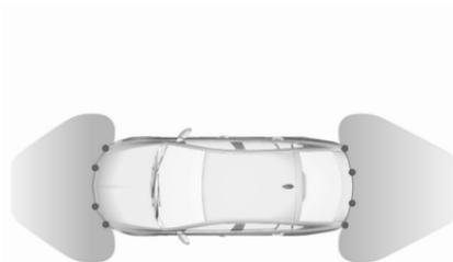
Das System besteht aus jeweils vier Ultraschall-Parksensoren im vorderen und hinteren Stoßfänger.
