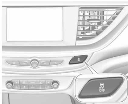
Die Traktionskontrolle kann ausgeschaltet werden, wenn ein Durchdrehen der Antriebsräder erwünscht ist:
