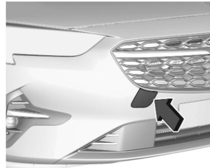
Die Spitze eines Schlitzschraubendrehers mit einem Tuch umwickeln, um den Lack zu schützen. Den Schraubendreher in den Schlitz an der Kante der Abdeckung stecken. Die Kappe vorsichtig abhebeln und lösen.
