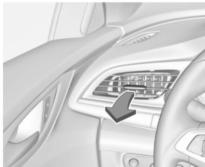
Abbildung zeigt äußere Belüftungsdüsen in der Instrumententafel.
