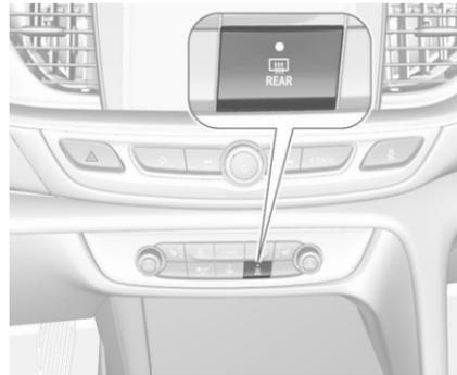
Die Heizung der Heckscheibe und der Außenspiegel wird durch Drücken auf betätigt. Die LED in der Taste leuchtet auf.
