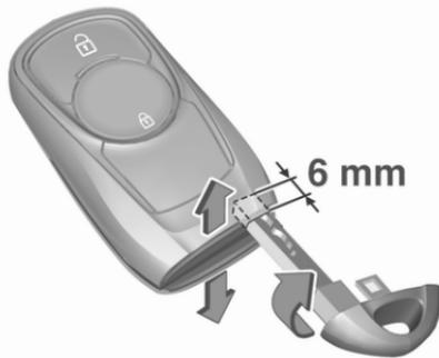
2. Das Schlüsselblatt wieder etwa 6 mm weit einführen und den Schlüssel drehen, um das Gehäuse zu öffnen. Wenn das Schlüsselblatt zu weit eingeführt wird, kann dies das Gehäuse beschädigen.
