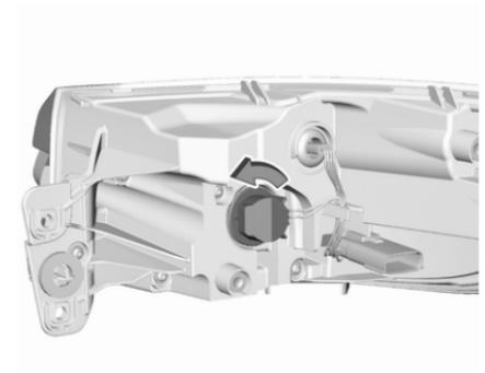
3. Die Lampenfassung des Blinkers links herum aus der Leuchteinheit drehen und abnehmen.
