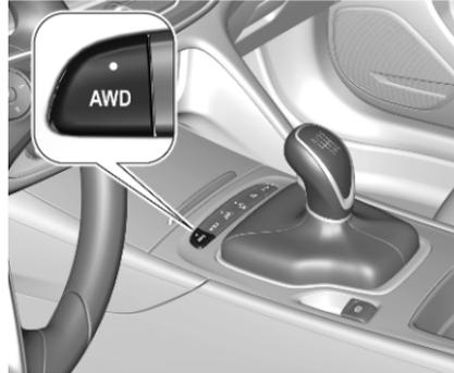
Die Betätigung wird durch die LED auf der Taste angezeigt. Wenn ein Umschalten vorübergehend nicht möglich ist, zum Beispiel bei zu hoher Fahrgeschwindigkeit, blinkt die LED.
