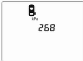
Reifendruck-Kontrollsystem durch Drehen des Einstellrädchens wählen.
