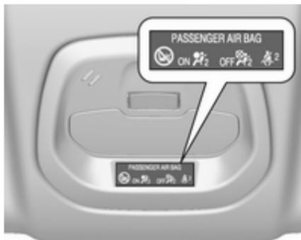
☘ für den Beifahrersitz leuchtet auf oder blinkt rot in der Dachkonsole, wenn der Sitz belegt ist.
