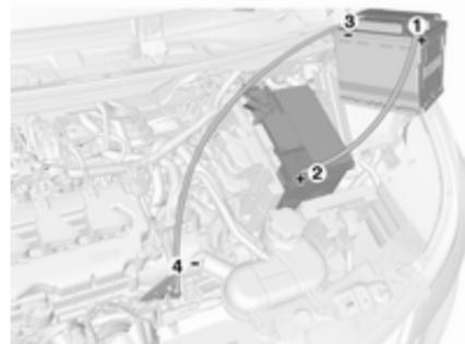
Reihenfolge für das Anschließen der Kabel:
