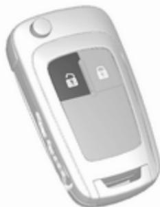
🔓 drücken, um Türen und Laderaum zu entriegeln. Türen durch Ziehen an den Griffen öffnen.
