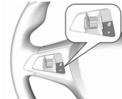
Die Heizung durch Drücken von
