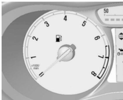
Bei geringem Füllstand leuchtet die Kontrollleuchte
