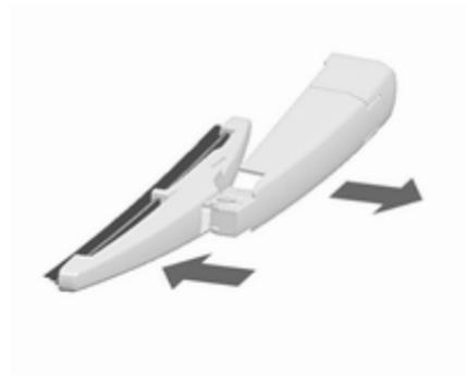
Wischerarm anheben. Das Wischerblatt im leichten Winkel zum Wischerarm nach unten drücken, bis es freigegeben wird.
