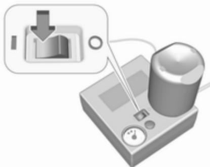
Wippschalter auf dem Kompressor auf I stellen. Der Reifen wird mit Dichtmittel gefüllt.
