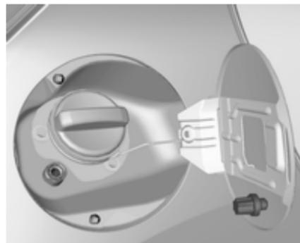
Die Schutzkappe ist magnetisch. Beim Tanken die Kappe an die Tankklappe setzen.
