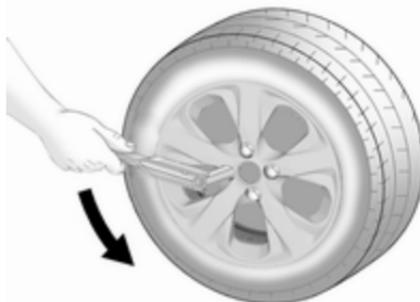
2. Radschraubenschlüssel ansetzen und sicherstellen, dass er gut sitzt. Die Radschrauben jeweils eine halbe Umdrehung lösen.
