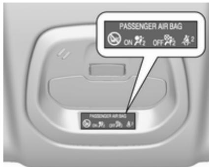
Wenn die Kontrollleuchte  $\text{ON}$  nach Einschalten der Zündung für ca. 60 Sekunden aufleuchtet, löst der Beifahrer-Airbag bei einem Unfall aus.
