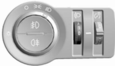
Zur Anpassung der Leuchtweite an die Fahrzeuglast, um Blendwirkung zu reduzieren: Daumenrädchen
