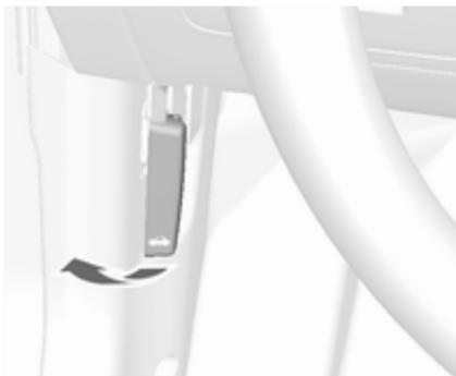
Entriegelungshebel ziehen und in die Ausgangsposition zurückführen.
