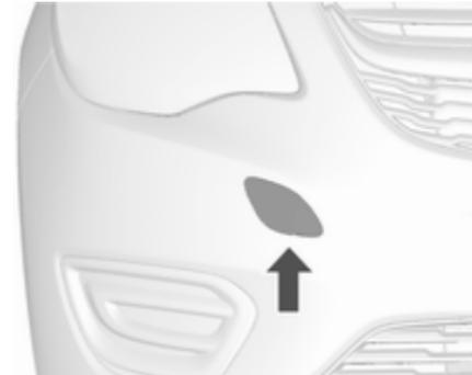
1. Abdeckung mit einem Schraubenzieher lösen und abnehmen.
