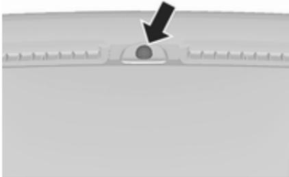
Die Status-LED ist in den Sensor oben auf der Instrumententafel integriert.
