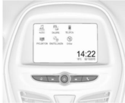
Ein Druck auf
