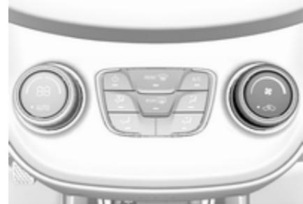
Luftstrom durch Einschalten des Gebläses auf die gewünschte Geschwindigkeit einstellen. Die gewählte Gebläsegeschwindigkeit ist anhand der Anzahl der Segmente auf dem Display erkennbar. Bei ausgeschaltetem Gebläse wird auch die Klimaanlage ausgeschaltet.
