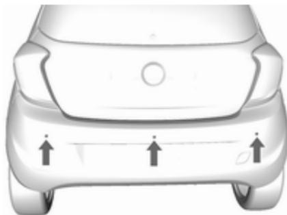
Die Heck-Einparkhilfe erleichtert das Einparken, indem sie den Abstand zwischen dem Fahrzeug und Hindernissen hinter dem Fahrzeug misst. Sie informiert und warnt den Fahrer mit Hilfe akustischer Signale und visueller Anzeigen.
