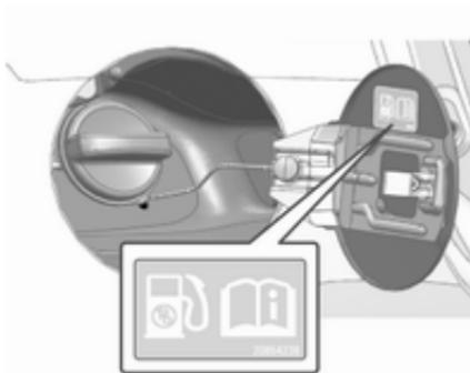
3. Kraftstofftankdeckel langsam gegen den Uhrzeigersinn drehen. Wenn ein zischendes Geräusch zu hören ist, warten, bis es aufgehört hat, bevor der Verschlussdeckel vollständig losgeschraubt wird.
