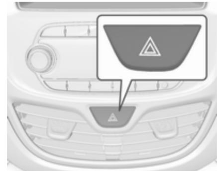
Wird durch Drücken von
