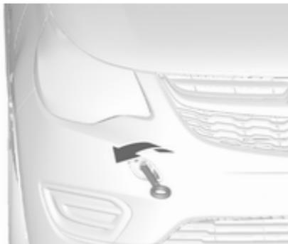
2. Abschleppöse bis zum Anschlag in waagerechter Stellung einschrauben.
