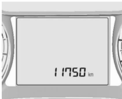
In der unteren Zeile wird die zurückgelegte Strecke in Kilometer angezeigt.
