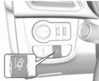
Die Spurverlassenswarnung wird durch Drücken von
