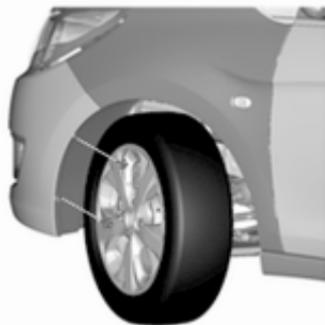
1. Das Rad drehen und die zwei Steckmuttern an der Außenseite der Radblende abnehmen.
