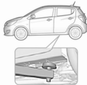
Position des hinteren Arms der Hebebühne, mittig unter der Aussparung im Schweller.
