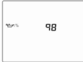
Zeigt die geschätzte Restlebensdauer des Öls an. Die Zahl in Prozent bedeutet die noch verbleibende Öllebensdauer und zeigt an, wann das Motoröl und der Filter gewechselt werden müssen ↷ 66.
