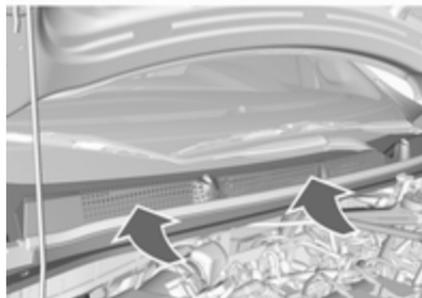
Der Lufteinlass im Motorraum außen vor der Windschutzscheibe muss zur Luftzufuhr frei sein. Gegebenenfalls Laub, Schmutz oder Schnee entfernen.
