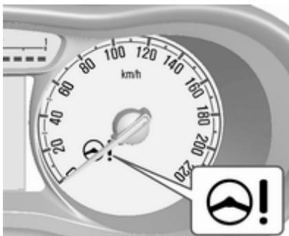
Bei einer Störung des Systems leuchtet die Kontrollleuchte ☰! auf.
