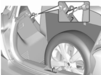
3. Das Gurtende mit der Schlaufe am Werkzeugkasten durch die Sitzlehnenrastung ziehen.
