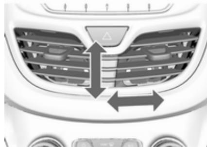
Richtung des Luftstroms durch Kippen und Schwenken der Lamellen einstellen.
