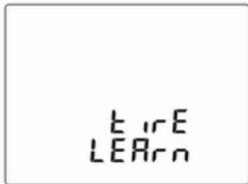
Dieser Menüpunkt dient dem Abgleichen eines neuen Reifen/neuen Rads mit den Sensoren des Reifendruck-Kontrollsystems ↷ 159.
