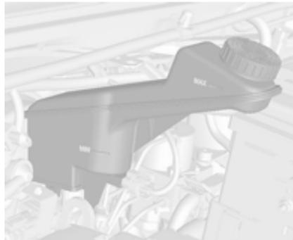
Der Bremsflüssigkeitsstand muss zwischen den Markierungen **MIN** und **MAX** liegen.
