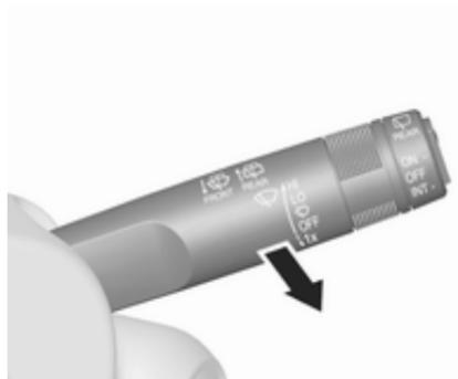
Hebel ziehen. Waschflüssigkeit spritzt auf die Windschutzscheibe und der Wischer wird für einige Wischbewegungen eingeschaltet. Waschflüssigkeit ↷ 142
