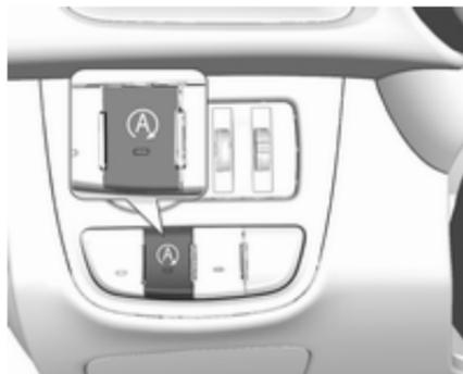
Die Stopp-Start-Automatik lässt sich durch Drücken von **A** manuell deaktivieren. Die Deaktivierung wird durch das Erlöschen der LED in der Taste angezeigt.
