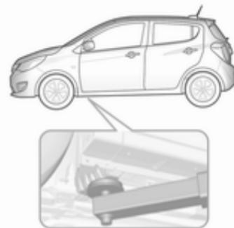
Position des vorderen Arms der Hebebühne am Unterboden.
