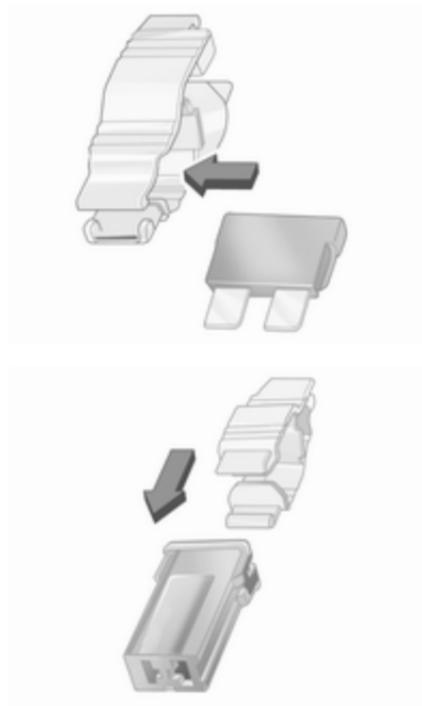
Den Sicherungszieher von oben auf die verschiedenen Arten von Sicherungen stecken und die Sicherung herausziehen.
