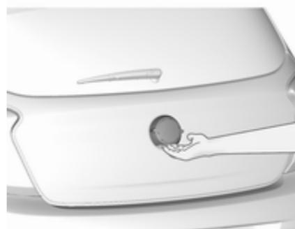
Zum Öffnen der Hecktür den Schalter unter dem Markenemblem drücken.
