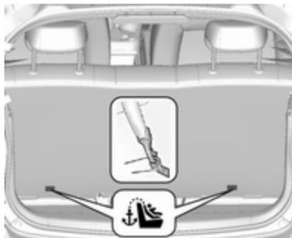
Zusätzlich zur ISOFIX Befestigung den Top-Tether Befestigungsgurt an den Top-Tether Befestigungsösen verankern.
