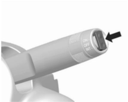
Zur Betätigung des Heckscheibenwischers Wippschalter drücken:
