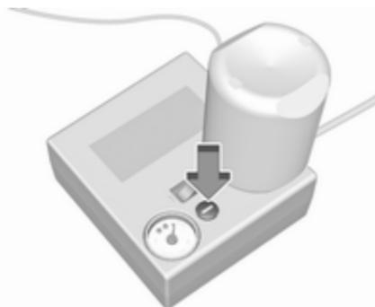
Wird der vorgeschriebene Reifendruck nicht innerhalb von zehn Minuten erreicht, das Reifenreparaturset entfernen. Das Fahrzeug um eine Reifenumdrehung bewegen. Das Reifenreparaturset wieder anbringen und den Füllvorgang 10 Minuten fortsetzen. Wird der vorgeschriebene Reifendruck danach immer noch nicht erreicht, Hilfe einer Werkstatt in Anspruch nehmen.
