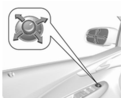
Entsprechenden Außenspiegel durch Drehen des Schalters nach links (L) oder rechts (R) auswählen. Danach das Bedienelement schwenken, um den Spiegel einzustellen.
