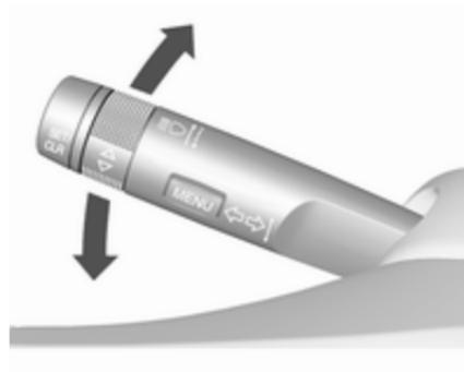
Hebel nach oben : Blinker rechts
