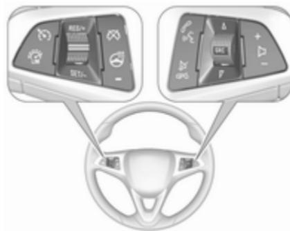
Das Driver Information Center, bestimmte Fahrerassistenzsysteme, das Infotainment System und ein angeschlossenes Mobiltelefon können mit den Lenkradelementen bedient werden.
