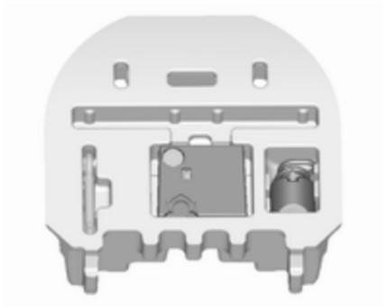
Das Wagenwerkzeug befindet sich neben dem Reifenreparaturset im Staufach unter der Bodenabdeckung.
