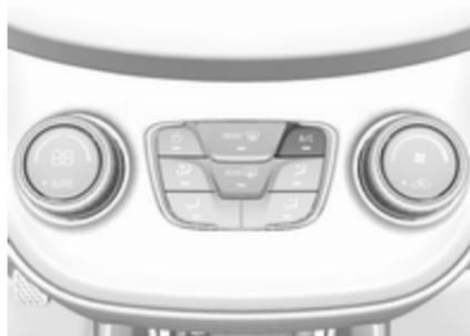
**A/C** drücken, um die Kühlung einzuschalten. Die LED in der Taste leuchtet auf, um die Aktivierung anzuzeigen. Die Kühlung ist nur bei laufendem Motor und eingeschaltetem Klimatisierungsgebläse funktionsfähig.
