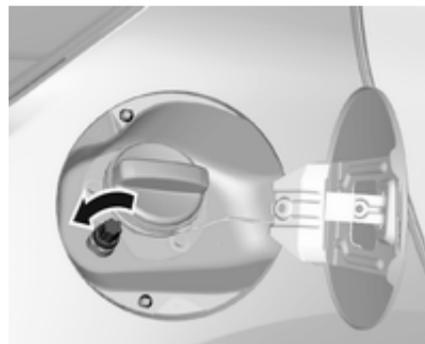
Die Schutzkappe vom Einfüllstutzen abschrauben.
