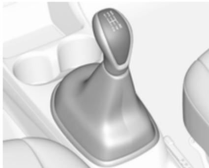
Zum Einlegen des Rückwärtsgangs das Kupplungspedal drücken und den Rückwärtsgang einlegen.
