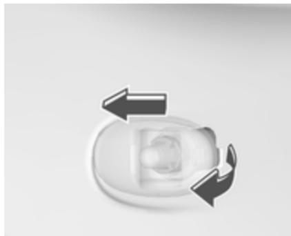
1. Die Lampe nach vorne schieben und mit dem hinteren Ende aus dem vorderen Flügel entnehmen.
