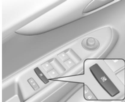
Zur Deaktivierung der elektrischen Fensterbetätigung der Hintertüren
