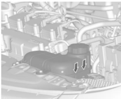
Bei kaltem Kühlsystem muss der Kühlmittelspiegel über der Fülllinienmarkierung liegen. Bei zu niedrigem Füllstand auffüllen.
