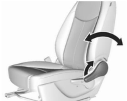
Hebel ziehen, Neigung einstellen und Hebel loslassen. Die Rückenlehne muss hörbar einrasten.
