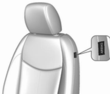
Das Seiten-Airbag-System besteht aus einem Airbag in der Rückenlehne jedes Vordersitzes. Diese Stelle ist durch das Wort **AIRBAG** gekennzeichnet.
