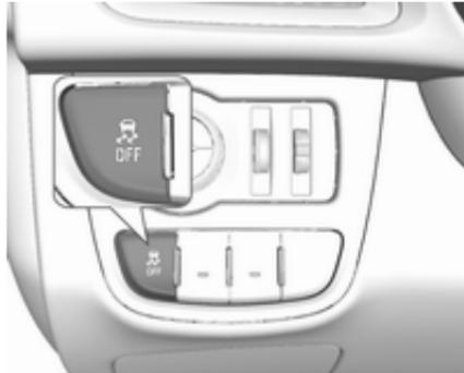
Die Traktionskontrolle kann ausgeschaltet werden, wenn ein Durchdrehen der Antriebsräder erwünscht ist:
