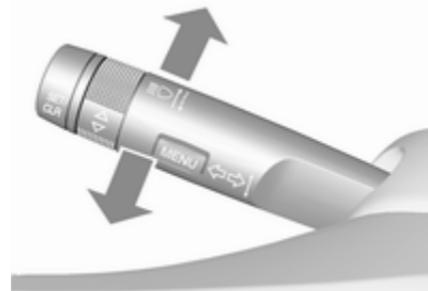
Zum Umschalten von Abblendlicht auf Fernlicht Hebel nach vorne drücken.
