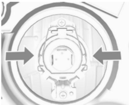
5. Federclip zusammendrücken und austrasten lassen.
