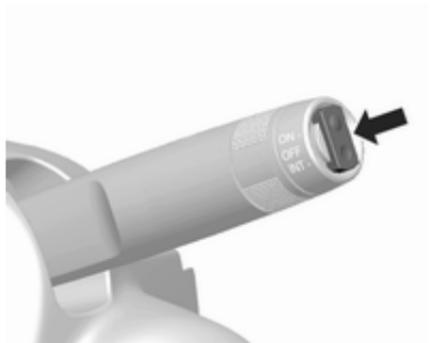
Zur Betätigung des Heckscheibenwischers Wippschalter drücken:
