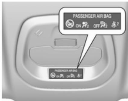
Wenn die Kontrollleuchte
