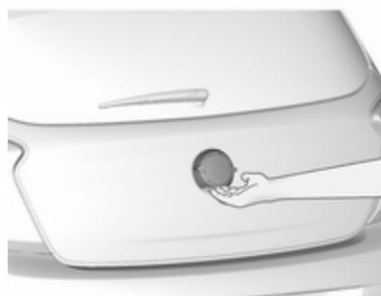
Zum Öffnen der Hecktür den Schalter unter dem Markenemblem drücken und leicht nach oben heben.
