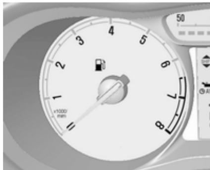
Bei geringem Füllstand leuchtet die Kontrollleuchte
