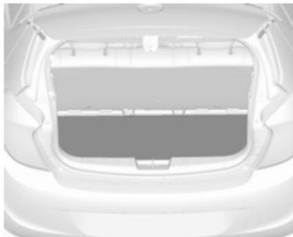
Die hintere Bodenabdeckung anheben, um Zugriff auf das Reifenreparaturset, das Wagenwerkzeug und das Warndreieck zu erhalten.
