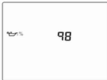
Zeigt die geschätzte Restlebensdauer des Öls an. Die Zahl in Prozent bedeutet die noch verbleibende Öllebensdauer und zeigt an, wann das Motoröl und der Filter gewechselt werden müssen ⇨ 67.
