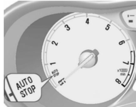
Ein Autostopp wird auf dem Drehzahlmesser angezeigt, indem die Nadel auf der Position **AUTOSTOP** steht.
