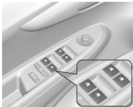
Den in der Türverkleidung befindlichen Schalter für das betreffende Fenster betätigen, indem er zum Öffnen gedrückt bzw. zum Schließen gezogen wird.
