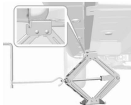
4. Wagenheber auf die erforderliche Höhe einstellen. Den Heber unmittelbar unter den Ansatzpunkt stellen und sicherstellen, dass er nicht rutschen kann.
