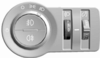
Zur Anpassung der Leuchtweite an die Fahrzeuglast, um Blendwirkung zu reduzieren: Daumenrädchen
