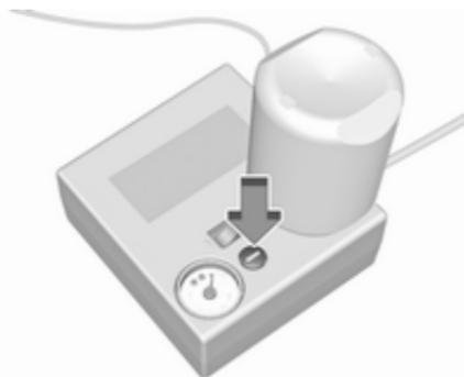
Wird der vorgeschriebene Reifendruck nicht innerhalb von zehn Minuten erreicht, das Reifenreparaturset entfernen. Das Fahrzeug um eine Reifenumdrehung bewegen. Das Reifenreparaturset wieder anbringen und den Füllvorgang 10 Minuten fortsetzen. Wird der vorgeschriebene Reifendruck danach immer noch nicht erreicht, ist der Reifen zu stark beschädigt. Hilfe einer Werkstatt in Anspruch nehmen.
