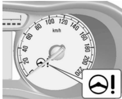
Bei einer Störung des Systems leuchtet die Kontrollleuchte
