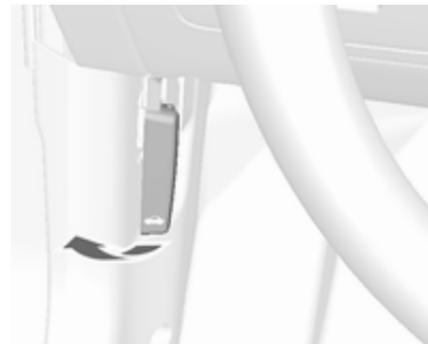
Entriegelungshebel ziehen und in die Ausgangsposition zurückführen.
