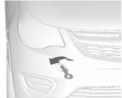
2. Abschleppöse bis zum Anschlag in waagerechter Stellung einschrauben.
