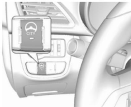
Bei laufendem Motor
