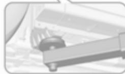
Position des vorderen Arms der Hebebühne am Unterboden.
