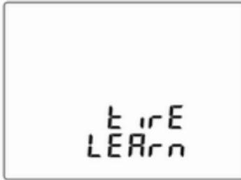
Dieser Menüpunkt dient dem Abgleichen eines neuen Reifen/neuen Rads mit den Sensoren des Reifendruck-Kontrollsystems ↷ 161.
