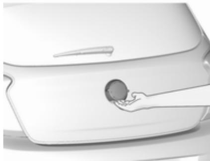
Zum Öffnen der Hecktür bei entriegeltem Fahrzeug den Touchpad-Schalter auf der Unterseite des Hecktürgriffs drücken und die Hecktür anheben.
