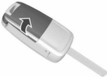
Schlüsselbart ausklappen und die Funkfernbedienung seitlich öffnen. Die Batterie austauschen (Batterietyp
