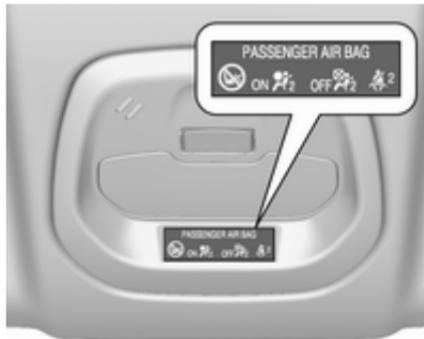
☹<sup>2</sup> für den Beifahrersitz leuchtet auf oder blinkt rot in der Dachkonsole, wenn der Sitz belegt ist.
