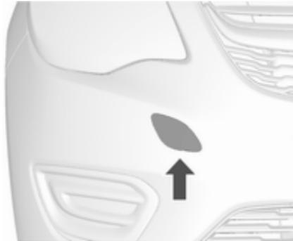
1. Abdeckung mit einem Schraubenzieher lösen und abnehmen.
