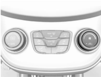
Luftstrom durch Einschalten des Gebläses auf die gewünschte Geschwindigkeit einstellen. Die gewählte Gebläsegeschwindigkeit ist anhand der Anzahl der Segmente auf dem Display erkennbar. Bei ausgeschaltetem Gebläse wird auch die Klimaanlage ausgeschaltet.
