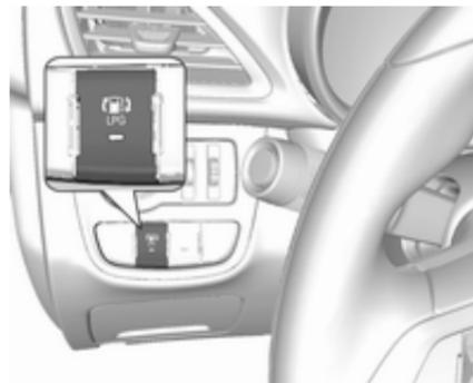
Durch Drücken von **LPG** wird zwischen Benzin- und Flüssiggasbetrieb umgeschaltet, sobald die erforderlichen Parameter (Kühlmitteltemperatur, Gastemperatur und Minstdrehzahl des Motors) erreicht sind. Die Anforderungen sind normalerweise nach etwa 60 Sekunden (je nach Außentemperatur) und der
