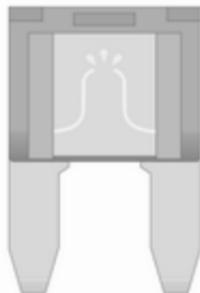
Je nach Ausführung lässt sich eine durchgebrannte Sicherung anhand des geschmolzenen Drahtes erkennen. Sicherung nur dann ersetzen, wenn die Ursache für die Störung behoben wurde.
