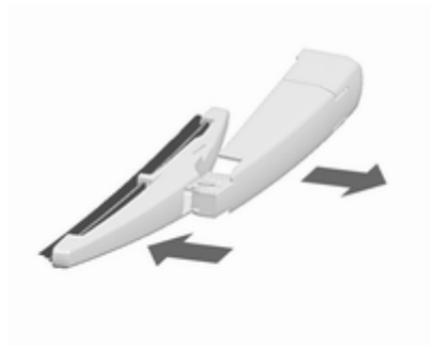
Wischerarm anheben. Das Wischerblatt im leichten Winkel zum Wischerarm nach unten drücken, bis es freigegeben wird.
