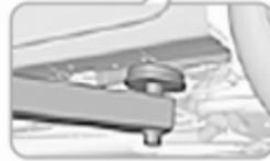
Position des hinteren Arms der Hebebühne, mittig unter der Aussparung im Schweller.
