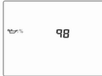
Zeigt die geschätzte Restlebensdauer des Öls an. Die Zahl in Prozent bedeutet die noch verbleibende Öllebensdauer und zeigt an, wann das Motoröl und der Filter gewechselt werden müssen ⇨ 68.
