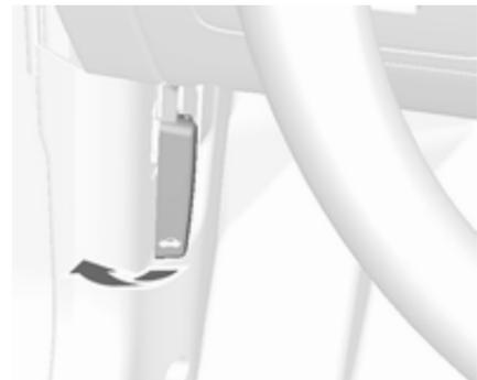
Entriegelungshebel ziehen und in die Ausgangsposition zurückführen.
