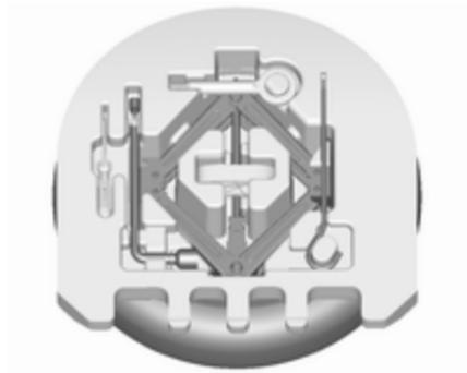
Der Wagenheber und das Wagenwerkzeug befinden sich im Laderaum.
