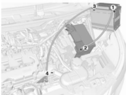
Reihenfolge für das Anschließen der Kabel:
