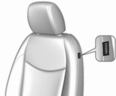
Das Seiten-Airbag-System besteht aus einem Airbag in der Rückenlehne jedes Vordersitzes. Diese Stelle ist durch das Wort **AIRBAG** gekennzeichnet.
