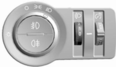
Zur Anpassung der Leuchtweite an die Fahrzeuglast, um Blendwirkung zu reduzieren: Daumenrädchen
