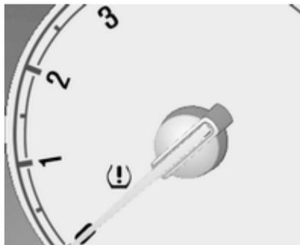
Wenn niedriger Reifendruck erkannt wird, wird dies durch die Kontrollleuchte
