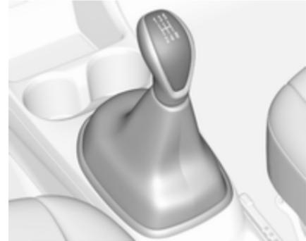
Zum Einlegen des Rückwärtsgangs das Kupplungspedal drücken und den Rückwärtsgang einlegen.
