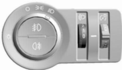
Zur Anpassung der Leuchtweite an die Fahrzeuglast, um Blendwirkung zu reduzieren: Daumenrädchen
