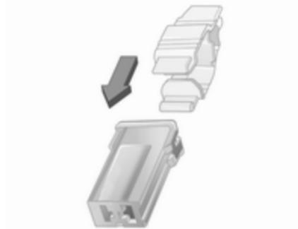
Den Sicherungszieher von oben auf die verschiedenen Arten von Sicherungen stecken und die Sicherung herausziehen.
