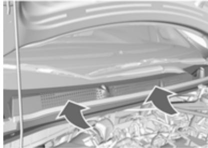
Der Luftreinlass im Motorraum außen vor der Windschutzscheibe muss zur Luftzufuhr frei sein. Gegebenenfalls Laub, Schmutz oder Schnee entfernen.
