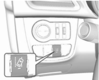
Die Spurverlassenswarnung wird durch Drücken von
