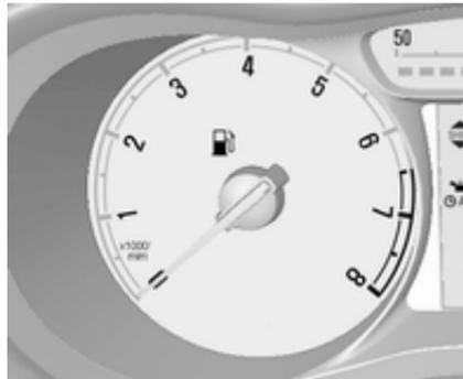
Bei geringem Füllstand leuchtet die Kontrollleuchte
