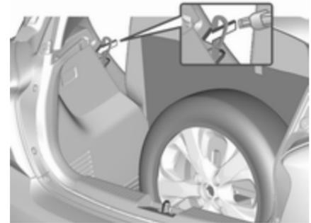
3. Das Gurtende mit der Schlaufe am Werkzeugkasten durch die Sitzlehnenrastung ziehen.
