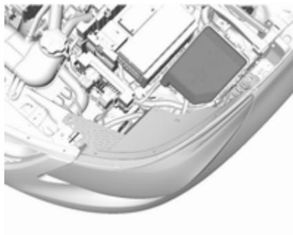
2. Abdeckung des Sicherungskastens entfernen (nur linke Fahrzeugseite).
