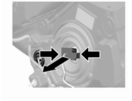
3. Beide Clips zusammendrücken und Steckeranschluss von der Glühlampe abziehen.
