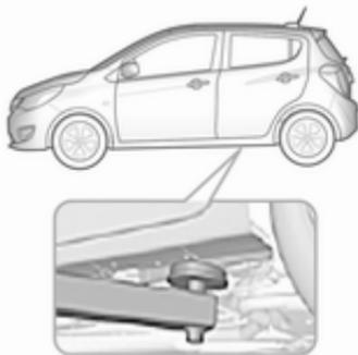
Position des hinteren Arms der Hebebühne, mittig unter der Aussparung im Schweller.
