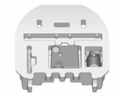
Das Wagenwerkzeug befindet sich im Stauraum unter der Bodenabdeckung des Laderaums.
