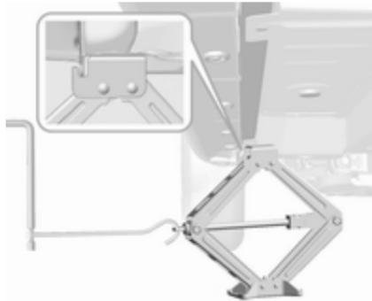
4. Wagenheber auf die erforderliche Höhe einstellen. Den Heber unmittelbar unter den Ansatzpunkt stellen und sicherstellen, dass er nicht rutschen kann. Kurbelstange anbringen und den korrekt ausgerichteten Wagenheber hochkurbeln, bis das Rad vom Boden abhebt.
