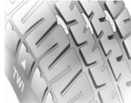
Die gesetzlich zulässige Mindestprofiltiefe (1,6 mm) ist erreicht, wenn das Profil bis zu einem Verschleißanzeiger (TWI = Tread Wear Indicator) abgefahren ist. Deren Lage wird durch Markierungen an der Reifenflanke angezeigt.
