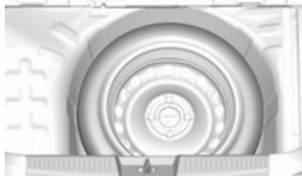
Das Reserverad befindet sich im Laderaum unter der Abdeckung des Laderaumbodens. Es ist mit einem Flügelbolzen in der Vertiefung fixiert.
