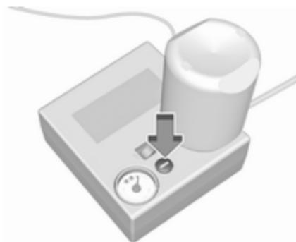
Wird der vorgeschriebene Reifendruck nicht innerhalb von 10 Minuten erreicht, Reifenreparaturset entfernen. Das Fahrzeug um eine Reifenumdrehung bewegen. Das Reifenreparaturset
