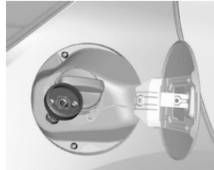
Den erforderlichen Adapter handfest auf den Einfüllstutzen schrauben.
