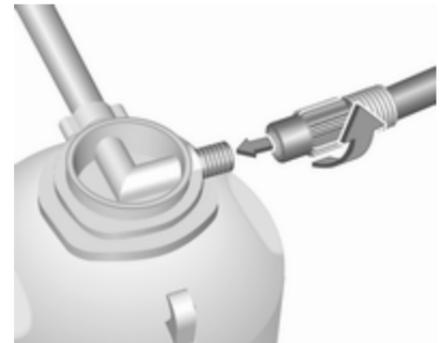
4. Kompressor-Luftschlauch an den Anschluss der Dichtmittelflasche schrauben.
