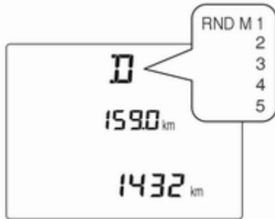
Im Automatikmodus wird das Fahrprogramm durch **D** im Driver Information Center angezeigt.
