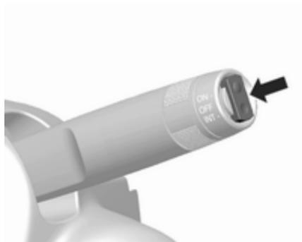
Zur Betätigung des Heckscheibenwischer Wippschalter drücken:
