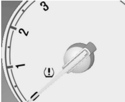
Wenn niedriger Reifendruck erkannt wird, wird dies durch die Kontrollleuchte (!) gemeldet ⇨ 76.
