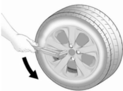
2. Radschraubenschlüssel ansetzen und sicherstellen, dass er gut sitzt. Die Radschrauben jeweils eine halbe Umdrehung lösen. Die Räder können mit Felgenschlössern verriegelt werden. Zum Lösen dieser Schrauben zuerst den Felgenschlossadapter anbringen und erst dann den Radschraubenschlüssel ansetzen. Der Adapter befindet sich im Handschuhfach.
