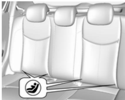
Für das Fahrzeug zugelassene ISOFIX-Kindersicherheitssysteme an ISOFIX-Befestigungshalterungen befestigen. Die speziellen Positionen für ISOFIX-Kindersicherheitssysteme sind in der Tabelle mit IL gekennzeichnet.
