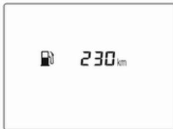
Die Reichweite wird aus dem momentanen Tankfüllstand und dem Momentanverbrauch errechnet. Die Anzeige erfolgt mit gemittelten Werten.
