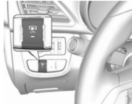
Durch Drücken von **LPG** wird zwischen Benzin- und Flüssiggasbetrieb umgeschaltet, sobald die erforderlichen Parameter (Kühlmitteltemperatur, Gastemperatur und Mindestdrehzahl des Motors) erreicht sind. Die Anforderungen sind normalerweise nach etwa 60 Sekunden (je nach Außentemperatur) und der ersten festen Betätigung des Gaspedals erreicht. Der LED-Status zeigt den aktuellen Betriebsmodus.
