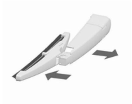
Wischerarm anheben. Das Wischerblatt im leichten Winkel zum Wischerarm nach unten drücken, bis es freigegeben wird.
