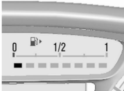
Die Anzahl der LEDs gibt den Füllstand im Kraftstofftank an.
