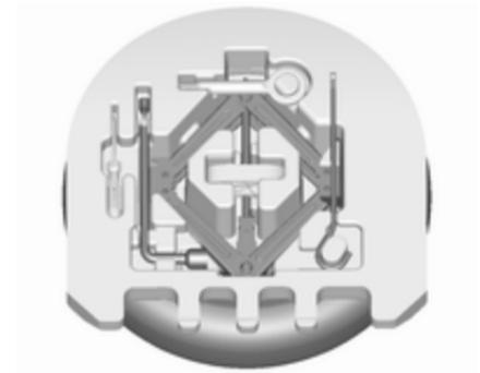
Der Wagenheber und das Wagenwerkzeug befinden sich im Laderaum.
