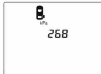
Reifendruck-Kontrollsystem durch Drehen des Einstellrädchens wählen. Systemstatus und Druckwarnungen werden durch eine Meldung und gleichzeitiges Blinken des betreffenden Reifens im Driver Information Center angezeigt.
