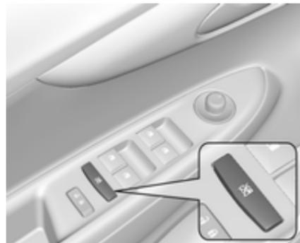
Zur Deaktivierung der elektrischen Fensterbetätigung der Hintertüren
