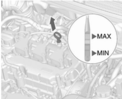
Messstab herausziehen, abwischen, vollständig einführen, erneut herausziehen und den Motorölstand ablesen.
