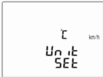
Taste **SET/CLR** drücken, während die Seite angezeigt wird. Durch Drehen des Einstellrädchens metrische Einheiten (Einheit 1) oder Einheiten des britischen Maßsystems (Einheit 2) auswählen. **SET/CLR** drücken, um die Maßeinheit festzulegen.
