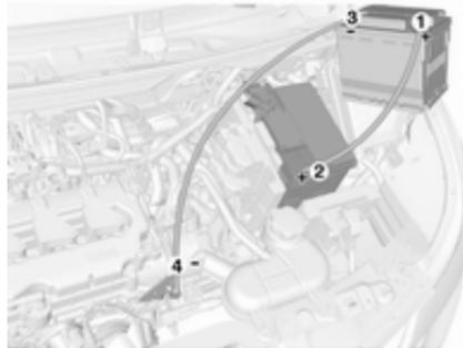
Reihenfolge für das Anschließen der Kabel:
