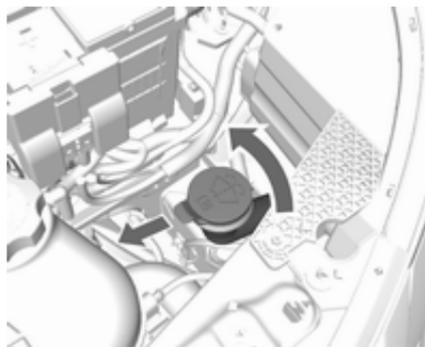
1. Linke Fahrzeugseite: Einfüllrohr drehen und aus dem Waschflüssigkeitsbehälter herausziehen.
