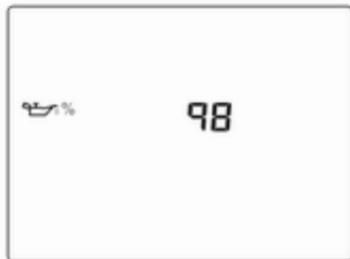
Zeigt die geschätzte Restlebensdauer des Öls an. Die Zahl in Prozent bedeutet die noch verbleibende Öllebensdauer und zeigt an, wann das Motoröl und der Filter gewechselt werden müssen ⇨ 69.
