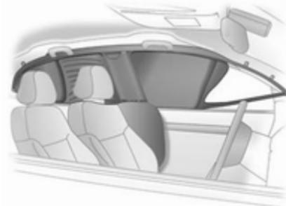
Der aufgeblähte Airbag dämpft den Aufprall, wodurch die Verletzungsfahr für den Kopf bei einem Seitenaufprall deutlich verringert wird.
