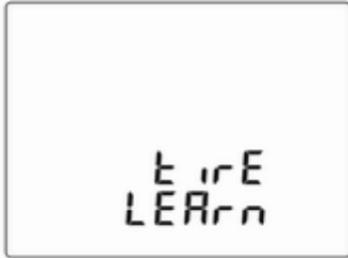
Dieser Menüpunkt dient dem Abgleichen eines neuen Reifen/neuen Rads mit den Sensoren des Reifendruck-Kontrollsystems ↷ 162.
