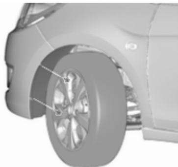
1. Das Rad drehen und die zwei Steckmutter an der Außenseite der Radblende abnehmen.
