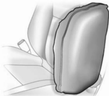
Der aufgeblähte Airbag dämpft den Aufprall, wodurch die Verletzungsfahr für Oberkörper und Becken bei einem Seitenaufprall deutlich verringert wird.
