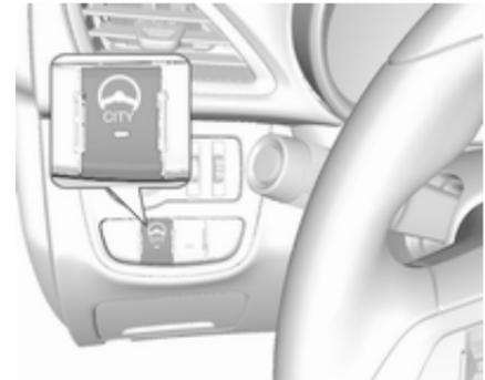
Bei laufendem Motor
