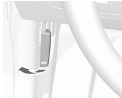
Entriegelungshebel ziehen und in die Ausgangsposition zurückführen.
