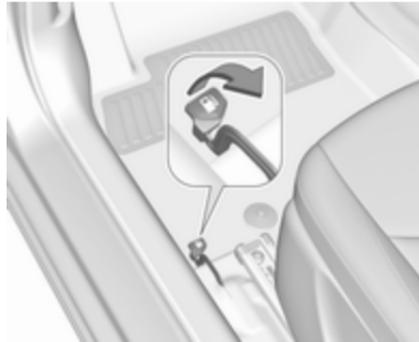
2. Die Tankklappe öffnen, indem der Entriegelungshebel am Fußboden links vorne beim Fahrersitz hochgezogen wird.
