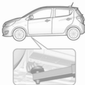
Position des vorderen Arms der Hebebühne am Unterboden.
