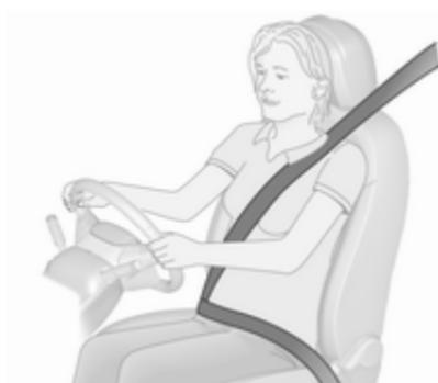
Sicherheitsgurt herausziehen und im Gurtschloss einrasten. Der Sicherheitsgurt muss unverdreht und eng am Körper anliegen. Die Rückenlehne darf nicht zu weit nach hinten geneigt sein (maximal ca. 25°).
