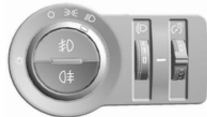
Wird durch Drücken von  $\text{D}$  bedient. Lichtschalter in Position  $\Rightarrow \Leftarrow$ : Die Nebelschlussleuchte kann nur gemeinsam mit den Nebelleuchten eingeschaltet werden.
