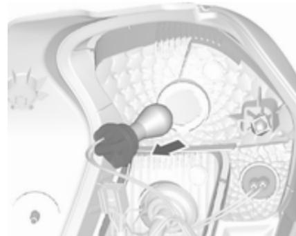
5. Lampenfassung herausnehmen. Glühlampe etwas in die Fassung hineindrücken, links herumdrehen und herausnehmen. Neue Glühlampe einsetzen.
