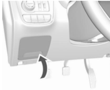
Der Sicherungskasten befindet sich auf der Fahrerseite hinter einer Abdeckung in der Instrumententafel.
