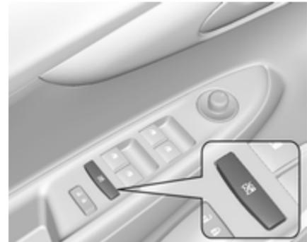
Zur Deaktivierung der elektrischen Fensterbetätigung der Hintertüren
