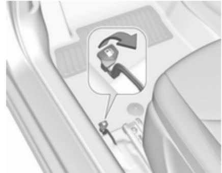
2. Die Tankklappe öffnen, indem der Entriegelungshebel am Fußboden links vorne beim Fahrersitz hochgezogen wird.
