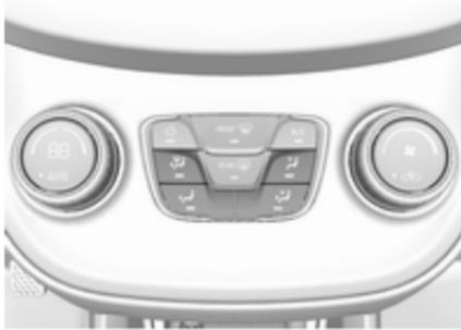
Entsprechende Taste für die gewünschte Einstellung drücken. Die Betätigung wird durch die LED in der Taste angezeigt.
