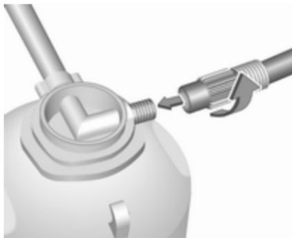
4. Luftschlauch des Kompressors an den Anschluss der Dichtmittelflasche schrauben.
