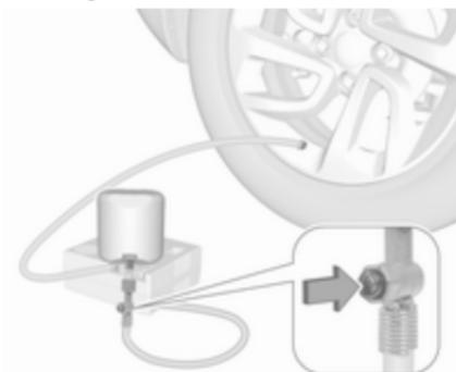
Je nach Ausführung kann sich der Knopf am Luftschlauch befinden. Kompressor nicht länger als 10 min laufen lassen.
