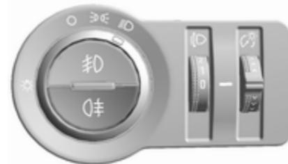
Wird durch Drücken von  $0\#$  bedient. Lichtschalter in Position  $\Rightarrow\Leftarrow$ : Die Nebelschlussleuchte kann nur gemeinsam mit den Nebelleuchten eingeschaltet werden.
