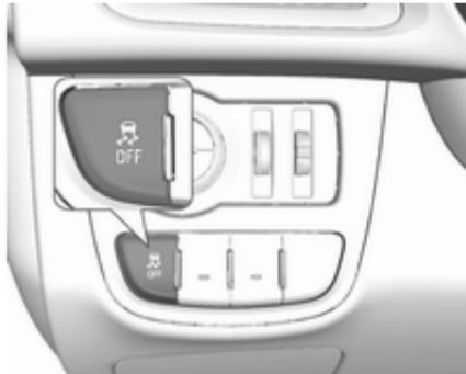
Die Traktionskontrolle kann ausgeschaltet werden, wenn ein Durchdrehen der Antriebsräder erwünscht ist:
