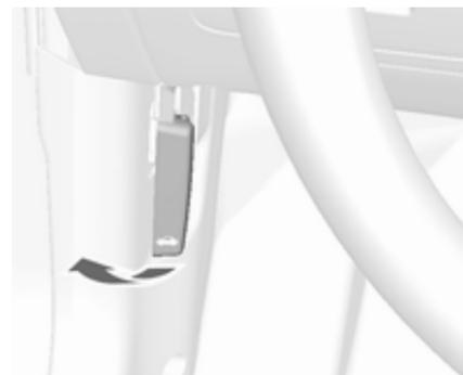
Entriegelungshebel ziehen und in die Ausgangsposition zurückführen.
