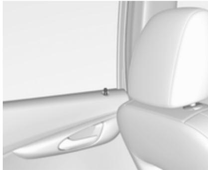
Zum Entriegeln einer hinteren Tür den inneren Verriegelungsknopf an der entsprechenden Tür ziehen. Tür durch Ziehen am Griff öffnen.
