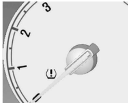
Wenn niedriger Reifendruck erkannt wird, wird dies durch die Kontrollleuchte
