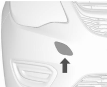
1. Die Spitze eines Schlitzschraubendrehers mit einem Tuch umwickeln, um den Lack zu schützen. Abdeckung mit einem Schraubenzieher lösen und abnehmen.
