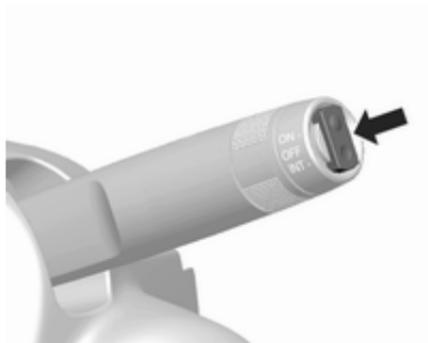
Zur Betätigung des Heckscheibenwischers Wippschalter drücken:
