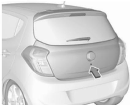
Zum Entriegeln der Hecktür den Schlüssel in das Schloss einstecken und nach links in die horizontale Position drehen. Die Hecktür zum Öffnen anheben.
