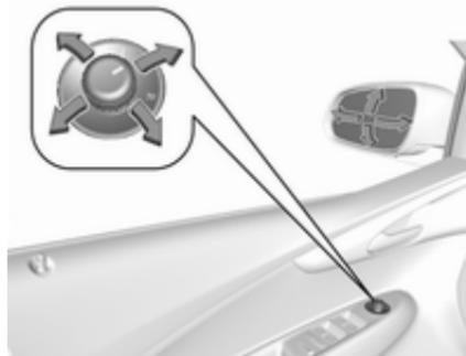
Entsprechenden Außenspiegel durch Drehen des Schalters nach links (L) oder rechts (R) auswählen. Danach das Bedienelement schwenken, um den Spiegel einzustellen.
