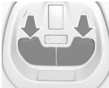
Bedienung durch Drücken der Tasten an der Vorderseite.
