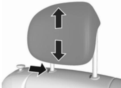
Kopfstütze nach oben ziehen und einrasten lassen. Zum Absenken auf die Verriegelung drücken und die Kopfstütze nach unten drücken.
