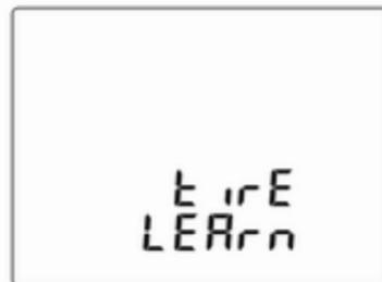
Dieser Menüpunkt dient dem Abgleichen eines neuen Reifen/neuen Rads mit den Sensoren des Reifendruckkontrollsystems ↷ 153.
