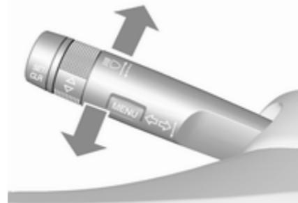
Zum Umschalten von Abblendlicht auf Fernlicht den Hebel nach vorne drücken.
