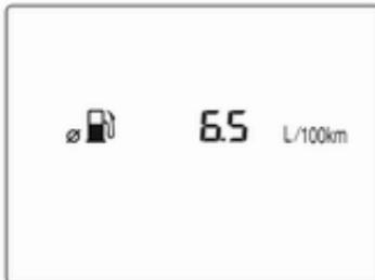
Anzeige des Durchschnittsverbrauchs. Die Messung kann jederzeit zurückgesetzt werden und beginnt mit einem voreingestellten Wert.
