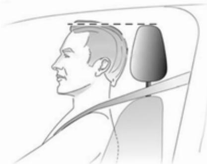
Die Oberkante der Kopfstütze sollte mit der Oberkante des Kopfes abschließen. Ist dies bei sehr großen Personen nicht möglich, höchste Position einstellen, bei sehr kleinen Personen tiefste Position.
