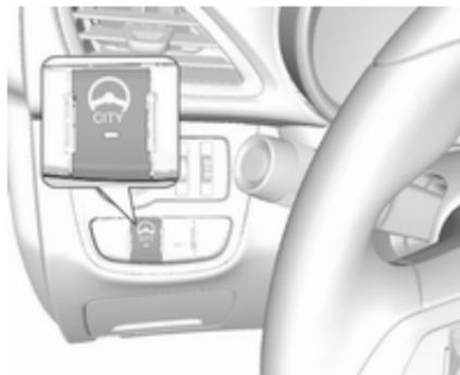
Bei laufendem Motor
