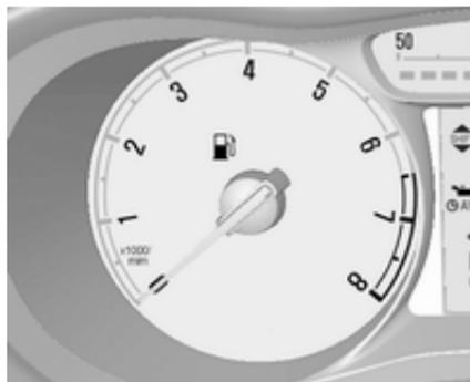
Bei geringem Füllstand leuchtet die Kontrollleuchte
