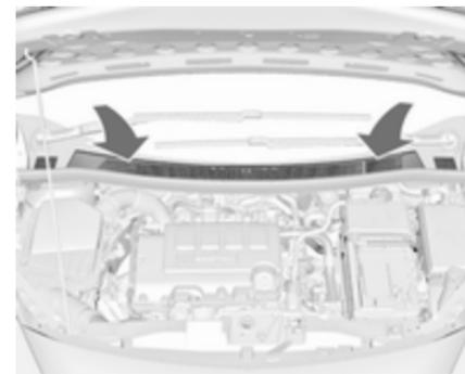
Der Lufteinlass im Motorraum außen vor der Windschutzscheibe muss zur Luftzufuhr frei sein. Gegebenenfalls Laub, Schmutz oder Schnee entfernen.
