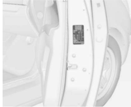
Reifendruck  $\varnothing$  207 und auf dem Aufkleber an der Beifahrertür.
