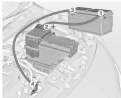
Reihenfolge für das Anschließen der Kabel:
