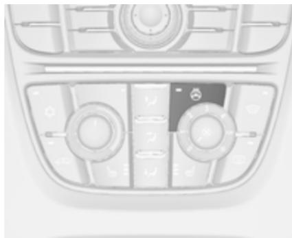
Die Heizung durch Drücken der Taste
