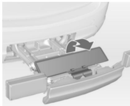
Den Halter für das Nummernschild ausklappen.
