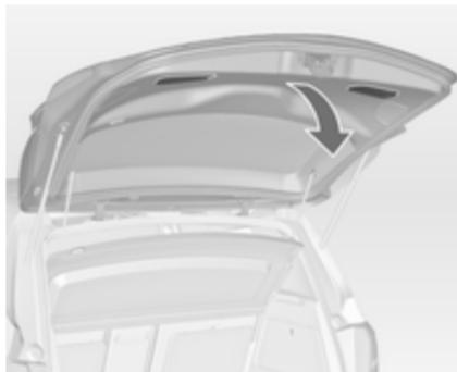
Einen der Innengriffe verwenden. Während die Hecktür zugeklappt wird, den Touchpad-Schalter unter der Leiste nicht drücken, da sonst die Hecktür erneut entriegelt wird.
