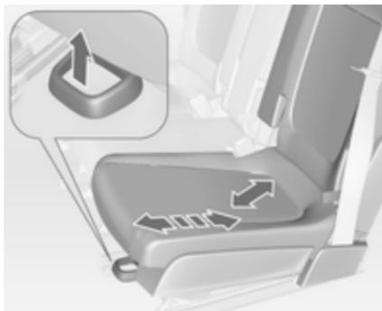
Die äußeren Rücksitze lassen sich einzeln nach vorn oder hinten verschieben. Sie sind in Längs- und Querrichtung verschiebbar.
