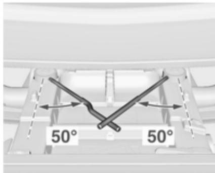
Das Heckträgersystem ist verriegelt, wenn die Spannhelme um ca. 50° angezogen wurden. Andernfalls ist der sichere Betrieb nicht gewährleistet.
