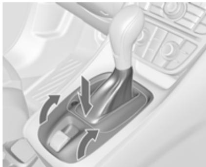
2. An der angegebenen Stelle an der Wählhebelverkleidung ziehen, um sie an der Rückseite zu lösen.
