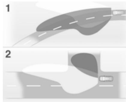
Der Lichtkegel wird in Abhängigkeit von Lenkradstellung und Geschwindigkeit geschwenkt.
