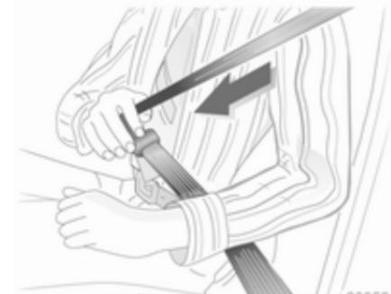
Den Gurt aus dem Aufroller herausziehen, unverdreht über den Körper legen und die Schlosszunge in das Gurtschloss einstecken, bis sie einrastet. Den Beckengurt während der Fahrt durch Ziehen am Schultergurt regelmäßig spannen.
