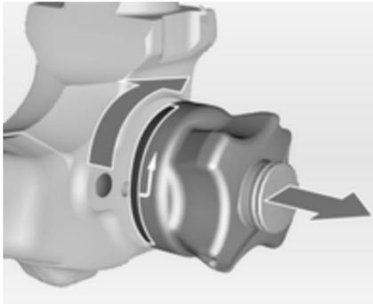
Drehgriff herausziehen und bis zum Anschlag nach rechts drehen.
