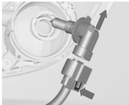
2. Die Lampenfassung durch Drücken der Haltenase vom Stecker lösen.
