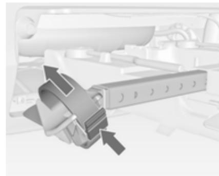
Den Entriegelungshebel am Spannband drücken und das Spannband herausziehen.
