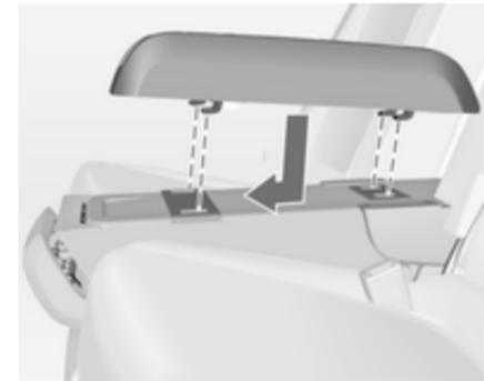
Die Haken des Adapters in die Aussparungen der Lehne einsetzen und den Adapter nach vorn drücken.
