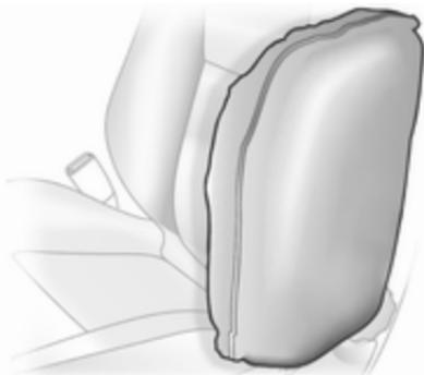
Der aufgeblähte Airbag dämpft den Aufprall, wodurch die Verletzungsgefahr für Oberkörper und Becken bei einem Seitenaufprall deutlich verringert wird.
