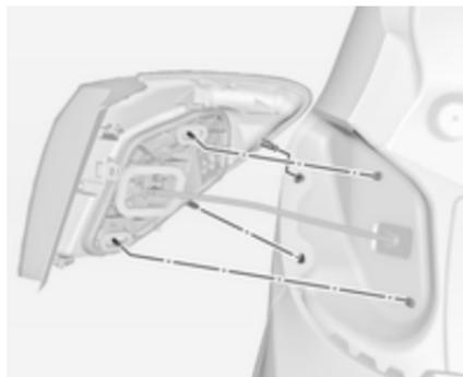
3. Das Lampengehäuse vorsichtig von den Haltestiften abziehen und herausnehmen. Darauf achten, dass der Kabelkanal nicht verschoben wird.
