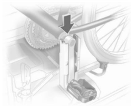
Das Fahrrad aufsetzen. Dabei muss die Tretkurbel wie in der Abbildung dargestellt in den Schacht der Tretkurbelaufnahme gesetzt werden.
