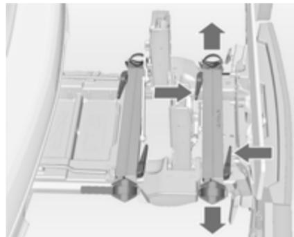
Den Entriegelungshebel drücken und die Radaufnahmen herausziehen.
