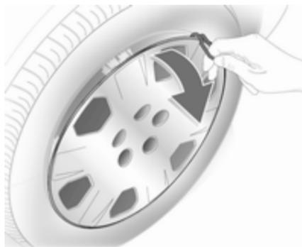
1. Radabdeckung mit dem Haken abziehen. Wagenwerkzeug ⇨ 175.
