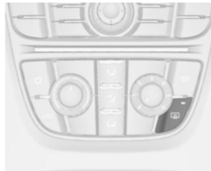
Wird durch Drücken der Taste
