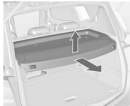
Abdeckung hinten anheben und an der Vorderseite nach oben drücken.
