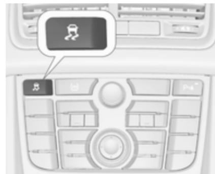
Die Traktionskontrolle kann ausgeschaltet werden, wenn ein Durchdrehen der Antriebsräder erwünscht ist: Taste
