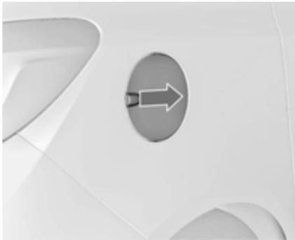
Die Tankklappe lässt sich nur bei entriegeltem Fahrzeug öffnen. Die Klappe an der Aussparung ziehen und öffnen.
