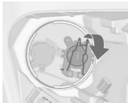
3. Die Federklammer lösen und nach hinten schwenken.
