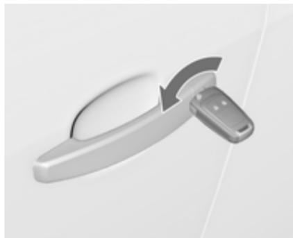
Fahrtür durch Drehen des Schlüssels im Schloss manuell entriegeln. Zündung einschalten und Zentralverriegelungstaste drücken, um alle Türen, Laderaum und Tankklappe zu entriegeln. Durch Einschalten der Zündung wird die Diebstahlsicherung deaktiviert ⇨ 27.
