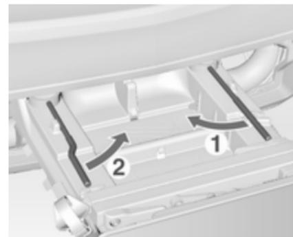
Zuerst den rechten Spannhebel (1), danach den linken Spannhebel (2) umlegen, bis ein Widerstand zu spüren ist.
