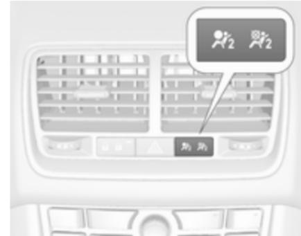
Solange die Kontrollleuchte
