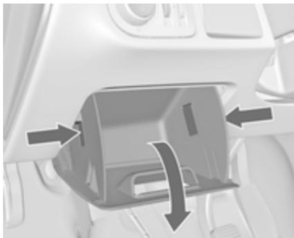
Der Sicherungskasten befindet sich hinter dem Staufach in der Instrumententafel.
