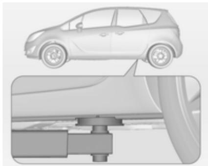
Den hinteren Arm der Hebebühne am Unterboden ansetzen.
