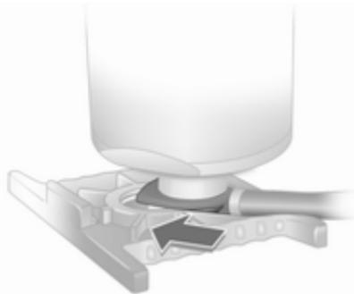
3. Die Dichtmittelflasche auf der Halterung platzieren. Sicherstellen, dass die Flasche nicht herunterfällt.
