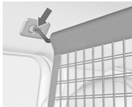
Im Dachrahmen befinden sich zwei Einbauöffnungen: Stange für das Netz an einer Seite einhängen, nach vorn drücken und einrasten lassen. Stange ausziehen, an der anderen Seite einhängen, nach vorn drücken und einrasten lassen.
