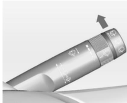
Hebel drücken. Waschflüssigkeit spritzt auf die Heckscheibe und der Wischer wird für einige Wischbewegungen eingeschaltet.
