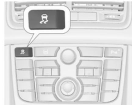
Für extremes Hochleistungsfahren kann ESC deaktiviert werden: Taste
