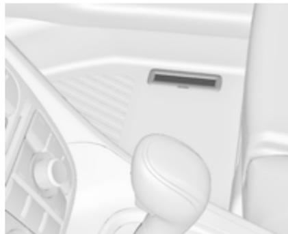
Die Fahrzeug-Identifizierungsnummer ist in das Typschild und die Bodenwanne (unter der Bodenabdeckung, sichtbar unter einer Abdeckung) eingestanzt.
