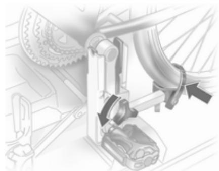
Spannbänder an beiden Fahrradreifen lösen.
