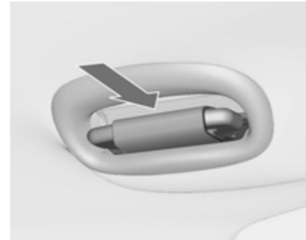
Den Sicherheitsgurthalter in das Dach schieben. Dabei muss die untere Schlosszunge nach vorn zeigen.
