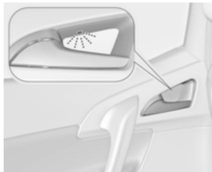
Grüne LEDs zeigen an, dass ein Öffnen von innen möglich ist:
