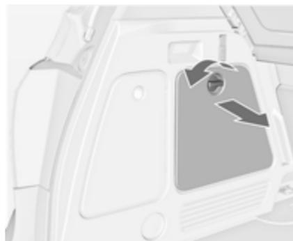
Den Riegel nach links drehen und die Abdeckung nach unten klappen.
