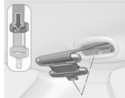
Die obere Schlosszunge in die Halterung drücken. Die zusammengesteckten Schlossungen an den Sicherheitsgurt klappen.
