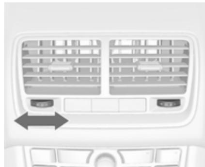
Zum Öffnen der Düse das Einstellrad nach rechts drehen. Durch Drehen am Einstellrad die Luftmenge an der Düse einstellen.
