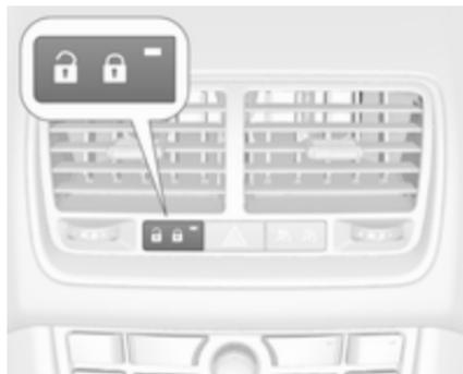
Die Zentralverriegelungstaste drücken: Die Türen werden ver- oder entriegelt. Wenn die Türen verriegelt werden, leuchtet die LED in der Taste.
