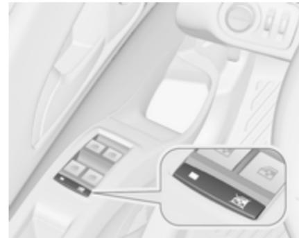
Zur Deaktivierung der elektrischen Fensterbetätigung der Hintertüren Schalter
