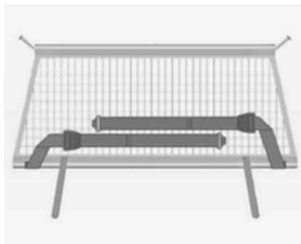
Spanngurte wie in der Abbildung dargestellt legen und am Netz ausrichten.
