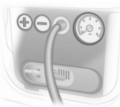
8. Am Kompressor Knopf **+** drücken. Der Reifen wird mit Dichtmittel gefüllt.
