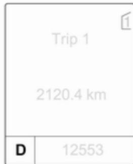
Im Getriebe-Display werden Modus oder gewählter Gang angezeigt.
