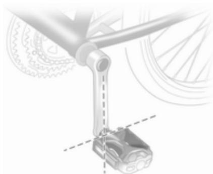
Das linke Pedal (ohne Kettenblatt) senkrecht nach unten drehen. Das Pedal an der linken Tretkurbel muss waagrecht stehen.
