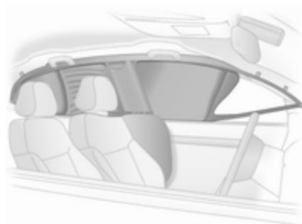
Der aufgeblähte Airbag dämpft den Aufprall, wodurch die Verletzungsgefahr für den Kopf bei einem Seitenaufprall deutlich verringert wird.
