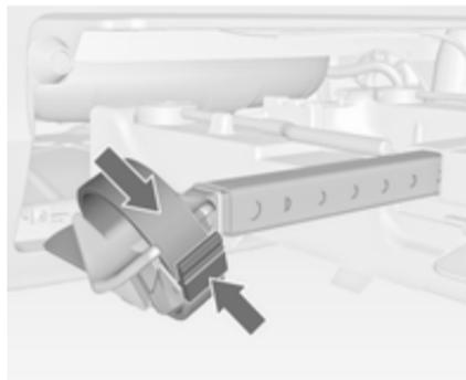
Das Spannband einführen und so weit wie möglich nach unten festziehen.
