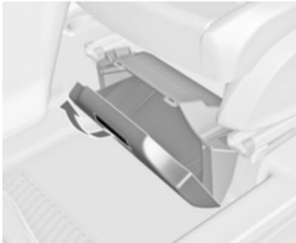
Je nach Fahrzeug befindet sich unter dem Fahrersitz ein Kasten. Am Griff ziehen und die Abdeckung nach unten klappen. Maximales Tragvermögen: 1,5 kg.
