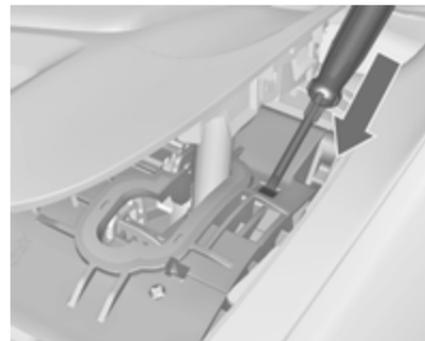
5. In die Öffnung so weit wie möglich einen Schraubendreher einführen und den Wählhebel aus **P** oder **N** schieben. Wenn **P** oder **N** erneut eingelegt wird, wird der Wählhebel erneut gesperrt. Ursache für die Stromunterbrechung von einer Werkstatt beheben lassen.
