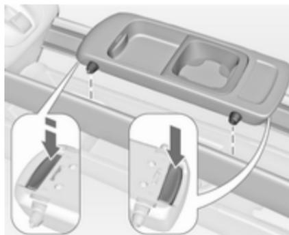
Die Knöpfe an der Vorder- und Rückseite drücken und die Führungsstifte in die obere bzw. untere Führungsschiene einsetzen. Der vordere Knopf muss fest gedrückt werden. Die Knöpfe loslassen und den Getränkehalter bewegen, bis er hörbar einrastet.
