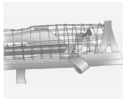
Die obere Netzstange nach unten bis knapp über die Mitte rollen.
