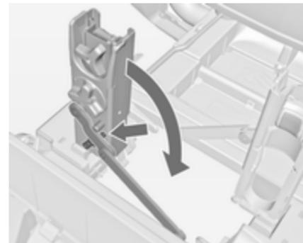
Den Arretierungshebel an der diagonalen Stütze ausrasten und beide Tretkurbelaufnahmen nach unten klappen.
