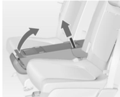
Am Band ziehen und den mittleren Sitz nach oben klappen.
