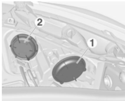
Scheinwerfer haben getrennte Systeme für Ablend- und Fernlicht 1 (äußere Lampen) sowie zusätzliches Fernlicht 2 (innere Lampen). Das Abbiegelicht befindet sich ebenfalls hinter der Abdeckung für das zusätzliche Fernlicht.
