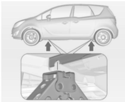
3. Sicherstellen, dass der Wagenheber richtig an den Anhebe­punkten des Fahrzeugs sitzt.
