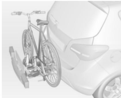
Das Heckträgersystem (Flex-Fix-System) bietet die Möglichkeit, Fahrräder auf einem in den Fahrzeugboden integrierten herausziehbaren Träger zu befestigen.
