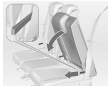
Am Griff an der Vorderseite der Lehne ziehen und die Lehne auf die Sitzfläche klappen. Der Sitz wird automatisch abgesenkt.
