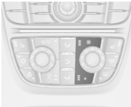
Mit der unteren Taste
