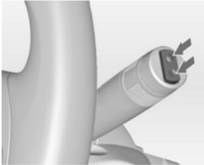
Zur Betätigung des Heckscheibenwischers Wippschalter drücken:
