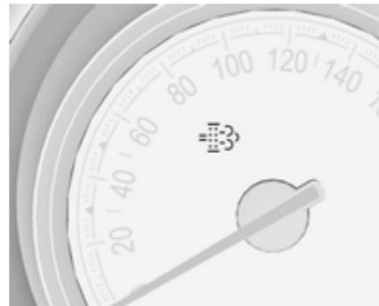
Unter bestimmten Fahrbedingungen, z. B. Kurzstreckenverkehr, kann sich das System nicht automatisch reinigen.
