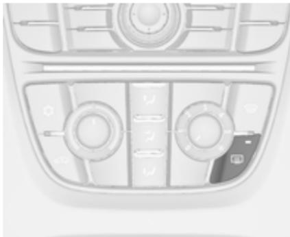
Die Heizung wird durch Drücken der Taste
