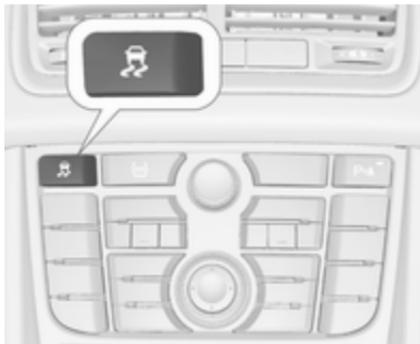
Die Traktionskontrolle kann ausgeschaltet werden, wenn ein Durchdrehen der Antriebsräder erwünscht ist: Taste
