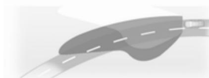
Der Lichtstrahl wird auf Basis des Lenkradwinkels und der Geschwindigkeit geschwenkt, was die Ausleuchtung von Kurven verbessert.
