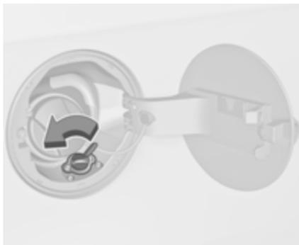
Die Schutzkappe vom Einfüllstutzen abschrauben.
