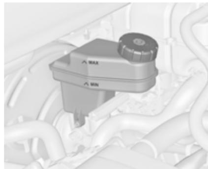
Der Bremsflüssigkeitsstand muss zwischen **MIN** und **MAX** liegen.
