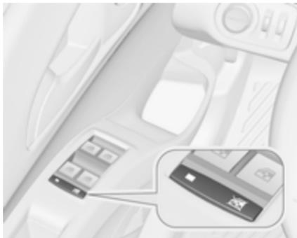
Zur Deaktivierung der elektrischen Fensterbetätigung der Hintertüren Schalter
