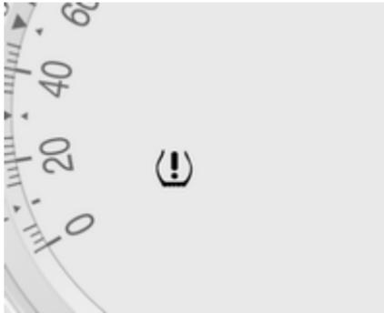
Wenn niedriger Reifendruck erkannt wird, wird dies durch die Kontrollleuchte (⚠) gemeldet ⇨ 104.
