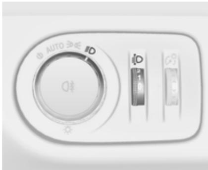
Zur Anpassung der Leuchtweite an die Fahrzeugbeladung, um Blendwirkung zu reduzieren: Daumenrad
