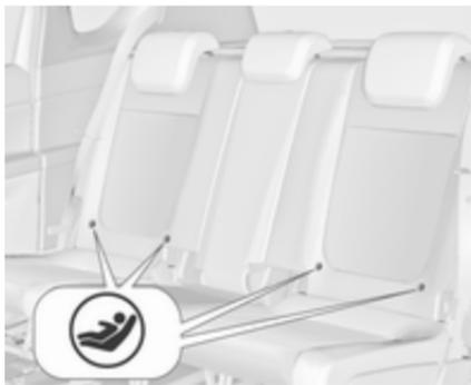
Für das Fahrzeug zugelassene ISOFIX Kindersicherheitssysteme an ISOFIX Befestigungsbügeln befestigen. Die speziellen Positionen für ISOFIX Kindersicherheitssysteme sind in der Tabelle mit IL gekennzeichnet.
