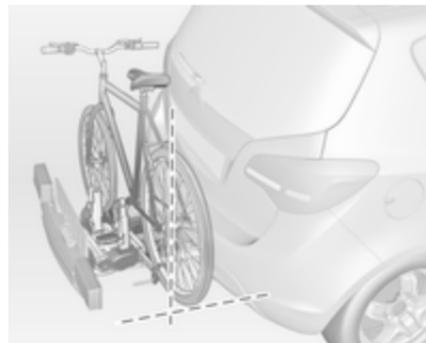
Fahrrad in Fahrzeuginnenrichtung ausrichten: Tretlagerfixierung etwas lösen.
