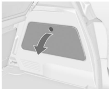
Zum Öffnen des Staufachs je nach Ausführung die Abdeckung ausrasen und öffnen bzw. die Bodenabdeckung anheben.
