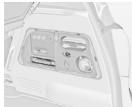
Ausführung 1: Das Wagenwerkzeug befindet sich neben dem Reifenreparaturset im rechten Fach im Laderaum.
