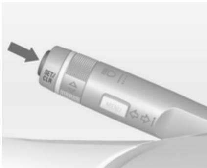
Zum Zurücksetzen des Tageskilometerzählers die Taste **SET/CLR** am Blinkerhebel einige Sekunden lang gedrückt halten oder bei Fahrzeugen mit einer Rückstelltaste diese in der Nähe des Tachometers einzeln für die ausgewählte Seite 1 oder 2 drücken.
