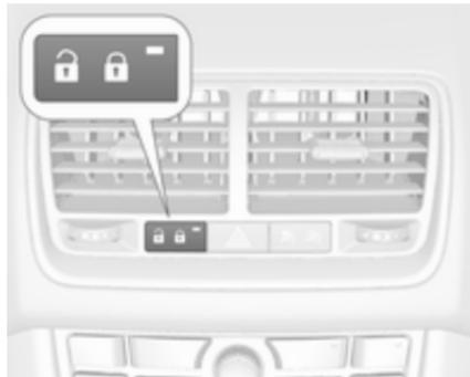
Die Zentralverriegelungstaste drücken: Die Türen werden ver- oder entriegelt. Wenn die Türen verriegelt sind, leuchtet die LED in der Taste.
