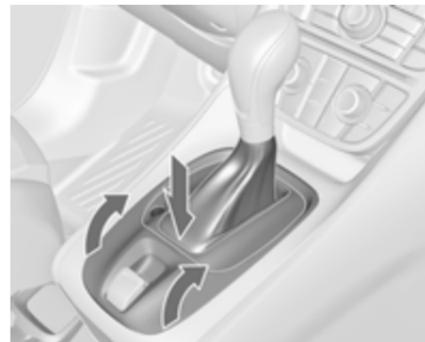
2. Die Wählhebelverkleidung an der angegebenen Stelle fassen, um sie an der Rückseite zu lösen.
