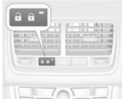
In der Zentralverriegelungstaste befindet sich eine Status-LED.
