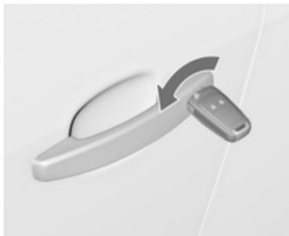
Fahrtür durch Drehen des Schlüssels im Schloss manuell entriegeln. Zündung einschalten und Zentralverriegelungstaste drücken, um alle Türen, Laderaum und Tankklappe zu entriegeln.
