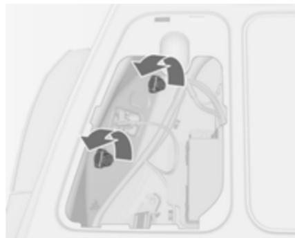
2. Die zwei Kunststoff-Befestigungsmuttern von innen mit der Hand abschrauben.
