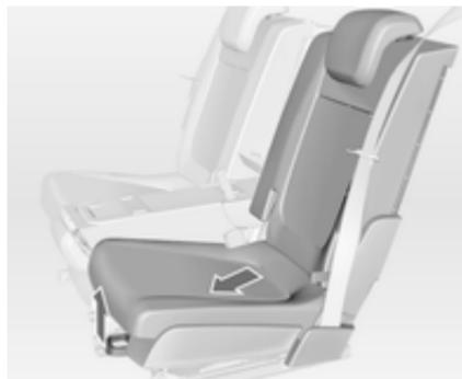
Am Griff ziehen und den Sitz schräg nach vorne in Position 2 schieben. Der Sitz gleitet automatisch nach außen. Den Griff loslassen und den Sitz einrasten lassen.
