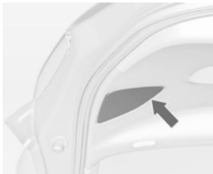
1. Die Hecktür öffnen und die Abdeckung mit einem Schraubendreher lösen.
