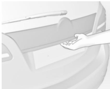
Nach dem Entriegeln den Touchpad-Schalter unter der Leiste der Hecktür betätigen und die Hecktür öffnen.
