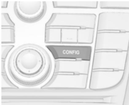
Drücken Sie die Taste **CONFIG** an der Frontplatte des Infotainment Systems, um das Menü **Einstellungen** zu öffnen.
