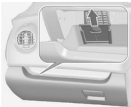
In Rechtslenkern befindet sich der Sicherungskasten hinter einer Abdeckung im Handschuhfach. Das Handschuhfach öffnen, den Deckel nach oben ziehen und abnehmen.
