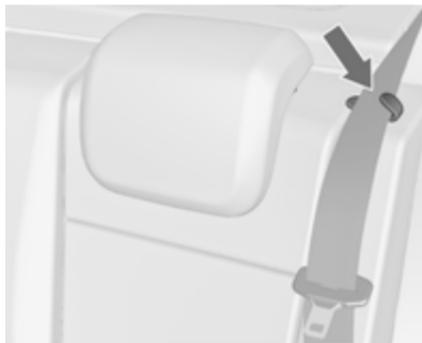
Den Sicherheitsgurt aus der Halterung an der Lehne nehmen.
