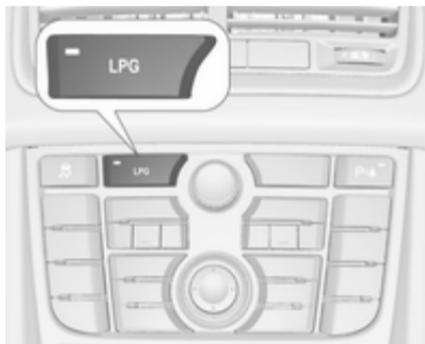
Durch Drücken der Taste **LPG** kann zwischen Benzin- und Flüssiggasbetrieb umgeschaltet werden. Die LED-Leuchte ● zeigt den aktuellen Betriebsmodus.
