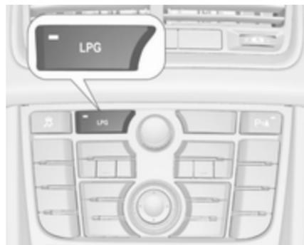
Durch Drücken der Taste **LPG** wird zwischen Benzin- und Flüssiggasbetrieb umgeschaltet, sobald die erforderlichen Parameter (Kühlmitteltemperatur, Gastemperatur und Mindest-drehzahl des Motors) erreicht sind. Die Anforderungen sind normalerweise nach etwa 60 Sekunden (je nach Außentemperatur) und der ers-
