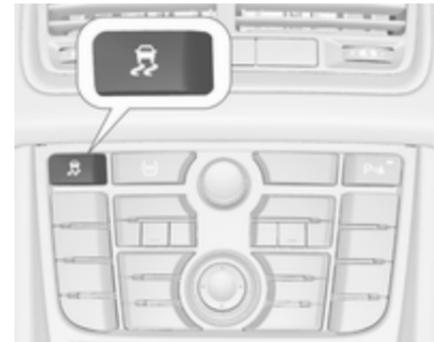
Für extremes Hochleistungsfahren kann ESC deaktiviert werden: Taste
