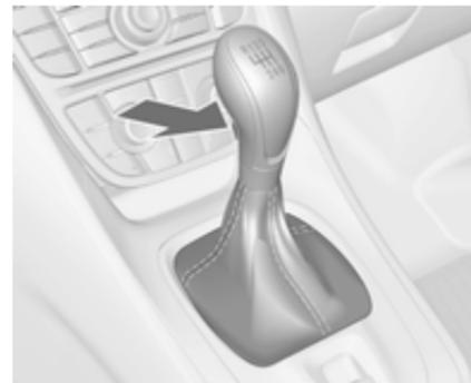
Rückwärtsgang: Bei stehendem Fahrzeug das Kupplungspedal durchtreten und dann 3 Sekunden warten. Anschließend den Entriegelungsknopf am Wählhebel betätigen und den Gang einlegen.
