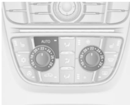
Ist die Mindesttemperatur **Lo** eingestellt, läuft die Klimaanlage mit maximaler Kühlung, sofern die Kühlung
