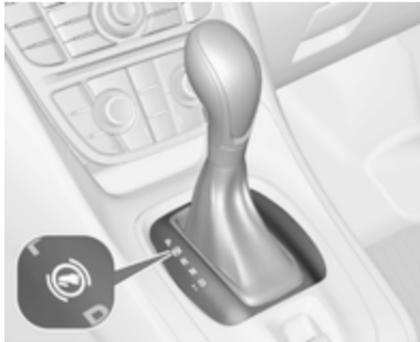
Bei nicht betätigtem Bremspedal leuchtet die Kontrollleuchte
