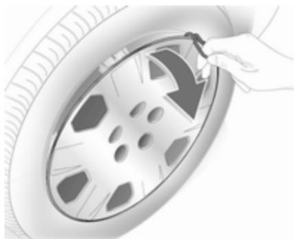
1. Radabdeckung mit dem Haken abziehen. Wagenwerkzeug ↗ 203.
