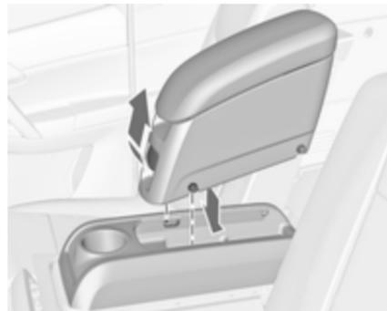
Den vorderen Knopf drücken und die vorderen Führungsstifte in die Führungsschienen einsetzen. Die Armlehne bewegen, bis sie hörbar einrastet. Den Knopf loslassen.
