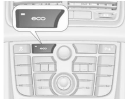
Die Stopp-Start-Automatik lässt sich durch Drücken der Taste **eco** manuell deaktivieren. Bei Deaktivierung erlischt die LED in der Taste.
