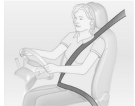
Bei starker Beschleunigung oder Verzögerung des Fahrzeugs blockieren die Sicherheitsgurte, um die Insassen in Sitzposition zu halten. Daher ist die Verletzungsgefahr deutlich geringer.
