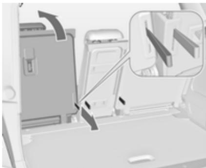
Am Griff an der Rückseite der Rückenlehne ziehen und die Rückenlehne nach unten klappen.
