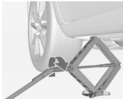
Radschlüssel ansetzen und den korrekt ausgerichteten Wagenheber hochkurbeln, bis das Rad vom Boden abhebt.
