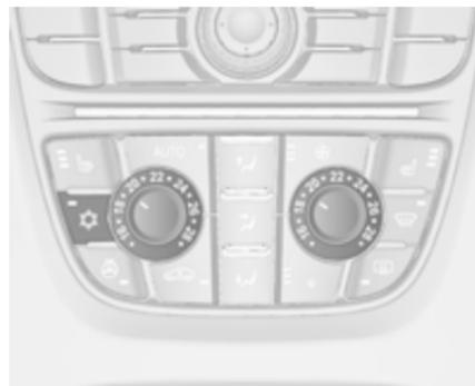
Taste ☀ drücken, um die Kühlung einzuschalten. Die Betätigung wird durch die LED auf der Taste ange-
