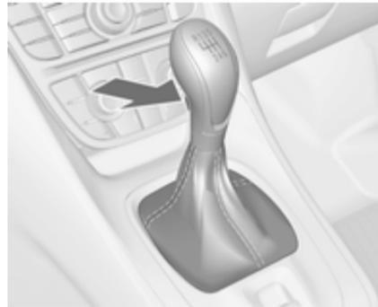
Zum Einlegen des Rückwärtsgangs nach Betätigen des Kupplungspedals bei stehendem Fahrzeug 3 Sekunden warten, anschließend den Entriegelungsknopf am Wählhebel drücken und den Gang einlegen. Lässt sich der Gang nicht einlegen, den Wählhebel in Leerlaufstellung führen, das Kupplungspedal loslassen und wieder betätigen. Nochmals schalten.
