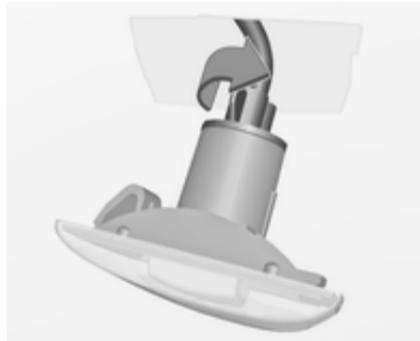
2. Lampenfassung nach links drehen, um sie aus dem Gehäuse zu entfernen.
