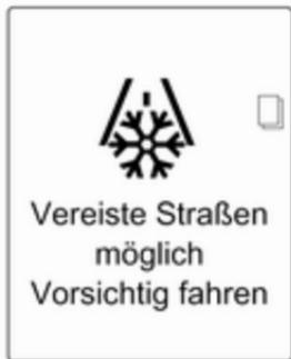
Wenn die Außentemperatur auf 3 °C sinkt, wird im Driver Information Center mit Uplevel-Display oder Uplevel-Kombi-Display eine Warnmeldung angezeigt.
