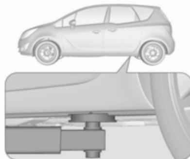
Anhebestelle für hinteren Arm der Hebeplattform am Unterboden.
