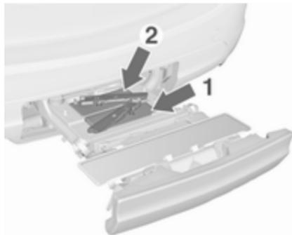
Zuerst die hintere Rückleuchte (1), dann die vordere (2) Rückleuchte aus den Ablagemulden entnehmen.
