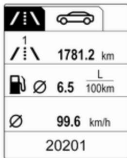
Im Uplevel-Kombi-Display können Menüseiten durch Drücken von **MENU** am Blinkerhebel ausgewählt werden. Folgende Menüsymbole werden in der obersten Displayzeile angezeigt:
