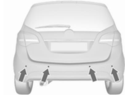
Das System besteht aus vier Ultraschall-Parksensoren im hinteren Stoßfänger. Wenn das Fahrzeug vorn mit Einparkhilfe ausgestattet ist, besteht das System aus vier zusätzlichen Ultraschall-Parksensoren im vorderen Stoßfänger.
