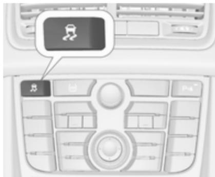
Die Traktionskontrolle kann ausgeschaltet werden, wenn ein Durchdrehen der Antriebsräder erwünscht ist:
