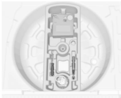
Ausführung 2: Das Wagenwerkzeug befindet sich neben dem Reifenreparaturset im Staufach unter der Bodenabdeckung.
