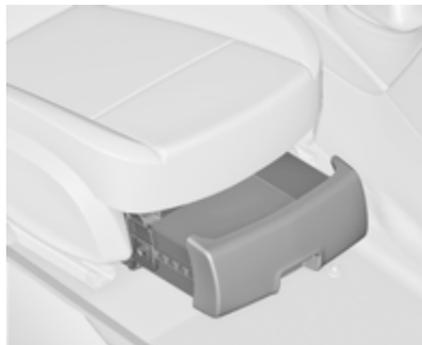
Ablagefach an Griffmulde anheben und herausziehen. Maximales Tragvermögen: 3 kg. Zum Schließen das Schubfach hineindrücken und einrasten lassen.
