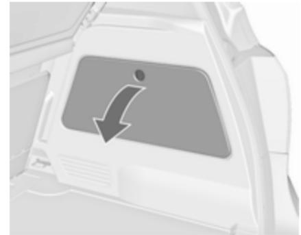
Zum Öffnen des Staufachs je nach Ausführung die Abdeckung ausrasten und öffnen bzw. die Bodenabdeckung anheben.
