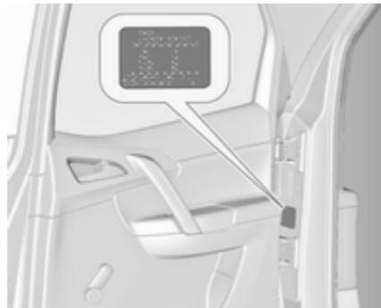
Das Typschild befindet sich am rechten Hinter- oder Vordertürrahmen.
