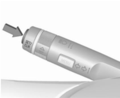
Zum Zurücksetzen des Tageskilometerzählers **SET/CLR** am Blinkerhebel einige Sekunden lang gedrückt halten oder bei Fahrzeugen mit einer Rückstelltaste diese in der Nähe des Tachometers einzeln für die ausgewählte Seite 1 oder 2 drücken.
