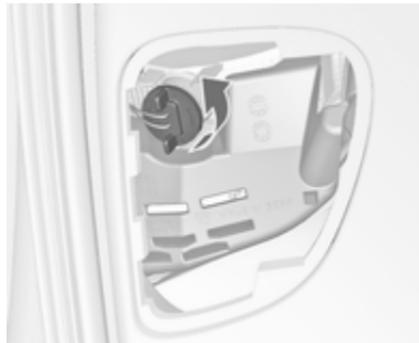
2. Die Lampenfassung durch Drehen nach links lösen. Lampenfassung heraus ziehen.
