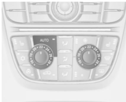
Ist die Mindesttemperatur **Lo** eingestellt, läuft die Klimaanlage mit maximaler Kühlung, sofern die Kühlung
