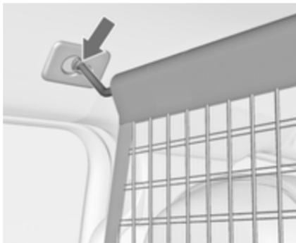
Im Dachrahmen befinden sich zwei Einbauöffnungen: Stange für das Netz an einer Seite eingehängen, nach vorn drücken und einrasten lassen. Stange ausziehen, an der anderen Seite eingehängen, nach vorn drücken und einrasten lassen.
