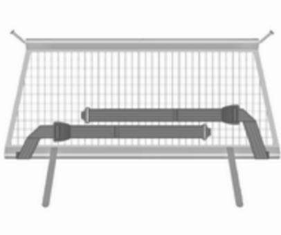
Spanngurte wie in der Abbildung dargestellt legen und am Sicherheitsnetz ausrichten.
