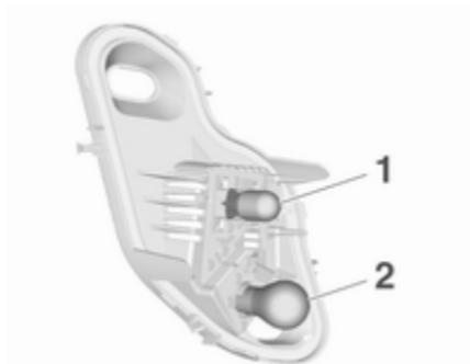
Nur die Bremsleuchte (1) und die Blinkleuchte (2) können ausgetauscht werden.
