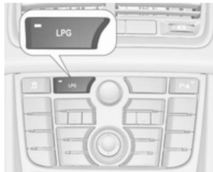
Durch Drücken von **LPG** kann zwischen Benzin- und Flüssiggasbetrieb umgeschaltet werden. Die LED-Leuchte
