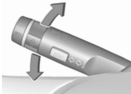
Hebel nach oben : Blinker rechts
