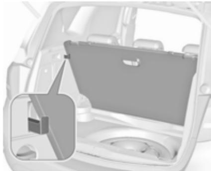
Die hintere Bodenabdeckung kann angehoben werden.
