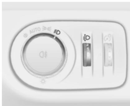
Zur Anpassung der Leuchtweite an die Fahrzeugbeladung, um Blendwirkung zu reduzieren: Daumenrad
