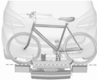
Die Radaufnahmen so positionieren, dass das Fahrrad sich etwa in horizontaler Position befindet. Der Abstand zwischen den Pedalen und der Hecktür sollte dabei mindestens 5 cm betragen.
