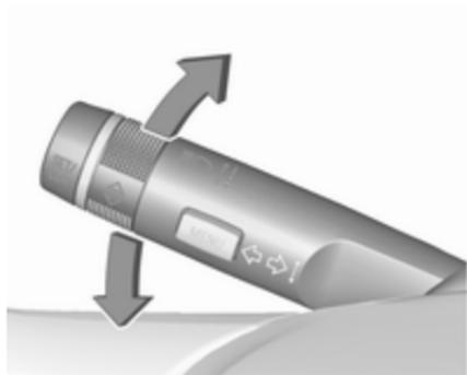
Hebel nach oben : Blinker rechts
