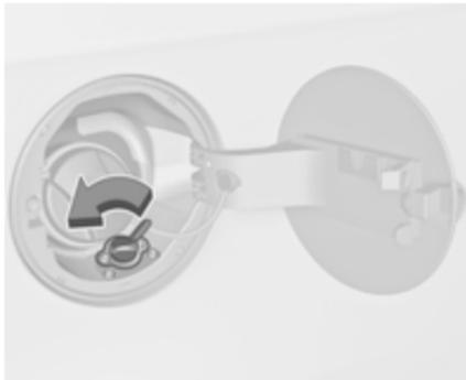
Die Schutzkappe vom Einfüllstutzen abschrauben.
