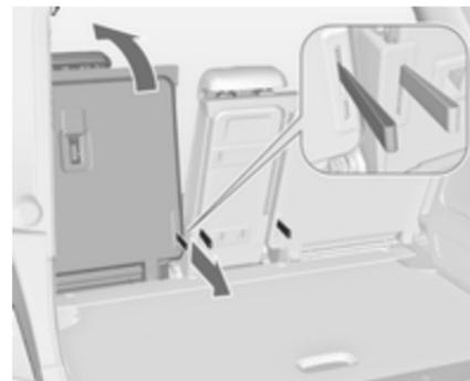
An der Schlaufe hinten an der Rückenlehne ziehen und die Rückenlehne nach unten klappen.
