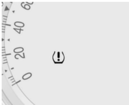
Wenn niedriger Reifendruck erkannt wird, wird dies durch die Kontrollleuchte (⚠) gemeldet ⇨ 101.
