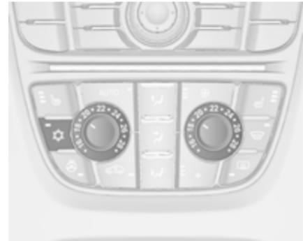
☀ drücken, um die Kühlung einzuschalten. Die Betätigung wird durch die LED in der Taste angezeigt. Die Kühlung ist nur bei laufendem Motor und eingeschaltetem Klimatisierungsgebläse funktionsfähig.
