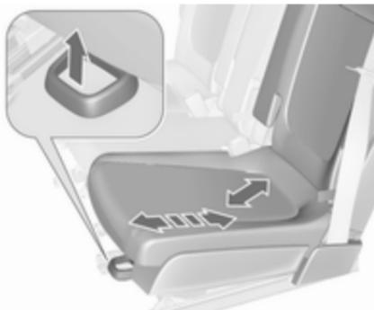
Die äußeren Rücksitze lassen sich einzeln nach vorn oder hinten verschieben. Sie sind in der Längs- und der Querrichtung verschiebbar.
