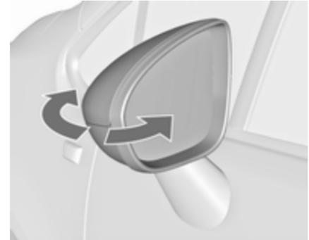
Zur Sicherheit von Fußgängern klappen die Außenspiegel bei Anstoßen aus ihrer Ausgangslage. Spiegel durch leichten Druck auf das Spiegelgehäuse wieder einrasten.
