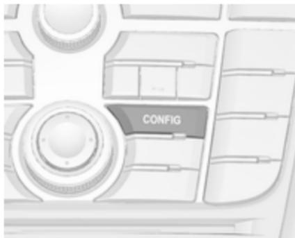
**CONFIG** an der Frontplatte des Infotainment Systems drücken, um das Menü **Einstellungen** zu öffnen.
