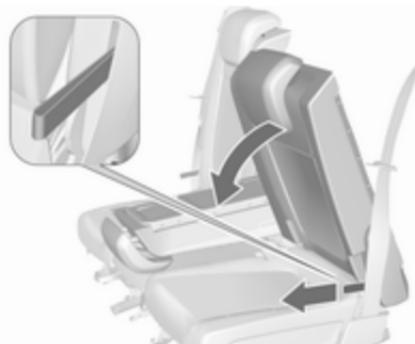
An der Schlaufe an der Vorderseite der Lehne ziehen und die Lehne auf die Sitzfläche klappen. Der Sitz wird automatisch abgesenkt, wenn der mittlere Sitz nach unten geklappt ist.
