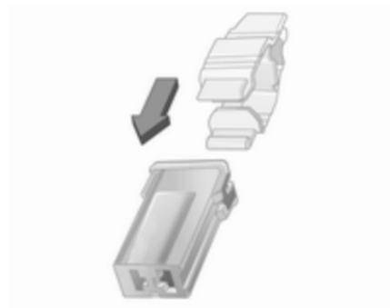
Sicherungszieher von oben oder seitlich auf die verschiedenen Ausführungen von Sicherungen stecken und Sicherung herausziehen.
