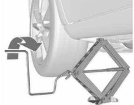
Kurbelstange anbringen und den korrekt ausgerichteten Wagenheber hochkurbeln, bis das Rad vom Boden abhebt.
