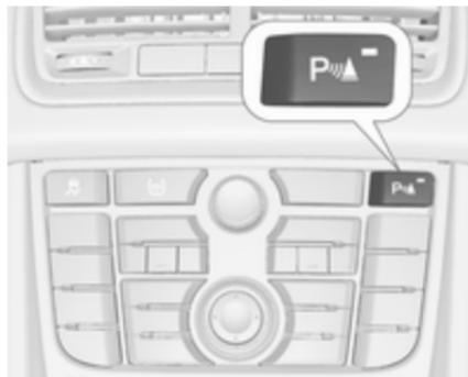
Beim Einlegen des Rückwärtsgangs wird die Front- und Heck-Einparkhilfe aktiviert.
