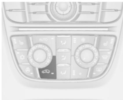
Zum Einschalten des Umluftbetriebs
