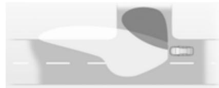
In engen Kurven oder beim Abbiegen wird abhängig vom Lenkwinkel oder dem Blinkersignal links oder rechts ein zusätzlicher Reflektor eingeschaltet, der die Straße in Fahrtrichtung ausleuchtet. Er wird bei Geschwindigkeiten von bis zu 40 km/h aktiviert.
