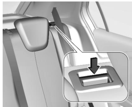
Die Rückenlehnen sind korrekt eingerastet, wenn die roten Markierungen neben den Entriegelungsgriffen nicht mehr sichtbar sind.
