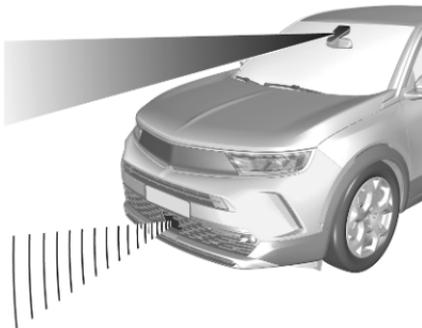
Die Auffahrwarnung erkennt Fahrzeuge, die sich in der gleichen Fahrspur vor dem eigenen Fahrzeug befinden, mithilfe der Frontkamera in der Windschutzscheibe und je nach Fahrzeugkonfiguration mit einer Radareinheit im Frontstoßfänger.
