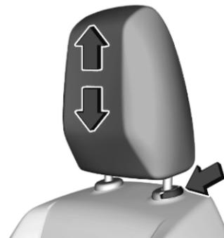
Kopfstütze nach oben ziehen bzw. Rastfedern durch Drücken entriegeln und Kopfstütze nach unten schieben.
