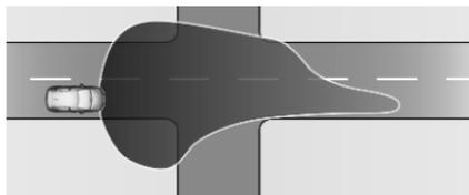
Wird automatisch bei Geschwindigkeiten bis ca. 50 km/h aktiviert. Der Lichtstrahl ist breit und symmetrisch.
