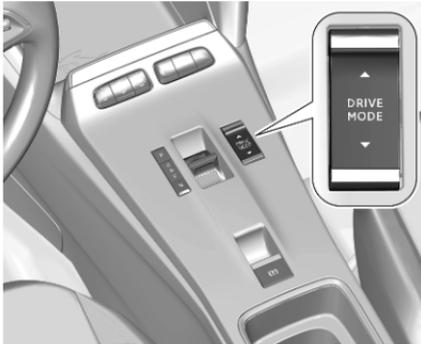
Mit dem abgebildeten Umschalter den entsprechenden Fahrmodus auswählen.
