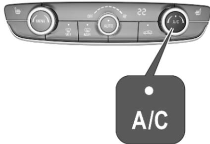
**A/C** drücken, um die Kühlung einzuschalten. Die LED in der Taste leuchtet auf, um die Aktivierung anzuzeigen. Die Kühlung ist nur bei laufendem Motor und eingeschaltetem Klimatisierungsgebläse funktionsfähig.
