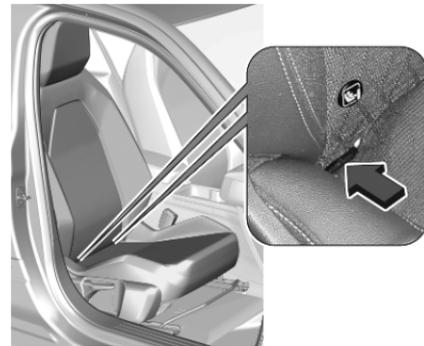
Für das Fahrzeug zugelassene ISOFIX-Kindersicherheitsysteme an den ISOFIX-Befestigungen befestigen. Die speziellen Positionen für ISOFIX-Kindersicherheitsysteme sind in der Tabelle mit ISOFIX gekennzeichnet ↗ 45.
