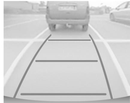
Auf dem Bildschirm wird der Bereich hinter dem Fahrzeug angezeigt. Die senkrechten Linien zeigen die Fahrzeugbreite bei ausgeklappten Seitenspiegeln an. Die Richtung der Linien ändert sich mit der Lenkradstellung.
