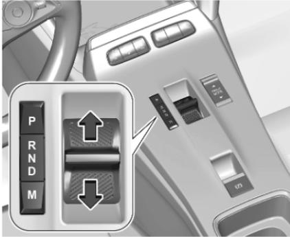
Das Fahrzeug verwendet eine elektrische Antriebseinheit mit einem 1-Gang-Getriebe. Der Wählschalter befindet sich in der Mittelkonsole zwischen den Sitzen.
