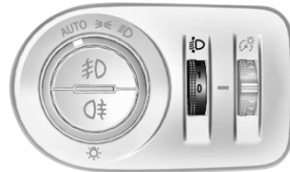
Die Leuchtweite kann manuell angepasst werden, wenn das Fahrzeug nicht mit Matrix-LED-Scheinwerfern ausgerüstet ist. Matrix-LED-Scheinwerfer werden automatisch eingestellt.
