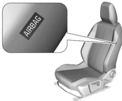
Das Seiten-Airbag-System besteht aus einem Airbag in der Rückenlehne jedes Vordersitzes und in den
