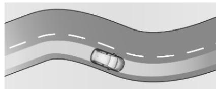
Auf diese Weise hält das System das Fahrzeug in der aktuellen Fahrspur. Das Fahrzeug befindet sich möglicherweise nicht genau in der Mitte der Spur.
