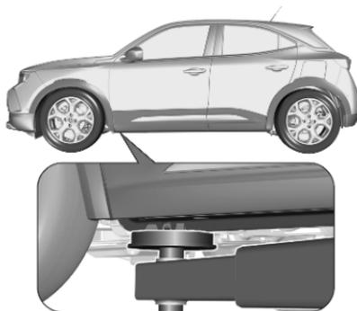
Vordere Arme der Hebebühne mittig unter den entsprechenden Wagenheberaufnahmen positionieren.
