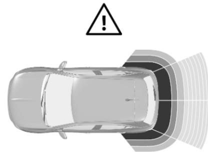
Außerdem wird der Abstand zu Hindernissen hinter dem Fahrzeug durch sich ändernde Abstandslinien im Info-Display angezeigt ↷ 81. Bei einem sehr geringen Abstand wird das Warnsymbol  $\triangle$  angezeigt.
