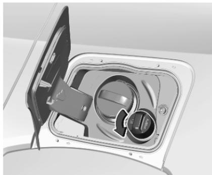
4. Die Schutzkappe vom Einfüllstutzen abschrauben.
