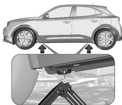
3. Sicherstellen, dass der Wagenheber richtig unter dem entsprechenden Aufnahmepunkt ausgerichtet ist.
