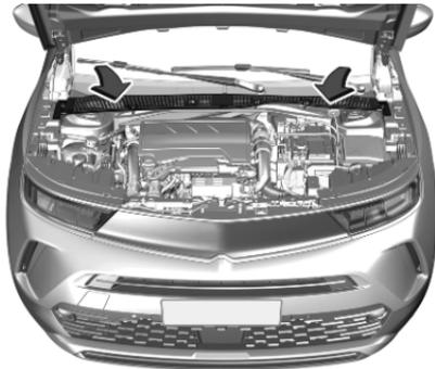
Der Lufteinlass im Motorraum außen vor der Windschutzscheibe muss zur Luftzufuhr frei sein. Gegebenenfalls Laub, Schmutz oder Schnee entfernen.
