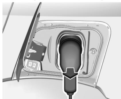
2. Den Fahrzeugstecker des Ladekabels innerhalb von 30 Sekunden nach dem Entriegeln vom Ladeanschluss trennen.
