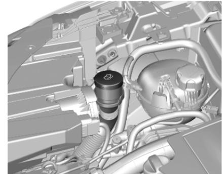
Mit einem Gemisch aus sauberem Wasser und einer geeigneten Menge zugelassener Scheibenwaschflüssigkeit mit Frostschutzmittel auffüllen.
