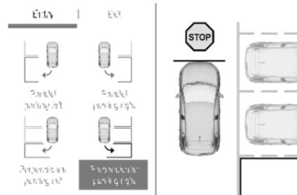
Wird eine freie Parklücke erkannt, wird im Info-Display eine optische Rückmeldung gegeben und es ertönt ein Signalton. Anhalten, Rückwärtsgang einlegen, Lenkrad loslassen und mit maximal 7 km/h fahren.
