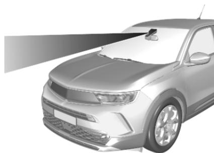
Das aktivierte System beobachtet mithilfe einer Kamera oben an der Windschutzscheibe die Spurmarkierungen. Das System lenkt das Fahrzeug in der erkannten Fahrspur. Der Fahrer spürt dabei, wie sich das Lenkrad dreht.
