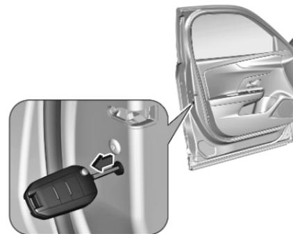
Zum Verriegeln der anderen Türen die schwarze Abdeckung mit einem Schlüssel entfernen.
