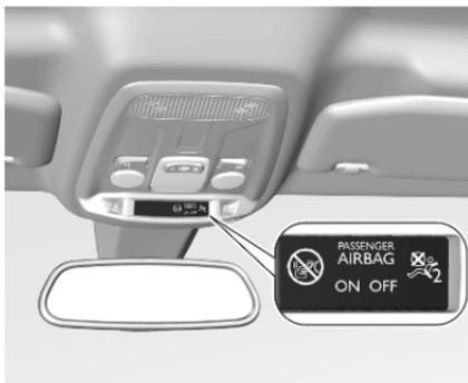
Wenn die Kontrollleuchte
