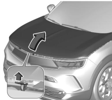
Schnappriegel hochdrücken und Motorhaube öffnen.
