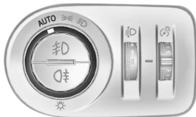
Bei aktivierter automatischer Lichtsteuerung schaltet das System abhängig von den äußeren Lichtverhältnissen und den Informationen des Wischersystems automatisch zwischen Tagfahrlicht und Scheinwerfern um.
