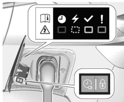
Der Beginn des Ladevorgangs wird durch die grün blinkende Statusanzeige am Ladeanschluss angezeigt.
