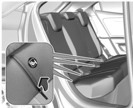
Die ISOFIX-Befestigungen sind durch einen Aufkleber auf der Rückenlehne gekennzeichnet. Um Zugriff auf die ISOFIX-Befestigungen zu erhalten, zuerst am Reißverschluss ziehen.
