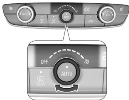
Luftstrom durch Drehen des Drehknopfs auf die gewünschte Geschwindigkeit einstellen. Die Gebläsedrehzahl kann auch im Menü Klimatisierungseinstellungen geändert werden. Zum Öffnen des Menüs auf **MENU** drücken.
