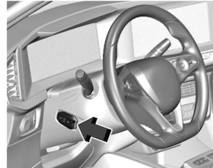
Elektronischen Schlüssel wie in der Abbildung gezeigt an die Markierung an der Lenksäulenabdeckung halten.
