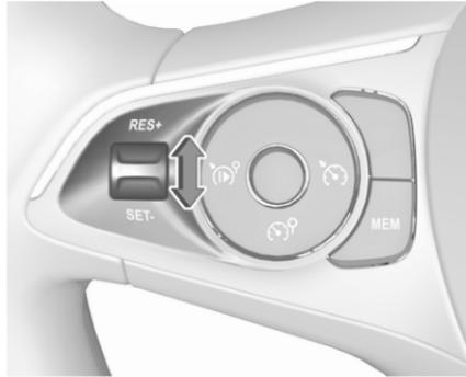
Die voreingestellte Höchstgeschwindigkeit kann durch Drücken des Daumenrädchens auf **RES/+** erhöht bzw. auf **SET/-** gesenkt werden. Daumenrädchen mehrmals kurz schieben, um die Geschwindigkeit in kleinen Schritten zu ändern, länger schieben, um sie in großen Schritten zu ändern.
