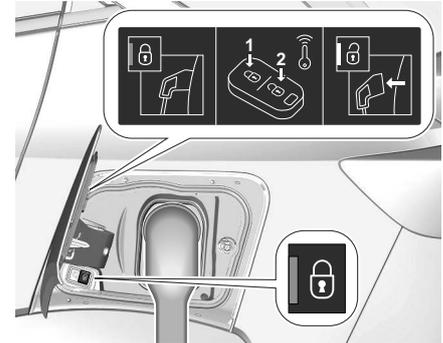
Nach dem Beginn des Ladevorgangs wird der Fahrzeugstecker am Ladeanschluss verriegelt und kann während des aktiven Ladens nicht
