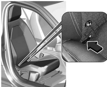
Für das Fahrzeug zugelassene ISOFIX-Kinderrückhaltesysteme an den ISOFIX-Befestigungen befestigen. Die speziellen Positionen für ISOFIX-Kinderrückhaltesysteme sind in der Tabelle der Kinderrückhaltesysteme ⇒seite29 gekennzeichnet.
