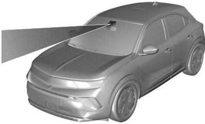
Die Spurverlassenswarnung unterstützt den Fahrer beim Vermeiden eines unbeabsichtigten Verlassens der Fahrspur. Die Frontkamera überwacht Straßenränder sowie die Spurmarkierungen, zwischen denen das Fahrzeug fährt. Wenn das Fahrzeug einen Fahrbahnrand oder eine Fahrbahnmarkierung überfährt, warnt das System den Fahrer. Ein unbeabsichtigtes Verlassen der Fahrspur wird vom System nicht angenommen, wenn die Blinker betätigt
