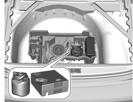
Das Reifenreparaturset befindet sich unter der Bodenabdeckung im Laderaum.
