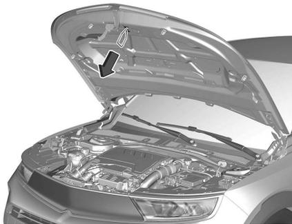
Die Motorhaube absenken und aus geringer Höhe (20–25 cm) in die Rastung fallen lassen.
