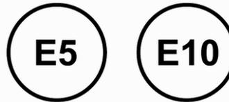
Nur bleifreie Kraftstoffe verwenden, die der Europäischen Norm EN 228, DIN 51626-1 oder einer gleichwertigen Spezifikation entsprechen. Der Motor kann mit Kraftstoff betrieben werden, der bis zu 10 % Ethanol (z. B. E10) enthält. Kraftstoffe mit der empfohlenen Oktanzahl verwenden. Eine niedrigere Oktanzahl kann zu einer reduzierten Motorleistung und einem geringeren Drehmoment führen und den Kraftstoffverbrauch leicht erhöhen.
