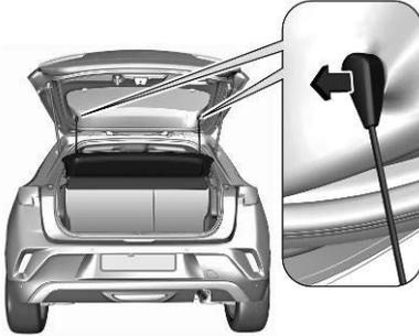
Haltebänder von Heckklappe lösen.
