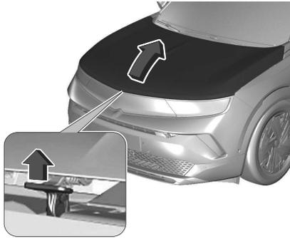
Schnappriegel hochdrücken und Motorhaube öffnen.
