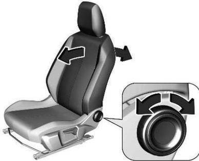
Handrad drehen. Zum Einstellen Rückenlehne entlasten.
