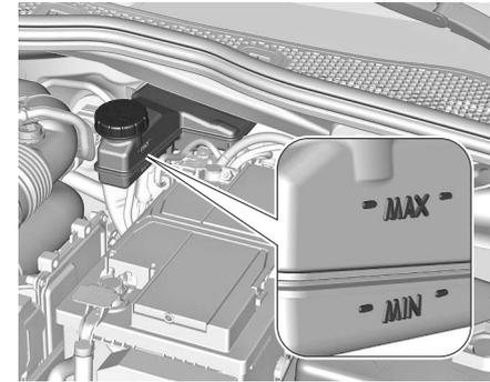
Der Bremsflüssigkeitsstand muss zwischen **MIN** und **MAX** liegen. Wenn der Flüssigkeitsstand unter die **MIN**-Markierung gefallen ist, die Hilfe einer Werkstatt in Anspruch nehmen. Brems- und Kupplungsflüssigkeit
