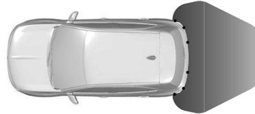
Das System arbeitet mit Ultraschall-Parkensensoren im hinteren Stoßfänger.
