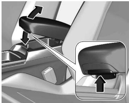
Die Armlehne nach hinten schieben, den Knopf drücken und nach oben klappen. Unter der Armlehne befindet sich ein Ablagefach.
