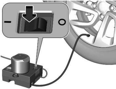
Wird der vorgeschriebene Reifendruck nicht innerhalb von zehn Minuten erreicht, das Reifenreparaturset abnehmen. Das Fahrzeug um eine Reifenumdrehung bewegen. Das Reparaturset wieder anschließen und weitere zehn Minuten lang aufpumpen. Wird der vorgeschriebene Reifendruck danach immer noch nicht erreicht, ist der Reifen zu stark beschädigt. Hilfe einer Werkstatt in Anspruch nehmen.
