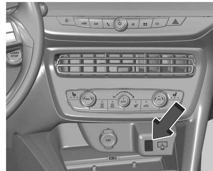
Der USB-Anschluss liefert eine Spannung von 5 V.
