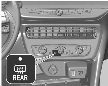
Wird durch Drücken von
