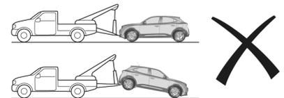
Wenn ein BEV, ein Hybridfahrzeug 48 V oder ein Fahrzeug mit Automatikgetriebe abgeschleppt wird,
