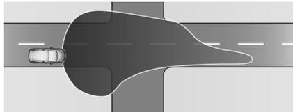
Wird automatisch bei Geschwindigkeiten bis ca. 50 mph aktiviert. Das Licht ist weit und symmetrisch.
