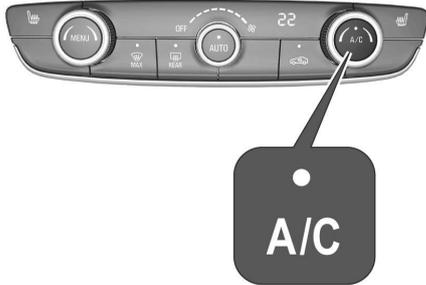
**A/C** drücken, um die Kühlung einzuschalten. Die LED in der Taste leuchtet auf, um die Aktivierung anzuzeigen. Die Kühlung funktioniert nur bei laufendem Motor und eingeschaltetem Gebläse.
