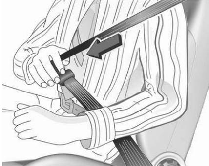
Den Sicherheitsgurt aus dem Aufroller herausziehen, unverdreht über den Körper führen und die Schlosszunge in das Gurtschloss einstecken, bis sie einrastet. Sicherstellen, dass der Sicherheitsgurt über die Schulter verläuft und während der Fahrt eng am Körper anliegt.
