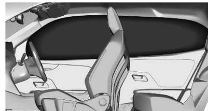
Der aufgeblähte Airbag dämpft den Aufprall, wodurch die Verletzungsgefahr für den Kopf bei einem Seitenaufprall deutlich verringert wird.
