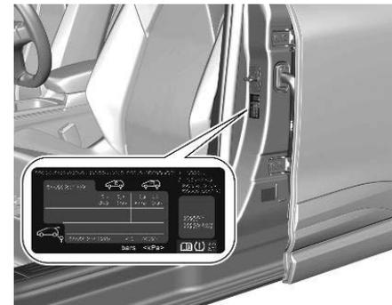
Das Reifendruckhinweisschild an der linken B-Säule gibt die Originalreifen und die entsprechenden Reifendrücke an. Die Reifendruckangaben beziehen sich auf kalte Reifen. Gültig für Sommer- und Winterreifen.
