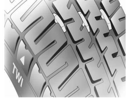
Die gesetzlich zulässige Mindestprofiltiefe (1,6 mm) ist erreicht, wenn das Profil bis zu einem Verschleißanzeiger (TWI = Tread Wear Indicator) abgefahren ist. Seine Lage wird durch Markierungen an der Reifenflanke angezeigt. Sollte der Verschleiß vorn größer sein als hinten, Vorderräder regelmäßig gegen Hinterräder tauschen. Sicherstellen, dass die Richtung der Raddrehung unverändert ist.
