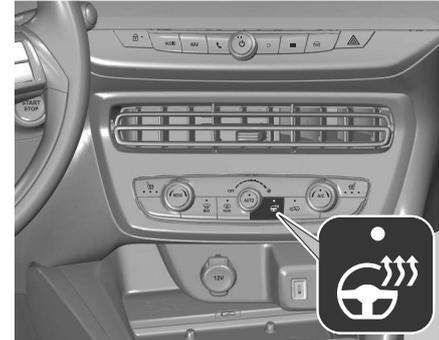
Bei Kälte beheizt diese Funktion den äußeren Teil des Lenkrads. Die Funktion kann bei einer Außentemperatur unter 20 °C aktiviert werden.
