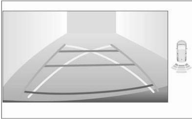
Auf dem Bildschirm wird der Bereich hinter dem Fahrzeug angezeigt.
