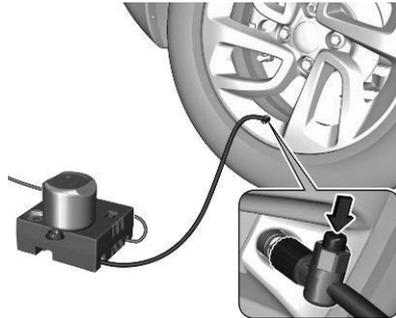
Zu hohen Reifendruck über die Taste am Luftschlauch korrigieren. Kompressor nicht länger als zehn Minuten laufen lassen.
