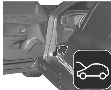
Hebel ziehen und in die Ausgangsposition zurückführen.
