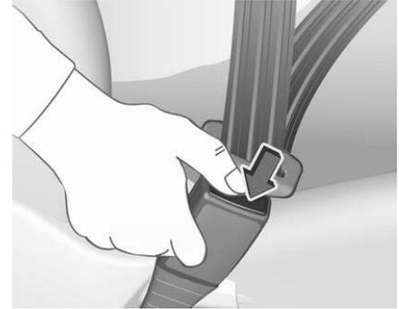
Zum Lösen des Sicherheitsgurts die rote Taste am Gurtschloss drücken und den Sicherheitsgurt zurückführen.
