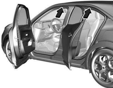
Alle Türen öffnen. Die Befestigungspunkte befinden sich an jedem Türrahmen der Karosserie.
