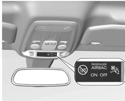
Wenn die Kontrollleuchte ON nach Einschalten der Zündung für ca. 60 Sekunden aufleuchtet, löst der Beifahrer-Airbag bei einem Unfall aus. Leuchtet die Kontrollleuchte OFF nach dem Einschalten der Zündung, ist das Airbag-System des Beifahrersitzes deaktiviert. Sie leuchtet, solange der Airbag deaktiviert ist. Wenn beide Kontrollleuchten gleichzeitig aufleuchten, liegt ein Systemfehler vor. Der Systemstatus ist nicht erkennbar,
