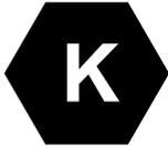
FF-Stecker bzw. -Anschluss zum Laden mit Gleichstrom
