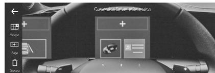
Auf dem Kombiinstrument können zwei Widgets angezeigt werden, im Head-up-Display ein Widget. Im Informationsdisplay können mehrere Widgets angezeigt werden.
