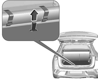
Die Kofferraumbodenabdeckung kann angehoben und ausgebaut werden. Die Laderaumbodenabdeckung an der Aussparung anheben und dann abnehmen.
