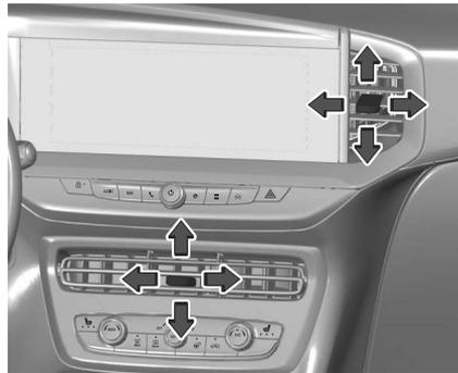
Richtung des Luftstroms durch Kippen und Schwenken der Lamellen einstellen. Zum Schließen der Belüftungsdüse die Lamellen nach innen schwenken.
