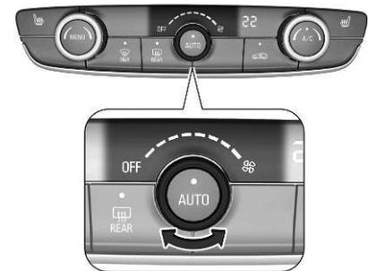
Luftstrom durch Drehen des Drehknopfs auf die gewünschte Geschwindigkeit einstellen. Die Gebläsedrehzahl kann auch im Menü Klimatisierungseinstellungen geändert werden.
