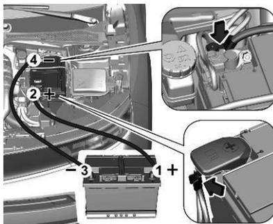
Reihenfolge für das Anschließen der Kabel:
