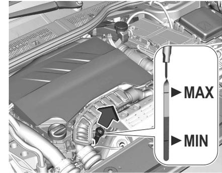
Messstab herausziehen, abwischen, vollständig einführen, erneut herausziehen und den Motorölstand ablesen.
