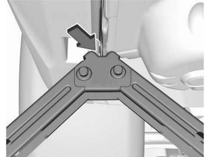
Sicherstellen, dass die Karosserie­kante in der Kerbe am Wagenheber sitzt.
