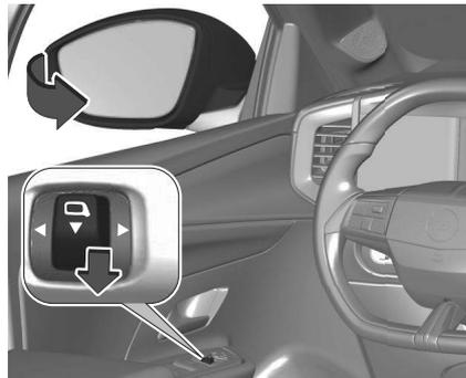
☐ in die mittlere Position bewegen. Nach hinten ziehen. Beide Außenspiegel werden eingeklappt.
