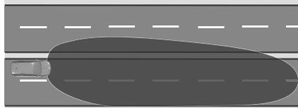
Wird bei einer Geschwindigkeit über 105 km/h aktiviert. Die Leuchtweite wird an die höhere Autobahngeschwindigkeit angepasst. Ohne Gegenverkehr wird die Sicht auf der Fahrzeugseite erhöht. Bei vorausfahrenden Fahrzeugen bzw. beim Überholen wird der andere Verkehrsteilnehmer weniger geblendet.
