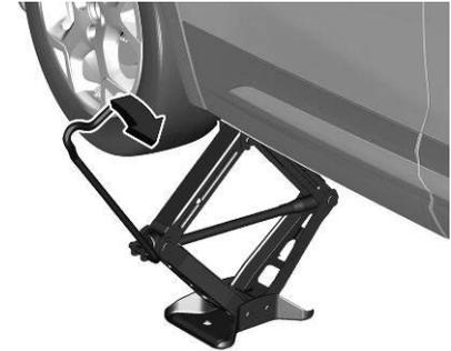
Das Fahrzeug mit korrekt ausgerichtetem Wagenheber anheben, bis das Rad vom Boden abhebt.
