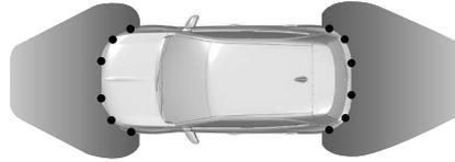
Das System arbeitet mit Ultraschall-Parkensensoren im hinteren und vorderen Stoßfänger.
