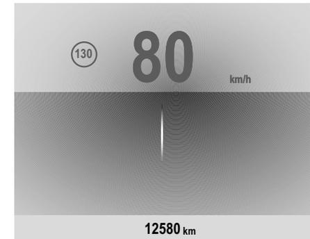
Die erfasste Gesamtfahrstrecke wird in km angezeigt.
