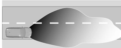
Wird beim Fahren in ländlichen Gebieten automatisch bei Geschwindigkeiten über 50 km/h aktiviert. Die Ausleuchtung der eigenen Fahrbahn und des Fahrbahnrandes wird angepasst. Entgegenkommende und vorausfahrende Fahrzeuge werden nicht geblendet.
