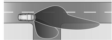
Beim Abbiegen mit bis zu 40 km/h aktiviert. Der Scheinwerfer besteht aus einzelnen LEDs, die den Fahrweg ausleuchten. Diese LEDs werden abhängig vom Lenkeinschlag oder der Aktivierung der Blinker ausgelöst.
