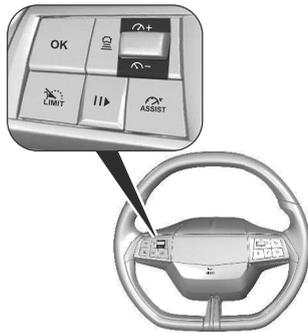
Bei aktivem System kann die voreingestellte Geschwindigkeit durch Drücken auf + erhöht bzw. auf - gesenkt werden. Durch kurzes Drücken wird die Geschwindigkeit in Schritten von 1 km/h geändert, bei langem Drücken in Schritten von 5 km/h. Der Geschwindigkeitswert wird auf dem Kombiinstrument angezeigt. Die Funktion kann in der Fahrzeugpersonalisierung aktiviert oder deaktiviert werden ⇒seite74 .
