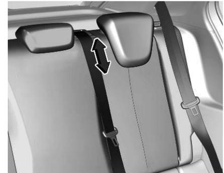
Der Sicherheitsgurt des Mittelsitzes könnte blockiert werden, wenn die Rückenlehne zu schnell hochgeklappt wird. Um den Aufroller zu entsperren, Sicherheitsgurt ca. 20 mm hindrücken oder herausziehen und dann loslassen.
