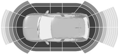
Diese Funktion warnt den Fahrer durch Anzeigen von Hinweisen, wenn Hindernisse seitlich neben dem Fahrzeug erkannt werden. Wenn sich das Hindernis neben dem Fahrzeug befindet und möglicherweise eine Kollision bevorsteht, ertönt ein **akustisches Warnsignal**. Hindernisse seitlich neben dem Fahrzeug werden nur berücksichtigt, wenn sie zuvor von den Parksensoren erkannt und vom System gespeichert wurden.
