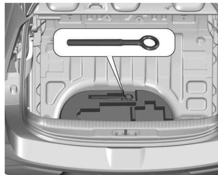
Die Abschleppöse befindet sich in einer Kiste unter der Bodenabdeckung im Laderaum.
