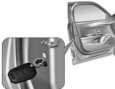
Zum Verriegeln der anderen Türen die Hintertüren öffnen. Sicherstellen, dass die Kindersicherung deaktiviert ist. Den Schlüssel vorsichtig einsetzen und Richtung Türinnenseite drehen. Anschließend den Schlüssel entfernen. Die Türen schließen. Die Tankklappe und die Heckklappe werden möglicherweise nicht verriegelt.
