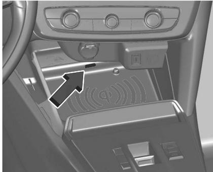
Sobald das Gerät erkannt wird, leuchtet die Kontrollleuchte des Ladegeräts grün. Sie leuchtet während der gesamten Ladezeit der Akkus.
