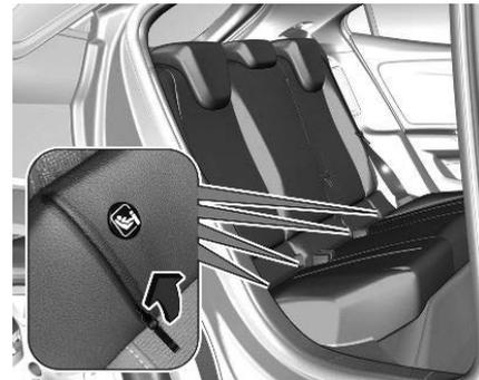
Die ISOFIX-Befestigungen sind durch einen Aufkleber auf der Rückenlehne gekennzeichnet. Um Zugriff auf die ISOFIX-Befestigungen zu erhalten, zuerst am Reißverschluss ziehen. Zum Montieren eines ISOFIX-Kindersicherheitsystems auf einem verstellbaren Sitz, beispielsweise dem Beifahrersitz, zuerst die Rückenlehne so weit wie nötig nach hinten neigen, um Zugriff auf die ISOFIX-Befestigungen zu erhalten. Nachdem das ISOFIX-Kinderrückhaltesystem ordnungsgemäß
