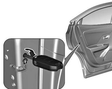
Rote Kindersicherung in der hinteren Tür mit einem Schlüssel in Richtung Fahrzeuginnenraum in die waagerechte
