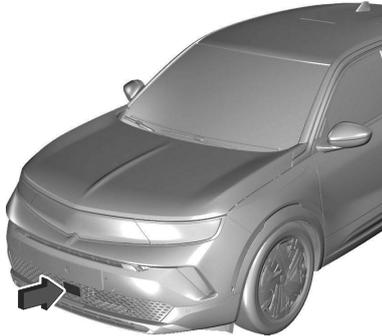
Die Radareinheit befindet sich in der Mitte des Frontstoßfängers.
