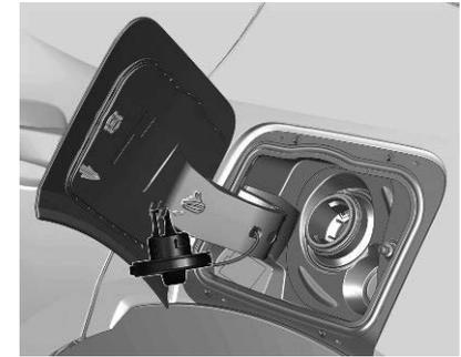
Der Deckel kann am Haken an der Tankklappe eingehängt werden. Die Tankdüse gerade am Einfüllstutzen ansetzen und mit geringem Kraftaufwand einstecken. Zum Tanken die Zapfpistole betätigen. Nach dem automatischen Abschalten des Tankvorgangs darf die Zapfpistole noch maximal zweimal erneut betätigt werden, um den Tank vollständig aufzufüllen.
