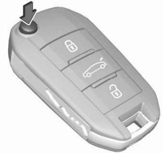
Zum Ausklappen auf den Knopf drücken. Zum Einklappen des Schlüssels zuerst auf den Knopf drücken.
