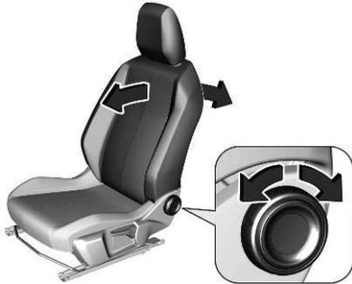
Handrad drehen. Zum Einstellen Rückenlehne entlasten.
