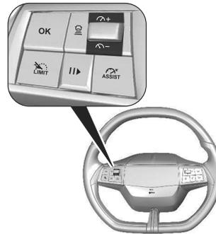
Bei aktivem System kann die voreingestellte Geschwindigkeit durch Drücken auf + erhöht bzw. auf - gesenkt werden. Durch kurzes Drücken wird die Geschwindigkeit in Schritten von 1 km/h geändert, bei langem Drücken in Schritten von 5 km/h. Der Geschwindigkeitswert wird auf dem Kombiinstrument angezeigt. Die Funktion kann in der Fahrzeugpersonalisierung aktiviert oder deaktiviert werden ⇒seite74 . Verkehrszeichen-Assistent ⇒seite149
