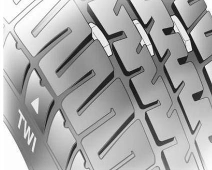
Die gesetzlich zulässige Mindestprofiltiefe (1,6 mm) ist erreicht, wenn das Profil bis zu einem Verschleißanzeiger (TWI = Tread Wear Indicator) abgefahren ist. Seine Lage wird durch Markierungen an der Reifenflanke angezeigt. Sollte der Verschleiß vorn größer sein als hinten, Vorderräder regelmäßig gegen Hinterräder tauschen. Sicherstellen, dass die Richtung der Raddrehung unverändert ist.
