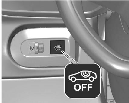
Wenn Tiere im Fahrzeug zurückgelassen werden, muss die Überwachung des Fahrzeuginnenraums und der Fahrzeugneigung abgeschaltet werden, weil laute Ultraschallsignale oder Bewegungen den Alarm auslösen.
