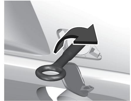
Abschleppöse bis zum Anschlag in waagerechter Stellung einschrauben. Abschleppseil - besser Abschleppstange - an der Abschleppöse befestigen. Die Abschleppöse darf nur zum Abschleppen und nicht zum Bergen eines Fahrzeugs verwendet werden.
