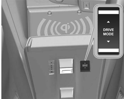
Mit dem abgebildeten Umschalter den entsprechenden Fahrmodus auswählen.
