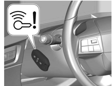
Elektronischen Schlüssel wie in der Abbildung gezeigt an die Markierung an der Lenksäulenabdeckung halten. Bei Fahrzeugen mit Schaltgetriebe in den Leerlauf schalten, das Kupplungspedal betätigen, das Bremspedal betätigen und **Start/Stop** drücken.
