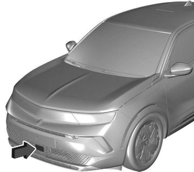
Die Radareinheit befindet sich in der Mitte des Frontstoßfängers.
