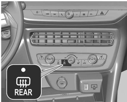
Wird durch Drücken von **REAR** bedient. Abhängig von den Außentemperaturen wird die Heizung nach einer bestimmten Zeit automatisch ausgeschaltet. Heckscheibenheizung →seite16
