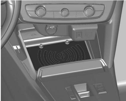
Mit diesem System können mobile Geräte wie Smartphones kabellos geladen werden, indem das Prinzip der magnetischen Induktion gemäß der Norm Qi genutzt wird.
