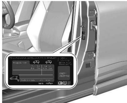
Das Reifendruckhinweisschild an der linken B-Säule gibt die Originalreifen und die entsprechenden Reifendrücke an. Die Reifendruckangaben beziehen sich auf kalte Reifen. Gültig für Sommer- und Winterreifen.
