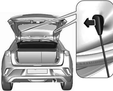
Haltebänder von Heckklappe lösen.
