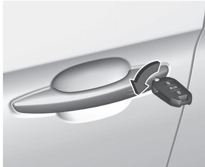
Die linke Vordertür durch Einsetzen und Drehen des Schlüssels im Schließzylinder von Hand entriegeln. Die anderen Türen können durch Ziehen am Innengriff geöffnet werden. Der Laderaum und die Tankklappe werden möglicherweise nicht entriegelt. Durch Einschalten der Zündung wird die Diebstahlsicherung deaktiviert.
