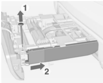
Zum Einbauen der Rückleuchten beide Schrauben (1) entfernen. Rückleuchten nach vorne (2) und unten aus der Halterung ziehen und zur Seite schwenken.
