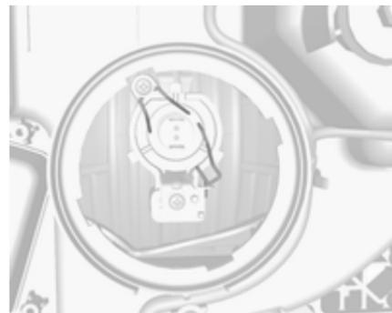
2. Den Federclip drücken und lösen.
