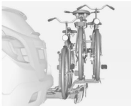
Das Heckträgersystem (Flex-Fix-System) bietet die Möglichkeit, ein Fahrrad auf einem in den Fahrzeugboden integrierten herausziehbaren Träger zu befestigen. Auf einem Anbaustück können zwei weitere Fahrräder befestigt werden. Der Transport anderer Gegenstände ist nicht zulässig.
