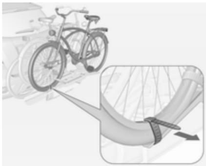
6. Beide Reifen des dritten Fahrrads mit Spannbändern zusätzlich an den Radaufnahmen sichern.
