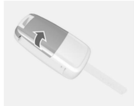
Schlüsselbart ausklappen und die Funkfernbedienung öffnen. Die Batterie austauschen (Batterietyp CR 2032). Die neue Batterie richtig einsetzen. Funkfernbedienung schließen und synchronisieren.
