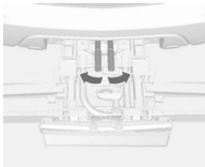
Gurt abnehmen und die beiden Spannhebel so weit wie möglich zur Seite schwenken.
