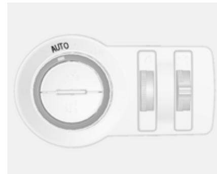
Wenn das automatische Fahrlicht bei laufendem Motor eingeschaltet wird, schaltet das System je nach den Lichtverhältnissen automatisch zwischen Tagfahr- und Abblendlicht um.
