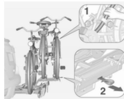
Den Rahmen (1) des hintersten Fahrrades mit einer Hand halten und zum Lösen an der Schlaufe (2) ziehen.
