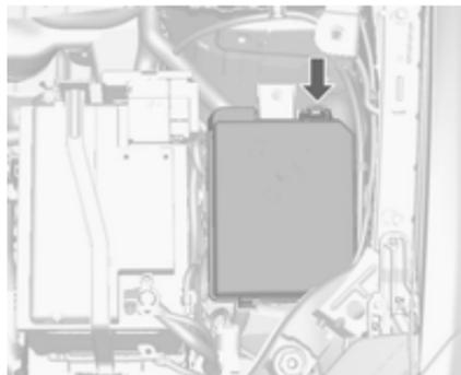
Der Sicherungskasten befindet sich im Motorraum.
