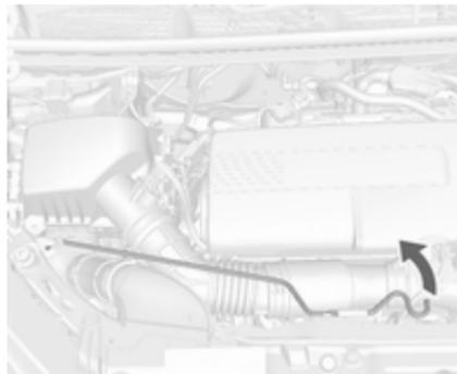
Die Motorhaubenstütze leicht aus der Halterung hochziehen. Anschließend am linken Haken an der Motorhaube einhängen.
