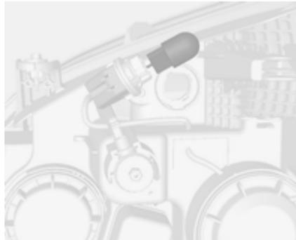
2. Glühlampe etwas in die Fassung hineindrücken, gegen den Uhrzeigersinn drehen und herausnehmen. Neue Glühlampe einsetzen.
