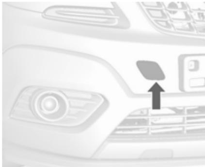
Kappe mit einem Schraubendreher lösen und abnehmen.
