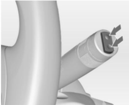
Zur Betätigung des Heckscheibenwischers Wippschalter drücken:
