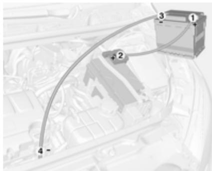
Reihenfolge für das Anschließen der Kabel:
