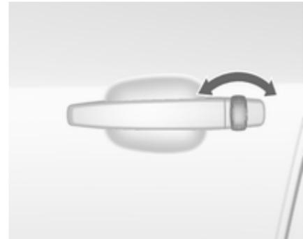
Fahrertür durch Drehen des Schlüssels im Schloss manuell entriegeln. Zündung einschalten und Zentralverriegelungstaste
