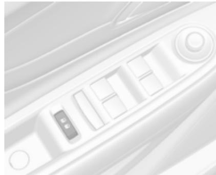
Die Zentralverriegelungstasten befinden sich in der Fahrertür.
