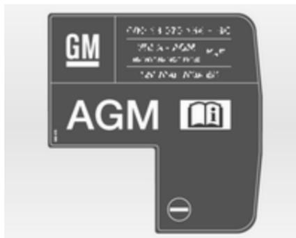
AGM-Batterien sind am Label an der Batterie zu erkennen. Wir empfehlen die Verwendung einer Original-Opel-Fahrzeugaufbatterie.
