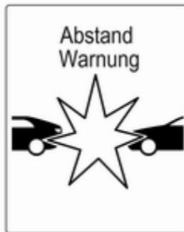
Beim zu schnellen Heranfahen an ein vorausfahrendes Fahrzeug wird die Auffahrwarnungsmeldung im Driver Information Center angezeigt. Gleichzeitig ertönt ein Warnton. Das Bremspedal betätigen, falls es die Situation erfordert.
