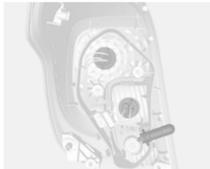
4. Lampenfassung herausnehmen. Glühlampe ausbauen und ersetzen.
