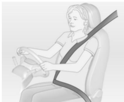
Bei starker Beschleunigung oder Verzögerung des Fahrzeugs blockieren die Sicherheitsgurte, um die Insassen in Sitzposition zu halten. Daher ist die Verletzungsgefahr deutlich geringer.
