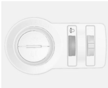
Zur Anpassung der Leuchtweite an die Fahrzeugbeladung, um Blendwirkung zu reduzieren: Daumenrad
