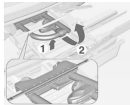
Den Träger an der Rückseite (1) anheben und nach hinten ziehen.
