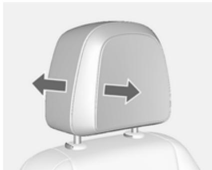
Für die Horizontaleinstellung Kopfstütze nach vorne ziehen. Sie rastet in drei Positionen ein.
