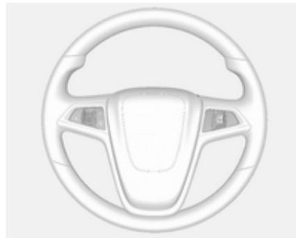
Das Infotainment System und der Geschwindigkeitsregler können mit den Bedienelementen am Lenkrad bedient werden.
