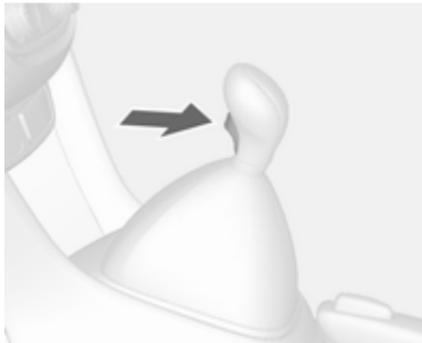
Zum Einlegen des Rückwärtsgangs nach Treten des Kupplungspedals bei stehendem Fahrzeug 3 Sekunden warten, anschließend den Entriegelungsknopf am Wählhebel drücken und den Gang einlegen.
