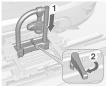
Den Träger (1) nach unten drücken und den Griff (2) zum Einrasten nach hinten schwenken.
