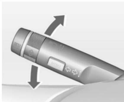
Hebel nach oben = Blinker rechts
