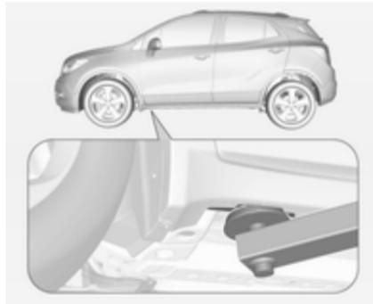
Anhebestelle für vorderen Arm der Hebebühne am Unterboden.
