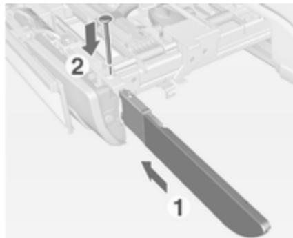
Rückleuchten in die Halterung drücken (1) und die Lampen wieder mit den Schrauben (2) befestigen.
