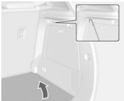
Abdeckung am Haken an der Seitenwand befestigen.
