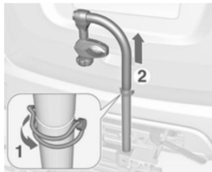
Spannhebel zur Seite schwenken (1) und Sicherungsstift herausziehen. Oberen Teil des Trägers (2) entfernen.
