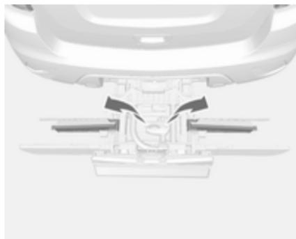
Gurt entfernen und Radaufnahme ausklappen.
