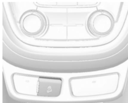
Bei Geschwindigkeiten unter ca. 40 km/h auf
