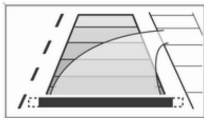
Die Fahrzeugsur wird entsprechend des Lenkwinkels angezeigt.
