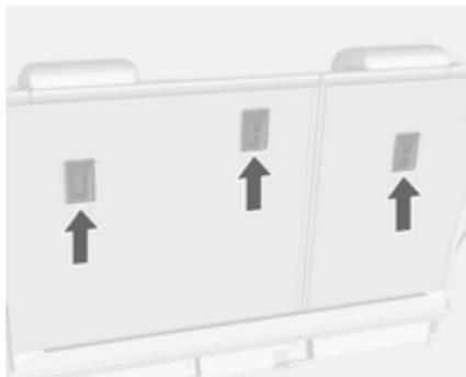
Bei anderen als ISOFIX-Kinderrückhaltesystemen den Top-Tether-Gurt an den Top-Tether Befestigungsösen befestigen. Der Gurt muss zwischen den beiden Führungsstangen der Kopfstütze verlaufen.
