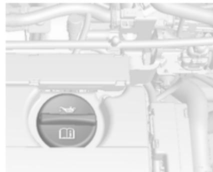
Der Motoröleinfüllstutzen befindet sich auf dem Nockenwellendeckel.
