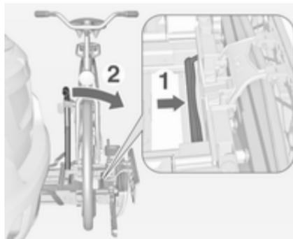
Den Hebel (1) zum Lösen drücken und halten.
