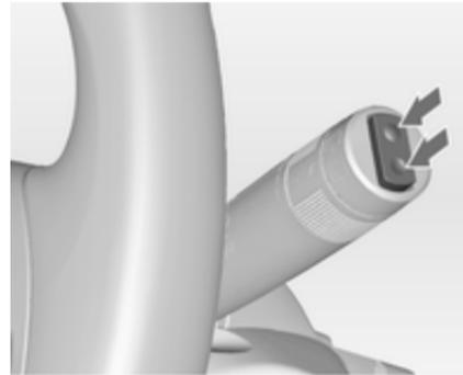
Zur Betätigung des Heckscheibenwischers Wippschalter drücken:
