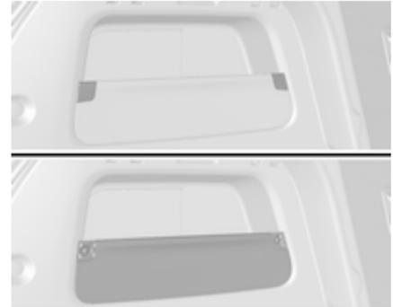
1. Beide Abdeckungen abnehmen und Schrauben entfernen. Blende ausbauen.
