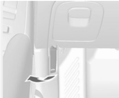
Entriegelungshebel ziehen und in die Ausgangsposition zurückführen.
