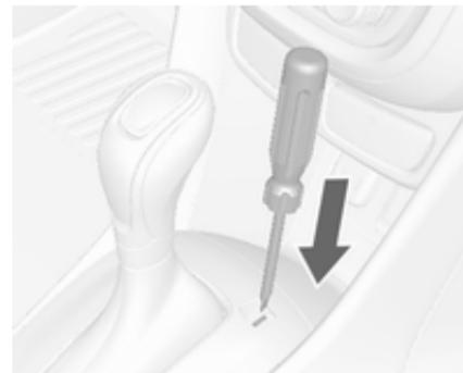
4. Schraubendreher bis zum Anschlag in die Öffnung stecken.
