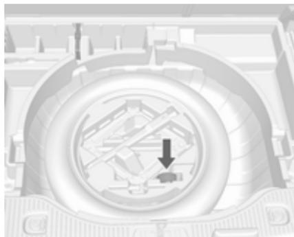
Ein beschädigtes vollwertiges Rad muss im Laderaum untergebracht und mit einem Gurt gesichert werden. Wagenwerkzeug ⇨ 186. Sichern des Rads:
