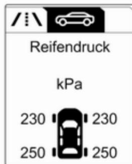
Reifendruck-Kontrollsystem durch Drehen des Einstellrädchens wählen. Systemstatus und Druckwarnungen werden durch eine Meldung und gleichzeitiges Blinken des betreffenden Reifens im DIC angezeigt.
