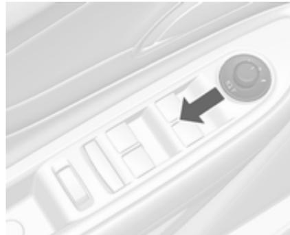
Bedienelement auf **0** drehen und dann nach hinten drücken. Beide Außenspiegel werden eingeklappt.
