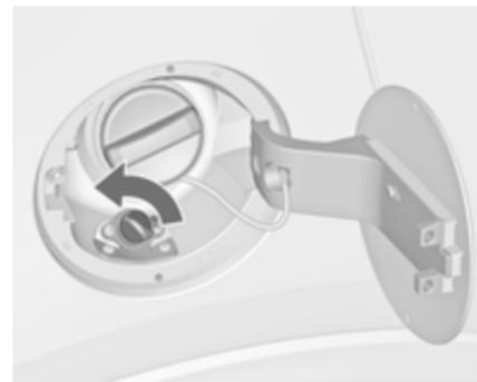
Die Schutzkappe vom Einfüllstutzen abschrauben.
