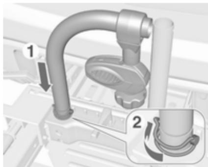
Träger (1) wieder einbauen. Sicherungsstift einsetzen und Spannhebel zur Seite schwenken (2).
