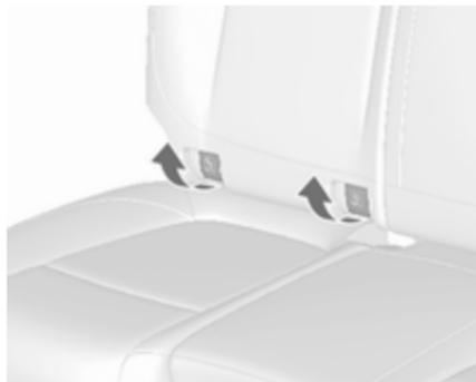
Die Abdeckungen der Führungen klappen beim Befestigen des Kindersicherheitssystems automatisch zurück.
