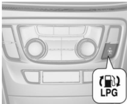
**LPG** drücken, um zwischen Benzin- und Flüssiggasbetrieb umzuschalten. Die LED in der Taste zeigt den aktuellen Betriebsmodus an.
