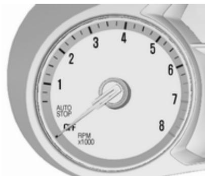
Zeigt die Motordrehzahl an. Nach Möglichkeit in jedem Gang im niedrigen Drehzahlbereich fahren.
