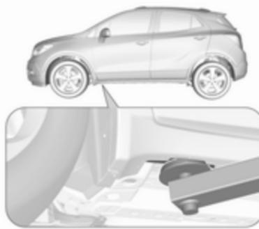
Anhebestelle für vorderen Arm der Hebeplattform am Unterboden.
