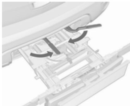
Die beiden Spannhebel so weit wie möglich nach innen schwenken. Gurt fixieren.
