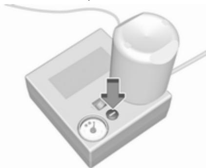
Wird der vorgeschriebene Reifendruck nicht innerhalb von zehn Minuten erreicht, das Reifenreparaturset entfernen. Das Fahrzeug um eine Reifenumdrehung bewegen. Das Reifenreparaturset wieder anschließen und Füllvorgang 10 Minuten fortsetzen. Wird der vorgeschriebene Reifendruck danach immer noch nicht erreicht, ist der Reifen zu stark beschädigt. Hilfe einer Werkstatt in Anspruch nehmen.
