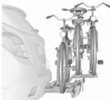
Das Heckträgersystem (Flex-Fix-System) bietet die Möglichkeit, ein Fahrrad auf einem in den Fahrzeugboden integrierten herausziehbaren Träger zu befestigen. Auf einem Anbaustück können zwei weitere Fahrräder befestigt werden. Der Transport anderer Gegenstände ist nicht zulässig.
