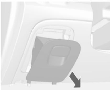
Der innere Sicherungskasten befindet sich auf der Fahrerseite unterhalb des Armaturenbretts. Zum Zugriff auf die Sicherungen das Staufach entfernen. Zum Entfernen das Staufach öffnen und herausziehen.
