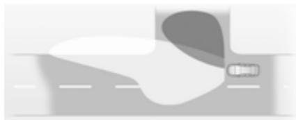
In engen Kurven oder beim Abbiegen wird abhängig vom Lenkwinkel bzw. dem Blinkersignal links oder rechts ein zusätzlicher Reflektor eingeschaltet, der die Straße in Fahrtrichtung beleuchtet. Er wird bei Geschwindigkeiten von bis zu 70 km/h aktiviert.
