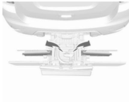
Gurt entfernen und Radaufnahme ausklappen.
