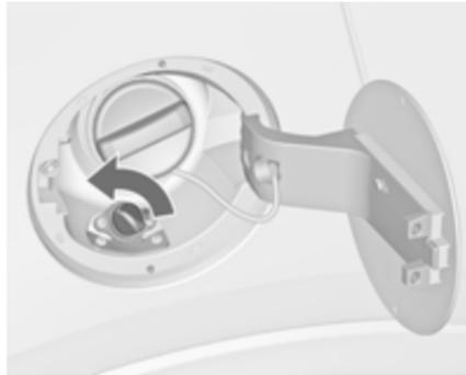
Die Schutzkappe vom Einfüllstutzen abschrauben.
