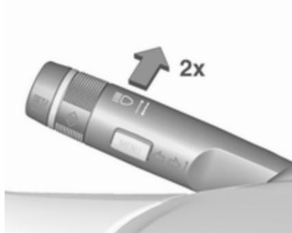
Der Fernlichtassistent wird durch zweimaliges Drücken des Blinkerhebels aktiviert. Bei Geschwindigkeiten über 40 km/h wird das Fernlicht automatisch eingeschaltet.
