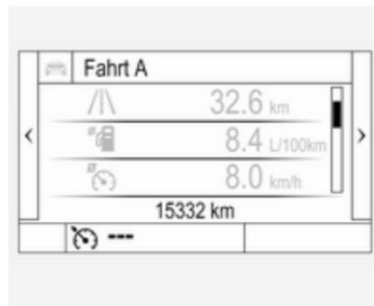
Die erfasste Gesamtfahrstrecke wird in km angezeigt.
