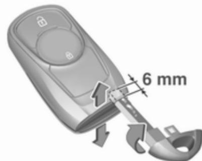
2. Das Schlüsselblatt ca. 6 mm in das Gehäuse einstecken und den Schlüssel drehen, um das Gehäuse zu öffnen. Wenn das Schlüsselblatt zu weit eingeführt wird, kann dies das Gehäuse beschädigen.
