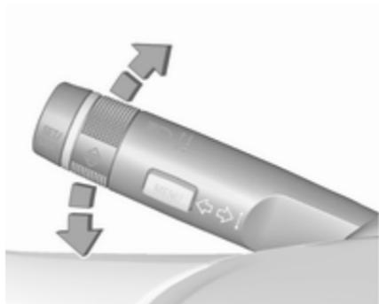
Hebel nach oben : Blinker rechts
