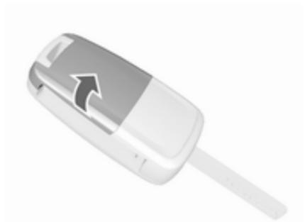
Schlüsselbart ausklappen und die Funkfernbedienung öffnen. Die Batterie austauschen (Batterietyp CR 2032). Die neue Batterie richtig einsetzen. Funkfernbedienung schließen und synchronisieren.
