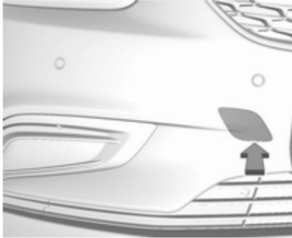
Kappe mit einem Schraubendreher lösen und abnehmen.
