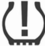
60 bis 90 Sekunden lang blinkt und dann mit Dauerlicht aufleuchtet, liegt ein Fehler im System vor. Hilfe einer Werkstatt in Anspruch nehmen.
