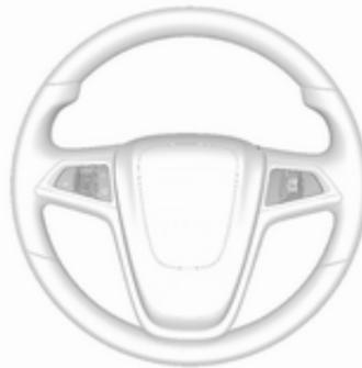
Das Infotainment System und der Geschwindigkeitsregler können mit den Bedienelementen am Lenkrad bedient werden.
