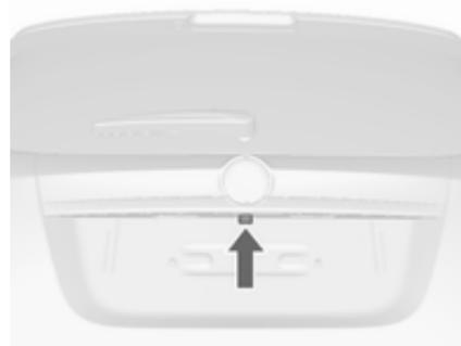
Die Kamera ist in den Hecktürgriff integriert und verfügt über einen Blickwinkel von 130°.
