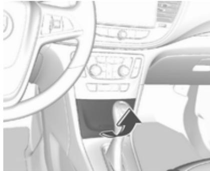
Eine 12-Volt-Zubehörsteckdose befindet sich in der vorderen Konsole hinter der Abdeckung. Zum Öffnen Knopf drücken.
