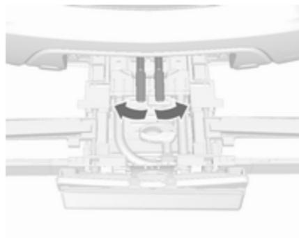
Gurt abnehmen und die beiden Spannhebel so weit wie möglich zur Seite schwenken.
