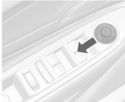
Bedienelement auf **0** drehen und dann nach hinten drücken. Beide Außenspiegel werden eingeklappt. Bedienelement erneut nach hinten drücken: Beide Außenspiegel kehren in ihre Ausgangslage zurück.
