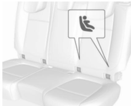
Bei einigen Fahrzeugen sind vor den Befestigungshalterungen Führungen angebracht, die den Einbau des Kindersicherheits-systems erleichtern.
