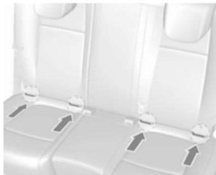
Für das Fahrzeug zugelassene ISOFIX-Kindersicherheitsysteme an ISOFIX-Befestigungshalterungen befestigen. Die speziellen Positionen für ISOFIX-Kindersicherheitsysteme sind in der Tabelle mit IL gekennzeichnet.
