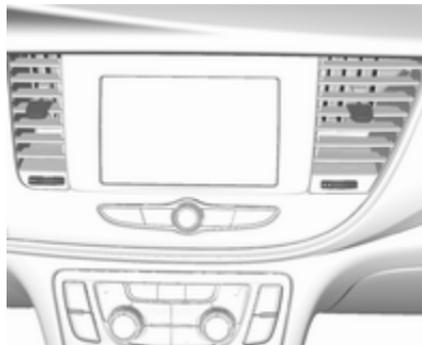
Zum Öffnen der Düse das Einstellrädchen nach rechts drehen. Durch Drehen am Einstellrädchen die Luftmenge an der Düse einstellen.
