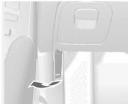
Entriegelungshebel ziehen und in die Ausgangsposition zurückführen.
