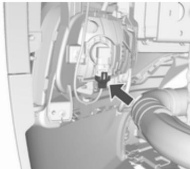
3. Die Halterippe nach außen ziehen und den Steckverbinder aus der Glühlampenfassung entfernen.
