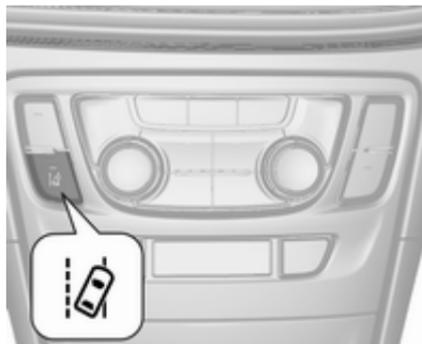
Die Spurverlassenswarnung wird durch Drücken auf
