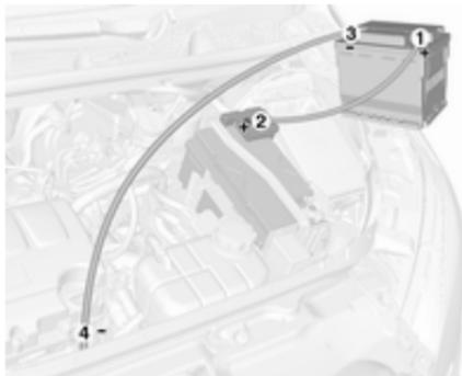
Reihenfolge für das Anschließen der Kabel:
