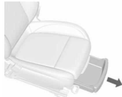
Ablagefach vorne anheben und herausziehen. Zum Schließen das Schubfach hineindrücken und einrasten lassen.
