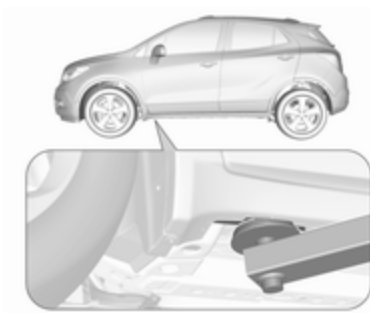
Anhebestelle für vorderen Arm der Hebeplattform am Unterboden.
