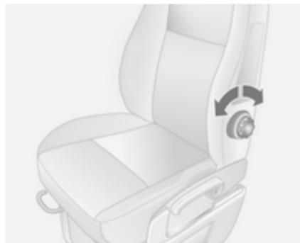
Die Lendenwirbelstütze durch Drehen des Handrades bei gleichzeitiger Entlastung der Rückenlehne einstellen.
