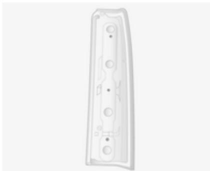
5. Die drei Schrauben von der Rückseite der Lampenbaugruppe entfernen.
