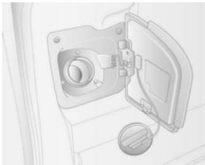
Den Tankdeckel durch Drehen nach links abschrauben.
