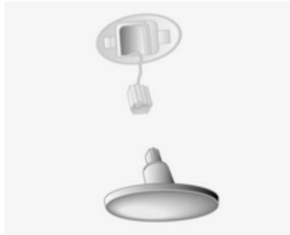
2. Den Kabelstecker von der Lampenbaugruppe abziehen.
