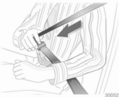
Den Gurt aus dem Aufroller ziehen, unverdreht über den Körper legen und die Schlosszunge in das Gurtverschluss einstecken, bis sie einrastet. Den Beckengurt während der Fahrt durch Ziehen am Schultergurt regelmäßig straffen.
