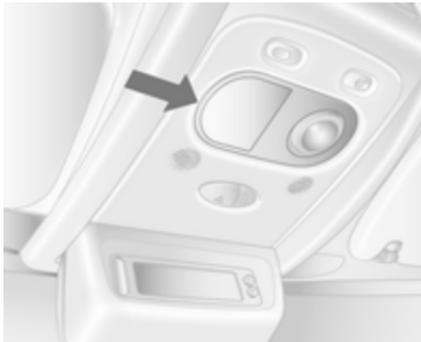
1. Streuscheibe mit einem flachen Schraubendreher lösen.
