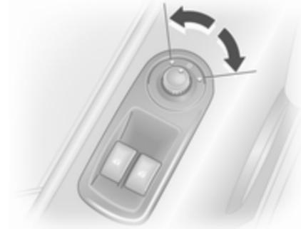
Den entsprechenden Außenspiegel durch Drehen des Schalters nach links oder rechts auswählen. Dann zum Einstellen des Spiegels den Schalter schwenken.
