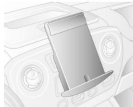
Den Dokumenthalter aus der Instrumententafel ziehen, indem Sie den Fuß in Ihre Richtung ziehen und dann den Halter nach unten klappen. Zum Wegklappen den Fuß anheben, bis der Dokumenthalter waagerecht steht, und dann bis zum Anschlag einschieben.
