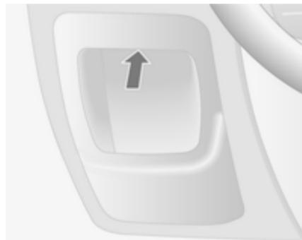
Hinter der Verkleidung der Instrumententafel auf der Fahrerseite. Am oberen Teil der Verkleidung ziehen, um sie zu lösen.
