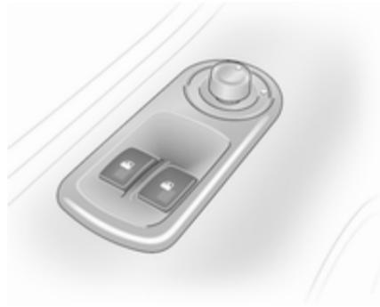
Schalter für jeweiliges Fenster durch Drücken zum Öffnen oder Ziehen zum Schließen betätigen.
