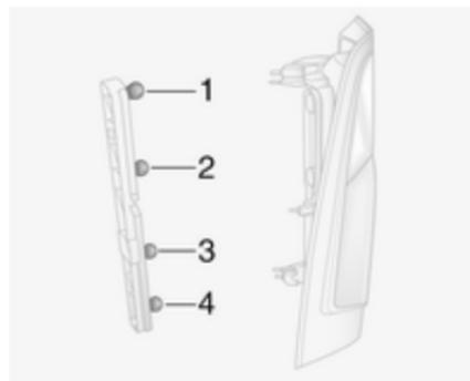
7. Die Glühlampe leicht in die Fassung drücken, nach links drehen, herausnehmen und eine neue Glühlampe einsetzen.
