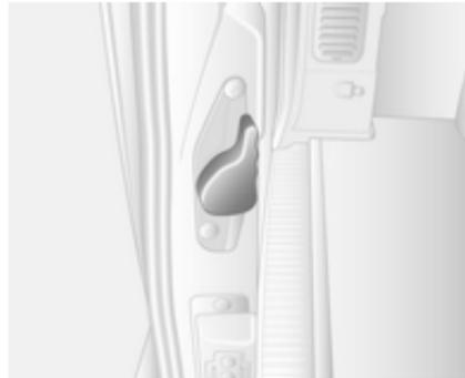
Die linke Tür wird mit dem Hebel entriegelt.
