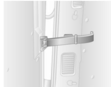
Zum Öffnen der Türen auf 180° die Arretierungen aus den Aufnahmen an den Türrahmen lösen.
