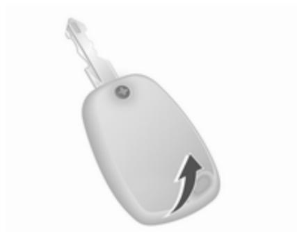
Schraube entfernen und Batteriefach durch Einstecken und Drehen einer Münze im Schlitz öffnen.
