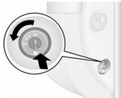
Das Beifahrer-Airbag-System lässt sich mit einem Schalter seitlich an der Instrumententafel deaktivieren.
