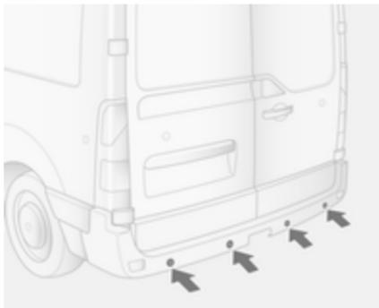
Das System besteht aus vier Sensoren im hinteren Stoßfänger.
