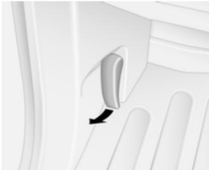
Entriegelungshebel ziehen und in die Ausgangsposition zurückführen.
