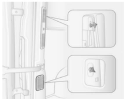
1. Das obere und untere Verkleidungsteil von der Hecksäule lösen.
