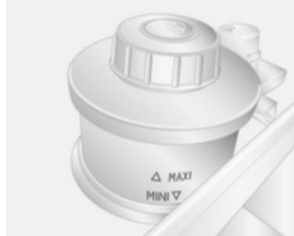
Wenn der Flüssigkeitsstand im Vorratsbehälter unter die Markierung **MINI** absinkt, Hilfe einer Werkstatt in Anspruch nehmen.
