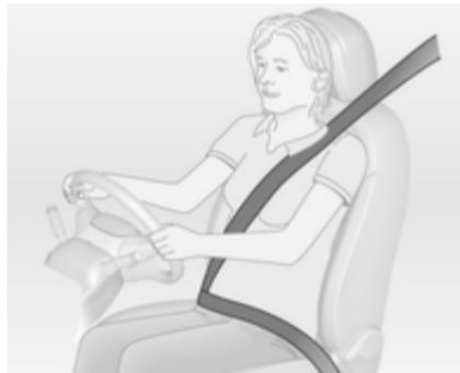
Bei starker Beschleunigung bzw. starkem Abbremsen des Fahrzeuges rasten die Sicherheitsgurte ein und fixieren die Insassen so in der Sitzposition. Das senkt erheblich die Verletzungsgefahr.
