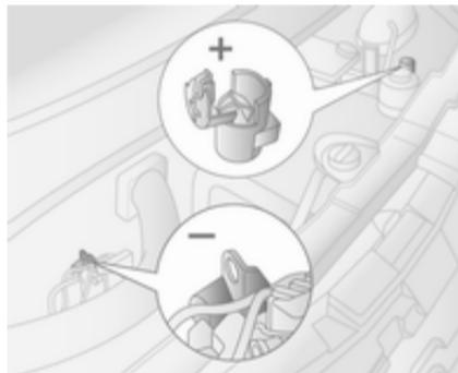
8. Das rote **+**-Kabel am Kompressor an den Starthilfanschluss anschließen ↪ 123.
