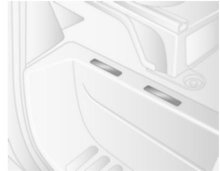
Die VIN befindet sich auch hinter einer abnehmbaren Kunststoff-Abdeckung an der rechten Trittstufe.
