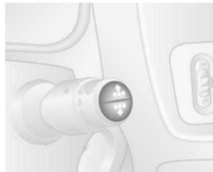
Die Funktionen können durch wiederholtes Drücken einer der beiden Tasten am Ende des Wischerhebels ausgewählt werden.
