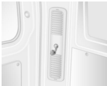
Bei Anschluss von elektrischem Zubehör in Fahrzeugen mit stehendem Motor wird die Batterie entladen. Die maximale Leistungsaufnahme von 120 Watt darf nicht überschritten werden. Kein Strom abgebendes Zubehör wie z. B. Ladegeräte oder Batterien anschließen.
