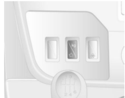
Das Lastprogramm kann sowohl im Manuell-Modus als auch im Automatik-Modus verwendet werden. In beiden Fällen werden die Schaltkennlinien automatisch an eine höhere Zuladung angepasst.
