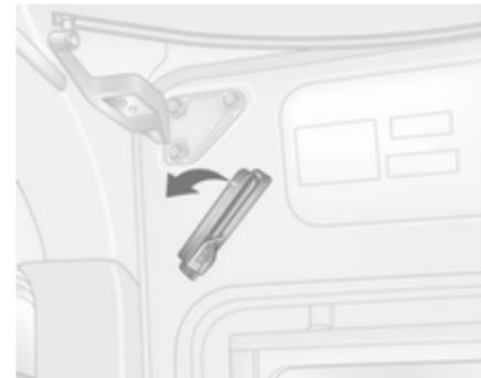
In Notfällen die Tür mit dem Innengriff entriegeln und zum Öffnen nach hinten schieben.
