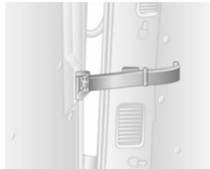
Zum Öffnen der Türen auf 180° die Feststeller aus den Aufnahmen an den Türrahmen lösen.
