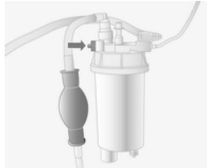
Wenn der Kraftstofftank leer gefahren wurde, muss das Diesel-Kraftstoffsystem entlüftet werden.
