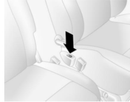
Bei laufendem Motor die Taste
