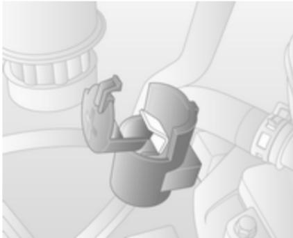
Wenn die Batterie entladen ist, lässt sich das Fahrzeug mit dem Starthilfeanschluss starten. Ein Zugang zur Batterie ist dazu nicht erforderlich.
