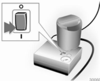
10. Den Kippschalter am Kompressor auf **I** stellen. Der Reifen wird mit Dichtmittel gefüllt.
