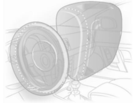
Die entfalteten Airbags dämpfen den Aufprall und verringern damit für die Insassen auf den Vordersitzen erheblich die Gefahr von Verletzungen im Oberkörper- und Kopfbereich.
