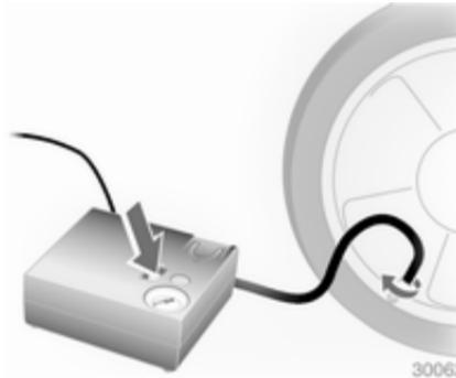
17. Fahrt unverzüglich fortsetzen, damit sich das Dichtmittel im Reifen gleichmäßig verteilt. Nach ca. 10 km Fahrtstrecke (spätestens jedoch nach 10 Minuten) anhalten und den Reifendruck mit dem Kompressor kontrollieren. Hierzu Kompressor-Luftschlauch direkt auf das Reifenventil und den Kompressor schrauben.
