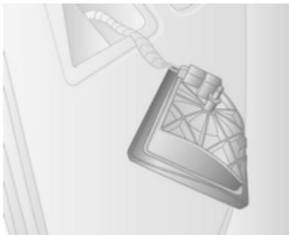
3. Die Lampenbaugruppe aus der Öffnung an der Außenseite lösen.
