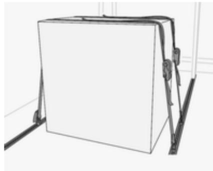
Den Gegenstand mit Hilfe der Spanngurte an den abnehmbaren Verzurrösen im Fahrzeugboden sichern.
