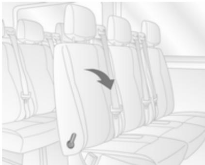
Um besseren Zugang zu den Rücksitzen zu erhalten, Entriegelungshebel ziehen und Rückenlehne nach vorne klappen.
