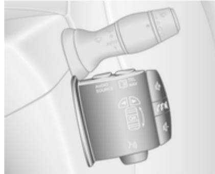
Das Infotainment System kann mit den Bedienelementen an der Lenksäule bedient werden.
