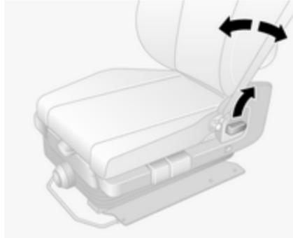
Hebel ziehen, Neigung einstellen und Hebel loslassen. Sitz einrasten lassen.
