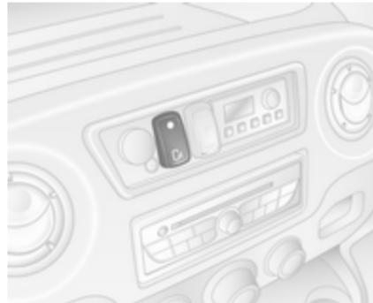
Zum automatischen Öffnen bei betätigter Parkbremse den Schalter auf der Instrumententafel drücken. Die Warnleuchte in der Instrumententafel leuchtet auf.
