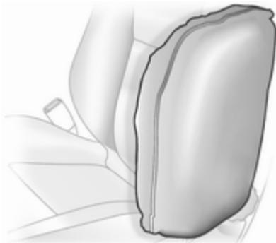
Die entfalteten Airbags dämpfen den Aufprall und verringern damit bei einem Seitenaufprall erheblich die Gefahr von Verletzungen im Oberkörper- und Beckenbereich.
