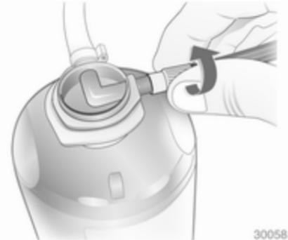
3. Den Luftschlauch des Kompressors am Anschluss der Dichtmittelflasche anschrauben.
