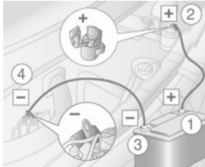
Reihenfolge für das Anschließen der Kabel:
