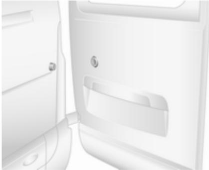
Beim Öffnen der Türen auf 270° werden die Türen von Magneten an der Seite des Fahrzeugs in vollständig geöffneter Stellung gehalten.
