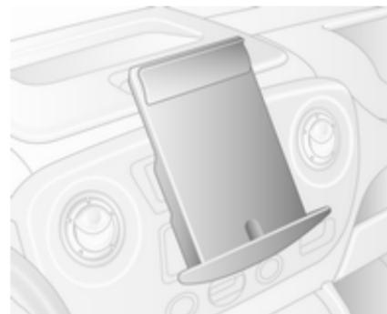
Den Dokumenthalter aus der Instrumententafel ziehen, indem Sie den Fuß in Ihre Richtung ziehen und dann den Halter nach unten klappen. Zum Wegklappen den Fuß anheben, bis der Dokumenthalter waagrecht steht, und dann bis zum Anschlag einschieben.
