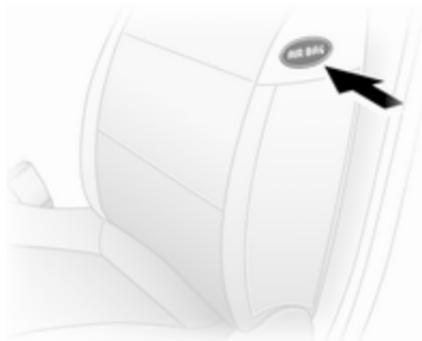
Das Seiten-Airbag-System besteht aus je einem Airbag in den Rückenlehnen der Vordersitze. Diese Stellen sind mit der Aufschrift **AIRBAG** gekennzeichnet.
