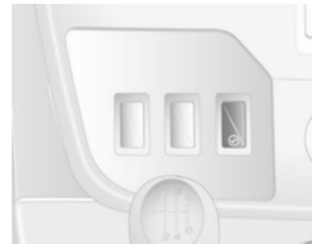
Zur Erhöhung der Leerlaufdrehzahl den Schalter drücken. Die Funktion wird nach einigen Sekunden aktiviert.
