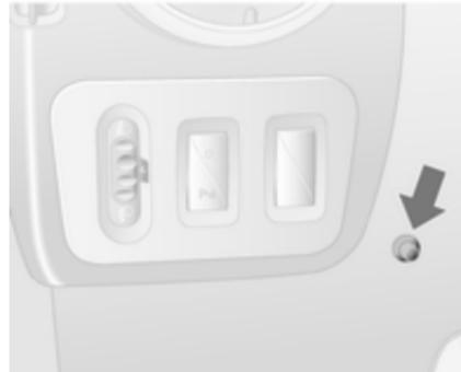
Anstatt mit der Fernbedienung kann die Heizung auch mit der Taste in der Instrumententafel für 30 Minuten ein- und ausgeschaltet werden.
