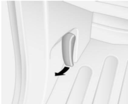
Entriegelungshebel ziehen und in die Ausgangsposition zurückführen.
