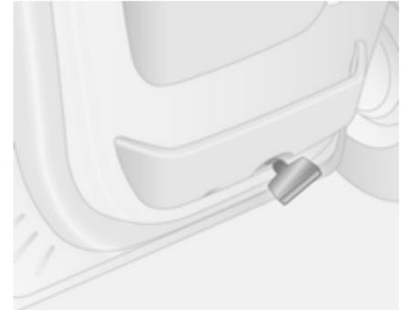
1. Leuchte mit einem flachen Schraubendreher lösen.
