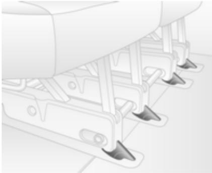
Der Sitz wird automatisch verriegelt und die Stifte **3** sind nicht mehr sichtbar.
