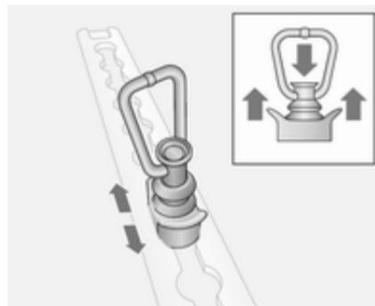
Zum Verschieben auf die Kappe in der Mitte drücken und an die gewünschte Position bewegen. Sicherstellen, dass die Verzurröse korrekt in der Aussparung eingerastet ist.
