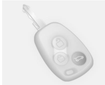
Bei der selektiven Türverriegelung kann der Laderaum separat ver- und entriegelt werden. Die Vordertüren bleiben verriegelt.
