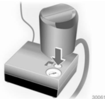
13. Der vorgeschriebene Reifendruck sollte innerhalb von 10 Minuten erreicht werden. Reifendruck ↪ 173. Den Kompressor ausschalten, wenn der korrekte Druck erreicht ist.
