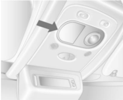
1. Streuscheibe mit einem flachen Schraubendreher lösen.
