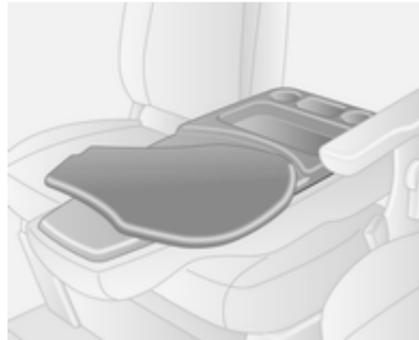
In der Beifahrersitzlehne befinden sich Ablagefächer und Getränkehalter. Diese können genutzt werden, wenn die Lehne vollständig nach vorn geklappt wird.
