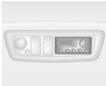
Bei abgestelltem Motor kann der hintere Fahrgastraum über Belüftungsdüsen in Bodennähe durch die Zusatzheizung geheizt werden. Die Zeit-, Tages- und Temperatureinstellungen lassen sich regeln, indem über die Bedienkonsole die gewünschten Werte einprogrammiert werden.
