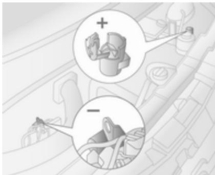
8. Das rote **+**-Kabel am Kompressor an den Starthilfanschluss anschließen ↪ 148.
