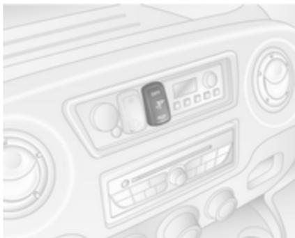
Bedienung über den Kippschalter auf der Instrumententafel:
