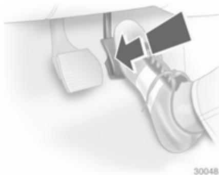
Beim Durchtreten des Gaspedals über den Druckpunkt hinaus wird abhängig von der Motordrehzahl in einen niedrigeren Gang geschaltet. Für eine Beschleunigung steht die volle Motorleistung zur Verfügung.
