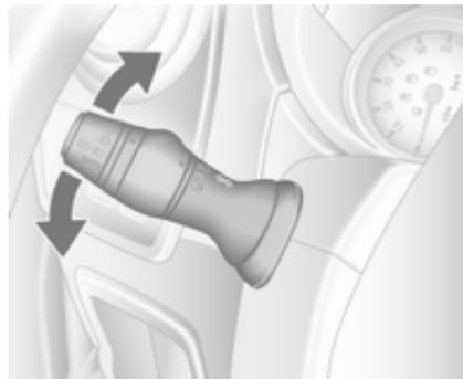
Hebel nach oben = Blinker rechts
