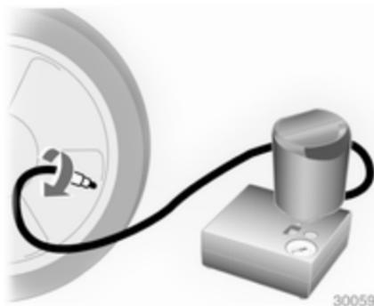
6. Den Füllschlauch am Reifenventil anschrauben.
