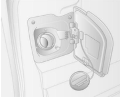
Den Tankdeckel durch Drehen nach links abschrauben.
