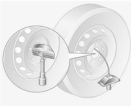
Das Rad aufrichten, den Stift aus der Halterung ziehen und das Rad vom Kabel lösen.
