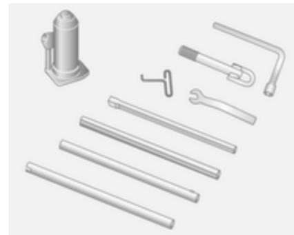
Fahrzeuge mit Hinterradantrieb: Inbegriffen sind auch ein hydraulischer Wagenheber und ein Satz Verlängerungsstücke für den Wagenheber.
