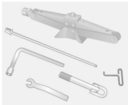
Wagenheber, Radmutternschlüssel, Adapter, Radabdeckungshaken und Abschleppöse sind als Einheit unter dem Fahrersitz verstaut.
