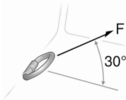
Verzurrösen im Laderaum dienen zum Sichern der Ladung mit Hilfe von Verzurrgurten oder einem Gepäckbodennetz.
