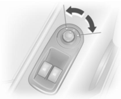
Den entsprechenden Außenspiegel durch Drehen des Schalters nach links oder rechts auswählen. Dann zum Einstellen des Spiegels den Schalter schwenken.
