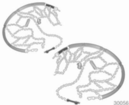
Schneeketten dürfen nur auf den Antriebsrädern montiert werden. Bei Fahrzeugen mit Doppelrädern an der Hinterachse sind Schneeketten nur an den äußeren Rädern zulässig.
