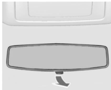
Hebel an der Unterseite justieren, um Blendwirkung zu reduzieren.
