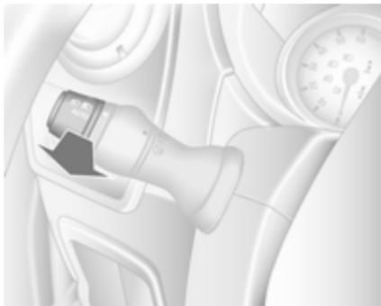
Zum Umschalten zwischen Fern- und Abblendlicht den Hebel zum Lenkrad ziehen, bis ein Klicken erfolgt.
