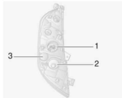
Die Scheinwerfer verfügen über separate Systeme für Fern- **1** und Abblendlicht **2**. Das Abbiegelicht **3** befindet sich zwischen den Scheinwerfern.
