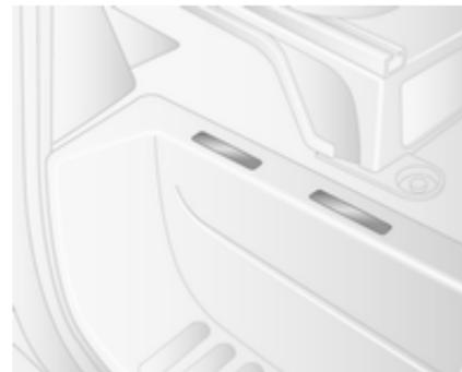
Die VIN befindet sich auch hinter einer abnehmbaren Kunststoff-Abdeckung an der rechten Trittstufe. Um Zugriff zu erhalten, die Abdeckung mit einem Schlitzschraubendreher lösen.
