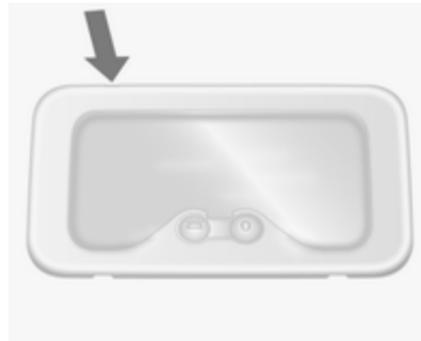
1. Leuchte mit einem flachen Schraubendreher lösen.
