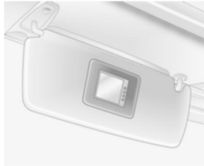
Die Kamera befindet sich normalerweise unter der Kennzeichenleiste; der Bildschirm in der Sonnenblende des Fahrers.
