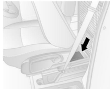
Um an diese Einheit zu gelangen, den Sitz ganz nach vorn schieben und die Lehne nach unten klappen.
