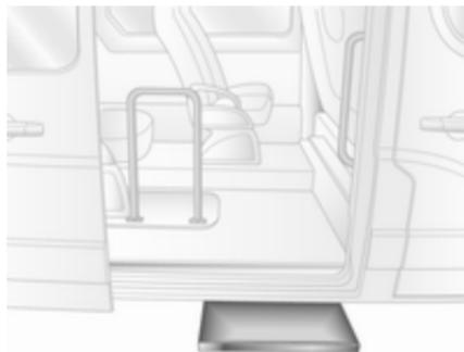
Beim Öffnen oder Schließen der Schiebetür wird das elektrische Trittbrett automatisch betätigt.
