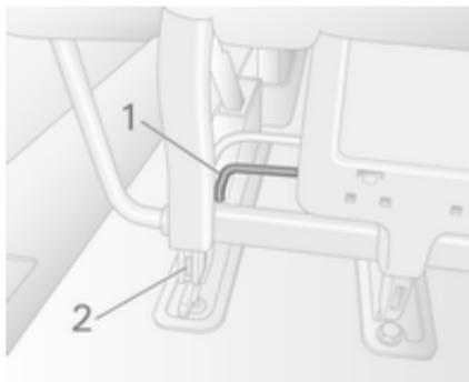
Zum Ausbau Hebel 1 auf beiden Seiten des Sitzes anheben. Stifte 2 werden sichtbar, um anzuzeigen, dass der Sitz entriegelt ist. Den Sitz nach
