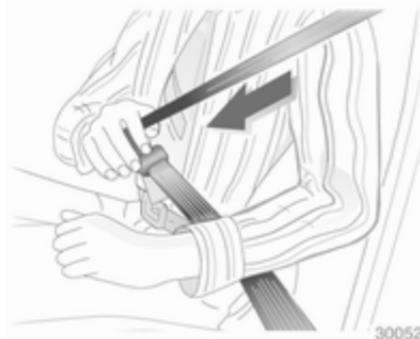
Den Gurt aus dem Aufroller ziehen, unverdreht über den Körper legen und die Schlosszunge in das Gurtschloss einstecken, bis sie einrastet. Den Beckengurt während der Fahrt durch Ziehen am Schultergurt regelmäßig straffen.
