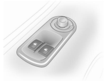
Schalter für jeweiliges Fenster durch Drücken zum Öffnen oder Ziehen zum Schließen betätigen.
