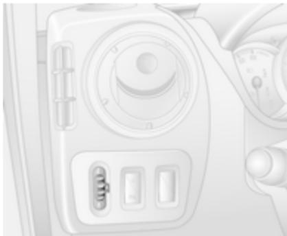
Um die Leuchtweite der Scheinwerfer an die Beladung des Fahrzeugs anzupassen und so zu vermeiden, dass andere geblendet werden: Knopf in die erforderliche Stellung drehen.
