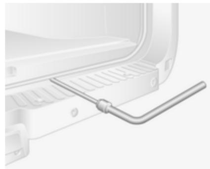
Zum Lösen des Reserverades mittels Radmutternschlüssel und Adapter das Kabel lösen und das Rad ganz nach unten lassen.
