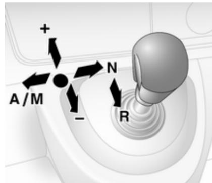
Den Wählhebel immer bis zum Anschlag in die entsprechende Richtung führen. Nach Loslassen kehrt er automatisch in die Mittelstellung zurück.
