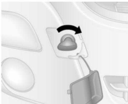
Die Abdeckung lösen und entfernen. Die Abschleppöse in den vorderen Abschlepppunkt einschrauben und mit dem Radmutterenschlüssel fest anziehen.
