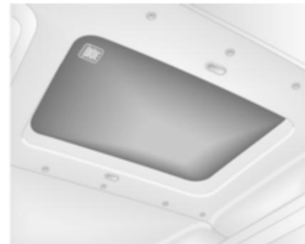
In Notfällen kann das Glas zerschlagen werden. Das Glasdach mit dem Hammer zerschlagen
