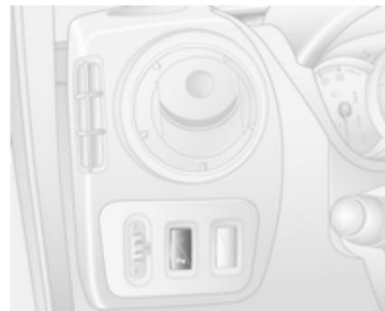
Das System durch Drücken und Halten der Taste **P**▲ in der Instrumententafel für ca. 3 Sekunden bei eingeschalteter Zündung und eingelegtem Rückwärtsgang deaktivieren. Die Kontrollleuchte in der Taste leuchtet permanent.
