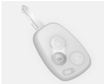
☷ auf der Funkfernbedienung zweimal innerhalb von 10 Sekunden drücken.
