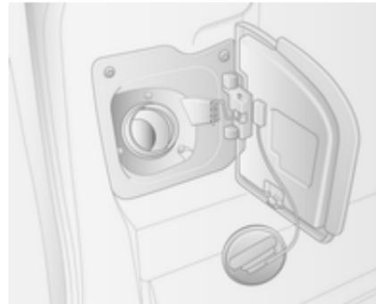
Den Tankdeckel durch Drehen nach links abschrauben.
