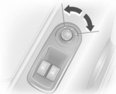
Den entsprechenden Außenspiegel wählen, indem der Regler auf Links oder Rechts geschaltet wird. Dann den Regler schwenken, um den Spiegel einzustellen.
