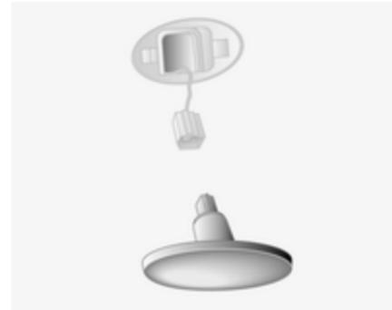
2. Den Kabelstecker von der Lampenbaugruppe abziehen.
