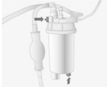
Bei jedem Motorölwechsel Restwasser aus dem Diesel-Kraftstofffilter ablassen.
