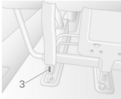
Der Sitz rastet automatisch ein und die Stifte 3 sind nicht mehr sichtbar, womit angezeigt wird, dass der Sitz verriegelt ist.
