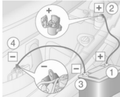
Reihenfolge für das Anschließen der Kabel:
