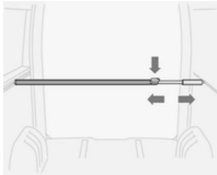
Die ausziehbaren Klemmstangen können senkrecht oder waagrecht verwendet werden.
