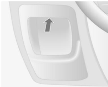
Hinter der Verkleidung auf der linken Seite der Instrumententafel. Am oberen Teil der Verkleidung ziehen, um sie zu lösen.
