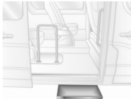
Beim Öffnen oder Schließen der elektrischen Schiebetür wird das elektrische Trittbrett automatisch betätigt.
