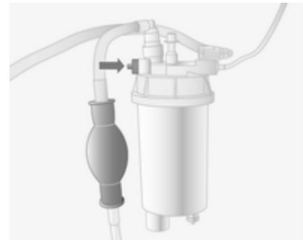
Wenn der Kraftstofftank leer gefahren wurde, muss das Diesel-Kraftstoffsystem entlüftet werden.
