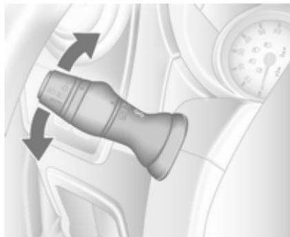
Hebel nach oben = Blinker rechts
