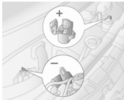
8. Das rote **+**-Kabel am Kompressor an den Starthilfeanschluss anschließen ↪ 154.
