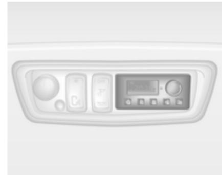
Bei abgestelltem Motor kann der hintere Fahrgastraum über Belüftungsdüsen in Bodennähe durch die Zusatzheizung geheizt werden.
