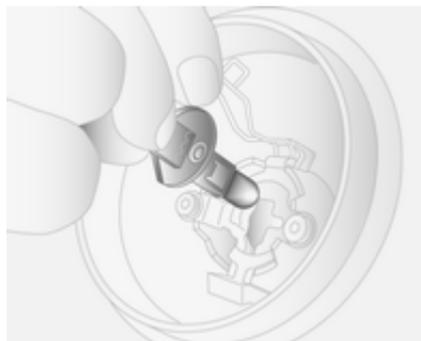
3. Den Federclip lösen.
