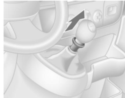
Rückwärtsgang: Bei stehendem Fahrzeug Kupplungspedal betätigen, anschließend Ring am Schalthebel nach oben ziehen und Gang einlegen.
