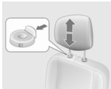
Verriegelung hochziehen, um die Kopfstütze höher zu stellen; auf die Verriegelung drücken, um die Kopfstütze tiefer zu stellen. Sicherstellen, dass die Kopfstütze eingerastet ist.
