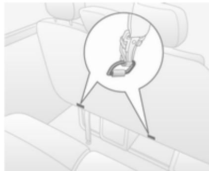
Zusätzlich zur ISOFIX-Befestigung den Top-Tether-Befestigungsgurt an den Top-Tether-Befestigungsösen verankern. Der Gurt muss zwischen den beiden Führungstangen der Kopfstütze verlaufen.
