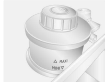
Wenn der Flüssigkeitsstand im Vorratsbehälter unter die Markierung **MINI** absinkt, Hilfe einer Werkstatt in Anspruch nehmen.
