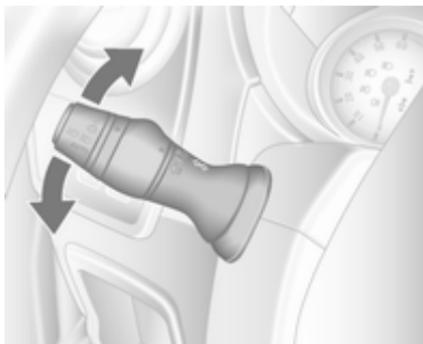
Hebel nach oben = Blinker rechts
