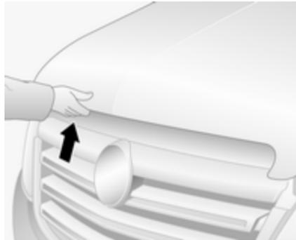
An der Sicherheitsverriegelung etwas links von der Mitte ziehen und die Motorhaube öffnen.
