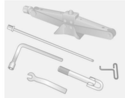
Wagenheber, Radmutternschlüssel, Adapter, Radabdeckungshaken, Schraubenschlüssel und Abschleppöse sind als Einheit unter dem Vordersitz verstaut.
