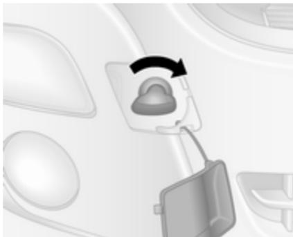
Die Abdeckung mit einem geeigneten Werkzeug lösen.
