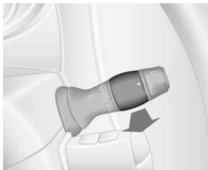
Hebel ziehen. Waschflüssigkeit wird auf die Windschutzscheibe gesprüht.
