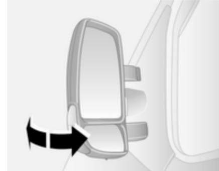
Zur Sicherheit von Fußgängern klappen die Außenspiegel bei Anstoßen aus ihrer Ausgangslage. Durch leichten Druck auf das Spiegelgehäuse wieder einrasten.
