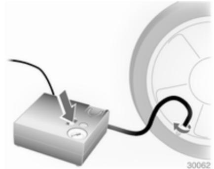
17. Fahrt unverzüglich fortsetzen, damit sich das Dichtmittel im Reifen gleichmäßig verteilt. Nach ca. 10 km Fahrtstrecke (spätestens jedoch nach 10 Minuten) anhalten und den Reifendruck mit dem Kompressor kontrollieren. Hierzu Kompressor-Luftschlauch direkt auf das Reifenventil und den Kompressor schrauben.
