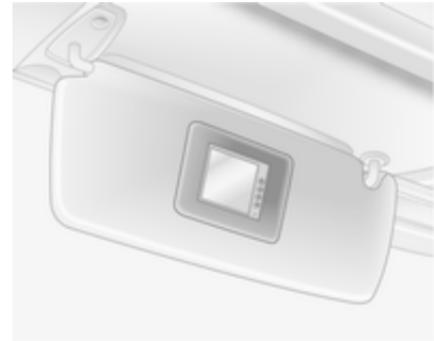
Die Kamera befindet sich normalerweise unter der Kennzeichenleiste; der Bildschirm in der Sonnenblende des Fahrers.
