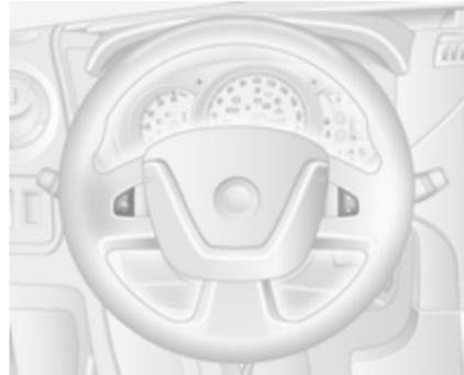
Auf die gewünschte Geschwindigkeit beschleunigen und Schalter **+** oder **-** drücken. Damit wird die aktuelle Geschwindigkeit gespeichert und beibehalten und das Gaspedal kann losgelassen werden.
