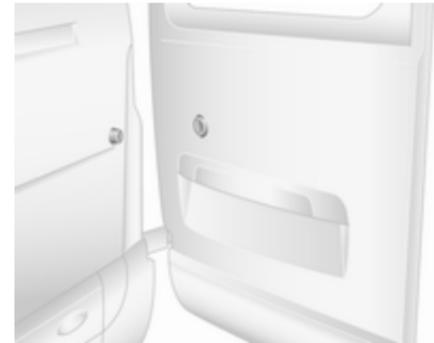
Beim Öffnen auf 270° werden die Türen von Magneten an der Karosserie in vollständig geöffneter Stellung gehalten.
