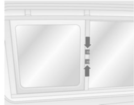
Zum Öffnen Schnapper drücken und Fenster offenschieben. Beim Schließen sicherstellen, dass der Schnapper einrastet.
