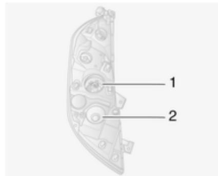
Die Scheinwerfer verfügen über separate Systeme für Fern- **1** und Abblendlicht **2**.
