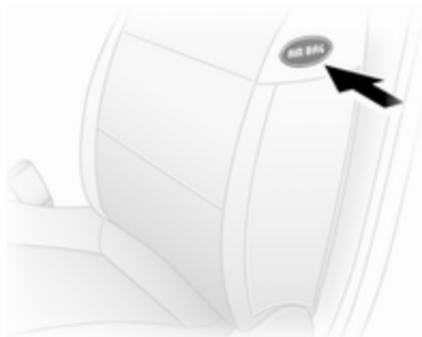
Das Seiten-Airbag-System besteht aus je einem Airbag in den Rückenlehnen der Vordersitze. Diese Stellen sind mit dem Wort **AIRBAG** gekennzeichnet.
