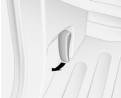
Entriegelungshebel ziehen und in die Ausgangsposition zurückführen.
