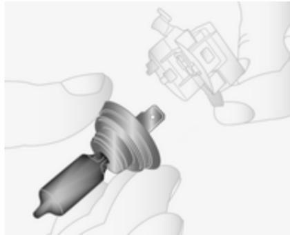
5. Glühlampe aus dem Lampenträger ziehen und neue Glühlampe einsetzen.
