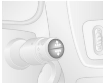
Die Uhrfunktion durch wiederholtes Drücken einer Taste am Ende des Wischerhebels aufrufen. Wenn die Zeit blinkt (nach ca. 2 Sekunden):
