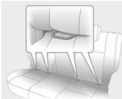
Für das Fahrzeug zugelassene ISOFIX Kindersicherheitsysteme an ISOFIX Befestigungsbügeln befestigen.
