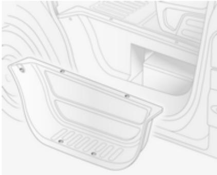
Die Batterie befindet sich unter dem Fahrzeug, hinter einer Verkleidung in der Stufe der linken Vordertür. Die Verkleidung entfernen, um an die Batterie zu gelangen.
