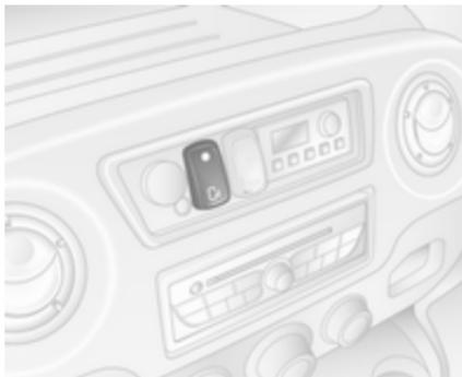
Zum automatischen Öffnen der elektrischen Schiebetür den Schalter an der Instrumententafel mit angezogener Parkbremse drücken; während des Vorgangs blinkt die LED im Schalter.
