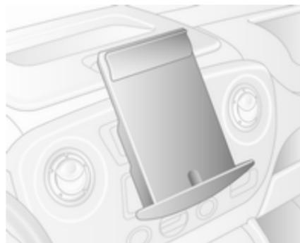
Den Dokumenthalter aus der Instrumententafel ziehen, indem Sie den Fuß in Ihre Richtung ziehen und dann den Halter nach unten klappen.
