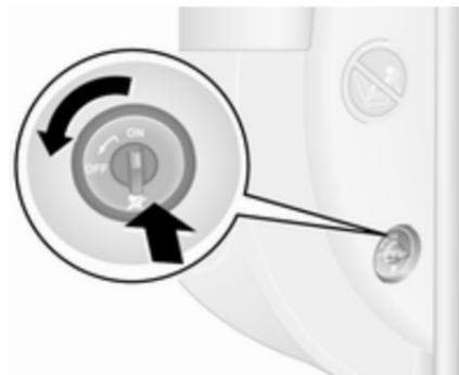
Schalter bei geöffneter Vordertür eindrücken und nach links in Stellung **OFF** drehen.
