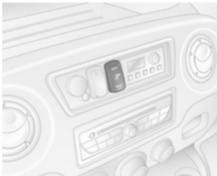
Bedienung über den Kippschalter auf der Instrumententafel:
