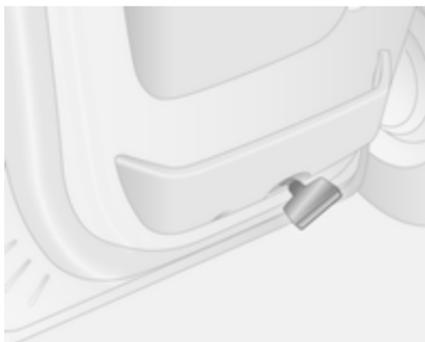
1. Leuchte mit einem flachen Schraubendreher lösen.
