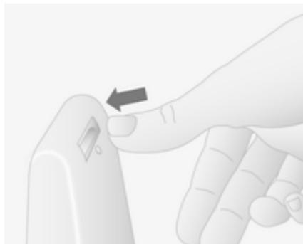
Verriegelung auf der Rückseite der Fernbedienung drücken und die Tastatur abheben.
