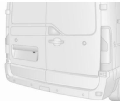
Die Kamera ist üblicherweise an den hinteren Türen/an der Hecktür unter der Kennzeichenverkleidung montiert.
