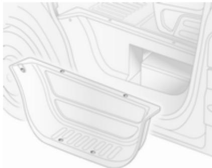
Die Batterie befindet sich hinter einer Verkleidung in der Stufe der linken Vordertür. Die Verkleidung entfernen, um an die Batterie zu gelangen.
