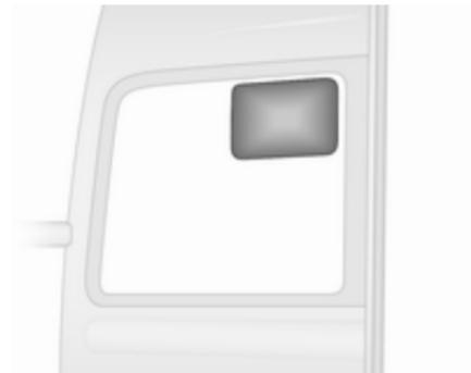
Die Heckscheibe kann mit einer Rückfahrlinse ausgerüstet sein. Die Rückfahrlinse unterstützt den Fahrer beim Rückwärtsfahren, indem sie tote Winkel reduziert.
