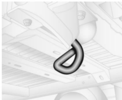
Ein Abschleppseil - oder besser noch eine Abschleppstange - an der hinteren Abschleppöse befestigen, auf keinen Fall an der Hinterachse oder den Bauteilen der Radaufhängung.
