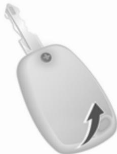
Schraube entfernen und Batteriefach durch Einstecken und Drehen einer Münze im Schlitz öffnen.
