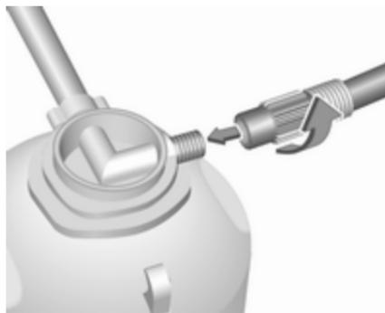
4. Den Luftschlauch des Kompressors am Anschluss der Dichtmitteflasche anschrauben.
