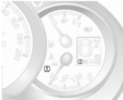
Wird ein zu niedriger Reifendruck erkannt, wird dies durch Aufleuchten der Kontrollleuchte (⚠) ↪ 103 angezeigt, und im Driver Information Center wird eine entsprechende Meldung angezeigt.
