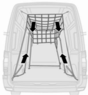
Das Sicherheitsnetz aus dem Dachbereich absenken und an den Verzurrösen im Fahrzeugboden befestigen ↻ 78.
