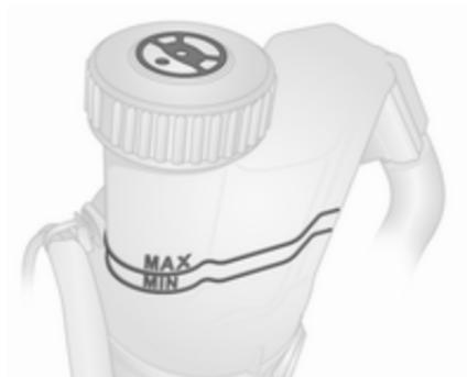
Wenn der Ölstand im Behälter unter die Markierung **MIN** absinkt, Hilfe einer Werkstatt in Anspruch nehmen.
