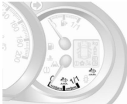
Bei Ausführungen ohne AdBlue-Füllstandswarning im Driver Information Center ist eine AdBlue-Anzeige vorhanden, die den verbleibenden AdBlue-Füllstand im Tank anzeigt. AdBlue-Anzeige ⇨ 94.
