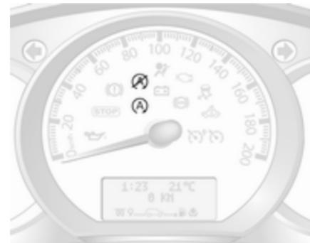
Ein Autostopp wird durch das grüne Aufleuchten der Kontrollleuchte **(A)** im Instrument angezeigt.
