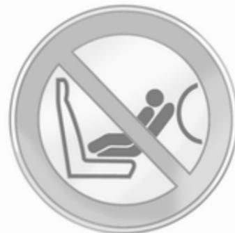
Außerdem befindet sich seitlich an der Instrumententafel ein Warnaufkleber, der bei geöffneter Beifahrertür sichtbar ist.
