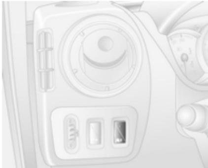
Falls nötig kann die Traktionskontrolle (TC) bei weicher, schlammiger oder schneebedeckter Fahrbahn deaktiviert werden, um die Traktion zu verbessern:
