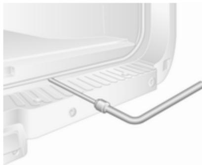
Zum Lösen des Reserverads das Drahtkabel lösen. Dazu den Radschlüssel und die Adapter (fahrzeugabhängig) an der abgebildeten Schlitzposition ansetzen und das Rad
