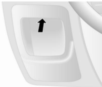
Hinter der Verkleidung auf der linken Seite der Instrumententafel. Am oberen Teil der Verkleidung ziehen, um sie zu lösen.
