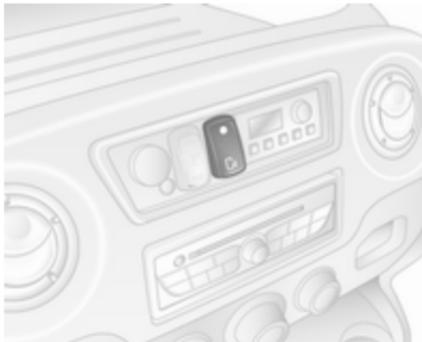
Zum automatischen Öffnen der elektrischen Schiebetür den Schalter an der Instrumententafel mit Fahrzeug im Stillstand und angezogener Parkbremse drücken; während des Vorgangs blinkt die LED im Schalter.
