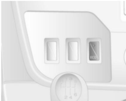
**ECO** drücken. Die Kontrollleuchte leuchtet bei Aktivierung. Gleichzeitig wird eine entsprechende Meldung im Driver Information Center angezeigt ↗ 105.
