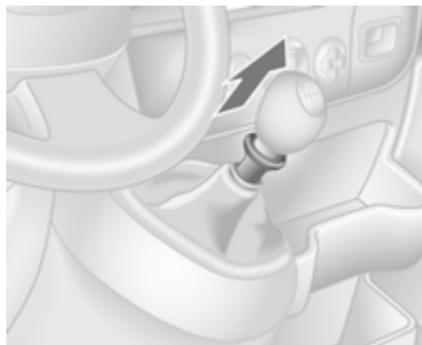
**Rückwärtsgang:** Bei stehendem Fahrzeug Kupplungspedal betätigen, anschließend Ring am Schalthebel nach oben ziehen und Gang einlegen.
