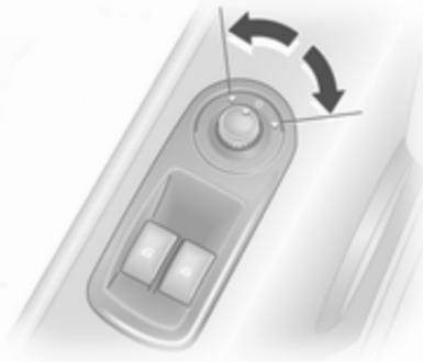
Zum Betrieb der elektrisch verstellbaren Außenspiegel die Zündung einschalten.
