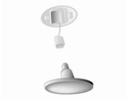
2. Den Kabelstecker von der Lampenbaugruppe abziehen.
