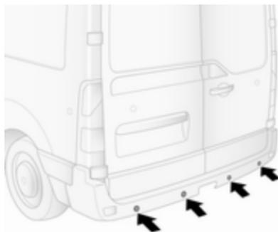
Das System besteht aus vier Ultraschallsensoren im hinteren Stoßfänger.
