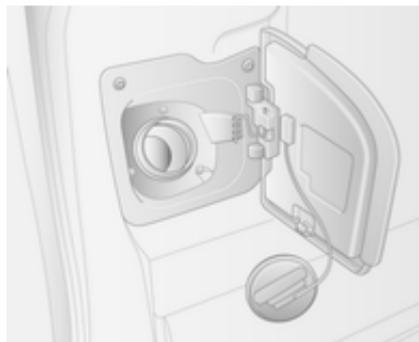
Den Tankdeckel durch Drehen nach links abschrauben.
