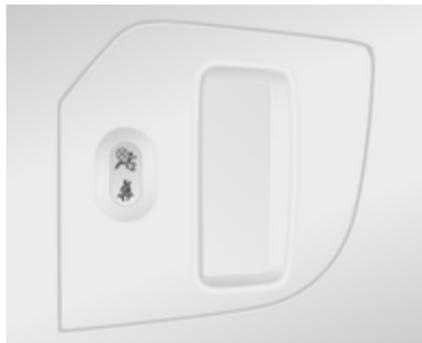
Beifahrer-Airbags sind abgeschaltet und lösen bei einer Kollision nicht aus. Die Kontrollleuchte
