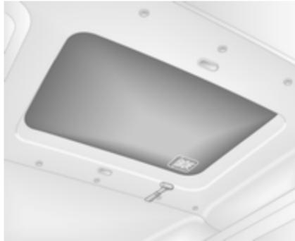
In Notfällen kann das Glas zerschlagen werden. Das Glasdach mit dem vorhandenen Hammer zerschlagen.
