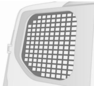
Je nach Ausführung sind die Fenster an der hinteren Tür und an der/den Schiebetür(en) mit Fenstergittern ausgestattet, die einen zusätzlichen Schutz und eine zusätzliche Sicherheit bieten.
