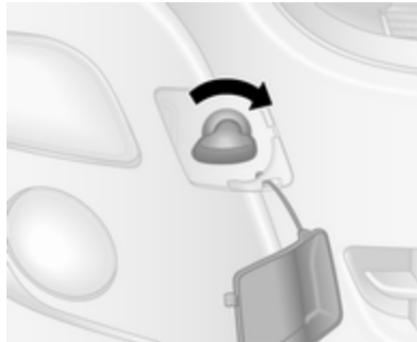
Die Abdeckung mit einem geeigneten Werkzeug lösen.
