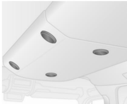
Am Dachrahmen können sich verstellbare Belüftungsdüsen befinden. Zum Öffnen die Belüftungsdüse drücken. Belüftungsdüse halten und in die gewünschte Richtung drehen, um den Luftstrom zu lenken.
