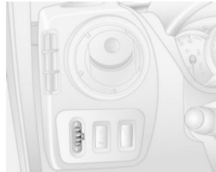
Bei eingeschaltetem Abblendlicht die Leuchtweite der Scheinwerfer an die Fahrzeugbeladung anpassen, um ein Blenden des Gegenverkehrs zu vermeiden.
