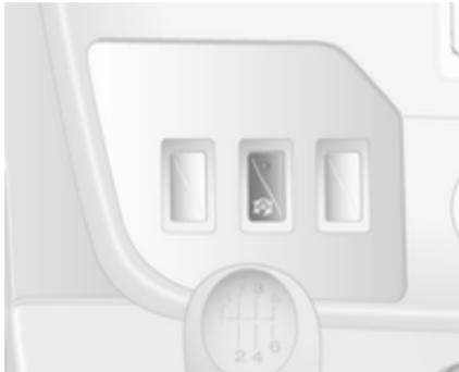
Die Stopp-Start-Automatik lässt sich durch Drücken von (A) manuell deaktivieren. Die Deaktivierung wird durch das Aufleuchten der LED in der Taste angezeigt.
