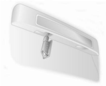
1. Leuchtenzusammenbau mit einem Schlitzschraubendreher abclipsen.
