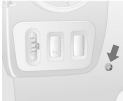
Je nach Ausführung kann der Zuheizer auch über die Tasten an der Instrumententafel für die zuletzt ausgewählte Dauer oder die Standarddauer (30 Minuten) eingeschaltet oder sofort ausgeschaltet werden. Die LED in der Taste bestätigt die Bedienung.
