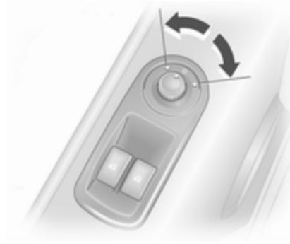
Den gewünschten Außenspiegel auswählen und durch Schwenken des Bedienelements einstellen.
