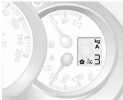
Der Modus oder der eingelegte Gang des automatisierten Schaltgetriebes wird im Getriebe-Display angezeigt.
