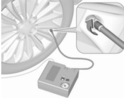
19. Fahrt unverzüglich fortsetzen, damit sich das Dichtmittel im Reifen gleichmäßig verteilt. Nach ca. zehn km Fahrstrecke (spätestens jedoch nach zehn Minuten) anhalten und den Reifendruck mit dem Kompressor kontrollieren. Hierzu Kompressor-Luftschlauch direkt auf das Reifenventil und den Kompressor schrauben.
