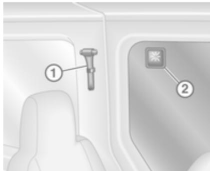
Zum Verlassen des Fahrzeugs in Notfällen mit dem Hammer 1 an der gekennzeichneten Stelle 2 auf die Scheibe schlagen.
