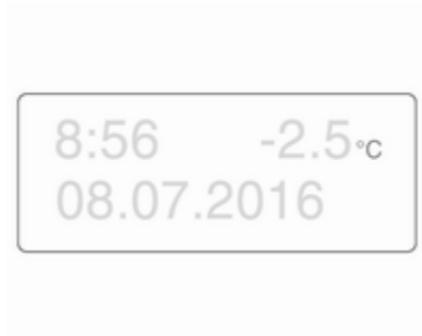
Ein Temperaturabfall wird sofort angezeigt, ein Temperaturanstieg mit Verzögerung.
