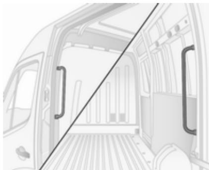
Die Handgriffe in der Nähe der hinteren Türen und der Schiebetür(en) verwenden, um das Ein- und Aussteigen in den Laderaum zu erleichtern.
