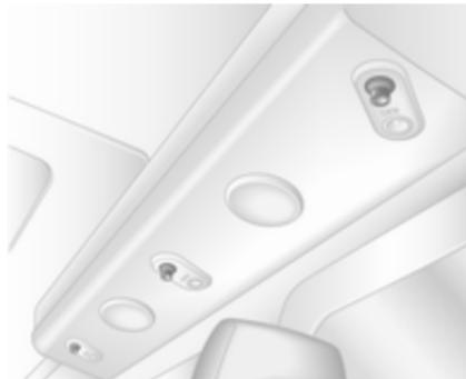
Der hintere Fahrgastraum wird über Belüftungsdüsen im Dach zusätzlich klimatisiert.
