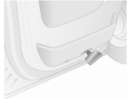
1. Leuchte mit einem flachen Schraubendreher lösen.
