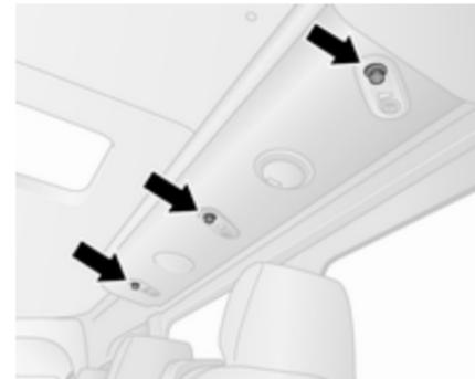
Am Dachrahmen über den Sitzen können sich verstellbare Belüftungsdüsen befinden. Einsteller drehen, um den Luftstrom zum entsprechen Sitz zu erhöhen/zu reduzieren.
