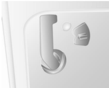
Die seitliche Schiebetür kann mit dem Innenschlossschalter von innen verriegelt werden.
