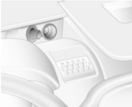
12 V-Zubehörsteckdosen befinden sich oben an der Instrumententafel oder neben dem Schalthebel.
