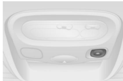
Die Spurverlassenswarnung wird durch Drücken auf
