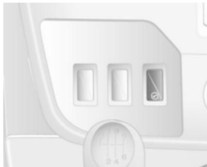
Zur Erhöhung der Leerlaufdrehzahl den Schalter drücken. Die Funktion wird nach einigen Sekunden aktiviert.
