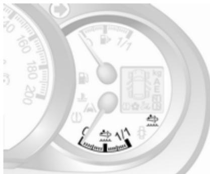
Bei Ausführungen ohne AdBlue-Füllstandswarnung im Driver Information Center ist eine AdBlue-Anzeige vorhanden, die den verbleibenden AdBlue-Füllstand im Tank anzeigt.
