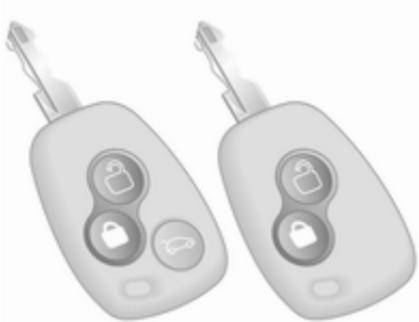
☰ drücken, um die Diebstahlwarnanlage zu aktivieren. Zur Bestätigung der Aktivierung blinkt der Warnblinker zweimal.
