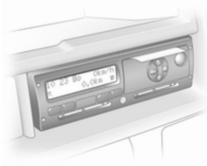
Bedienung des Tachograph nach beiliegender Bedienungsanleitung. Die gesetzlichen Bestimmungen hinsichtlich des Gebrauchs beachten. Bei einer Störung leuchtet Kontrollleuchte T im Instrumentendisplay auf. Hilfe einer Werkstatt in Anspruch nehmen.
