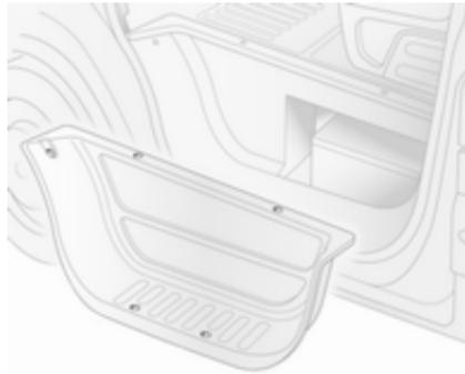
Die Batterie befindet sich hinter einer Verkleidung in der Stufe der linken Vordertür. Die Verkleidung entfernen, um an die Batterie zu gelangen.
