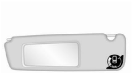
Manche Fahrzeuge sind mit einem großen konvexen Spiegel auf der Beifahrerseite der Sonnenblende ausgestattet, der die Sicht verbessert und tote Winkel reduziert.
