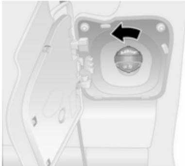
3. Die blaue Schutzkappe links herum drehen, um sie vom Einfüllstutzen abzuschrauben.
