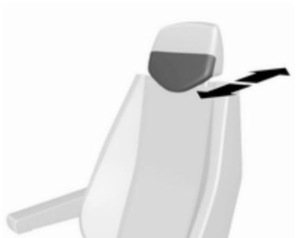
Varianteabhängig können die Kopfstützen auch nach vorn oder hinten geneigt werden. Den unteren Teil der Kopfstütze zum Einstellen drücken oder ziehen.
