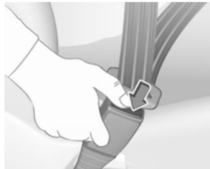
Zum Lösen rote Taste am Gurtverschluss drücken. Der Sicherheitsgurt wird automatisch aufgerollt.
