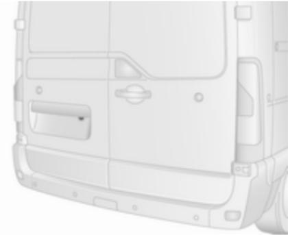
Die Kamera ist üblicherweise an den hinteren Türen/an der Hecktür unter der Kennzeichenverkleidung montiert.
