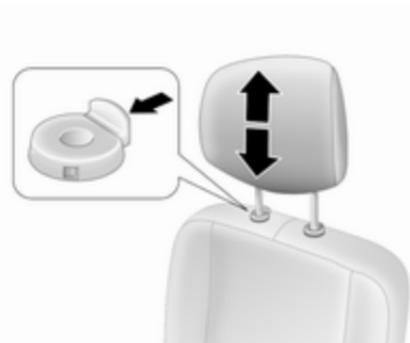
Nach oben ziehen, um die Kopfstütze höher zu stellen, oder auf den Knopf drücken und die Kopfstütze absenken. Sicherstellen, dass die Kopfstütze eingerastet ist.
