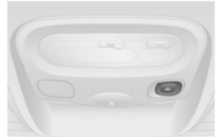
Die Spurverlassenswarnung wird durch Drücken auf
