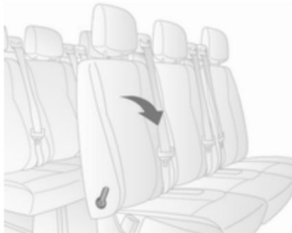
Für einen leichteren Zugang zu den Sitzen der 3. Reihe (sofern ausgerüstet) die Schiebetür öffnen, den Freigabehebel am umklappbaren Zugangssitz der 2. Reihe ziehen und die Sitzlehne nach vorne klappen. Falls erforderlich, die Sicherheitsgurte aus ihren Schlössern lösen.
