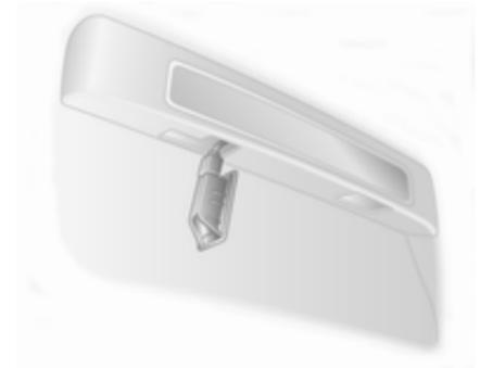
1. Leuchtenszusammenbau mit einem Schlitzschraubendreher abklipsen.
