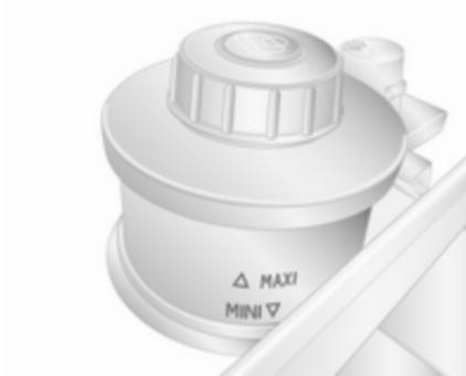
Wenn der Ölstand im Behälter unter die Markierung **MINI** absinkt, Hilfe einer Werkstatt in Anspruch nehmen.
