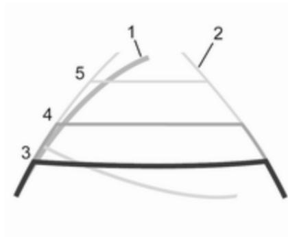
Je nach Ausstattung wird die Spur (1) des Fahrzeugs in blau auf dem Info-Display angezeigt. Sie zeigt den Weg des Fahrzeugs abhängig vom Lenkwinkel an.
