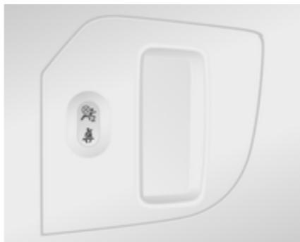
Beifahrer-Airbags sind abgeschaltet und lösen bei einer Kollision nicht aus. Die Kontrollleuchte
