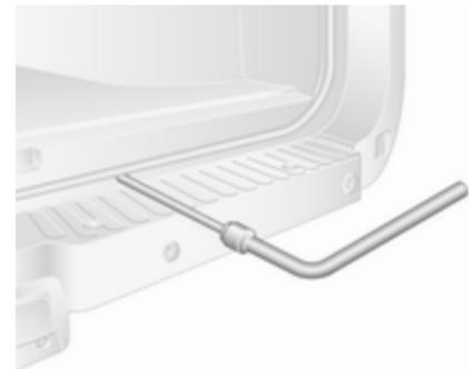
Zum Lösen des Reserverads das Drahtkabel lösen. Dazu den Radschlüssel und die Adapter (fahrzeugabhängig) an der abgebildeten Schlitzposition ansetzen und das Rad vollständig absenken, indem der Radschlüssel rechtsherum gedreht wird.
