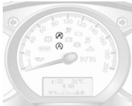
Ein Autostopp wird durch das grüne Aufleuchten der Kontrollleuchte
