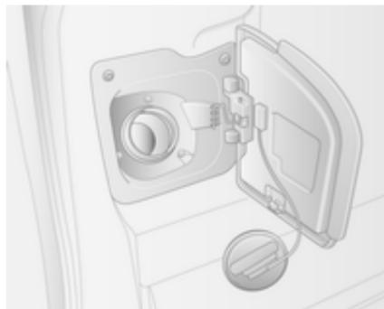
Den Tankdeckel durch Drehen nach links abschrauben.
