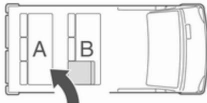
Beim erneuten Einbau der Sitze stets sicherstellen, dass die Sitzreihe mit dem klappbaren Sitz **B** ordnungsgemäß vor der festen Sitzreihe **A** positioniert ist.
