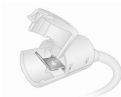
Wenn die Fahrzeugbatterie entladen ist, lässt sich das Fahrzeug mit dem Starthilfeanschluss starten. Ein Zugang zur Batterie ist dazu nicht erforderlich.
