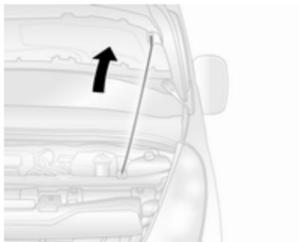
Stützstange nach oben aus dem Halter ziehen und am Haken rechts an der Unterseite der Motorhaube sichern.
