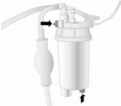
Bei jedem Motorölwechsel Restwasser aus dem Diesel-Kraftstofffilter ablassen.
