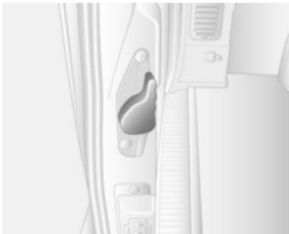
Die linke Tür wird dann über den Hebel an der Innenkante der Tür freigegeben.
