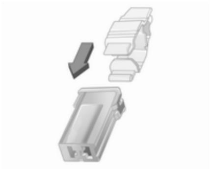
Für den Wechsel von Sicherungen befindet sich im Sicherungskasten in der Instrumententafel ein Sicherungszieher.
