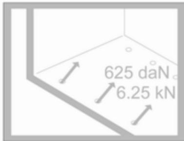
Die maximale auf die Verzurrösen einwirkende Kraft darf 625 daN/ 6,25 kN/6250 N nicht übersteigen.
