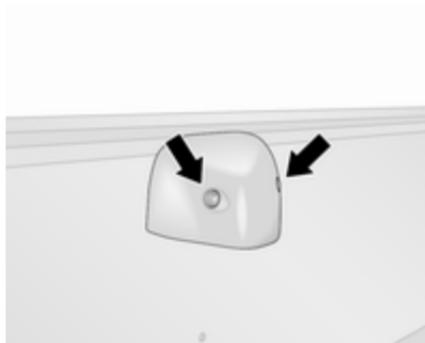
1. Die zwei Schrauben von der Streuscheibenabdeckung entfernen.
