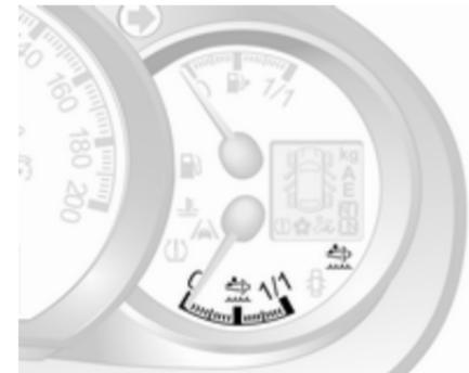
Bei Ausführungen ohne AdBlue-Füllstandswarnung im Driver Information Center ist eine AdBlue-Anzeige vorhanden, die den verbleibenden AdBlue-Füllstand im Tank anzeigt.
