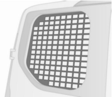
Je nach Ausführung sind die Fenster an der hinteren Tür und an der/den Schiebetür(en) mit Fenstergittern ausgestattet, die einen zusätzlichen Schutz und eine zusätzliche Sicherheit bieten.
