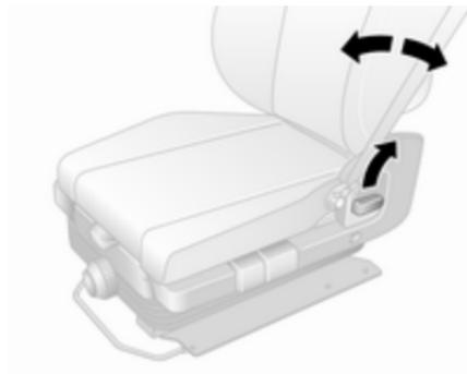
Hebel ziehen, Neigung einstellen und Hebel loslassen. Sitz hörbar einrasten lassen.
