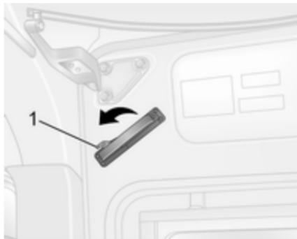
Bei einem Notfall kann die seitliche Schiebetür nach Freigeben des Innengriffs manuell geöffnet werden.
