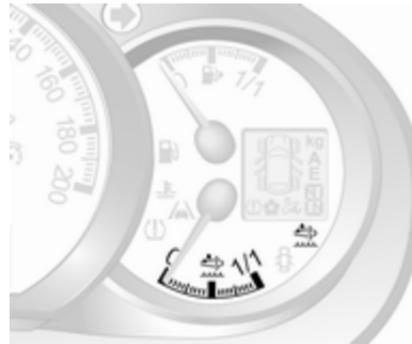
Bei Ausführungen ohne AdBlue-Füllstandswarning im Driver Information Center ist eine AdBlue-Anzeige vorhanden, die den verbleibenden AdBlue-Füllstand im Tank anzeigt. AdBlue-Anzeige ↪ 93.
