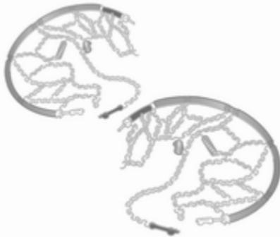
Schneeketten dürfen nur auf den Antriebsrädern montiert werden. Bei Fahrzeugen mit Doppelnägeln an der Hinterachse sind Schneeketten nur an den äußeren Rädern zulässig.
