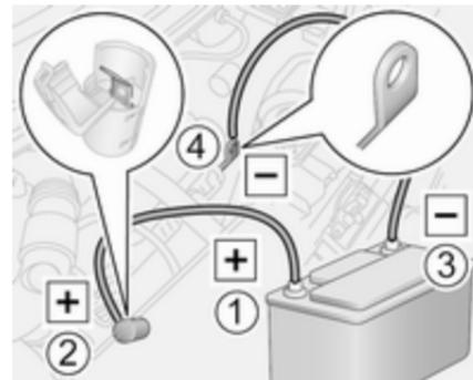
Modellabhängig kann sich der Starthilfeanschluss auf der linken oder rechten Seite des Motorraums befinden.
