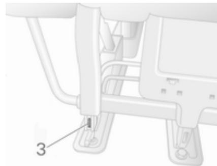
Der Sitz rastet automatisch ein und die Stifte **3** sind nicht mehr sichtbar, womit angezeigt wird, dass der Sitz verriegelt ist.
