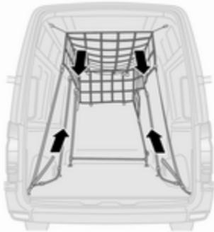
Das Sicherheitsnetz aus dem Dachbereich absenken und an den Verzurrösen im Fahrzeugboden befestigen ↻ 77.
