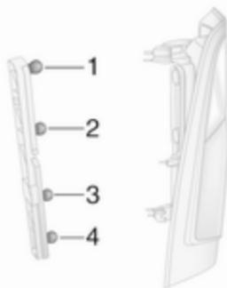
7. Die Glühlampe leicht in die Fassung drücken, linksherum drehen, herausnehmen und eine neue Glühlampe einsetzen.
