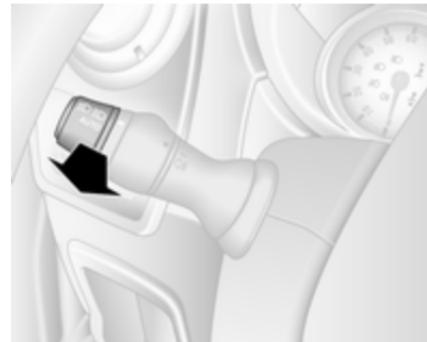
Den äußeren Lichtschalter auf **AUTO** drehen und den Blinkerhebel ziehen, um den Fernlichtassistenten zu aktivieren.
