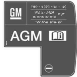
AGM-Batterien sind am entsprechenden Batterieschild zu erkennen. Wir empfehlen den Einsatz einer original Opel-Fahrzeugbatterie.
