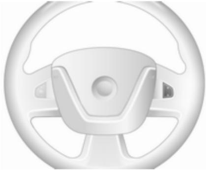
○ drücken: Der Geschwindigkeitsregler wird deaktiviert und die grüne Kontrollleuchte
