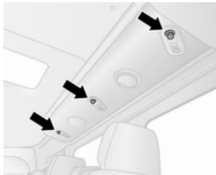
Am Dachrahmen über den Sitzen können sich verstellbare Belüftungsdüsen befinden. Einsteller drehen, um den Luftstrom zum entsprechen Sitz zu erhöhen/zu reduzieren.
