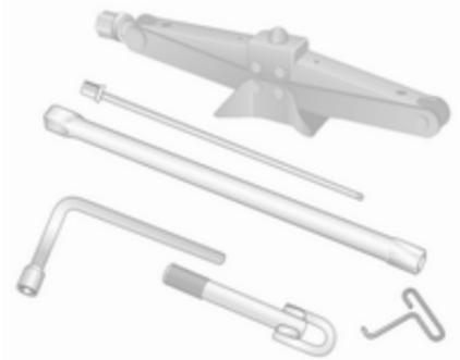
Wagenheber, Radmutternschlüssel, Adapter (für Ausbau Reserverad), Radabdeckungshaken und Abschleppöse sind als Einheit unter dem Vordersitz verstaut.
