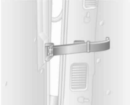
Zum Öffnen der Türen auf 180° oder weiter (modellabhängig) die Feststeller aus den Aufnahmen an den Türrahmen lösen und die Türen in die gewünschte Position bringen.
