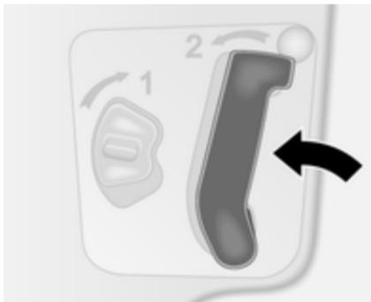
Die rechte Tür kann auch aus dem Fahrzeuginneren durch ziehen am Innengriff geöffnet werden.
