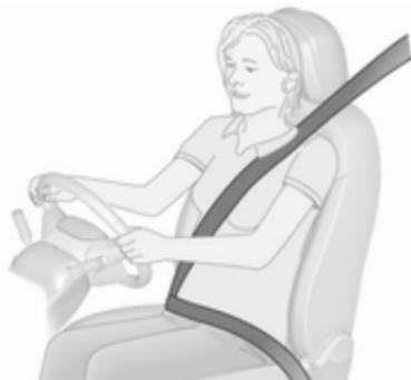
Bei starker Beschleunigung oder Verzögerung des Fahrzeugs blockieren die Sicherheitsgurte, um die Insassen in Sitzposition zu halten. Dadurch wird die Verletzungsgefahr deutlich verringert.
