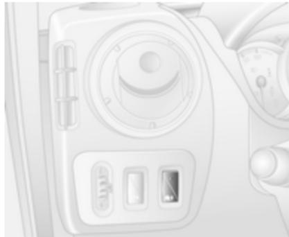
Falls nötig kann das ESP®Plus bei weicher, schlammiger oder schneebedeckter Fahrbahn deaktiviert werden, um die Traktion zu verbessern:
