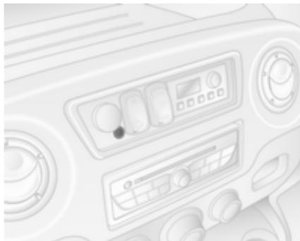
Die Anzeige leuchtet während des Betriebs des elektrischen Trittbretts auf. Wenn sie bei geschlossener Tür weiterhin aufleuchtet, die Trittstufe nicht eingefahren wird oder die Tür nicht vollständig in der verriegeltem Position eingerastet ist.
