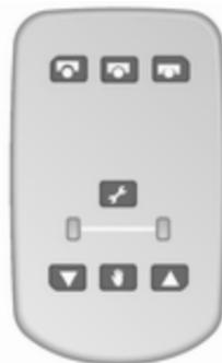
Wenn mehr Bodenfreiheit erforderlich ist oder das Einsteigen in das Fahrzeug erleichtert werden soll, kann die Federung mit Hilfe der Fernbedienung angehoben bzw. abgesenkt werden.
