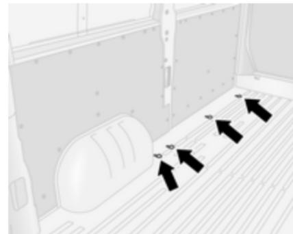
Verzurrösen im Laderaum dienen zum Sichern der Ladung mit Hilfe von Verzurrgurten oder einem Gepäckbodennetz.
