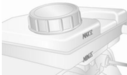
Der Bremsflüssigkeitsstand muss zwischen **MIN** und **MAX** liegen.
