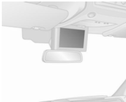
Bei Fahrzeugen mit Navigationssystem wird das Bild der Rückfahrkamera auf dem Display des Infotainment Systems angezeigt.
