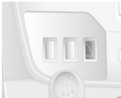
**ECO** drücken. Die Kontrollleuchte leuchtet bei Aktivierung. Gleichzeitig wird eine entsprechende Meldung im Driver Information Center angezeigt ↗ 104.
