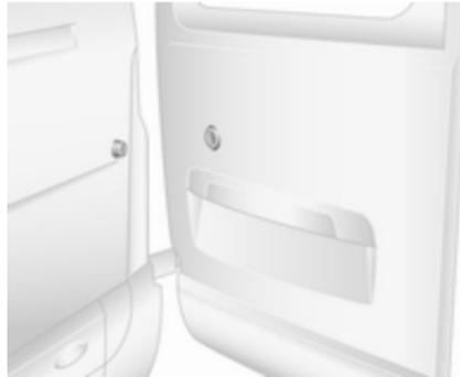
Beim Öffnen auf 270° werden die Türen von Magneten an der Karosserie in vollständig geöffneter Stellung gehalten.
