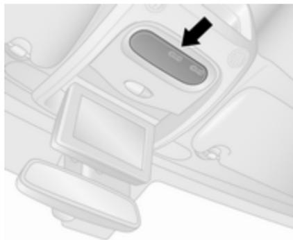
1. Leuchte mit einem flachen Schraubendreher lösen.
