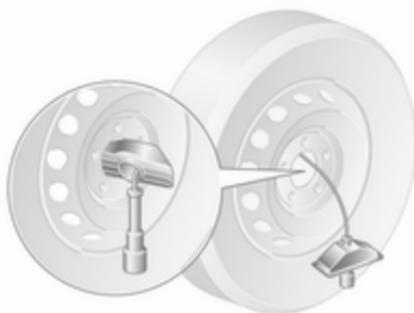
Das Rad aufrecht positionieren, die Sicherung von der Felge lösen und das Rad vom Drahtkabel und von der verbundenen Sicherung lösen. Dazu die Komponenten durch die Radmitte führen.
