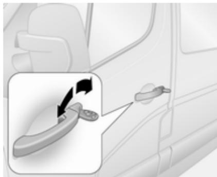
Schlüssel im Fahrertürschloss drehen. Türen durch Ziehen an den Griffen öffnen.
