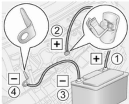
Reihenfolge für das Anschließen der Kabel:
