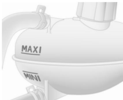
Bei kaltem Kühlsystem sollte der Kühlmittelstand knapp über der **MINI**-Markierung liegen. Bei zu niedrigem Füllstand auffüllen.
