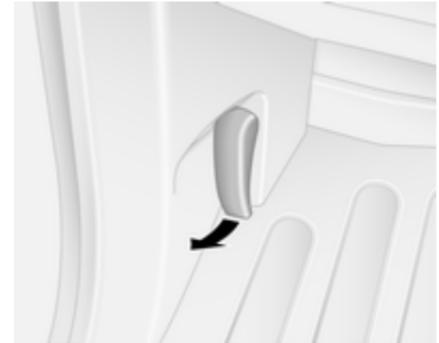
Entriegelungshebel ziehen und in die Ausgangsposition zurückführen.
