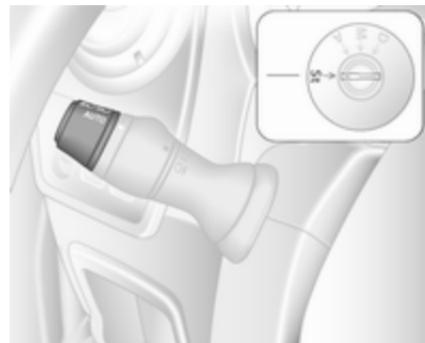
Wenn das automatische Fahrlicht bei laufendem Motor aktiviert wird, schaltet das System je nach Umgebungslicht zwischen Tagfahrlicht (wenn vorhanden) und Abblendlicht um.
