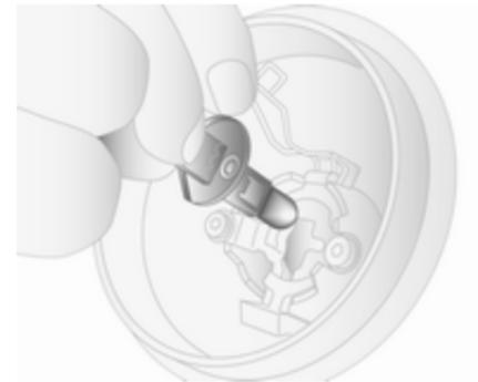
3. Federklammer lösen und die Leuchtmittelfassung aus dem Reflektorgehäuse entnehmen.
