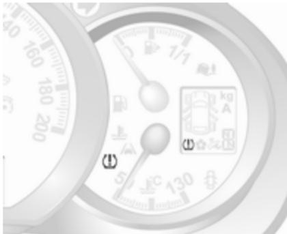
Wird ein zu niedriger Reifendruck erkannt, wird dies durch Aufleuchten der Kontrollleuchte (⚠) ⇨ 102 angezeigt, und im Driver Information Center wird eine entsprechende Meldung angezeigt.
