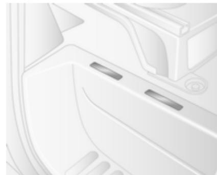
Die VIN befindet sich auch hinter einer abnehmbaren Kunststoffabdeckung an der rechten vorderen Trittstufe. Um Zugriff zu erhalten, die Abdeckung mit einem Schlitzschraubendreher lösen.
