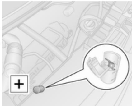
9. Das rote **+**-Kabel am Kompressor an den Starthilfeanschluss anschließen ↷ 224.
