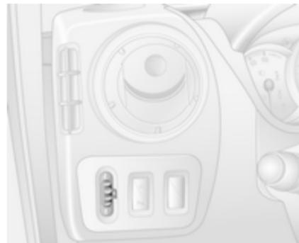
Bei eingeschaltetem Abblendlicht die Leuchtweite der Scheinwerfer an die Fahrzeugbelastung anpassen, um ein Blenden des Gegenverkehrs zu vermeiden.
