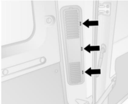
Der Sicherungskasten befindet sich hinter der Verkleidung rechts im Laderaum, neben der hinteren Tür.
