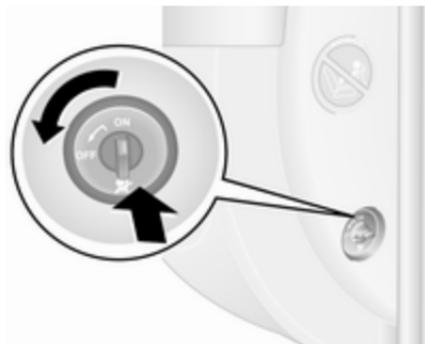
Bei ausgeschalteter Zündung die Vordertür öffnen, den Schalter drücken und nach links in die Position OFF drehen.
