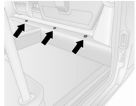
Der Sicherungskasten befindet sich unter der Stufenverkleidung unten rechts im Laderaum.
