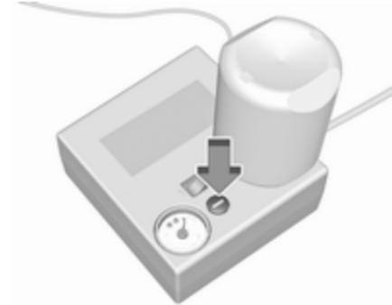
14. Der vorgeschriebene Reifendruck sollte innerhalb von zehn Minuten erreicht sein. Reifendruck  $\diamond$  259. Wenn der richtige Druck erreicht ist, den Kippschalter in Stellung **O** schalten, um den Kompressor auszuschalten.
