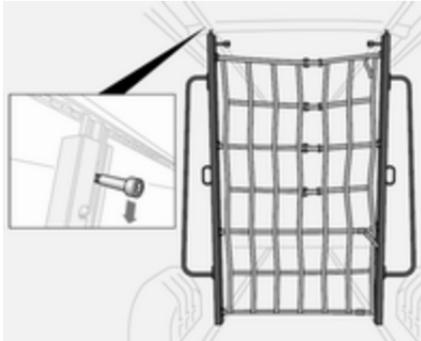
Zum Verschieben den Riegel nach unten ziehen, die Trennwand lösen und an der gewünschten Stelle positionieren. Sicherstellen, dass der Riegel voll einrastet und die Trennwand senkrecht steht.
