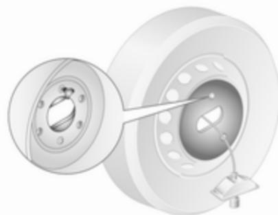
Beim Wiederanbringen eines Reserverads zuerst die Montageplatte (Fahrzeuge mit Doppelrädern hinten) anbringen und mit der Mutter sichern.
