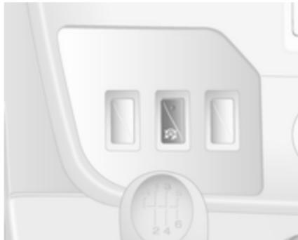
Die Stopp-Start-Automatik lässt sich durch Drücken von Ⓜ manuell deaktivieren. Die Deaktivierung wird durch das Aufleuchten der LED in der Taste angezeigt.
