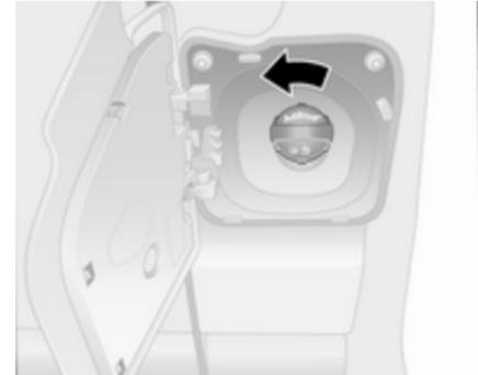
3. Die blaue Schutzkappe links herum drehen, um sie vom Einfüllstutzen abzuschrauben.
