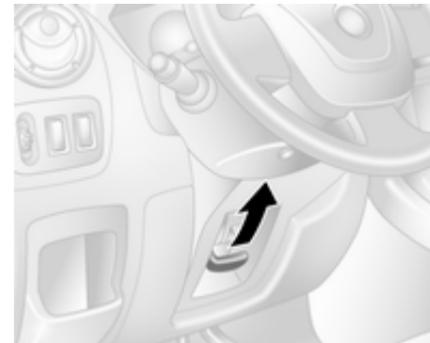
Hebel entriegeln, Lenkrad einstellen, Hebel einrasten und darauf achten, dass er komplett verriegelt ist.
