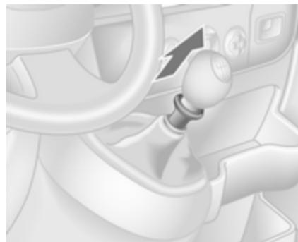
Zum Einlegen des Rückwärtsgangs bei stehendem Fahrzeug das Kupplungspedal treten, den Ring am Wählhebel nach oben ziehen und den Gang einlegen.
