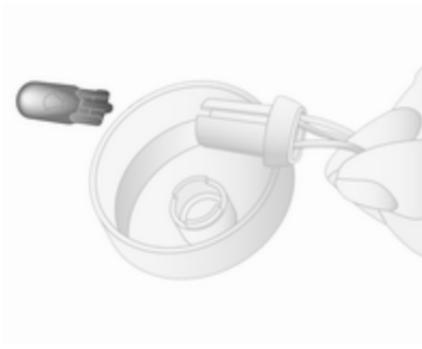
5. Die Glühlampe aus der Fassung lösen und eine neue Glühlampe einsetzen.
