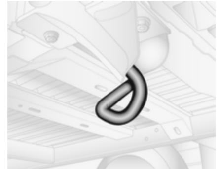
Ein Abschleppseil - oder besser noch eine Abschleppstange - an der hinteren Abschleppöse befestigen, auf keinen Fall an der Hinterachse oder den Bauteilen der Radaufhängung.
