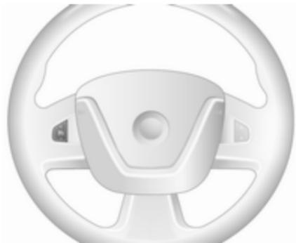
Auf die gewünschte Geschwindigkeit beschleunigen und **+** oder **-** drücken. Die aktuelle Geschwindigkeit wird jetzt gespeichert und gehalten. Das Gaspedal muss dazu nicht mehr betätigt werden.
