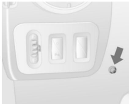
Je nach Ausführung kann der Zuheizung auch über die Tasten an der Instrumententafel für die zuletzt ausgewählte Dauer oder die Standarddauer (30 Minuten) eingeschaltet oder sofort ausgeschaltet werden. Die LED in der Taste bestätigt die Bedienung.
