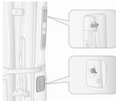
1. Das obere und untere Verkleidungsteil von der Hecksäule lösen.
