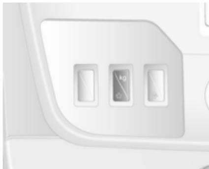
Das Lastprogramm kann sowohl im Manuell-Modus als auch im Automatik-Modus verwendet werden. In beiden Fällen werden die Schaltkennlinien automatisch an eine höhere Zuladung angepasst.
