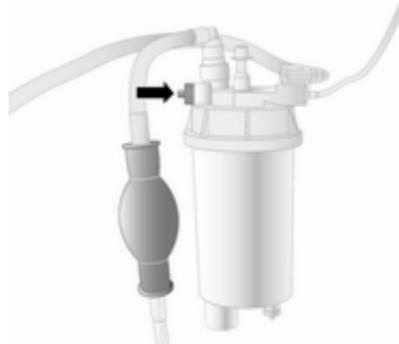
Wenn der Kraftstofftank leer gefahren wurde, muss das Diesel-Kraftstoffsystem entlüftet werden.
