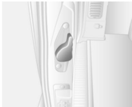
Die linke Tür wird dann mit dem Hebel entriegelt.
