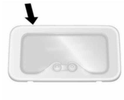
1. Leuchte mit einem flachen Schraubendreher lösen.
