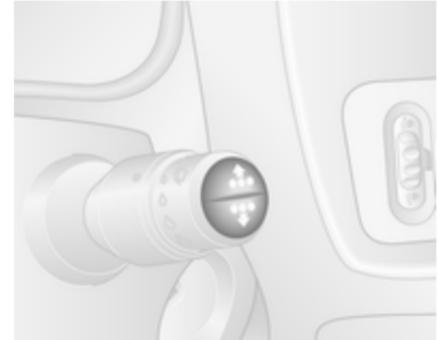
Die Uhrfunktion durch wiederholtes Drücken der Taste am Ende des Wischerhebels aufrufen. Wenn die Zeit blinkt (nach ca. zwei Sekunden):
