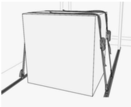
Die maximale Belastung der Ladeschienen am Boden beträgt 500 daN/700 mm.
