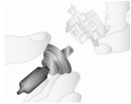
5. Die Glühlampe aus der Fassung lösen und eine neue Glühlampe einsetzen.
