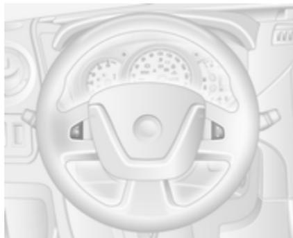
Der Geschwindigkeitsregler und Geschwindigkeitsbegrenzer können über die Bedienelemente am Lenkrad bedient werden.
