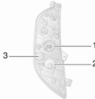
Die Scheinwerfer verfügen über separate Systeme für Fern- **1** und Abblendlicht **2**. Das Abbiegelicht **3** befindet sich zwischen den Scheinwerfern.
