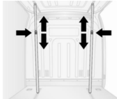
Die ausziehbaren Klemmstangen können in vertikaler Position verwendet werden, wobei sie an den Ladeschienen am Boden und am Dach gesichert werden,
