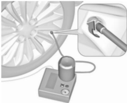
7. Den Dichtmitteleinfüllschlauch am Reifenventil anschrauben.
