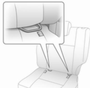
Für das Fahrzeug zugelassene ISOFIX-Kindersicherheitsysteme an ISOFIX-Befestigungshalterungen befestigen.
