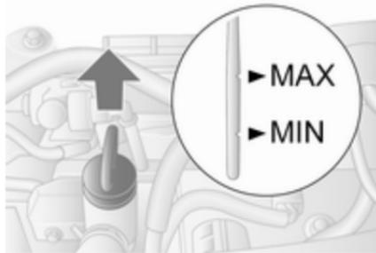
Wenn der Motorölstand in den Bereich der Nachfüllmarke **MIN** abgesunken ist, Motoröl nachfüllen.
