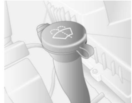
Mit einem Gemisch aus sauberem Wasser und einer geeigneten Menge frostschutzmittelhaltiger Scheibenwaschflüssigkeit auffüllen.
