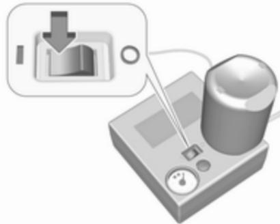
11. Kippschalter auf dem Kompressor auf die Stellung **I** stellen. Der Reifen wird mit Dichtmittel gefüllt.
