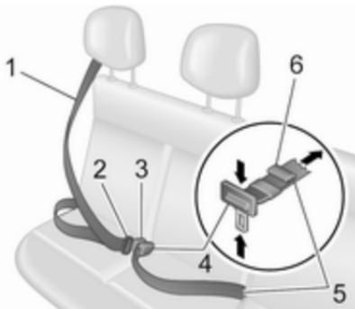
Den Gurt **1** aus dem Aufroller ziehen, unverdreht über den Körper legen und durch Ziehen an der Schloßzunge **2** sicherstellen, dass die Schloßzunge **2** vollständig im Gurtschloß **3** eingerastet ist.
