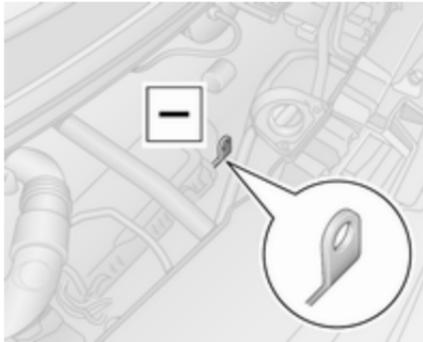
10. Das schwarze **-**-Stromversorgungskabel an einen Massepunkt des Fahrzeugs wie zum Beispiel den Motorblock oder eine Befestigungsschraube des Motors anschließen.
