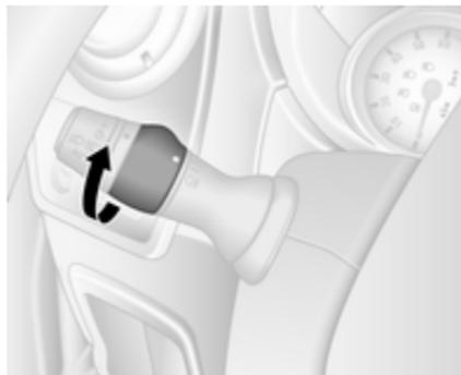
Inneren Schalter in Stellung  $\#D$  drehen und loslassen.
