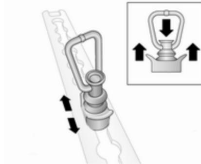
Die abnehmbaren Verzurrösen können an den Ladeschienen auf der Seite, im Boden oder am Dach gesi-
