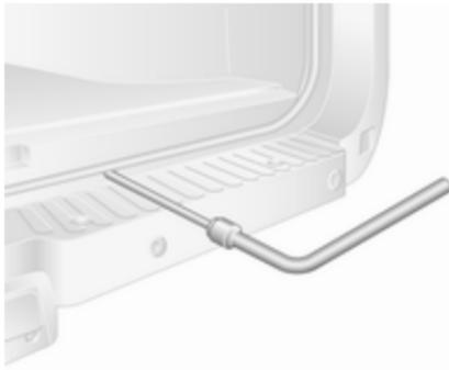
Dann den Seilzug mit dem Radschlüssel und den Adaptern festziehen. Dazu den Seilzug am oben dargestellten Schlitz anschließen und den Schlüssel gegen den Uhrzeigersinn drehen, bis sich das Rad in der vollständig angehobenen Position befindet.
