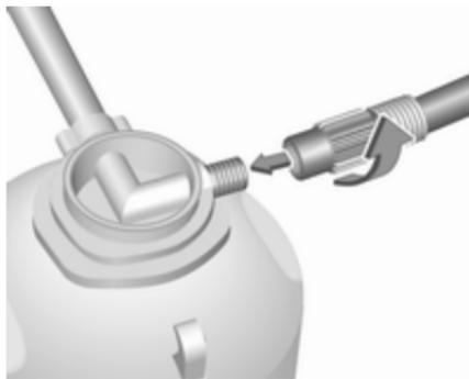
4. Den Luftschlauch des Kompressors am Anschluss der Dichtmittelflasche anschrauben.
