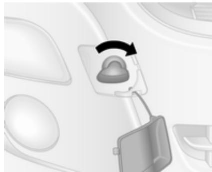
Die Abdeckung mit einem geeigneten Werkzeug lösen.
