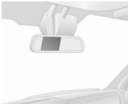
Das Display der Rückfahrkamera wird beim Einlegen des Rückwärtsgangs automatisch eingeschaltet. Ein akustisches Signal bestätigt die Aktivierung.
