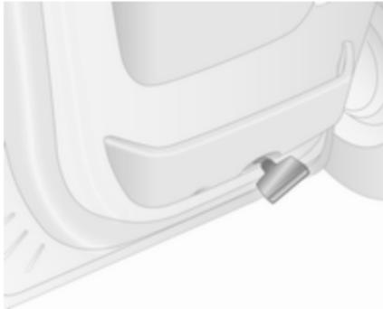
1. Leuchte mit einem flachen Schraubendreher lösen.
