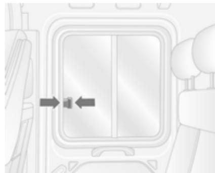
Zum Öffnen Schnapper drücken und Fenster offenschieben. Beim Schließen sicherstellen, dass der Schnapper einrastet.
