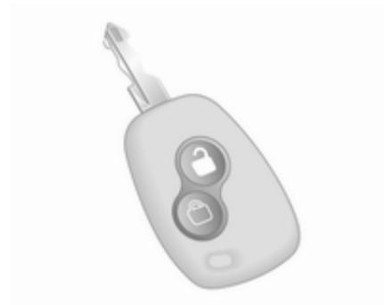
☞ drücken, um die Vordertüren zu entriegeln. Nochmals drücken, um das gesamte Fahrzeug zu entriegeln.
