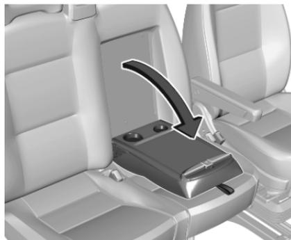
Die Getränkehalter können sich in einem ausklappbaren Ablagetisch in der Rückenlehne der Beifahrersitzlehne befinden.
