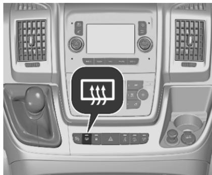
Wird durch Drücken von ☰ bedient. Die Heizung wird nach kurzer Zeit automatisch ausgeschaltet. Heckscheibenheizung ⇨ 17.
