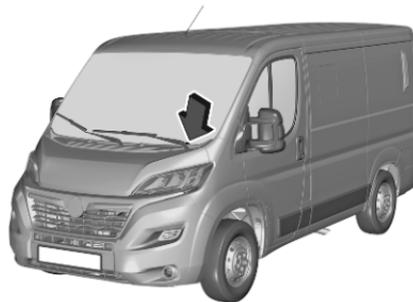
Die Fahrzeug-Identifizierungsnummer ist durch die Windschutzscheibe sichtbar in die Instrumententafel eingestanzt.
