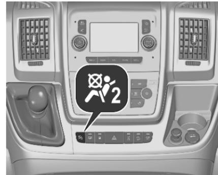
Leuchtet die Kontrollleuchte
