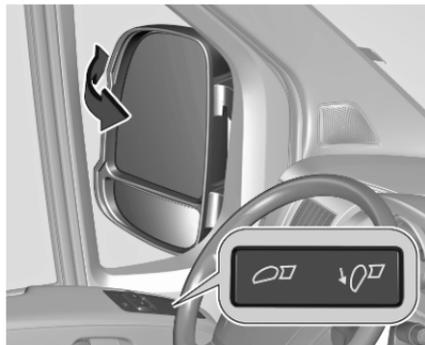
↙ drücken. Beide Außenspiegel werden eingeklappt.
