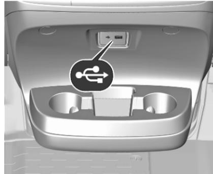
Im zentralen Stauraum befindet sich ein USB-Anschluss zum Anschluss externer Geräte an das Infotainment-System.
