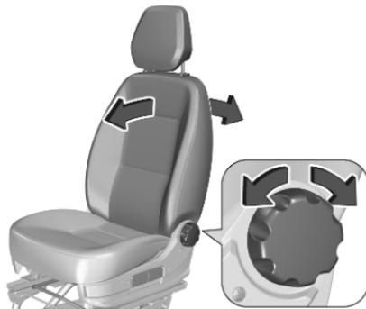
Handrad drehen. Zum Einstellen Rückenlehne entlasten.
