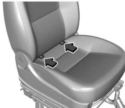
Für das Fahrzeug zugelassene ISOFIX-Kindersicherheitsysteme an den ISOFIX-Befestigungen befestigen. Die speziellen Positionen für ISOFIX-Kindersicherheitsysteme sind in der Tabelle mit gekennzeichnet ↷ 35.
