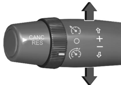
Den Bedienhebel nach oben + oder nach unten - drücken. Die gewählte Geschwindigkeit wird eingestellt.
