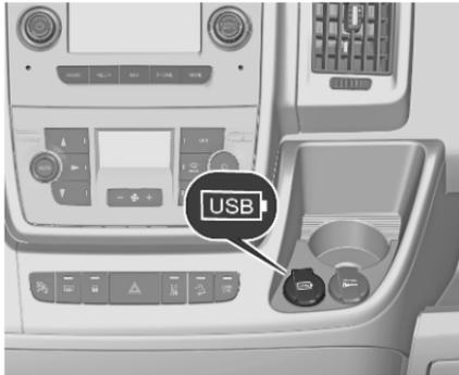
In der Instrumententafel befindet sich ein USB-Anschluss zum Laden externer Geräte.
