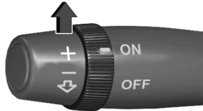
Auf die gewünschte Geschwindigkeit beschleunigen und den Bedienhebel ca. 1 Sekunde lang nach oben + bewegen. Die aktuelle Geschwindigkeit wird gespeichert und beibehalten. Gaspedal kann gelöst werden.
