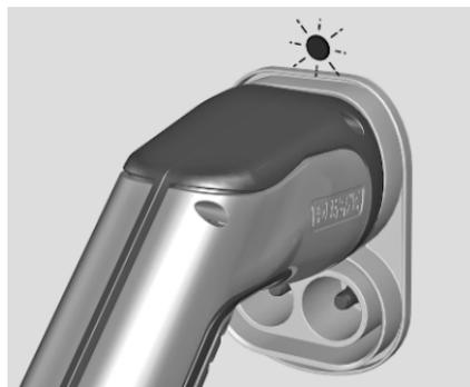
Die LED oberhalb des Ladeanschlusses leuchtet, um anzuzeigen, dass der Fahrzeugstecker verriegelt ist.
