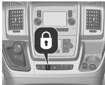
Zum Verriegeln auf
