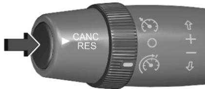
Ein Druck auf die Taste deaktiviert die Funktion. Der Geschwindigkeitsbegrenzer ist pausiert, eine Meldung wird eingeblendet.
