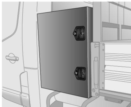
Die Riegel mit dem mitgelieferten Schlüssel öffnen und aufdrehen.
