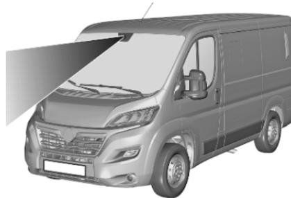
Die Auffahrwarnung erkennt ein vorausfahrendes Fahrzeug, das sich in der gleichen Fahrspur vor dem eigenen Fahrzeug befindet, mithilfe der Frontkamera in der Windschutzscheibe.
