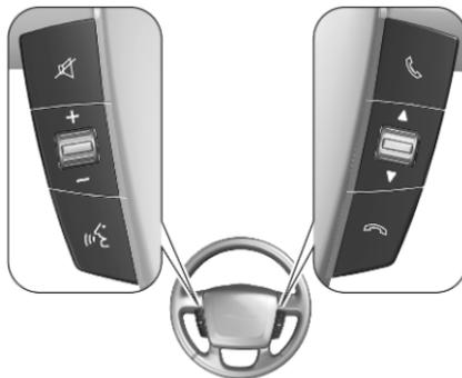
Die Bedienelemente am Lenkrad können für Audio- und Mobiltelefonfunktionen verwendet werden.
