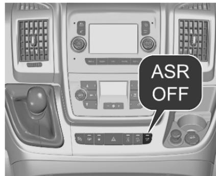
Die Traktionskontrolle kann im Bedarfsfall durch Drücken auf **ASR OFF** ausgeschaltet werden.
