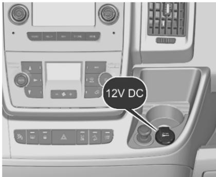
In der Instrumententafel befindet sich eine 12-V-Steckdose.
