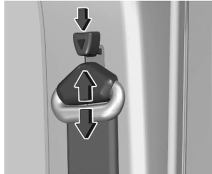
Die Taste drücken, um den Sicherheitsgurt zu lösen und die Höhe einzustellen.
