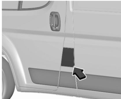
Die Tankklappe durch Ziehen der Klappe öffnen.
