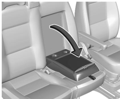
Die Lehne des mittleren Beifahrersitzes kann mit einer Dokumentenablage versehen sein.
