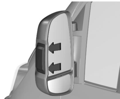
1. Die beiden Befestigungsschrauben entfernen.
