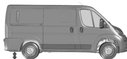
Zum leichteren Be- und Entladen kann die Höhe der hinteren Ladekante verstellt werden.
