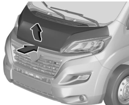
Schnappriegel hochdrücken und Motorhaube öffnen.
