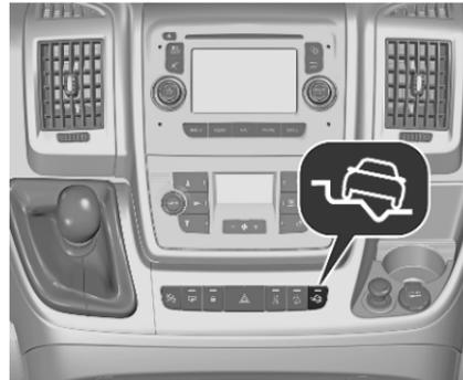
Bei Geschwindigkeiten unter ca. 30 km/h
