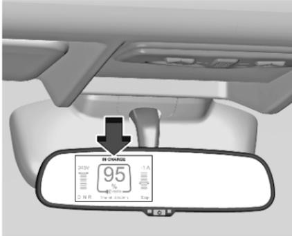
Der Beginn des Ladevorgangs wird durch eine Meldung im Display des Rückspiegels angezeigt.
