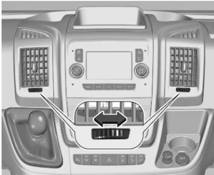
Die Luftmenge am Belüftungsdüsenausgang durch Drehen des Einstellrädchens einstellen. Die Belüftungsdüse ist geschlossen, wenn das Einstellrädchen fast ganz nach links oder rechts gedreht wird.
