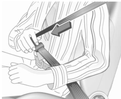
Den Sicherheitsgurt aus dem Aufroller herausziehen, unverdreht über den Körper führen und die Schloßzunge in das Gurtschloss einstecken, bis sie einrastet. Sicherstellen, dass der Gurt während der Fahrt eng am Körper anliegt.
