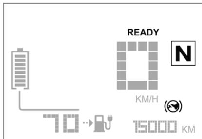
Wenn eine Fahrposition ausgewählt ist und innerhalb von fünf Sekunden kein Druck auf die Pedale ausgeübt wird, ertönt ein Warnton.
