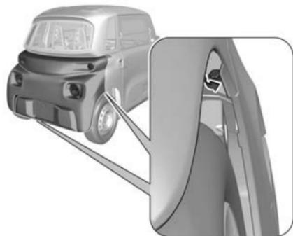
5. Die zwei unteren seitlichen Befestigungsschrauben von den Radkästen entfernen.
