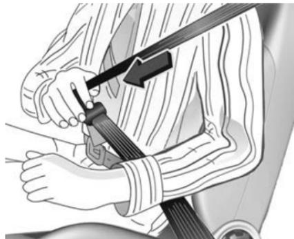
Den Sicherheitsgurt aus dem Aufroller herausziehen, unverdreht über den Körper führen und die Schloßzunge in das Gurtschloss einstecken, bis sie einrastet. Sicherstellen, dass der Sicherheitsgurt über die Schulter verläuft und während der Fahrt eng am Körper anliegt.
