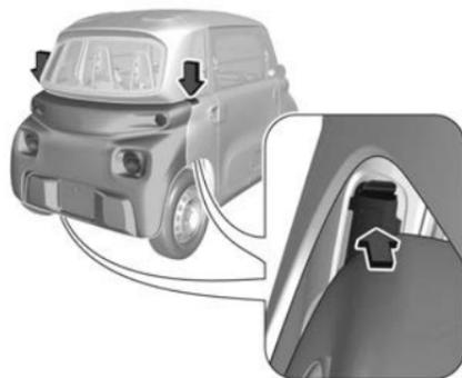
3. Die zwei oberen Zugangsklappen von den Kotflügeln entfernen.
