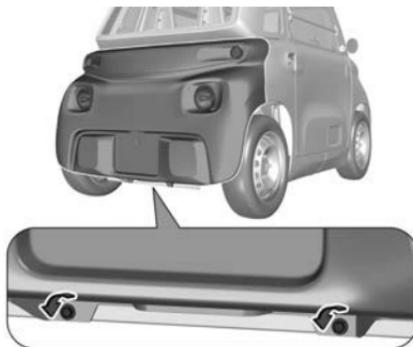
2. Die zwei unteren Befestigungsschrauben vom Rahmen entfernen.
