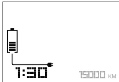
Die verbleibende Ladedauer wird im Fahrerinfodisplay angezeigt. Wenn der Ladevorgang abgeschlossen ist, wird im Fahrerinfodisplay **0:00** angezeigt oder das Fahrerinfodisplay wird ausgeschaltet.
