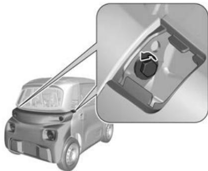
4. Die zwei oberen seitlichen Befestigungsschrauben von den Flügeln entfernen.
