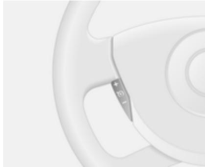
Beschleunigen Sie auf die gewünschte Geschwindigkeit und drücken Sie den Schalter **+** oder **-**. Die aktuelle Geschwindigkeit wird nun gespeichert und aufrecht erhalten und das Gaspedal kann losgelassen werden.
