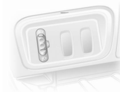
Leuchtweite der Scheinwerfer an die Fahrzeugbelastung anpassen, um ein Blenden des Gegenverkehrs zu vermeiden.
