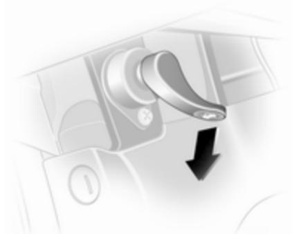
Entriegelungshebel ziehen und in die Ausgangsposition zurückführen.
