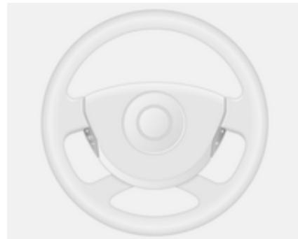
Geschwindigkeitsregler und Geschwindigkeitsbegrenzer können über die Bedienelemente am Lenkrad betätigt werden.
