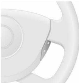
Schalter **O** drücken: Geschwindigkeitsregler ist deaktiviert und die grüne Kontrollleuchte
