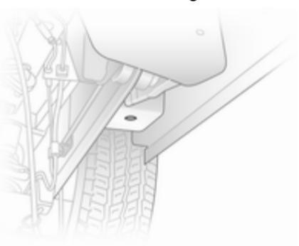
3. Zum Anheben des Fahrzeugs die Stützfläche des Wagenhebers unter dem Wagenheber-Ansatzpunkt positionieren, der dem zu wechselnden Rad am nächsten liegt.
