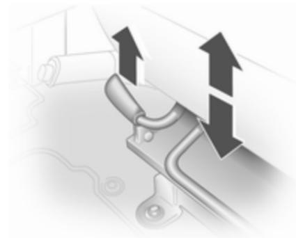
Hebel anheben und durch Veränderung des Körpergewichts anheben oder absenken.
