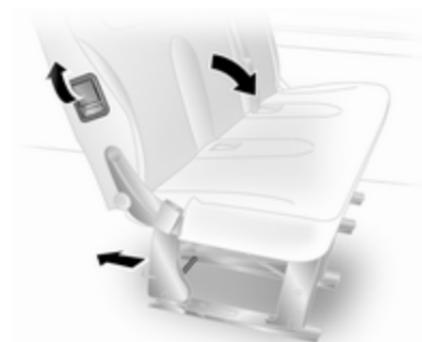
Kopfstützen ausbauen ⇨ 31. Kopfstützen ausbauen. Am seitlichen Griff zum Lösen der Rückenlehne ziehen und diese nach vorn auf die Sitzfläche klappen, ggf. die Sicherheitsgurte mit zwei Schlossungen von ihren Gurtschlössern lösen.
