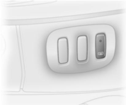
Die Heizung wird durch Drücken der Taste
