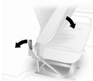
Zum leichteren Zugang zu den Rücksitzen Rückenlehne nach vorn klappen. Ggf. den Gurt mit zwei Schlossungen von seinen Gurtschlössern lösen.
