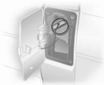
Zum Entriegeln und Öffnen des Tankdeckels den Schlüssel einstecken und nach links drehen. Nach Ende des Tankvorgangs den Tankdeckel wieder aufsetzen und den Schlüssel so weit wie möglich nach rechts drehen.
