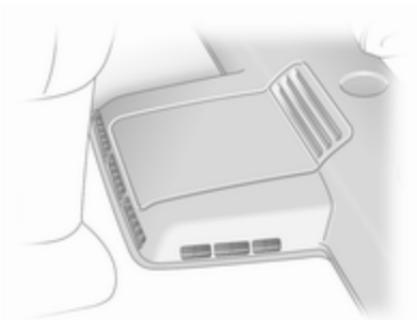
Das Heizgebläse des hinteren Fahrgastraums leitet den Luftstrom über die hinteren Belüftungsdüsen in den hinteren Fahrgastraum.
