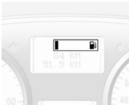
Zeigt den Kraftstoffstand im Tank an. Erleuchtung der Segmente zeigt den Kraftstoffstand an.
