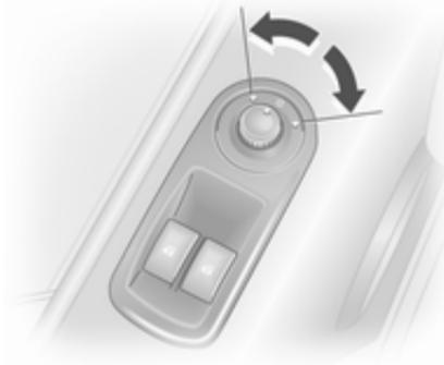
Den entsprechenden Außenspiegel durch Drehen des Schalters nach links oder rechts auswählen. In der Mittelstellung ist kein Spiegel ausgewählt.
