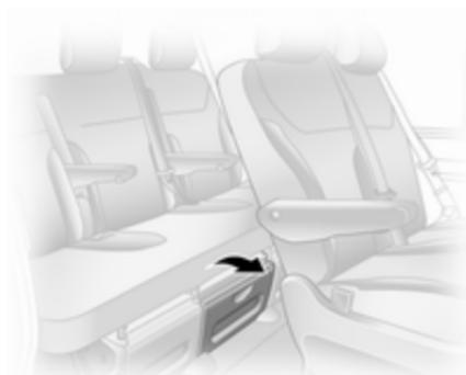
Zum Verstauen langer Gegenstände unter den Sitzen kann die Verkleidung des mittleren Sitzes ausgehängt werden.
