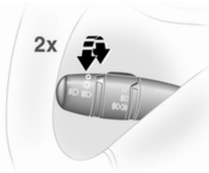
Bei laufendem Motor werden die Scheinwerfer abhängig von den äußeren Lichtverhältnissen eingeschaltet.
