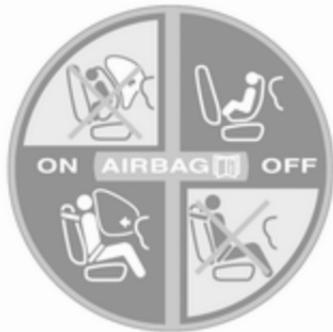
Das System der Airbagabschaltung ist durch einen Aufkleber an der Seite der Instrumententafel gekennzeichnet und bei geöffneter Beifahrertür sichtbar.
