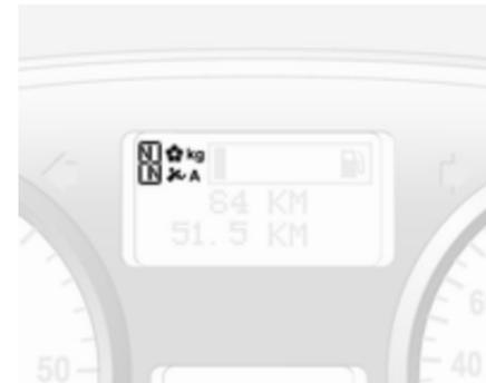
Der Modus oder der eingelegte Gang des automatisierten Schaltgetriebes wird im Fahrerinformationszentrum angezeigt.
