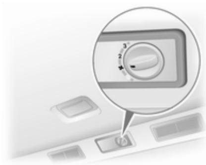
Der Luftdurchsatz wird durch das Gebläse bestimmt. Die Lufttemperatur wird mit dem Temperaturregler an der Instrumententafel eingestellt.
