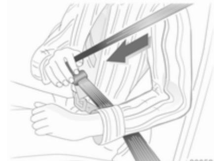
Gurt aus dem Aufroller herausziehen, unverdreht über den Körper legen und die Schlosszunge in das Gurtschloss einstecken, bis sie einrastet. Den Beckengurt während der Fahrt durch Ziehen am Schultergurt regelmäßig anziehen.
