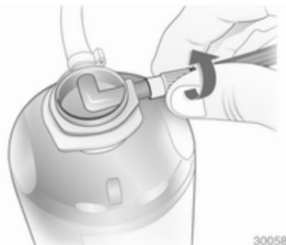
3. Den Luftschlauch des Kompressors am Anschluss der Dichtmittelflasche anschrauben.
