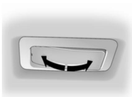
Bedienung durch Schwenken der Leuchte in eine von 3 Positionen:
