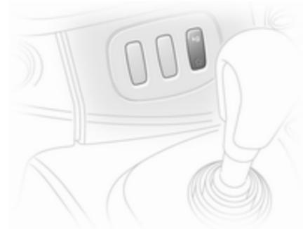
Das Lastprogramm kann sowohl im Manuell-Modus als auch im Automatik-Modus verwendet werden. In beiden Fällen werden die Schaltkennlinien automatisch an eine höhere Zuladung angepasst.
