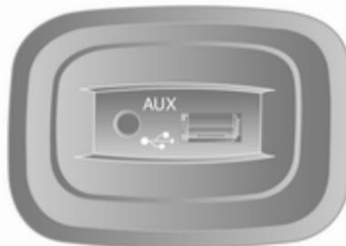
In der Infotainment-Einheit (oder in der Mittelkonsole) befindet sich eine USB-Buchse zum Anschluss externer Audioquellen.
