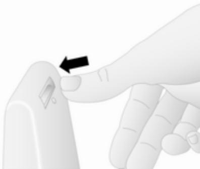
Verriegelung auf der Rückseite der Fernbedienung drücken und die Tastatur abheben.
