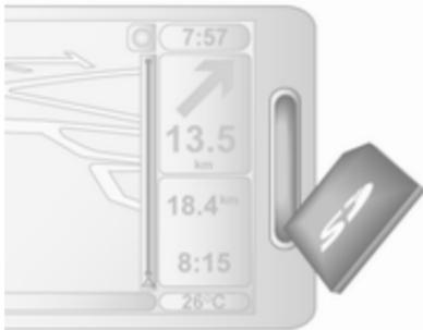
Stellen Sie sicher, dass die SD-Karte richtig eingesetzt ist. Die Ausrichtung kann je nach Lage des SD-Kartensteckplatzes im Fahrzeug unterschiedlich sein.
