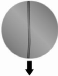
Bei Bedarf zuerst die Abdeckung innen an der Hecktür entfernen und dann das Metallband zum Entriegeln nach unten ziehen. Die Hecktür in die offene Position drücken.
