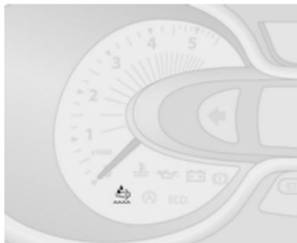
Wenn der AdBlue-Füllstand unter einen bestimmten Wert fällt, wird eine Füllstandswarnung im Driver Information Center (DIC) angezeigt ↗ 94. Zusätzlich leuchtet die Kontrollleuchte
