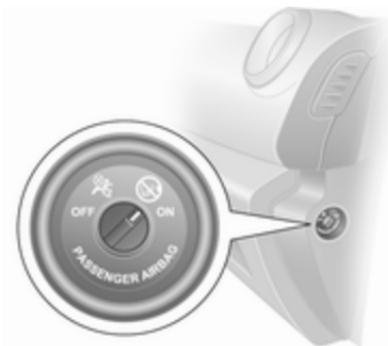
Das Beifahrer-Airbag-System lässt sich mit einem Schalter seitlich an der Instrumententafel deaktivieren. Die vordere Beifahrertür öffnen, um auf den Schalter zurückzugreifen.
