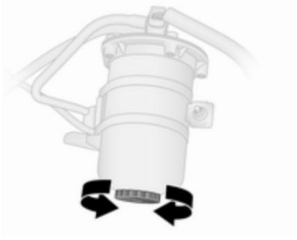
Bei jedem Motorölwechsel Restwasser aus dem Filter ablassen.
