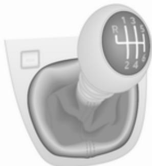
Zum Einlegen des Rückwärtsgangs bei stehendem Fahrzeug das Kupplungspedal treten, den Ring am Schalthebel nach oben ziehen und den Gang gegen den Widerstand einlegen.
