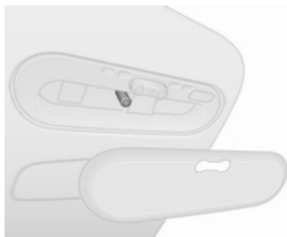
1. Streuscheibenzusammenbau mit einem Schlitzschraubendreher von den Clips und dem Positionierer lösen.
