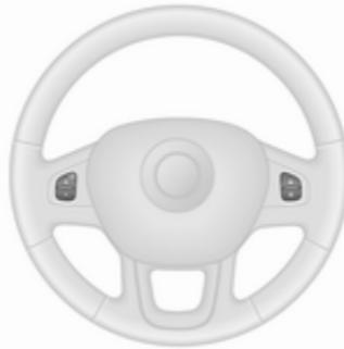
Der Geschwindigkeitsregler und Geschwindigkeitsbegrenzer können über die Bedienelemente am Lenkrad bedient werden.
