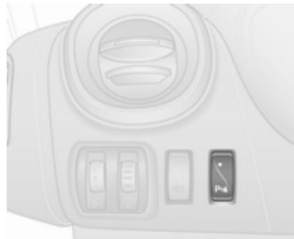
Das System durch Drücken auf **P**▲ auf der Instrumententafel bei eingeschalteter Zündung deaktivieren. Die LED leuchtet in der Taste auf, wenn das System deaktiviert ist. Beim Einlegen des Rückwärtsgangs ertönt kein akustisches Signal.
