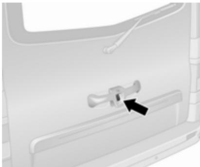
Nach Entriegelung den Hecktürknopf drücken und die Hecktür auf die vollständig geöffnete Position anheben.
