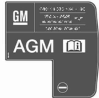
AGM-Batterien sind am entsprechenden Batterieschild zu erkennen. Wir empfehlen den Einsatz einer original Opel-Batterie.
