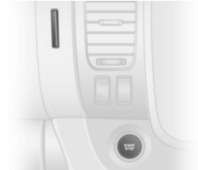
Der elektronische Schlüssel muss sich innerhalb des Fahrzeugs befinden, entweder im Kartenleser oder im vorderen Fahrgastraum.
