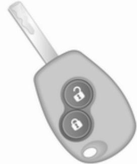
Abhängig von der Konfiguration
