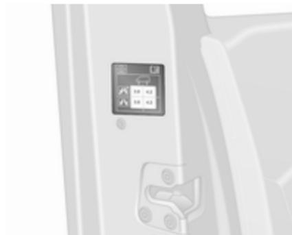
Das Reifendruckhinweisschild am Fahrertürrahmen gibt die Originalreifen und die entsprechenden Reifendrucke an. Reifen immer auf die am Hinweisschild angegebenen Druckwerte auffüllen.
