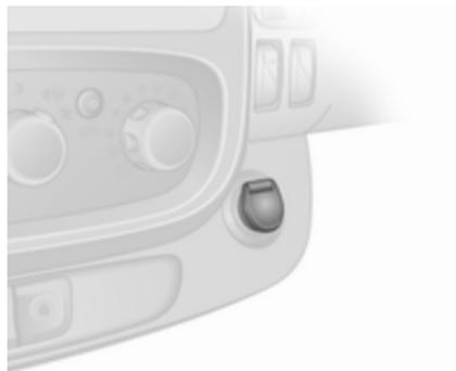
12-V-Zubehörsteckdosen befinden sich auf der Instrumententafel und hinten im Fahrzeug. Die Abdeckung nach oben klappen.
