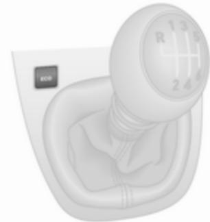
**ECO** drücken. Die Kontrollleuchte **ECO** leuchtet bei Aktivierung im Instrument.
