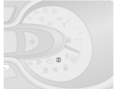
Wird ein zu niedriger Reifendruck erkannt, wird dies durch Aufleuchten der Kontrollleuchte (⚠) ⇨ 92 angezeigt, und im DIC wird eine entsprechende Meldung angezeigt.
