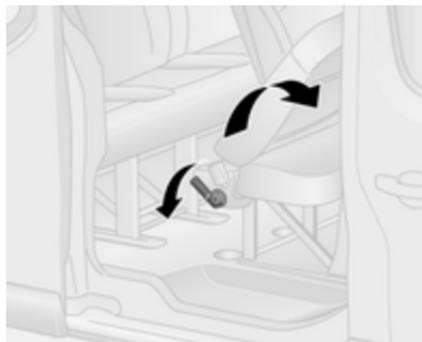
Um besseren Zugang zu den Rücksitzen zu erhalten, Entriegelungshebel ziehen und Rückenlehne nach vorne klappen. Falls erforderlich, die Sicherheitsgurte aus ihren Schlössern lösen.
