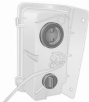
1. 2 Schrauben lösen (mit dem mitgelieferten Werkzeug) und Leuchte abbauen.
