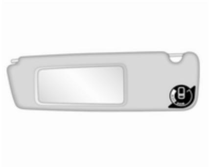
Manche Fahrzeuge sind mit einem großen konvexen Spiegel auf der Beifahrerseite der Sonnenblende ausgestattet, der die Sicht verbessert und tote Winkel reduziert.
