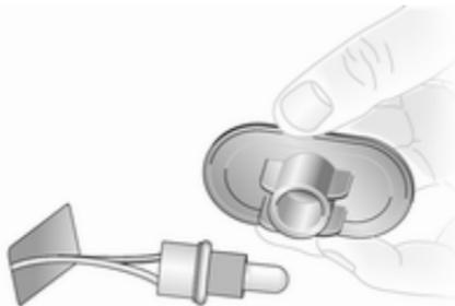
1. Lampenzusammenbau vom Kotflügel lösen. Dazu mit einem geeigneten Werkzeug auf die Clips drücken und den Lampenzusammenbau durch die Öffnung herausnehmen.
