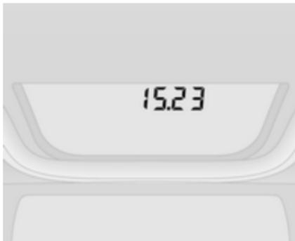
Die Uhreinstellfunktion durch wiederholtes Drücken der Taste am Ende des Wischerhebels aufrufen.
