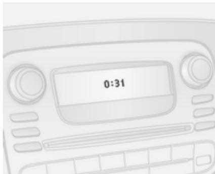
Stunden und Minuten können durch Drücken der entsprechenden Tasten neben dem Display oder über die Bedienelemente des Infotainmentsystems eingestellt werden.
