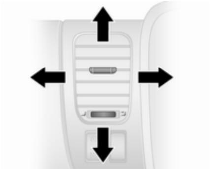
Um die mittleren Belüftungsdüsen zu öffnen oder schließen und den Luftstrom einzustellen, die Lamellen nach oben oder unten drehen und das Einstellrad nach links oder rechts drehen.
