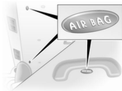
Das Kopf-Airbag-System besteht aus je einem Airbag an jeder Seite des Dachrahmens. Diese Stellen sind durch die Aufschrift **AIRBAG** in der Dachverkleidung gekennzeichnet.
