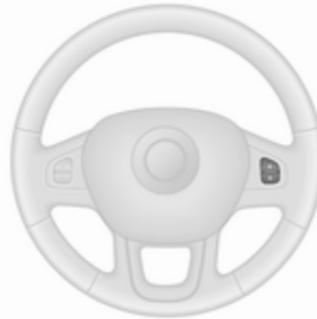
**O** drücken: Der Geschwindigkeitsregler wird deaktiviert und die grüne Kontrollleuchte
