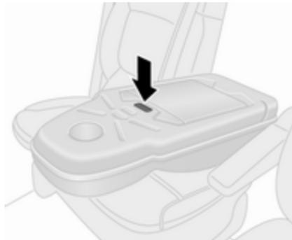
Den Knopf (siehe Pfeil) an der Rückseite der Sitzlehne drücken, um die Dokumentenablage zu entriegeln und auf die Ablagefächer zuzugreifen.
