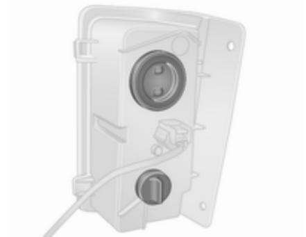
1. 2 Schrauben lösen (mit dem mitgelieferten Werkzeug) und Leuchte abbauen.
