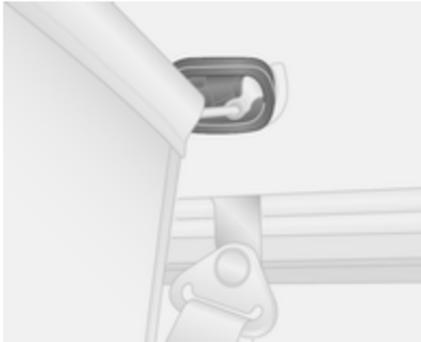
Die Abdeckungen im Dachhimmel (mit einem flachen Schraubendreher) lösen, um die Halterungen freizulegen. Dann die Laderaumnetzstangen in die linken und rechten Halterungen stecken und sichern.
