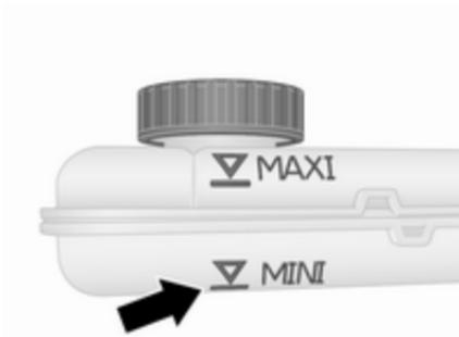
Der Bremsflüssigkeitsstand muss zwischen den Markierungen **MINI** und **MAXI** liegen.
