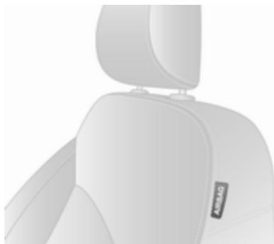
Das Seiten-Airbag-System besteht aus einem Airbag in der Rückenlehne jedes Vordersitzes. Diese Stellen können mit dem Wort **AIRBAG** gekennzeichnet sein.
