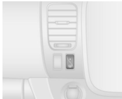
Die Heizung wird durch Drücken der Taste
