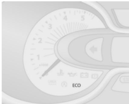
Beim Fahren kann der ECO-Modus vorübergehend deaktiviert werden, z. B. um die Motorleistung zu erhöhen, indem das Gaspedal kräftig durchgetreten wird.
