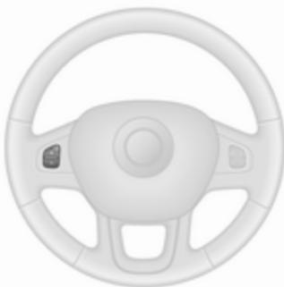
Auf die gewünschte Geschwindigkeit beschleunigen und **+** oder **-** drücken. Die aktuelle Geschwindigkeit wird jetzt gespeichert und gehalten. Das Gaspedal muss dazu nicht mehr betätigt werden.
