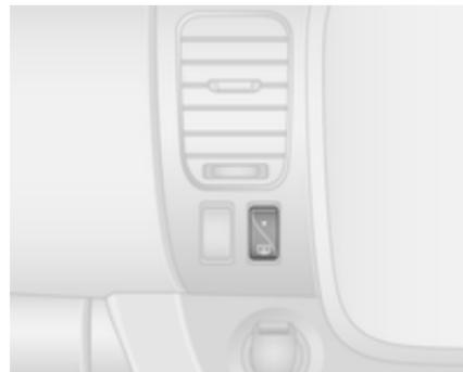
Wird durch Drücken der Taste
