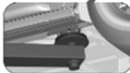
Die Position der hinteren Arme der Hebebühne befindet sich mittig unter den entsprechenden Wagenheberaufnahmen.
