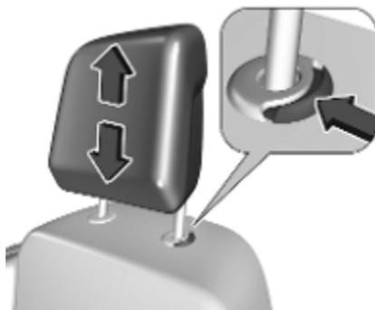
Die Kopfstütze nach oben oder unten schieben. Wenn die Kopfstütze eingerastet ist, auf die Arretierung drücken und dann die Kopfstütze bewegen.
