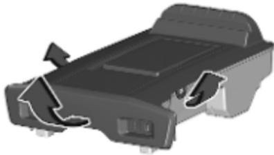
4. Haltetaschen an der Abdeckung lösen und Kasten öffnen.
