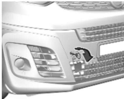
Abschleppöse rechtsherum bis zum Anschlag in waagerechter Stellung einschrauben.
