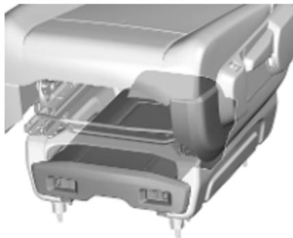
Das Wagenwerkzeug befindet sich im Kasten unter dem linken Vordersitz.
