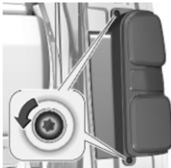
2. Die beiden Schrauben losschrauben und abnehmen.
