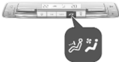
Zur Aktivierung der Verteilung gekühlter/erwärmter Luft über die hinteren Belüftungsdüsen auf
