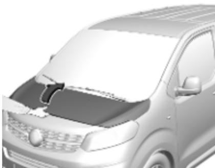
Schnappriegel hochdrücken und Motorhaube öffnen.
