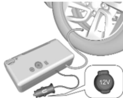
5. Das Elektrokabel an die vordere 12-V-Steckdose am Fahrzeug anschließen ⇨ 102.
