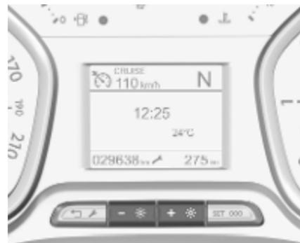
Die Helligkeit kann bei eingeschalteter Außenbeleuchtung angepasst werden.
