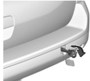
Abschleppöse rechtsherum bis zum Anschlag in waagerechter Stellung einschrauben.
