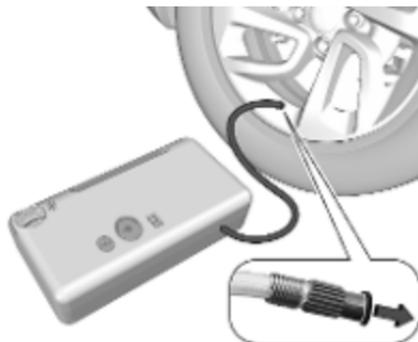
4. Luftschlauch ganz abwickeln und Kappe vom Ende des Schlauchs abdrehen. Schlauch am Ventil des platten Reifens befestigen.
