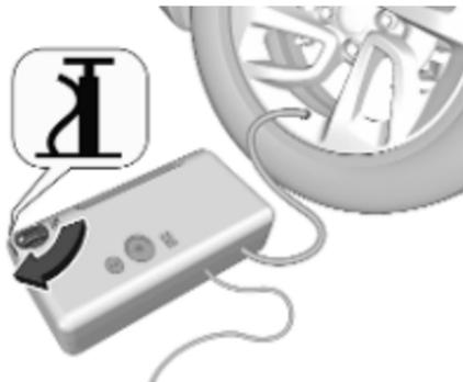
12. Sofort anfahren, damit sich das Dichtmittel im Reifen gleichmäßig verteilt. Nach ca. 5 km oder spätestens nach zehn Minuten anhalten und Reifendruck kontrollieren. Wählknopf am Reparaturset auf das Luftpumpensymbol
