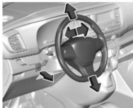
Griff entriegeln, Lenkrad einstellen, Griff einrasten und darauf achten, dass er komplett verriegelt ist. Lenkrad nur bei stehendem Fahrzeug und gelöster Lenkradsperrung einstellen.
