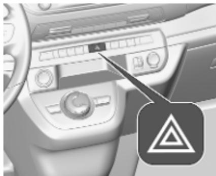
Wird durch Drücken von
