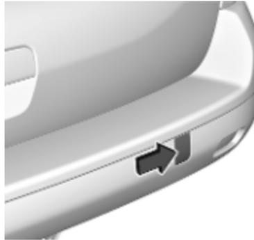
Zum Entriegeln auf die linke obere Ecke der Abdeckung am Heckstoßfänger drücken.
