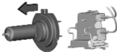
3. Die Lampe aus der Lampenfassung lösen und ersetzen.
