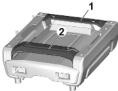
1. Der Kasten wird durch zwei Stangen gesichert, die ein Verrutschen bei fehlerhaftem Verstauen verhindern.
