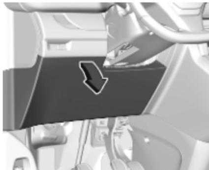
Zum Abnehmen der Abdeckung zuerst an der linken, dann an der rechten oberen Ecke ziehen.
