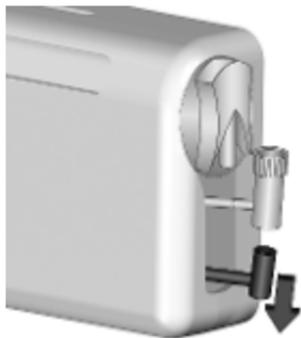
3. Rohrbaugruppe leicht herausziehen und dann den Stecker um eine viertel Umdrehung linksherum drehen und vom Luftschlauch trennen.
