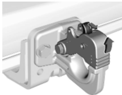
2. Hebel ziehen und den Schlepphaken öffnen.
