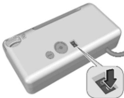
6. Wippschalter auf dem Kompressor auf I stellen. Der Reifen wird mit Dichtmittel gefüllt.
