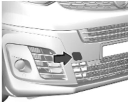
Mittig auf die Abdeckung drücken und zur linken oberen Seite schieben, um sie zu lösen.
