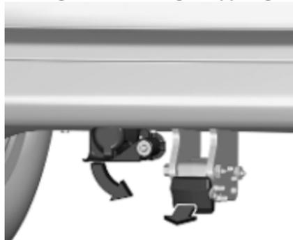
1. Anschlussbuchse nach unten drehen. Kappe abnehmen.
