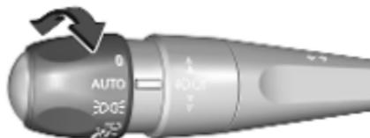
**AUTO** : Automatische Lichtsteuerung, schaltet automatisch zwischen Tagfahr- und Abblendlicht um
