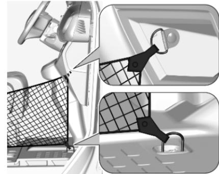
4. Die Haken an den Verzurrösen im Handschuhfach und am Boden befestigen.
