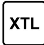
Paraffinischer Dieseldieselkraftstoff gemäß der Norm EN15940, gemischt mit einem Biokraftstoff gemäß der Norm EN14214 (mit bis zu 7 % Fettsäuremethylester)
