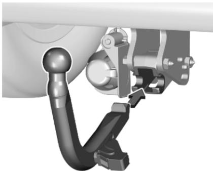
2. Anschlussstange der Anhängerkupplung in die Öffnung einsetzen und fest bis zum Anschlag nach oben drücken.
