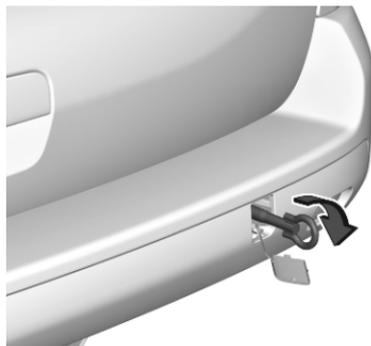
Abschleppöse rechtsherum bis zum Anschlag in waagerechter Stellung einschrauben.
