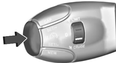
Bei einer Geschwindigkeit über 40 km/h die Taste drücken, um zur gespeicherten Geschwindigkeit zurückzukehren.
