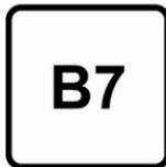
Dieseldieselkraftstoff gemäß der Norm EN590, gemischt mit einem Biokraftstoff gemäß der Norm EN14214 (mit bis zu 7 % Fettsäuremethylester)
