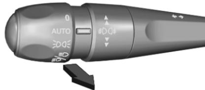
Zum Aktivieren des Fernlichts den Hebel über den Widerstandspunkt hinaus ziehen.
