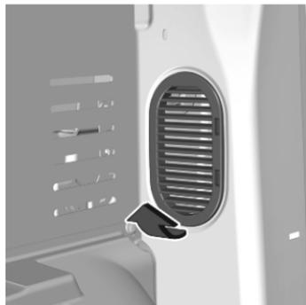
3. Fahrzeuge mit Belüftungsdüsen oder Abdeckung der Rückleuchten, in der Verkleidung: Belüftungsdüsen oder Abdeckung abnehmen.
