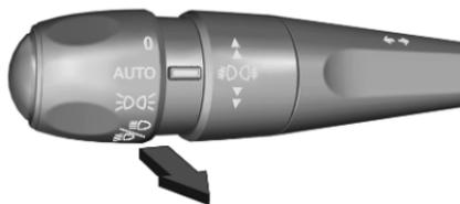
Zum Einschalten der manuellen Wegausleuchtung die Zündung ausschalten, die Fahrertür öffnen und am Blinkerhebel ziehen.
