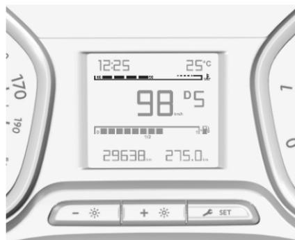
Eine Skala aus weißen Segmenten zeigt die Motorkühlmitteltemperatur an.
