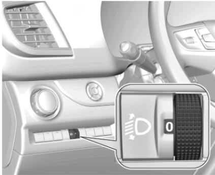
Zur Anpassung der Leuchtweite an die Fahrzeuglast, um die Blendwirkung zu reduzieren: Daumenrädchen
