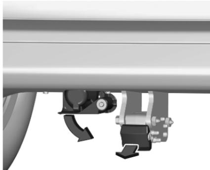
1. Anschlussbuchse nach unten drehen. Kappe abnehmen.
