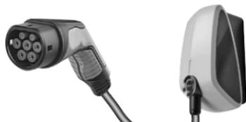
Eine Wallbox ist ein Ladegerät für Privathaushalte. Unter Umständen ist die Wallbox mit einem integrierten Mode-3-Ladekabel ausgestattet, das am Ladeanschluss des Fahrzeugs angeschlossen wird. Zum Laden an einer Wallbox ohne integriertes Mode-3-Kabel ist ein tragbares Mode-3-Ladekabel erforderlich.
