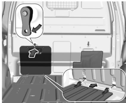
Die Arretiervorrichtung nach oben drehen. Die Scharniere der Klappe in die Aussparungen einsetzen, die Klappe hochklappen und die Arretiervorrichtung schließen.
