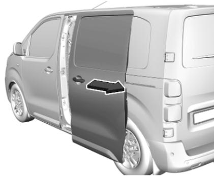
Nach dem Entriegeln am Außentürgriff ziehen und die Tür über den Widerstandspunkt hinaus nach hinten schieben.
