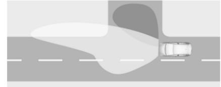
Beim Abbiegen mit bis zu 40 km/h aktiviert. Je nach Lenkwinkel und Aktivierung der Blinker leuchten die Nebelscheinwerfer die Fahrtrichtung aus.
