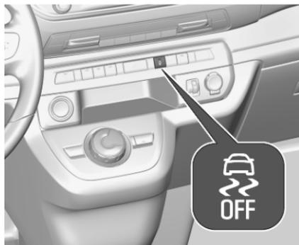
ESC und Traktionskontrolle können im Bedarfsfall durch Drücken auf
