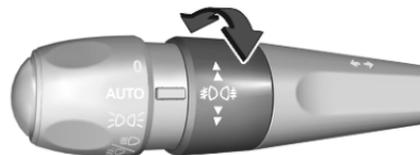
Den Drehregler einmal drehen, um die Nebelscheinwerfer zu aktivieren bzw. zu deaktivieren.
