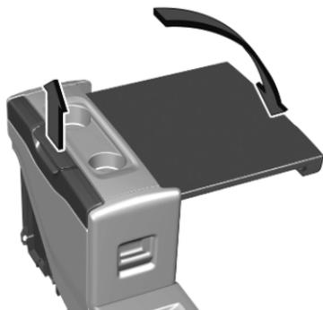
Auf beiden Seiten befinden sich Tische. Den Tisch vollständig nach oben ziehen und dann in die horizontale Position bringen.
