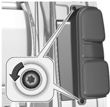
2. Die beiden Schrauben losschrauben und abnehmen.
