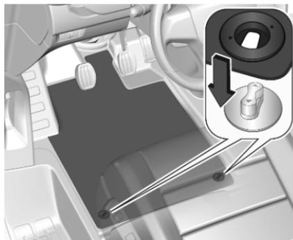
2. Schlitze in der Matte wie gezeigt an den Haltern ausrichten.
