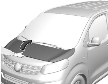
Schnappriegel hochdrücken und Motorhaube öffnen.
