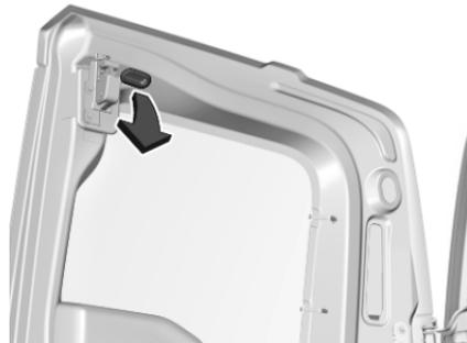
Die Spitze eines Schlitzschraubendrehers mit einem Tuch umwickeln, um den Lack zu schützen. Innenabdeckung oder Belüftungsdüsen mit dem Schraubendreher abnehmen.
