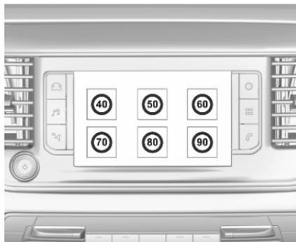
Die gewünschte Geschwindigkeit durch Berühren des entsprechenden Symbols auswählen. Diese Geschwindigkeit ist der neue Wert für den Geschwindigkeitsregler.
