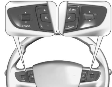
Die Menüs und Funktionen im Fahrerinfodisplay lassen sich über den Drehknopf am linken Lenksäulenhebel auswählen.
