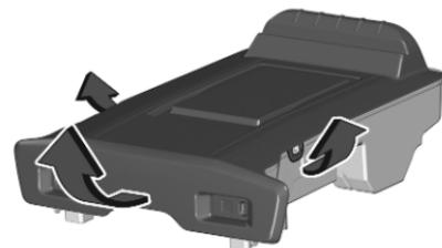
4. Haltelaschen an der Abdeckung lösen und Kasten öffnen.
