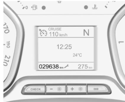
Die erfasste Gesamtfahrstrecke wird in km angezeigt.
