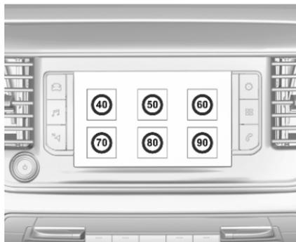
Die gewünschte Geschwindigkeit durch Berühren des entsprechenden Symbols auswählen. Diese Geschwindigkeit ist der neue Wert für den Geschwindigkeitsbegrenzer.
