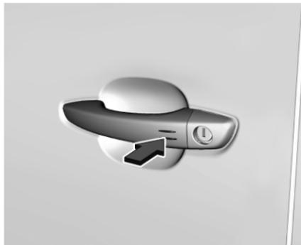
Auf einen der Türgriffe drücken oder die Taste an der Heckklappe drücken.
