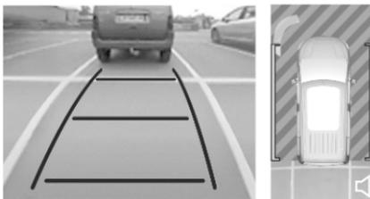
Der Bildschirm im Info-Display ist zweigeteilt. Rechts erscheint ein Bild des Fahrzeugs von oben, links die
