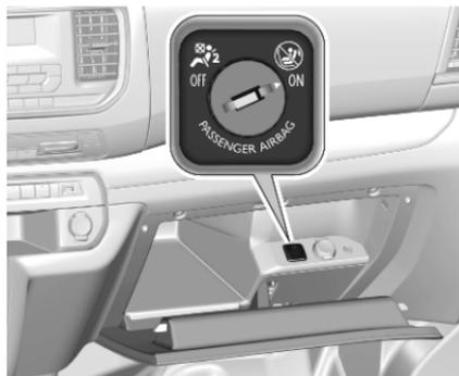
Der Beifahrer-Airbag kann über einen Schalter auf der Beifahrerseite der Instrumententafel deaktiviert werden.
