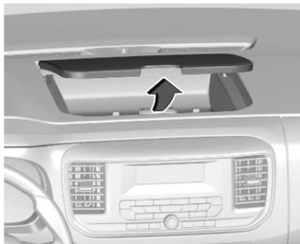
Zum Öffnen des Ablagefachs auf den Knopf drücken und die Abdeckung öffnen.
