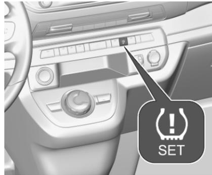
a) Fahrzeuge ohne Infotainment-System: Taste (!) 3 Sekunden lang drücken. Der Start wird durch einen Signalton bestätigt.
