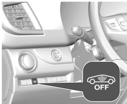
Wenn Tiere im Fahrzeug zurückgelassen werden, muss die Überwachung des Fahrzeuginnenraums abgeschaltet werden, weil laute Ultraschallsignale oder Bewegungen den Alarm auslösen. Auch ausschalten, wenn das Fahrzeug auf einer Fähre oder einem Zug transportiert wird.
