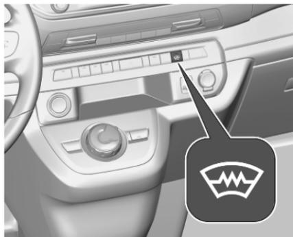
Die Heizung wird über die Taste
