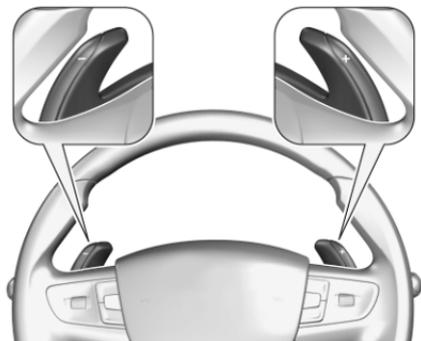
Bei Fahrzeugen mit Automatikgetriebe kann die Gangschaltung über und - bedient werden.
