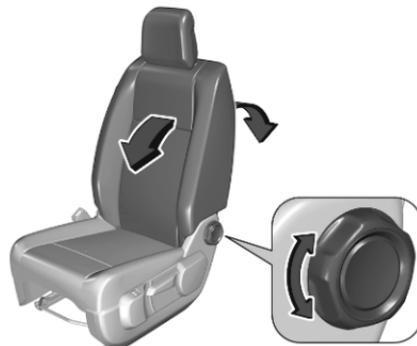
Zum Anpassen der Neigung am Handrad drehen. Zum Einstellen Rückenlehne entlasten.
