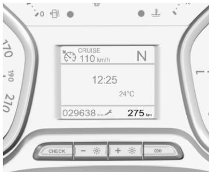
Der Tageskilometerzähler zählt bis 1.999,9 km und wird dann automatisch zurückgesetzt.
