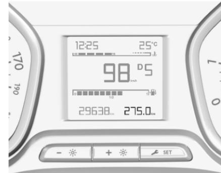
Der Tageskilometerzähler zählt bis 9.999,9 km und wird nicht automatisch zurückgesetzt.
