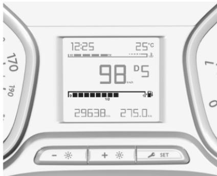
Der Kraftstoffstand wird auf einer Skala aus weißen Segmenten angezeigt.
