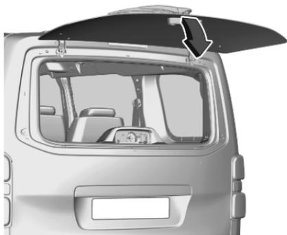
Auf den mittleren Bereich der Scheibe drücken, bis die Scheibe vollständig geschlossen ist.
