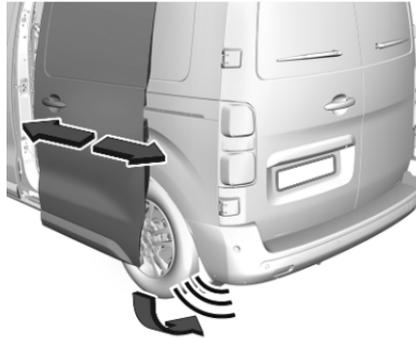
Zum Öffnen oder Schließen einer Schiebetür den Fuß auf der entsprechenden Seite unter dem Stoßfänger vor und zurück bewegen.
