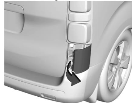
1. Fahrzeuge mit Schraubenabdeckung an der unteren Rückleuchteinheit: Haltetaschen der Abdeckung vorsichtig mit einem Schraubendreher lösen und leicht nach außen ziehen.
