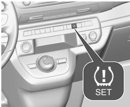
a) Fahrzeuge ohne Infotainment-System: Die Taste (SET) drei bis zehn Sekunden lang drücken. Der Start wird durch einen Signalton bestätigt.
