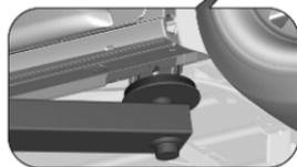
Die Position der hinteren Arme der Hebebühne befindet sich mittig unter den entsprechenden Wagenhebeaufnahmen.
