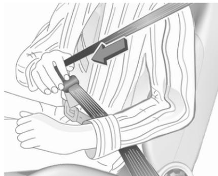
Den Sicherheitsgurt aus dem Aufroller herausziehen und unverdreht über den Körper führen. Den Sicherheitsgurt mit der anderen Hand nach vorne und unten ziehen, sodass der Gurt ungehindert durch die Schloßzunge gleiten kann. Die Schloßzunge in das Gurtschloß einstecken. Sicherstellen, dass der Sicherheitsgurt über die Schulter verläuft und während der Fahrt eng am Körper anliegt.
