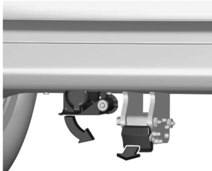
1. Anschlussbuchse nach unten drehen. Kappe abnehmen.
