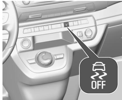
ESC und Traktionskontrolle können im Bedarfsfall durch Drücken auf
