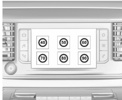
Die gewünschte Geschwindigkeit durch Berühren des entsprechenden Symbols auswählen. Diese Geschwindigkeit ist der neue Wert für den semiadaptiven Geschwindigkeitsregler.
