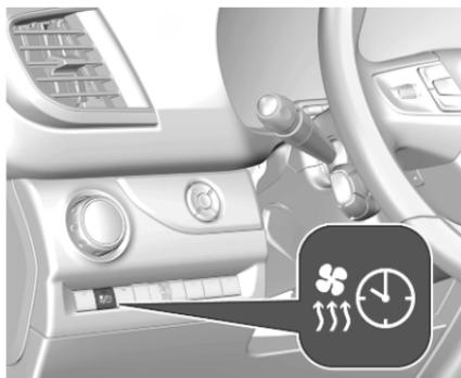
Bei Aktivierung der Standheizung leuchtet die LED in der entsprechenden Anzeige.
