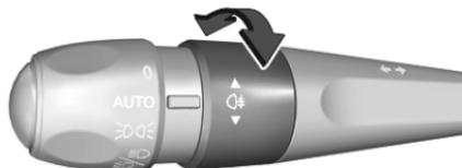
Den Drehregler einmal Stellung drehen, um die Nebelschlussleuchte zu aktivieren bzw. zu deaktivieren.
