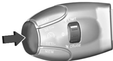
Ein Druck auf die Taste deaktiviert die Funktion. Der Geschwindigkeitsbegrenzer ist pausiert, eine Meldung wird eingeblendet. Das Fahrzeug fährt ohne eingestellte Höchstgeschwindigkeit.
