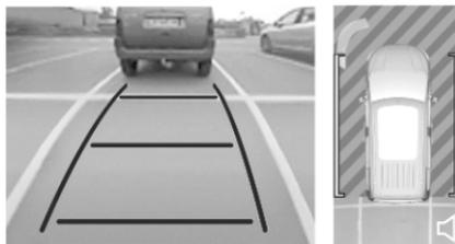
Der Bildschirm im Info-Display ist zweigeteilt. Rechts erscheint ein Bild des Fahrzeugs von oben, links die Ansicht von hinten. Die Einparksensoren ergänzen die Informationen zur Ansicht von oben.
