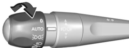
Bei aktivierter automatischer Lichtsteuerung und laufendem Motor schaltet das System abhängig von den äußeren Lichtverhältnissen und den Informationen des Wischersystems zwischen Tagfahrlicht und Scheinwerfern automatisch um.
