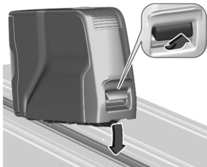
Der Griff an der Vorderseite muss sich in der gespannten Position befinden. Die Rückseite des Multifunktionsstischs in die Schiene einsetzen und die Vorderseite nach unten neigen. Den Multifunktionsstisch verschieben, bis er einrastet.
