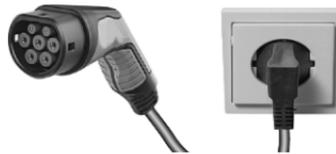
Zum Laden an einer Haushaltssteckdose das Ladekabel an den Ladeanschluss des Fahrzeugs und an die Haushaltssteckdose anschließen.
