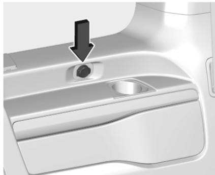
Auch unten links an der D-Säule kann sich eine 12-V-Steckdose befinden. Die maximale Leistungsaufnahme darf 120 W nicht überschreiten.
