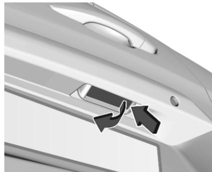
Einen Schraubendreher in eine der Vertiefungen an der Abdeckung einführen und diese loshebeln. Abdeckung entfernen.
