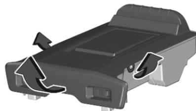
4. Haltelaschen an der Abdeckung lösen und Kasten öffnen.
