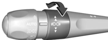
Den Drehregler zweimal drehen, um die Nebelschlussleuchte zu aktivieren bzw. zu deaktivieren.
