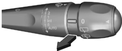
Waschflüssigkeit spritzt auf die Windschutzscheibe und der Wischer wird für einige Wischbewegungen eingeschaltet.
