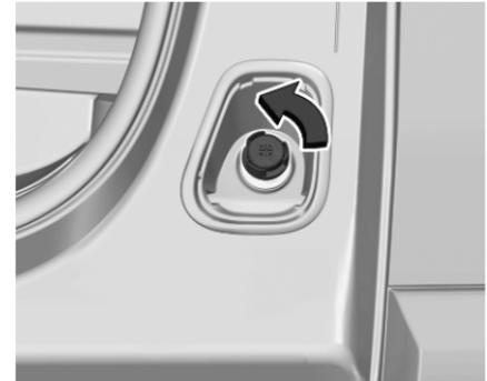
3. Die Schutzkappe vom Einfüllstutzen abschrauben.
