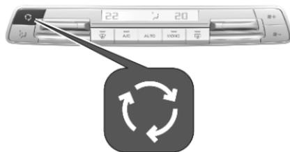
Zur Aktivierung des Umluftbetriebs auf ↻ drücken. Die Aktivierung wird über das Symbol ↻ im Display angezeigt.
