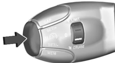
Ein Druck auf die Taste deaktiviert die Funktion. Der semiadaptive Geschwindigkeitsregler ist pausiert
