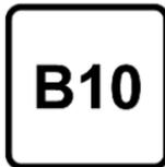
Dieseldieselkraftstoff gemäß der Norm EN16734, gemischt mit einem Biokraftstoff gemäß der Norm EN14214 (mit bis zu 10 % Fettsäuremethylester)
