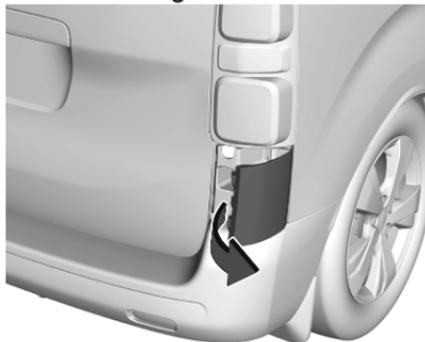
1. Fahrzeuge mit Schraubenabdeckung an der unteren Rückleuchteinheit: Haltetaschen der Abdeckung vorsichtig mit einem Schraubendreher lösen und leicht nach außen ziehen.
