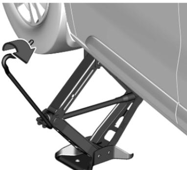
Das Fahrzeug mit korrekt ausgerichtetem Wagenheber anheben, bis das Rad vom Boden abhebt.
