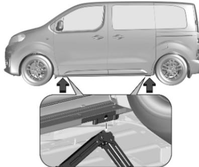
3. Sicherstellen, dass der Wagenheber richtig unter dem entsprechenden Aufnahmepunkt ausgerichtet ist. Direkt unter dem Aufnahmepunkt so positionieren, dass er nicht abrutschen kann.
