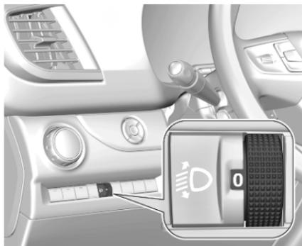
Zur Anpassung der Leuchtweite an die Fahrzeuglast, um die Blendwirkung zu reduzieren: Daumenrädchen
