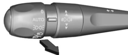
Zum Einschalten der manuellen Wegausleuchtung die Zündung ausschalten, die Fahrertür öffnen und am Blinkerhebel ziehen.
