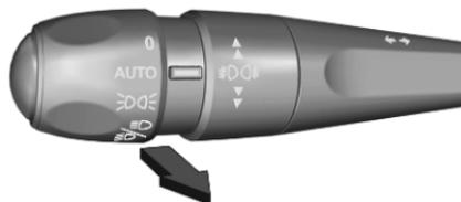
Zum Aktivieren des Fernlichts den Hebel über den Widerstandspunkt hinaus ziehen.
