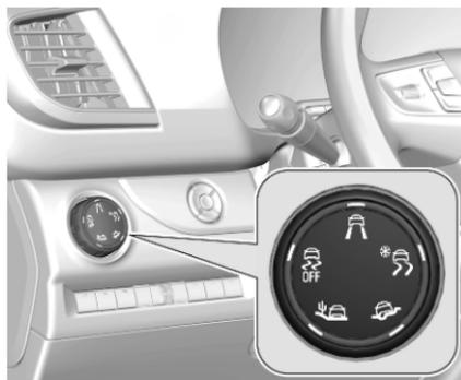
Die selektive Fahrsteuerung bietet die Auswahl zwischen fünf verschiedenen Fahrmodi, die durch Drehen des Bedienelements ausgewählt werden.
