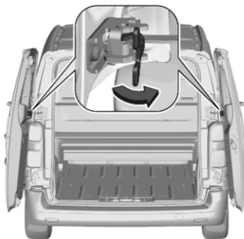
Die Türen werden durch Streben in der 90°-Position gehalten. Um die Türen bis 180° zu öffnen, auf die Arretierung drücken und die Türen in die gewünschte Position schwenken. Vor dem Schließen der Türen sicherstellen, dass die Arretierstreben in der 90°-Position stehen.
