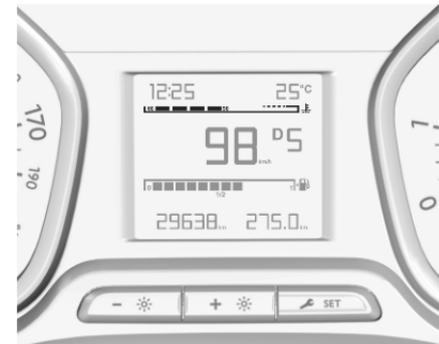
Eine Skala aus weißen Segmenten zeigt die Motorkühlmitteltemperatur an.
