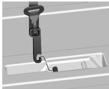
Die Befestigungen auf beiden Seiten in die Verankerungen am Boden einsetzen.
