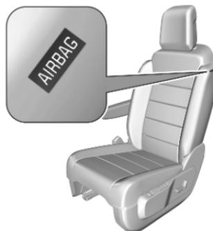
Das Seiten-Airbag-System besteht aus je einem Airbag in der Sitzlehne jedes Vordersitzes. Diese Stellen sind mit dem Wort **AIRBAG** gekennzeichnet.
