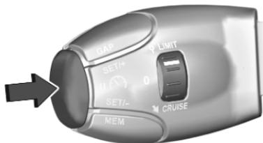
Ein Druck auf die Taste deaktiviert die Funktion. Der Geschwindigkeitsregler ist pausiert, eine Meldung wird eingeblendet. Das Fahrzeug fährt ohne Geschwindigkeitsregler.
