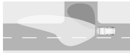
Beim Abbiegen mit bis zu 40 km/h aktiviert. Je nach Lenkwinkel und Aktivierung der Blinker leuchten die Nebelscheinwerfer die Fahrtrichtung aus.
