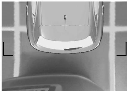
Durch Aufzeichnung der Fahrzeugumgebung während des Manövers rekonstruiert die Rückfahrkamera die Darstellung der Fahrzeugumgebung von oben. So hat der Fahrer eventuelle Hindernisse immer im Blick. Diese Ansicht ist im Automatikmodus oder im Ansichtsauswahlmenü verfügbar.
