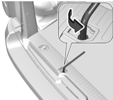
3. Radschlüssel an der Sechskopfschraube ansetzen. Schraube linksherum drehen, bis der Reserveradhalter so weit abgesenkt ist, dass die Befestigung gelöst werden kann.
