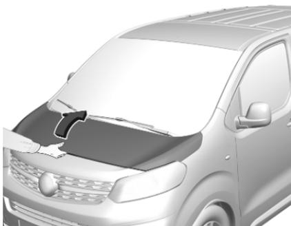
Schnappriegel hochdrücken und Motorhaube öffnen.
