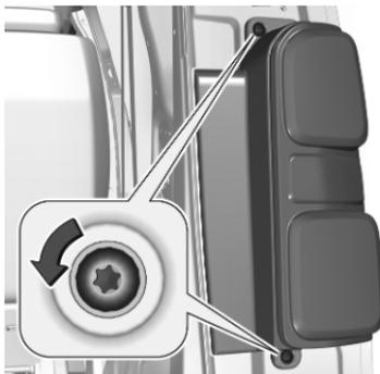
2. Die beiden Schrauben losschrauben und abnehmen.
