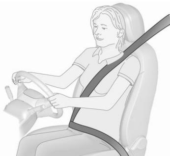
Die Höhe so einstellen, dass der Sicherheitsgurt über die Schulter verläuft.
