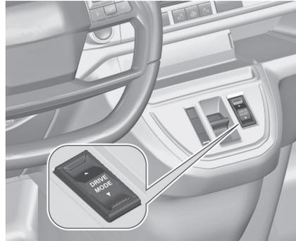
Mit dem abgebildeten Umschalter den entsprechenden Fahrmodus auswählen. Die Fahrmodi können auch auf der Menüseite ausgewählt werden, die sich auf dem Info-Display öffnet, wenn der Kippschalter betätigt wurde.
