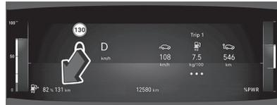
Die kombinierte Reichweite (Hochvoltbatterie und Wasserstofftank) wird angezeigt.
