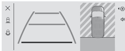
Die erste waagerechte Linie markiert eine Entfernung von etwa 30 cm zum Rand des Heckstoßfängers. Die oberen horizontalen Linien markieren Entfernungen von etwa 1 bzw. 2 m zum Rand des Heckstoßfängers.
