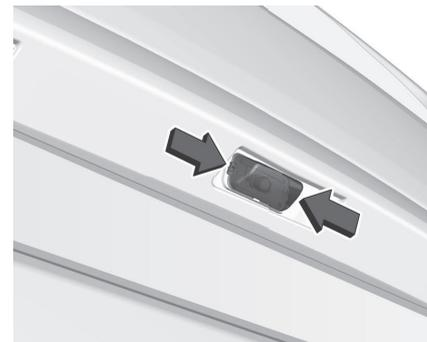
Einen dünnen Schraubendreher o. Ä. in eine der Vertiefungen an der Abdeckung einführen und nach außen drücken, um die Clips zu lösen. Abdeckung entfernen.
