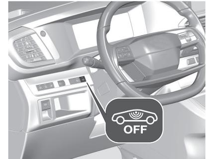
Wenn Tiere im Fahrzeug zurückgelassen werden, muss die Überwachung des Fahrzeuginnenraums abgeschaltet werden, weil laute Ultraschallsignale oder
