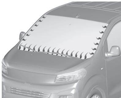
Diese Funktion beheizt den unteren Rand und die Seiten der Windschutzscheibe. Dadurch ermöglicht die Funktion ein schnelles Lösen der Wischerblätter, wenn diese an der Windschutzscheibe festgefroren sind. Außerdem wird verhindert, dass sich im Wischerbetrieb Schnee auf der Windschutzscheibe ansammelt.
