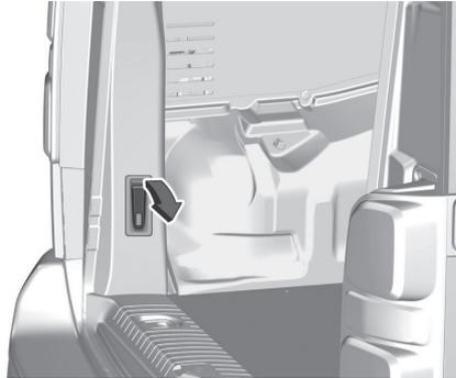
Eine der Laderaumleuchten kann auch als Taschenlampe verwendet werden. Die Taschenlampe von oben aus der Aussparung ziehen.
