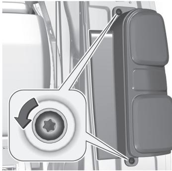
2. Die beiden Schrauben los-schrauben und abnehmen.
