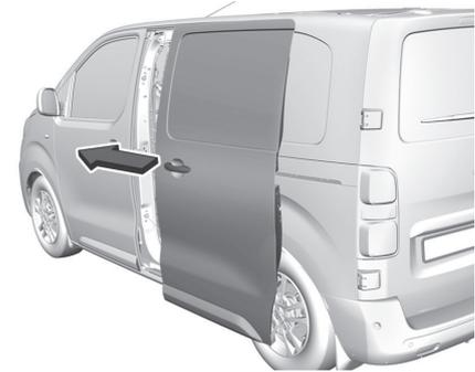
Zum Schließen von außen am Türgriff ziehen und die Tür nach vorne schieben, bis sie einrastet.
