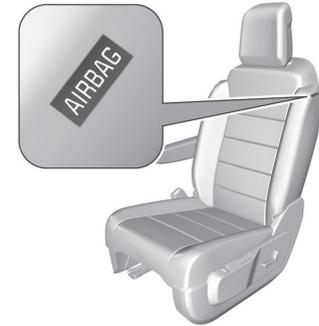
Das Seiten-Airbagsystem besteht aus einem Airbag in jeder Vordersitzlehne. Diese Stellen sind mit dem Wort AIRBAG gekennzeichnet.
