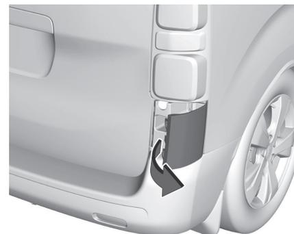
1. Fahrzeuge mit Schraubenabdeckung an der unteren Rückleuchteinheit: Haltetaschen mit einem Schraubendreher lösen und leicht nach außen ziehen.
