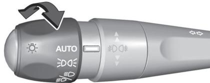
Bei Einstellrad in der Position AUTO und laufendem Motor schaltet das System abhängig von den äußeren Lichtverhältnissen und den Informationen des Wischersystems zwischen Tagfahrlicht und Scheinwerfern automatisch um.
