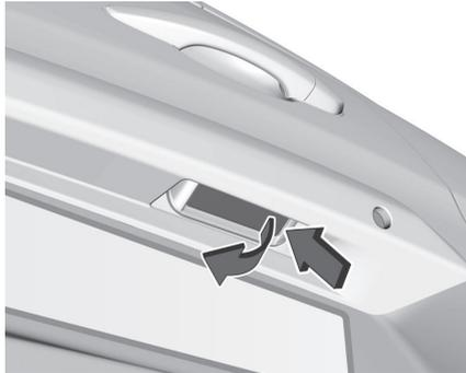
Einen Schraubendreher in eine der Vertiefungen an der Abdeckung einführen und diese loshebeln. Die Abdeckung entfernen
