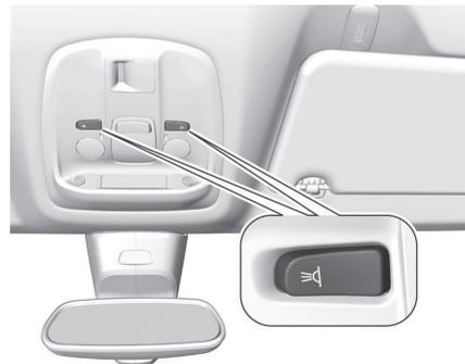
Die Bedienung erfolgt durch Drücken auf und an den Innenleuchten.
