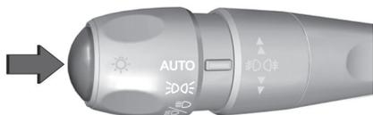
Die Rückblick-Kamera wird eingeschaltet, wenn das Fahrzeug fährt und die Rückansicht über das Rückfahrdisplay oder durch Drücken der Taste am Hebel ausgewählt wird. Beim Betrieb mit einem Anhänger ist die Sicht nach hinten weiterhin möglich.
