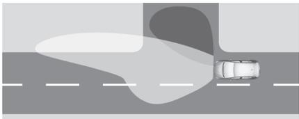
Beim Abbiegen mit bis zu 40 km/h aktiviert. Je nach Lenkwinkel und Aktivierung der Blinker leuchten die Nebelscheinwerfer die Fahrtrichtung aus. Diese Funktion kann in der Fahrzeugpersonalisierung aktiviert oder deaktiviert werden.
