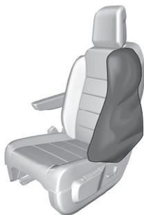
Der aufgeblähte Airbag dämpft den Aufprall, wodurch die Verletzungsgefahr für Oberkörper bei einem Seitenaufprall deutlich verringert wird.
