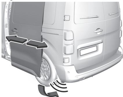
Zum Öffnen oder Schließen einer Schiebetür den Fuß auf der entsprechenden Seite unter dem Stoßfänger vor und zurück bewegen.
