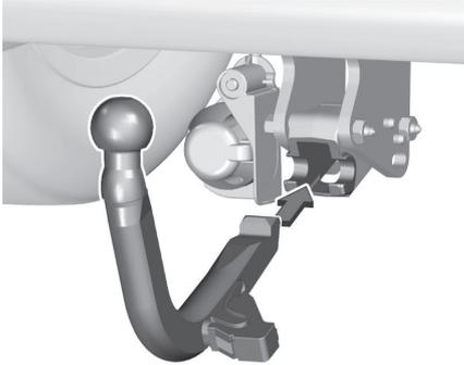
2. Anschlussstange der Anhängerkupplung in die Öffnung einsetzen und fest bis zum Anschlag nach oben drücken.
