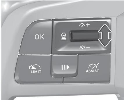
Die voreingestellte Geschwindigkeit kann durch Bewegungen des Daumenrädchens auf  $\curvearrowright$  erhöht bzw. auf  $\curvearrowleft$  gesenkt werden. Daumenrädchen mehrmals kurz schieben, um die Geschwindigkeit in kleinen Schritten zu ändern, länger schieben, um sie in großen Schritten zu ändern.
