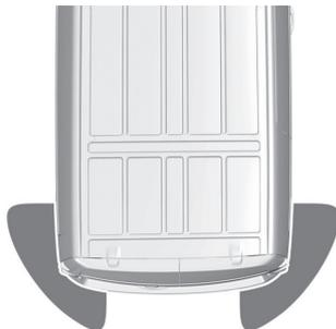
Der elektronische Schlüssel muss sich außerhalb des Fahrzeugs in einem Umkreis von ca. 1 m um die Bewegungssensoren befinden. Je nach Fahrzeugkonfiguration muss sich der elektronische Schlüssel im entsprechenden Bereich befinden. Den Fuß nicht zu lange unter dem Heckstoßfänger halten und nicht zu langsam bewegen.
