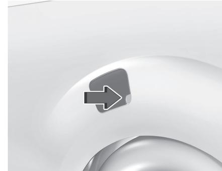
2. Die Tankklappe öffnen Sie durch Ziehen an der rechten unteren Ecke. Sie befindet sich hinten links am Fahrzeug.
