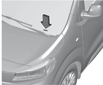
Die Fahrzeug-Identifizierungsnummer kann durch die Windschutzscheibe sichtbar in die Instrumententafel eingestanzt sein.
