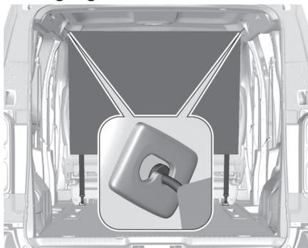
1. Im Dachrahmen befinden sich an beiden Seiten Einbauöffnungen. Sofern vorhanden, die Abdeckungen öffnen.
