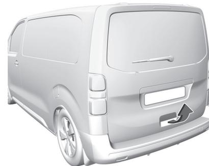
Nach dem Entriegeln die Heckklappentaste drücken und die Heckklappe öffnen.
