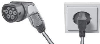
Zum Laden an einer Haushaltssteckdose das Ladekabel an den Ladeanschluss des Fahrzeugs und an die Haushaltssteckdose anschließen. Bei einer Ladeleistung von 1,8 kW dauert der Ladevorgang ungefähr 30 bis 38 Stunden.
