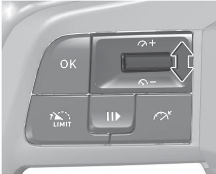
Bei aktivem System kann die voreingestellte Geschwindigkeit durch Bewegungen des Daumenrädchens auf  $\curvearrowright$  erhöht bzw. auf  $\curvearrowleft$  gesenkt werden. Daumenrädchen mehrmals kurz schieben, um die Geschwindigkeit in kleinen Schritten zu ändern, länger
