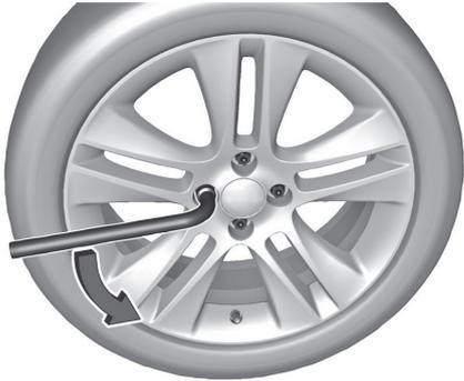
2. Radschlüssel anbringen und jede Radschraube um eine halbe Umdrehung lockern. Die Räder können mit Felgenschlössern verriegelt werden. Um diese speziellen Schrauben zu lösen, vor dem Ansetzen des Radschlüssels den Adapter auf den Schraubenkopf aufsetzen. Der Adapter ist im Handschuhfach untergebracht
