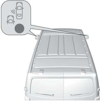
Erkennt das System bei Vorwärtsfahrt ein Fahrzeug im toten Winkel, leuchtet im entsprechenden Seitenspiegel eine LED auf.
