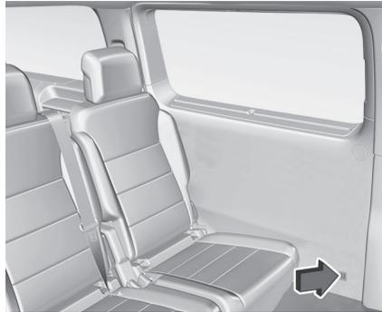
Zwei USB-Anschlüsse können sich an der linken unteren Seite der B-Säule befinden. Beide USB-Anschlüsse können nur externe Geräte aufladen.
