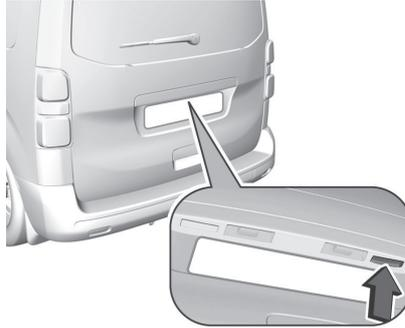
Zum Verriegeln des Fahrzeugs auf die rechte Heckklappentaste drücken, während sich der elektronische Schlüssel außerhalb des Fahrzeugs in einer Entfernung von höchstens ca. 1 m zur Heckklappe befindet.
