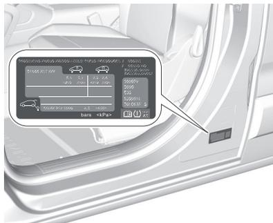
Auf dem Aufkleber Reifendruck sind die Reifendruckwerte im leeren und beladenen Zustand angegeben. Dieser Aufkleber befindet sich an der Innenseite der Tür auf der Fahrerseite.
