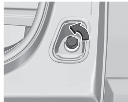
3. Die Schutzkappe vom Einfüllstutzen abschrauben.
