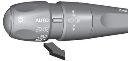
Um die Lichthupe zu aktivieren, den Hebel kurz bis zum Widerstandspunkt ziehen.
