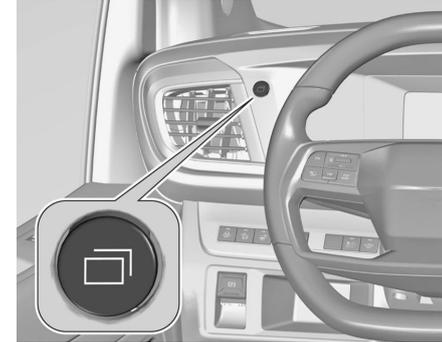
Die Taste drücken, um durch die verschiedenen Seiten zu blättern oder um eine Popup-Meldung zu schließen. Meldungen werden im Fahrerinfodisplay angezeigt. In einigen Fällen wird gleichzeitig ein Warn- oder Signalton wiedergegeben. Durch Druck eine Meldung bestätigen.
