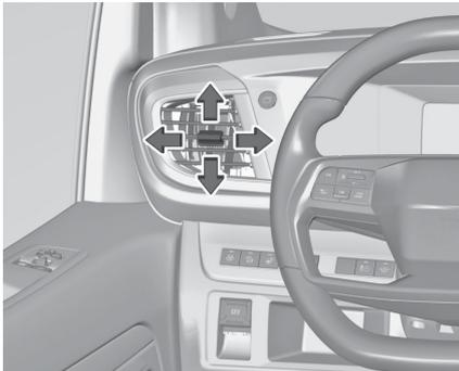
Richtung des Luftstroms durch Kippen und Schwenken der Lamellen einstellen. Zum Schließen der Belüftungsdüse die Lamellen nach außen schwenken. Bei eingeschalteter Kühlung müssen mindestens zwei Belüftungsdüsen geöffnet sein.
