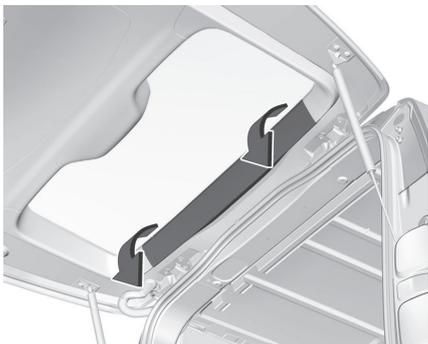
Innenverkleidung durch Biegen nach oben und unten von den Clips lösen. Verkleidung vorsichtig abziehen.
