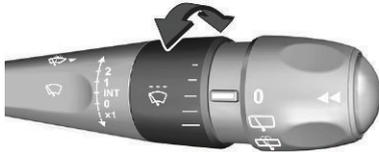
Bei Wischerhebel in Position INT kann durch Drehen des Rings eine von fünf Intervallstufen ausgewählt werden. Beim Auswählen einer niedrigeren Frequenz erfolgt eine Wischbewegung zur Bestätigung.
