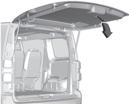
Die Heckklappe am Innengriff nach unten ziehen. Von oben auf die Heckklappe
