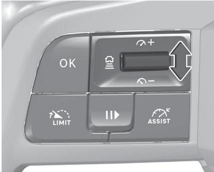
Die voreingestellte Geschwindigkeit kann durch Bewegen des Daumenrädchens auf  $\curvearrowright$  erhöht bzw. auf  $\curvearrowleft$  gesenkt werden. Daumenrädchen mehrmals kurz schieben, um die Geschwindigkeit in kleinen Schritten zu ändern, länger schieben, um sie in großen Schritten zu ändern.
