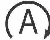
Ein Autostop wird durch die Kontrollleuchte
