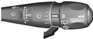
Hebel ziehen. Waschflüssigkeit spritzt auf die Windschutzscheibe und der Wischer wird für einige Wischbewegungen eingeschaltet.
