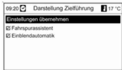
Mit der **Fahrspurassistent**-Option kann der Illustrationstyp bestimmt werden, der angezeigt wird, wenn eine Autobahnkreuzung erreicht wird.
