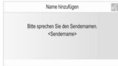
Wenn das Radio eingeschaltet ist und Sie den Befehl **"Name hinzufügen"** geben, ist die oben abgebildete On Screen-Mitteilung zu sehen. Zugleich wird vom System die Sprachausgabe-Mitteilung **"Bitte sprechen Sie den Sendernamen."** angesagt.
