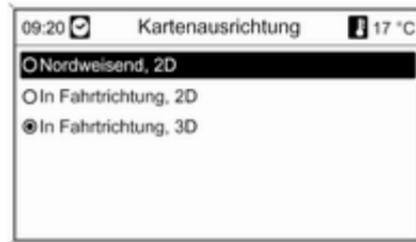
Ausrichtung (Nordweisend/In Fahrtrichtung) und Dimensionen (2D/3D) des Kartenausschnittes auswählen (3D nur bei Navi 900 verfügbar).
