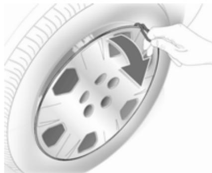
1. Radmutternkappen mit Schraubendreher lösen und abnehmen. Radabdeckung mit dem Haken abziehen. Wagenwerkzeug ⇨ 240.
