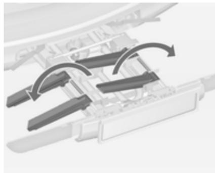
Beide Radaufnahmen ausklappen.
