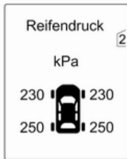
Reifendruck-Kontrollsystem durch Drehen des Einstellrädchens wählen. Systemstatus und kleine Druckdifferenzen werden über eine Warnmeldung und gleichzeitiges Blinken des betreffenden Reifens im Driver Information Center angezeigt.
