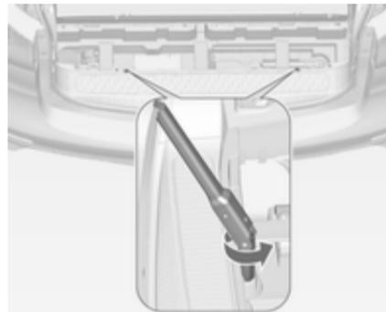
3. Radschlüssel auf eine Sechskantschraube aufsetzen und gegen den Uhrzeigersinn drehen, bis ein Widerstand bemerkbar ist.
