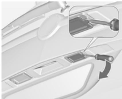
1. Schraubendreher in die Aussparung der Abdeckung einführen, zur Seite drücken und die Feder lösen. Abdeckung abnehmen.
