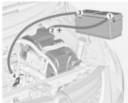
Reihenfolge für das Anschließen der Kabel:
