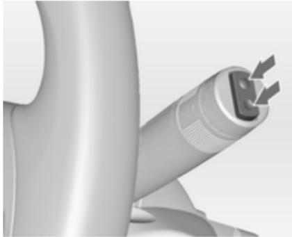
Zur Betätigung des Heckscheibenwischers Wippschalter drücken:
