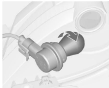
2. Lampe durch Drehen gegen den Uhrzeigersinn aus der Lampenfassung nehmen.
