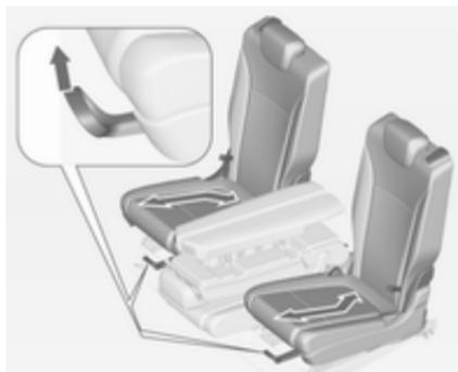
In der Komfortposition können die äußeren Sitze zusätzlich seitlich verschoben werden. Die Rückenlehne des mittleren Sitzes wird dabei als Armlehne umgeklappt.
