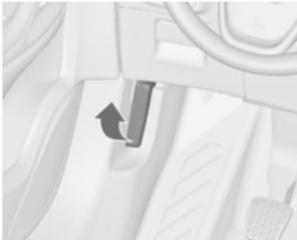
Entriegelungshebel ziehen und in die Ausgangsposition zurückführen.
