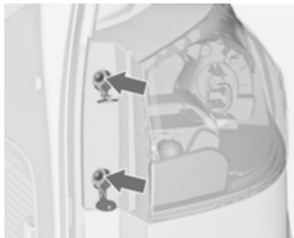
2. Die mit Pfeilen gekennzeichneten Schrauben entfernen.
