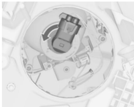
2. Die Lampenfassung durch Drehen nach links lösen. Lampenfassung aus dem Reflektor ziehen.
