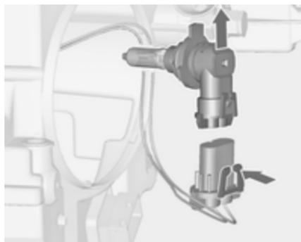
3. Die Lampenfassung durch Drücken der Haltenase vom Stecker lösen.
