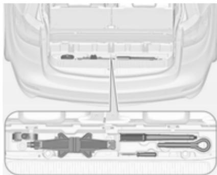
Das Wagenwerkzeug und der Wagenheber befinden sich im Staufach vor der Hecktür im Laderaum.
