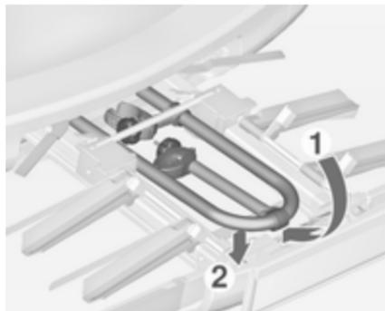
Den Träger nach hinten klappen und dann bis zum Anschlag nach vorne drücken (1).
