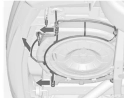
5. Die Reserveradhalterung anheben und beide Verriegelungen lösen.
