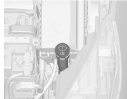
Sauberes Wasser und eine geeignete Menge Scheibenwaschlösung mit Frostschutzmittel mischen. Das richtige Mischverhältnis ist auf dem Waschflüssigkeitsbehälter angegeben.
