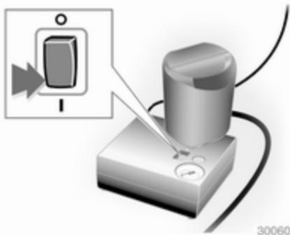
10. Wippschalter auf dem Kompressor auf I stellen. Der Reifen wird mit Dichtmittel gefüllt.
