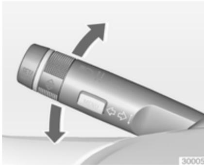
Hebel nach oben = Blinker rechts
