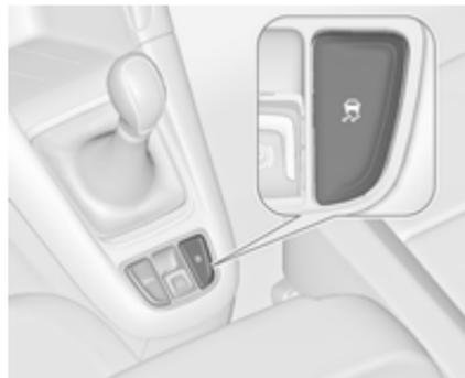
Für extremes Hochleistungsfahren kann ESC deaktiviert werden: Taste
