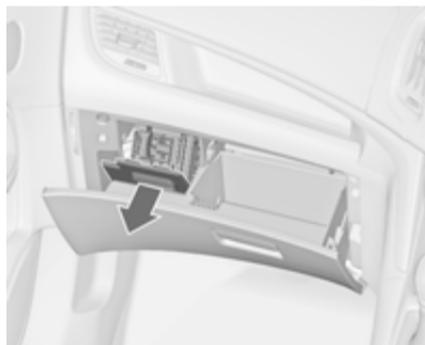
In Rechtslenkern befindet sich der Sicherungskasten hinter einer Abdeckung im Handschuhfach. Das Handschuhfach öffnen, dann die Abdeckung öffnen und nach unten klappen.
