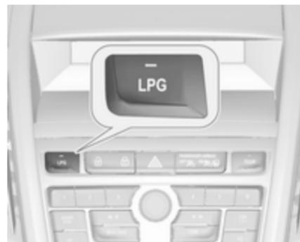
Taste **LPG** drücken, um zwischen Benzin- und Flüssiggasbetrieb umzuschalten. Die LED-Leuchte
