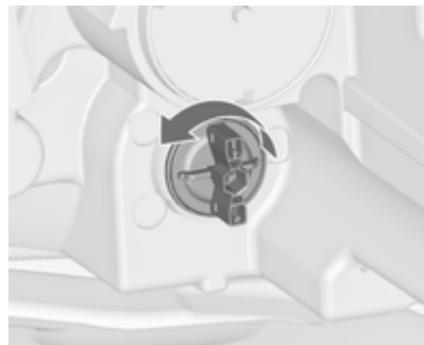
1. Lampenfassung (2) durch Drehen nach links ausrasten. Lampenfassung aus dem Reflektor ziehen.
