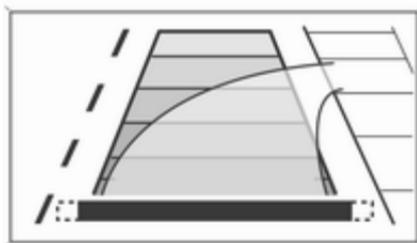
Die Fahrzeugspur wird entsprechend des Lenkwinkels angezeigt.
