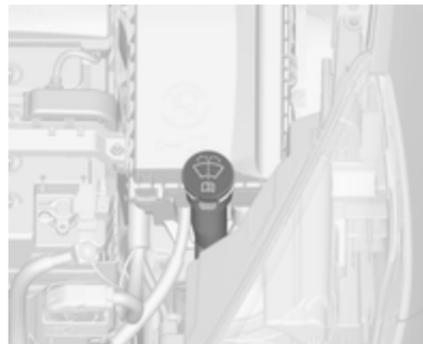
Sauberes Wasser und eine geeignete Menge Scheibenwaschlösung mit Frostschutzmittel mischen. Das richtige Mischverhältnis ist auf dem Waschflüssigkeitsbehälter angegeben.
