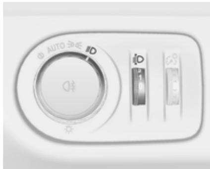
Zur Anpassung der Leuchtweite an die Fahrzeugbeladung, um Blendwirkung zu reduzieren: Daumenrad
