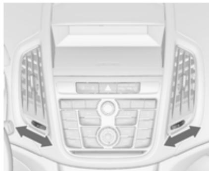
Zum Öffnen der Düse Einstellrädchen auf I drehen. Durch Drehen am Einstellrad die Luftmenge an der Düse einstellen.
