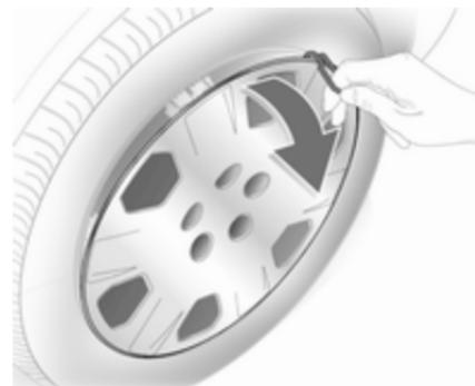
1. Radmutternkappen mit Schraubendreher lösen und abnehmen. Radabdeckung mit dem Haken abziehen. Wagenwerkzeug ⇨ 247.
