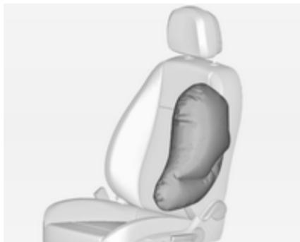
Der aufgeblähte Airbag dämpft den Aufprall, wodurch die Verletzungsfahrer für Oberkörper und Becken bei einem Seitenaufprall deutlich verringert wird.
