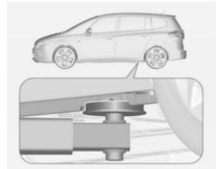
Position des hinteren Arms der Hebebühne mittig unter der Aussparung im Schweller.
