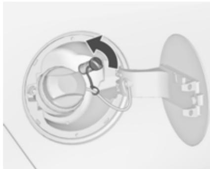
Die Schutzkappe vom Einfüllstutzen abschrauben.
