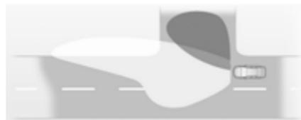
In engen Kurven oder beim Abbiegen wird abhängig vom Lenkwinkel oder dem Blinkersignal links oder rechts ein zusätzlicher Reflektor eingeschaltet, der die Straße im rechten Winkel zur Fahrtrichtung beleuchtet. Er wird bei Geschwindigkeiten von bis zu 40 km/h aktiviert.
