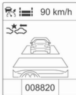
Taste **MENU** am Blinkerhebel drücken und mit dem Daumenrad die Seite des adaptiven Geschwindigkeitsreglers auswählen, um diese Seite im Driver Information Center anzuzeigen.
