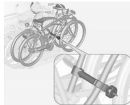
Das vierte Fahrrad mit der kurzen Zusatzhalterung befestigen. Die Halterung muss zwischen dem Rahmen des dritten und des vierten Fahrrads fixiert werden.
