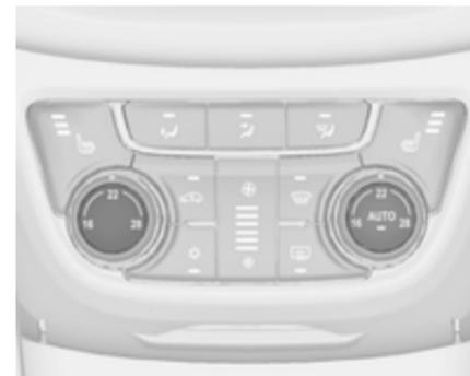
Ist die Mindesttemperatur eingestellt, läuft die Klimaanlage mit maximaler Kühlung, sofern Kühlung ☀ eingeschaltet ist.
