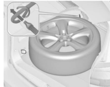
2. Das Schlaufenende des Gurtes durch die vordere Zurröse an der linken Seite führen.
