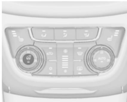
Die Heizung durch Drücken der Taste
