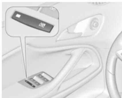
Zur Deaktivierung der elektrischen Fensterbetätigung der Hintertüren Schalter
