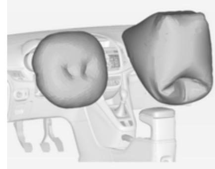
Die aufgeblähten Airbags dämpfen den Aufprall, wodurch die Verletzungsgefahr für Oberkörper und Kopf bei einem Frontalaufprall deutlich verringert wird.
