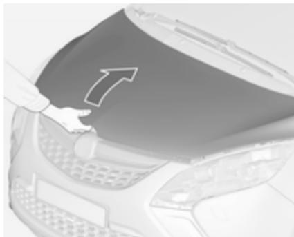
Verschlusshaken nach rechts ziehen und Motorhaube öffnen.
