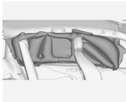
Der aufgeblähte Airbag dämpft den Aufprall, wodurch die Verletzungsfahrer für den Kopf bei einem Seitenaufprall deutlich verringert wird.
