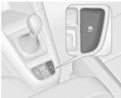
Die Traktionskontrolle kann ausgeschaltet werden, wenn ein Durchdrehen der Antriebsräder erwünscht ist: Taste
