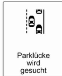
Wenn das Fahrzeug bei aktiviertem System an einer Reihe geparkter Autos vorbeifährt, beginnt die erweiterte Einparkhilfe nach einer geeigneten
