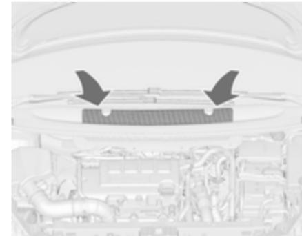
Der Lufteinlass im Motorraum außen vor der Windschutzscheibe muss zur Luftzufuhr frei sein. Gegebenenfalls Laub, Schmutz oder Schnee entfernen.
