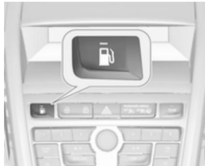
Durch Drücken der Taste
