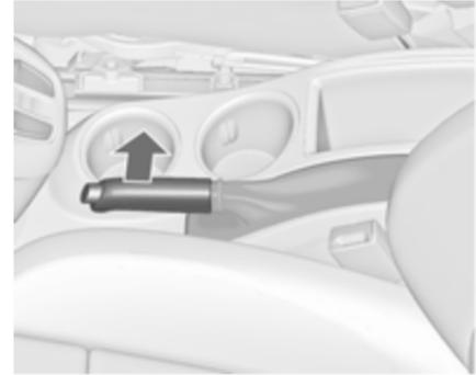
Die Parkbremse ohne Betätigung des Entriegelungsknopfes immer fest anziehen, im Gefälle oder an einer Steigung so fest wie möglich.
