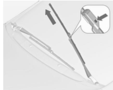
Wischerarm anheben, bis er von selbst steht, Taste zum Lösen des Wischerblattes drücken und Wischerblatt abnehmen.
