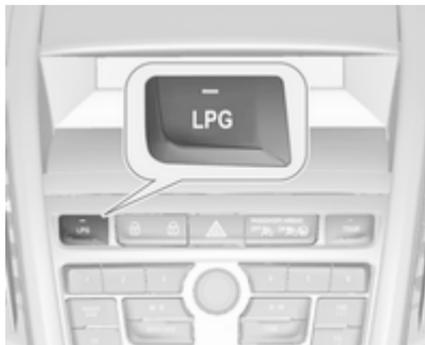
Durch Drücken der Taste **LPG** wird zwischen Benzin- und Flüssiggasbetrieb umgeschaltet, sobald die erforderlichen Parameter (Kühlmitteltemperatur, Gastemperatur und Minstdrehzahl des Motors) erreicht sind. Die Anforderungen sind normalerweise nach etwa 60 Sekunden (je nach Außentemperatur) und der ersten festen Betätigung des Gaspedals erreicht. Der LED-Status zeigt den aktuellen Betriebsmodus.
