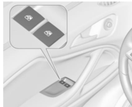
Schalter für das betreffende Fenster betätigen, indem er zum Öffnen gedrückt bzw. zum Schließen gezogen wird.
