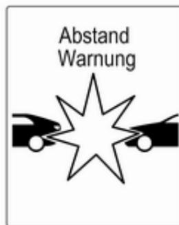
Beim zu schnellen Heranfahren an ein vorausfahrendes Fahrzeug wird die Auffahrwarnungsmeldung im Driver Information Center angezeigt. Gleichzeitig ertönt ein Signalton. Betätigen sie das Bremspedal, wenn es die Situation erfordert.
