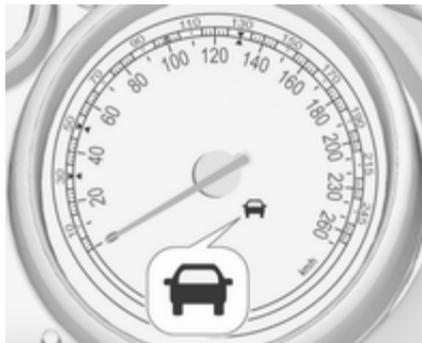
Wenn das System ein vorausfahrendes Fahrzeug in Ihrer Fahrspur erkennt, leuchtet die Kontrollleuchte „Vorausfahrendes Fahrzeug“
