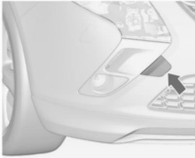
Mit einem Schraubendreher in den Schlitz an der kürzeren Kante der Abdeckung fahren. Abdeckung durch vorsichtiges Seitwärtsbewegen des Schraubendrehers lösen. Um Schäden zu vermeiden, wird empfohlen, ein Tuch zwischen Schraubendreher und Rahmen zu legen.
