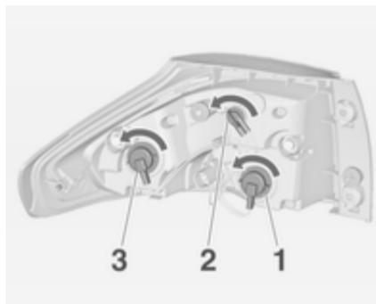
5. Lampe durch Drehen an der Lampenfassung entfernen und austauschen.
