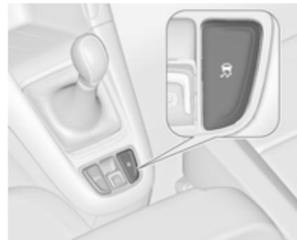
Für extremes Hochleistungsfahren kann ESC deaktiviert werden: Taste
