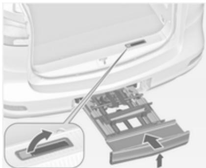
Entriegelungshebel nach oben drücken und halten. Das Heckträgersystem leicht anheben und bis zum Einrasten in den Stoßfänger drücken. Der Entriegelungshebel muss in die Ausgangslage zurückkehren.
