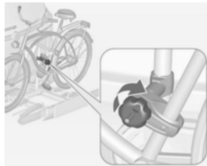
2. Die kurze Halterung am Fahrradrahmen befestigen. Zum Fixieren den Knopf im Uhrzeigersinn drehen.
