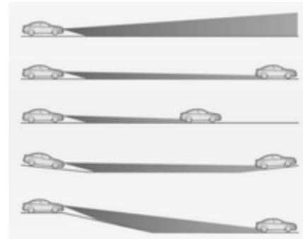
Eine spezielle topografische Bewertungsfunktion erkennt vorausfahrende Fahrzeuge an Steigungen oder Gefällen, indem es die Bewegung der Rückleuchten auswertet. Das System passt die Leuchtweitenhöhe so an, dass die Straße optimal ausgeleuchtet wird, ohne andere Verkehrsteilnehmer zu blenden.
