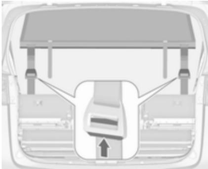
Auf beiden Seiten die Taste am Spannmittelmechanismus drücken, um das Band zu lösen. Haken von den Ösen lösen. Die Sicherheitsnetzstangen aus den Halterungen im Dachrahmen aushaken. Netz einrollen und mit einem Gurt sichern.
