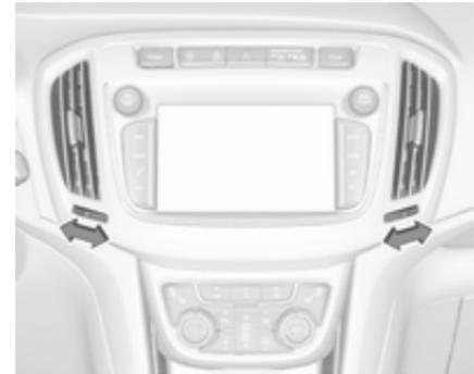
Zum Öffnen der Düse Einstellrädchen auf I drehen. Durch Drehen am Einstellrädchen die Luftmenge an der Düse einstellen.
