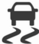
Die Traktionskontrolle ist nach jedem Motorstart funktionsfähig, sobald die Kontrollleuchte
