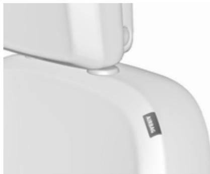
Das Seiten-Airbag-System besteht aus einem Airbag in der Rückenlehne jedes Vordersitzes. Diese Stellen sind mit dem Wort **AIRBAG** gekennzeichnet.
