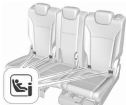
Für das Fahrzeug zugelassene ISOFIX-Kindersicherheitsysteme auf der zweiten Sitzreihe empfehlen wir, den entsprechenden äußeren Sitz in die dritte Rastposition vor der hintersten Position einzustellen (Standardsitz). Der Komfortsitz, sofern ausgestattet, muss sich in der normalen Position befinden ↪ 45.
