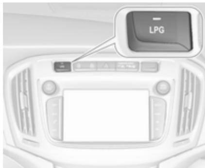
**LPG** drücken, um zwischen Benzin- und Flüssiggasbetrieb umzuschalten. Die LED-Leuchte ☐ zeigt den aktuellen Betriebsmodus.
