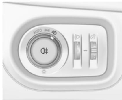
Wird durch Drücken von  $\text{0}$  bedient. Lichtschalter in Stellung **AUTO**: Beim Einschalten der Nebelschlussleuchte werden die Scheinwerfer automatisch eingeschaltet.
