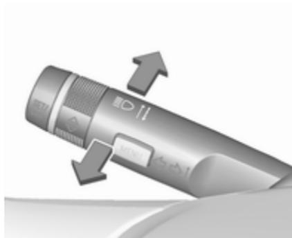
Zum Umschalten von Abblend- auf Fernlicht den Hebel drücken.
