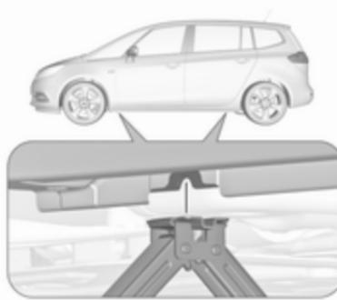
4. Sicherstellen, dass der Wagenheber richtig unter dem entsprechenden Ansatzpunkt ausgerichtet ist.
