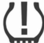
Wenn niedriger Reifendruck erkannt wird, wird dies durch die Kontrollleuchte
