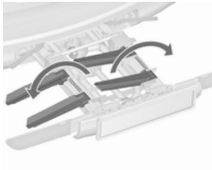
Beide Radaufnahmen ausklappen.
