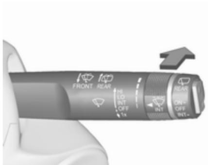
Hebel drücken. Waschflüssigkeit spritzt auf die Heckscheibe und der Wischer wird für einige Wischbewegungen eingeschaltet.
