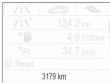
Die erfasste Gesamtfahrstrecke wird in km angezeigt.
