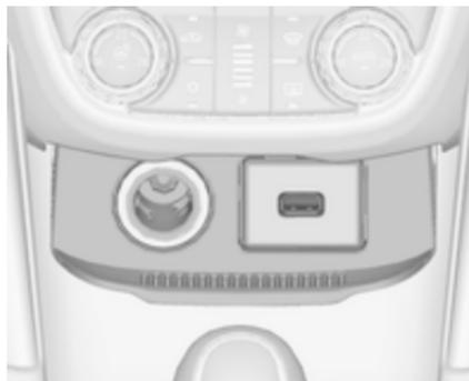
Eine 12-Volt-Zubehörsteckdose befindet sich in der vorderen Konsole. Die Abdeckung nach unten klappen.
