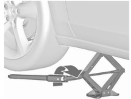
Radschlüssel ansetzen und den korrekt ausgerichteten Wagenheber hochkurbeln, bis das Rad vom Boden abhebt.
