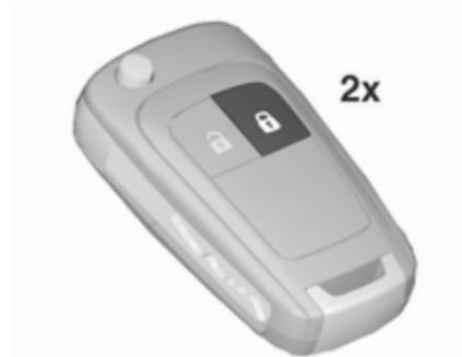
☷ auf der Funkfernbedienung zweimal innerhalb von 5 Sekunden drücken.
