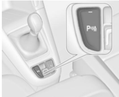
Es lässt sich außerdem durch Drücken der Einparkhilfe-Taste **P** mit einem Dreieckssymbol manuell deaktivieren.
