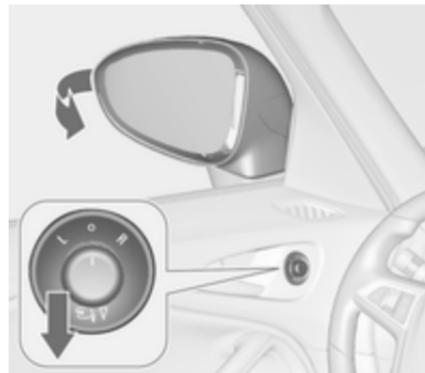
Bedienelement auf 0 drehen und dann hinunterdrücken. Beide Außenspiegel werden eingeklappt.
