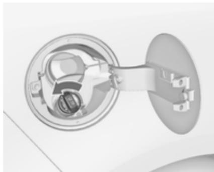
4. Die Schutzkappe vom Einfüllstutzen abschrauben.
