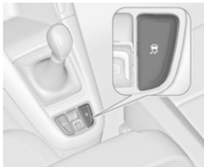
Die Traktionskontrolle kann ausgeschaltet werden, wenn ein Durchdrehen der Antriebsräder erwünscht ist:
