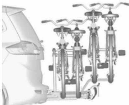
Das Heckträgersystem (Flex-Fix-System) bietet die Möglichkeit, zwei Fahrräder auf einem in den Fahrzeugboden integrierten herausziehbaren Träger zu befestigen. Auf einem Anbaustück können zwei weitere Fahrräder befestigt werden. Der Transport anderer Gegenstände ist nicht zulässig.
