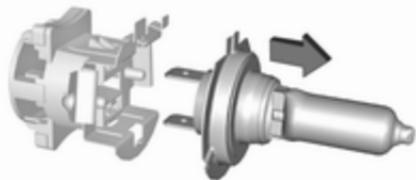
3. Lampe aus dem Steckverbinder Lampenfassung ziehen.
