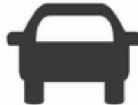
Wenn das System ein vorausfahrendes Fahrzeug in der Fahrspur erkannt hat, leuchtet die Kontrollleuchte für ein erkanntes vorausfahrendes Fahrzeug
