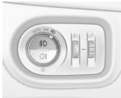
Wird durch Drücken von  $\text{D}$  bedient. Lichtschalter in Stellung **AUTO**: Beim Einschalten der Nebelleuchten werden die Scheinwerfer automatisch eingeschaltet.
