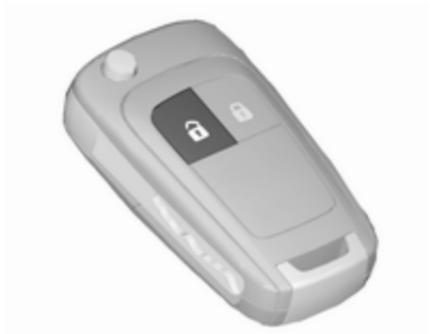
Bei ausgeschalteter Zündung drücken. Die Hecktür wird freigegeben und kann durch Drücken des Touchpad-Schalters unterhalb des Griffs entriegelt und geöffnet werden.
