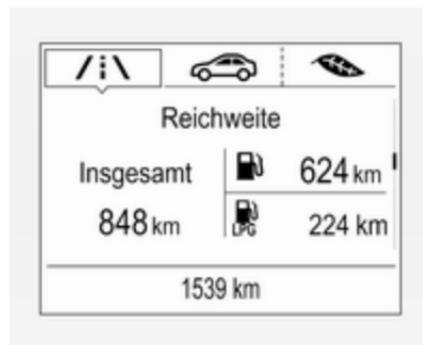
Anzeige der ungefähren Kraftstoffreichweite für jeden Kraftstofftank (LPG, CNG und Benzin). Ein niedriger Kraftstoffstand in einem beliebigen Tank wird durch **Niedrig** im entsprechenden Bereich angezeigt.
