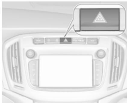
Wird durch Drücken von
