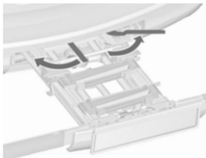
Die beiden Spannhebel so weit wie möglich zur Seite schwenken. Andernfalls ist die sichere Funktion nicht garantiert.
