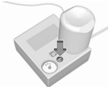
Wird der vorgeschriebene Reifendruck nicht innerhalb von zehn Minuten erreicht, das Reifenreparaturset entfernen. Das Fahrzeug um eine Reifenumdrehung bewegen. Das Reifenreparaturset
