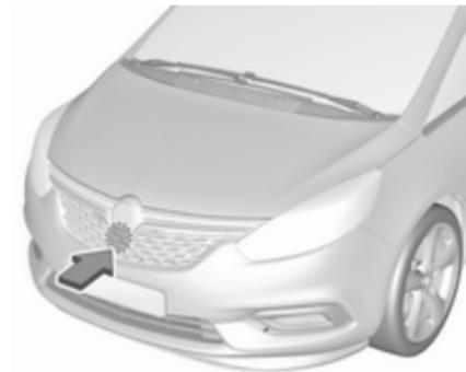
Das Radargerät ist hinter dem Kühlergrill unterhalb des Markenemblems montiert.
