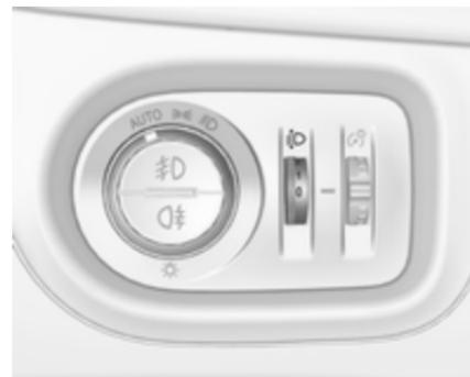
Zur Anpassung der Leuchtweite an die Fahrzeugbeladung, um Blendwirkung zu reduzieren: Daumenrad
