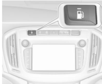
Durch Drücken von
