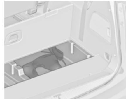
Bei Fahrzeugen ohne dritte Sitzreihe befinden sich unter der Bodenabdeckung Staufächer. Zum Öffnen die Abdeckung anheben.
