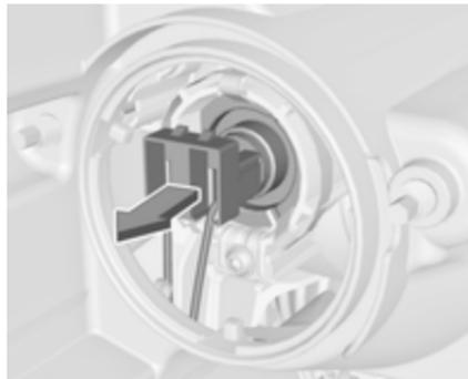
2. Die Lampenfassung aus dem Reflektorgehäuse ziehen.
