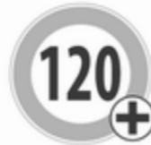
Zudem werden in der unteren Zeile des Driver Information Centers permanent die aktuell gültigen Geschwindigkeitsbegrenzungen angezeigt. Wenn eine Geschwindigkeitsbegrenzung mit Add-on verfügbar ist, wird in diesem Gebiet ein + Symbol angezeigt.
