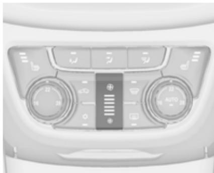
Die untere Taste drücken, um die Gebläsedrehzahl zu reduzieren. Die obere Taste drücken, um die Gebläsedrehzahl zu erhöhen. Die Gebläsegeschwindigkeit ist anhand der Anzahl der Segmente auf dem Display erkennbar.
