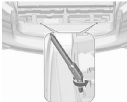
3. Radschlüssel auf eine Sechskantschraube aufsetzen und links herum drehen, bis ein Widerstand bemerkbar ist.
