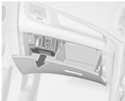
In Rechtslenkern befindet sich der Sicherungskasten hinter einer Abdeckung im Handschuhfach. Das Handschuhfach öffnen, dann die Abdeckung öffnen und nach unten klap-
