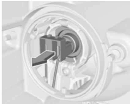
2. Die Lampenfassung aus dem Reflektorgehäuse ziehen.
