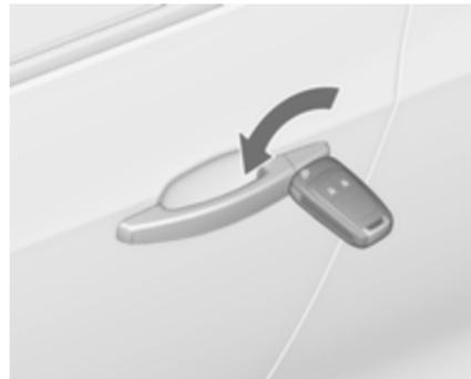
Die Fahrtür durch Drehen des Schlüssels im Schloss von Hand entriegeln. Zündung einschalten und drücken, um alle Türen, Laderaum und Tankklappe zu entriegeln. Durch Einschalten der Zündung wird die Diebstahlsicherung deaktiviert.
