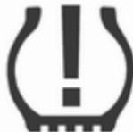
60 bis 90 Sekunden lang blinkt und dann mit Dauerlicht aufleuchtet, liegt ein Fehler im System vor. Hilfe einer Werkstatt in Anspruch nehmen.
