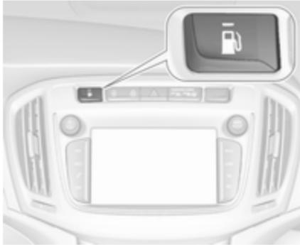
Durch Drücken von
