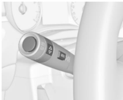
Das Menü über die Tasten am Blinkerhebel auswählen.
