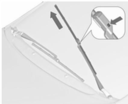
Wischerarm anheben, bis er von selbst steht, Taste zum Lösen des Wischerblattes drücken und Wischerblatt abnehmen.
