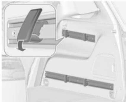
Den Haken in gewünschte Position zuerst in der oberen Nut der Schiene einsetzen und dann in die untere Nut hineindrücken. Zum Entfernen zuerst aus der oberen Nut herausziehen.
