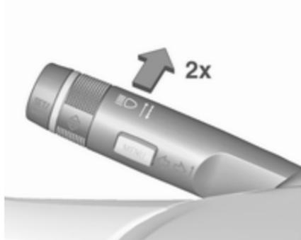
Der Fernlichtassistent wird aktiviert, wenn bei einer Geschwindigkeit über 40 km/h zweimal der Blinkerhebel gedrückt wird.
