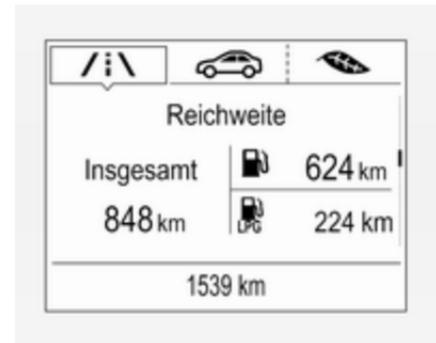
Anzeige der ungefähren Kraftstoffreichweite für jeden Kraftstofftank (LPG, CNG und Benzin). Ein niedriger Kraftstoffstand in einem beliebigen Tank wird durch **Niedrig** im entsprechenden Bereich angezeigt.
