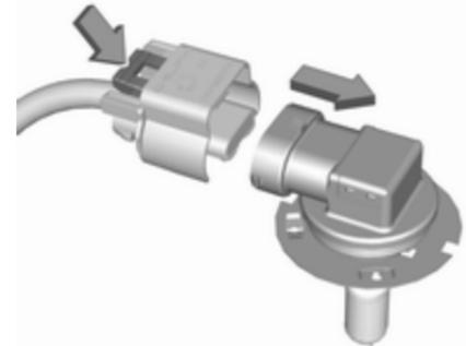
3. Die Lampenfassung durch Drücken der Haltenase vom Stecker lösen.
