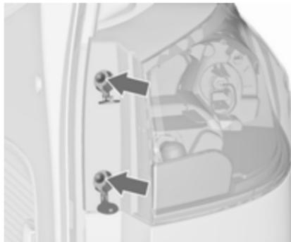
2. Die mit Pfeilen gekennzeichneten Schrauben entfernen.
