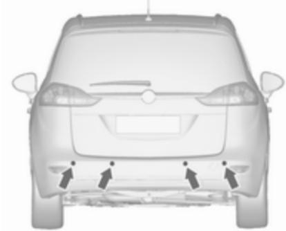
Das System besteht aus jeweils vier Ultraschall-Parksensoren im vorderen und hinteren Stoßfänger.
