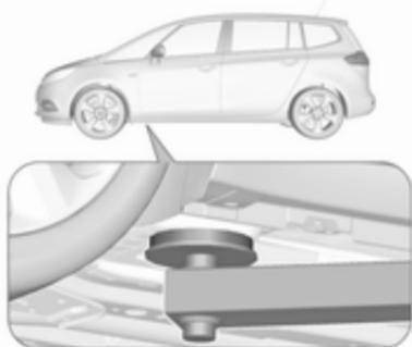
Position des vorderen Arms der Hebebühne am Unterboden.
