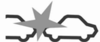
Wenn der Abstand zu einem vorausfahrenden Fahrzeug zu gering wird oder Sie sich einem anderen Fahrzeug zu schnell nähern, wird im Driver Information Center das Kollisionssymbol angezeigt und es erklingt ein Warnton. Betätigen Sie das Bremspedal, wenn es die Situation erfordert.
