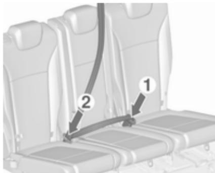
Die untere Gurtzunge von der Sicherung abnehmen und in das linke Gurtschloss (1) des mittleren Sitzes einrasten. Die obere Gurtzunge mit dem Gurt über den Beckenbereich und die Schulter führen (Gurt dabei nicht verdrehen) und in das rechte Gurtschloss (2) des mittleren Sitzes einrasten.
