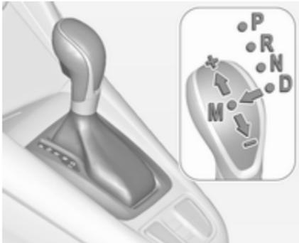
**P** : Parkstellung, Räder sind blockiert; nur bei stillstehendem Fahrzeug und betätigter Parkbremse einlegen
