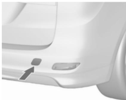
Mit einem Schraubendreher in den Schlitz an der unteren Kante der Abdeckung fahren. Abdeckung durch vorsichtiges Abwärtsbewegen des Schraubendrehers lösen. Um Schäden zu vermeiden, wird empfohlen, ein Tuch zwischen Schraubendreher und Rahmen zu legen.
