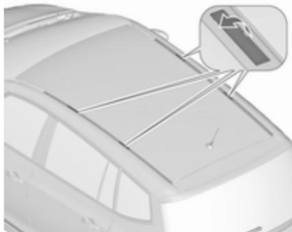
Zur Befestigung eines Dachgepäckträgers die Kappen in den Dachleisten öffnen. Die Befestigungsvorrichtungen nach Anweisung in die in der Abbildung dargestellte Halterung einführen.
