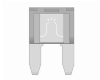
Je nach Ausführung lässt sich eine durchgebrannte Sicherung anhand des geschmolzenen Drahtes erkennen. Sicherung nur dann ersetzen, wenn die Ursache für die Störung behoben wurde.
