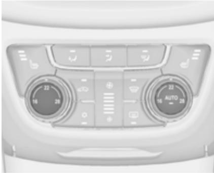
Ist die Mindesttemperatur **Lo** eingestellt, läuft die Klimaanlage mit maximaler Kühlung, sofern die Kühlung
