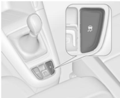
Die Traktionskontrolle kann ausgeschaltet werden, wenn ein Durchdrehen der Antriebsräder erwünscht ist:
