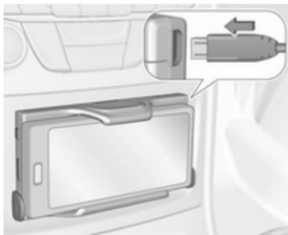
Συνδέστε το smartphone στη βάση τηλεφώνου χρησιμοποιώντας το συμβατό καλώδιο σύνδεσης. Υπάρχουν διαθέσιμες διάφορες εκδόσεις του καλωδίου σύνδεσης.
