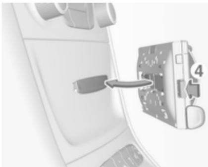
2. Συνδέστε τη βάση τηλεφώνου στην ηλεκτρική σύνδεση και πιέστε και τα δύο ασφαλιζόμενα κινούμενα τμήματα (4), για να ασφαλιστούν.
