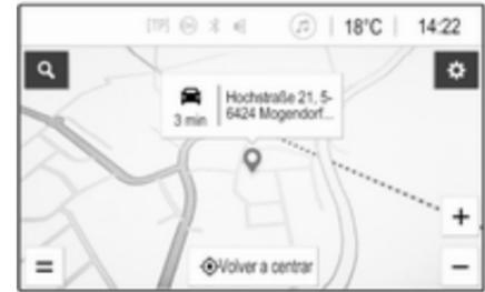
Para volver a la ubicación actual, seleccione **Volver a centrar** en la parte inferior de la pantalla.
