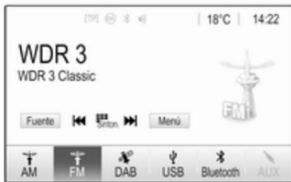
Para cambiar a otro modo de audio: toque uno de los elementos en la barra de selección de interacción.
