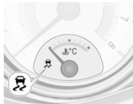
El ESC está operativo cada vez que arranca el motor en cuanto se apaga el testigo de control
