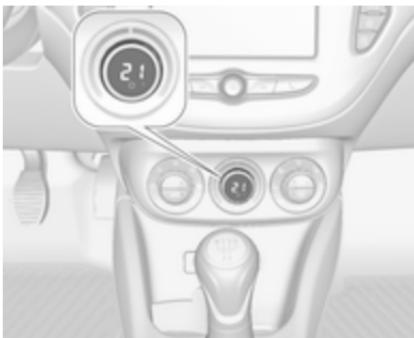
Si se ajusta la temperatura mínima **Lo**, el climatizador automático funciona a la máxima potencia de refrigeración siempre que se conecte la refrigeración
