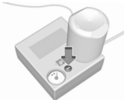
Vacie el exceso de presión de los neumáticos mediante el botón situado encima del indicador de presión.
