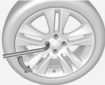
2. Inserte completamente la llave para tornillos de rueda y afloje cada tornillo media vuelta.
