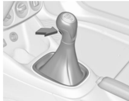
Para engranar la marcha atrás, pise el pedal de embrague, pulse el botón de desbloqueo de la palanca selectora y engrane la marcha.
