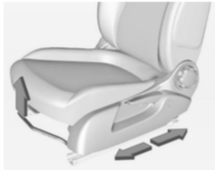
Tire del asidero, deslice el asiento, suelte el asidero. Intente mover el asiento hacia delante y hacia atrás para asegurarse de que el asiento está bloqueado en su posición.
