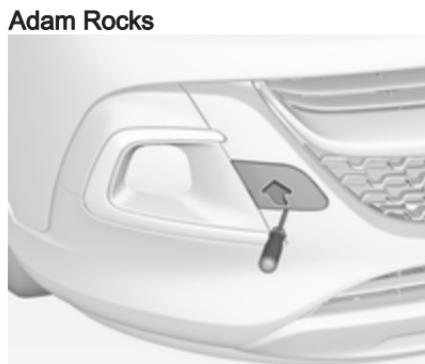
1. Envuelva un trapo alrededor de la punta de un destornillador plano para evitar dañar la pintura. Desenganche el tapón pequeño con el destornillador en la posición marcada.
