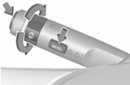
Pulse **MENU** para cambiar entre menús o para volver de un submenú al siguiente nivel superior del menú.
