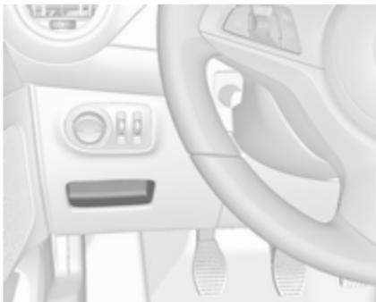
Hay compartimentos portaobjetos situados debajo del interruptor de las luces, en la consola central delante de la palanca selectora, en los bolsillos de las puertas y en los paneles laterales junto a los asientos traseros.
