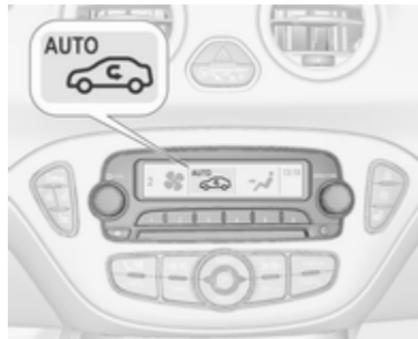
Los ajustes de climatización se muestran en la pantalla de información. Las modificaciones de los ajustes aparecen brevemente, sobre el menú mostrado en ese momento.
