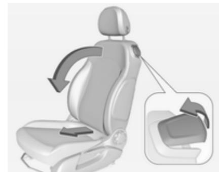
Tire de la palanca de desbloqueo hacia delante e incline el respaldo hacia delante. Luego deslice el asiento hacia delante hasta el tope.
