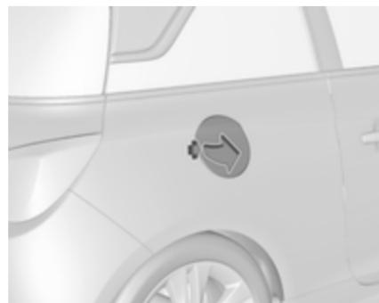
La tapa del depósito de combustible sólo se puede abrir con el vehículo desbloqueado.
