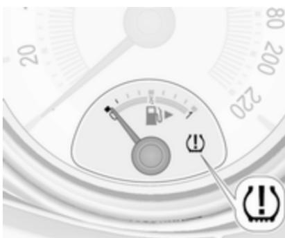
Si se detecta un problema de presión baja de los neumáticos, se indica mediante el testigo de control
