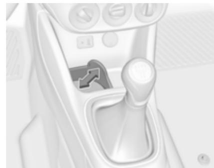
Hay una correa de goma flexible situada en el compartimento portaobjetos situado delante de la palanca selectora. Tire de la correa para sujetar un vaso o un cenicero.
