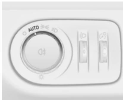
Cuando está conectada la función de control automático de las luces y el motor está en marcha, el sistema cambia entre luz de circulación diurna y conexión automática de los faros, dependiendo de las condiciones luminosas y de la información proporcionada por el sistema del sensor de lluvia.
