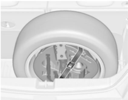
9. Coloque la caja de herramientas en el interior de la rueda y fíjela con la correa 2 insertada a través de dos radios de la rueda.
