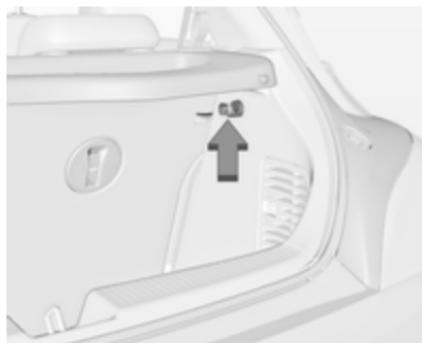
Utilice el gancho en la pared lateral derecha del compartimento de carga para colgar bolsas. Carga máxima: 5 kg.
