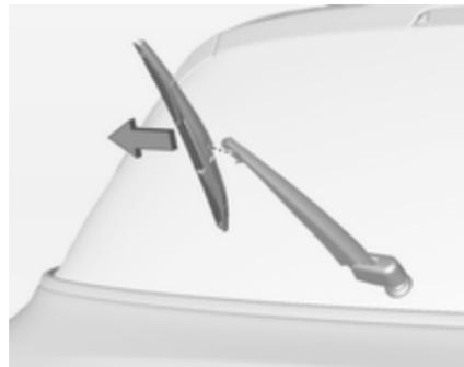
Levante el brazo del limpiaventanilla. Desacople la escobilla como se muestra en la ilustración y desmóntela.
