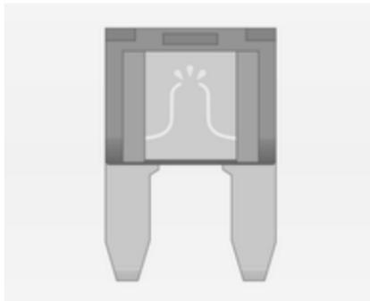
Dependiendo del tipo de fusible, un fusible defectuoso puede reconocerse por su filamento fundido. No sustituya el fusible hasta que se subsane la causa de la avería.
