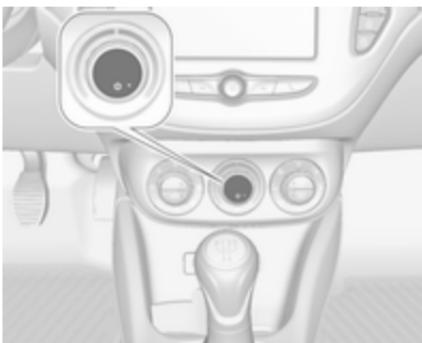
Pulse ☀ para activar la refrigeración. El LED del botón se ilumina para indicar su activación. La refrigeración sólo funciona con el motor en marcha y el ventilador de climatización conectado.
