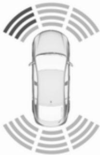
La distancia hasta los obstáculos se muestra en la pantalla de información en color mediante zonas de colores delante y detrás del vehículo  $\diamond 88$ .
