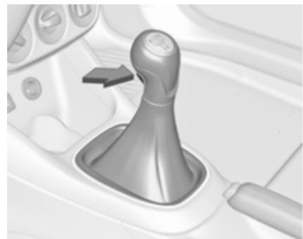
Marcha atrás: con el vehículo parado, pise el pedal de embrague y pulse el botón de desbloqueo de la palanca selectora y engrane la marcha.
