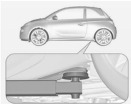
Posición del brazo trasero de la plataforma elevadora, ubicado centrado bajo el rebaje del estribo.
