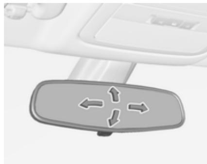
Para ajustar el espejo, mueva la carcasa del espejo en la dirección deseada.
