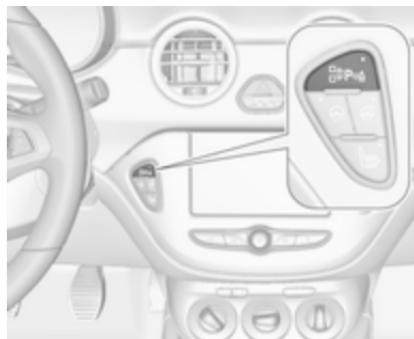
El asistente de aparcamiento delantero y trasero y el asistente de aparcamiento avanzado usan ambos el mismo botón para su activación y desactivación:
