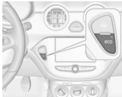
Desactive manualmente el sistema stop-start pulsando **eco**. Para indicar la desactivación, se apaga el LED del botón.
