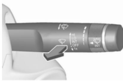
Tire de la palanca. Se pulveriza líquido de lavado sobre el parabrisas y el limpialuneta se realiza el barrido varias veces.
