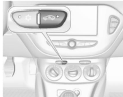
Pulse 🚗 para activar el modo de recirculación de aire. El LED del botón se ilumina para indicar su activación.
