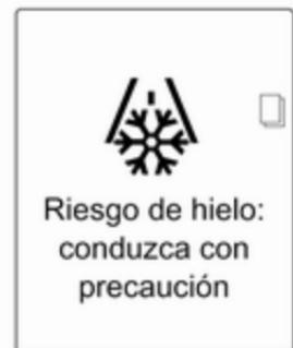
Si la temperatura exterior desciende a 3 °C, aparece un mensaje de advertencia en el centro de información del conductor.
