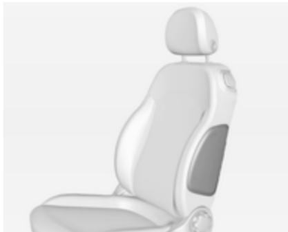
El sistema de airbags laterales se compone de un airbag en cada respaldo de los asientos delanteros. La ubicación se puede identificar por el rótulo **AIRBAG**.
