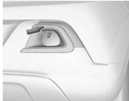
1. Extraiga la cubierta tirando con la mano en la posición marcada, consulte la flecha de la ilustración.
