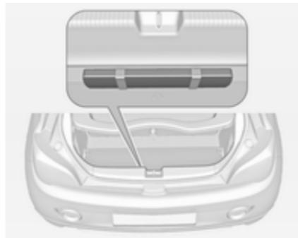
El triángulo de advertencia se guarda con correas elásticas en el compartimento de carga, debajo del portón trasero.
