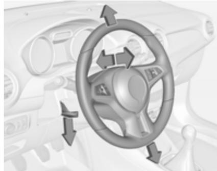
Desbloquee la palanca, ajuste el volante, luego enclave la palanca y asegúrese de que esté totalmente bloqueada.
