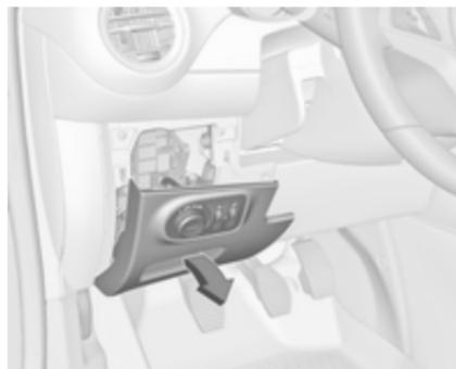
La caja de fusibles está detrás del conmutador de las luces en el tablero de instrumentos.
