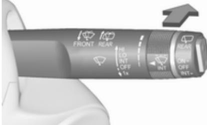
Presione la palanca. Se pulveriza líquido de lavado sobre la luneta trasera y el limpialuneta se realiza el barrido varias veces.
