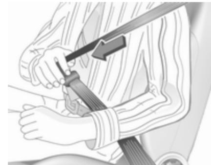
Extraiga el cinturón del retractor, guíelo por encima del cuerpo sin retorcerlo e inserte la lengüeta en el cierre. Durante el viaje, tense frecuentemente el cinturón abdominal tirando suavemente de la banda torácica.
