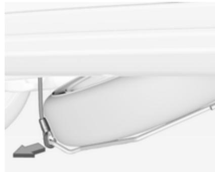
6. Levante un poco el soporte de la rueda de repuesto con la mano y suelte el cable de seguridad.
