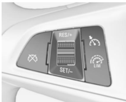
Pulse . Si el regulador de velocidad se han activado con anterioridad, se apagarán al activarse el limitador de velocidad y cuando el testigo de control se apague.
