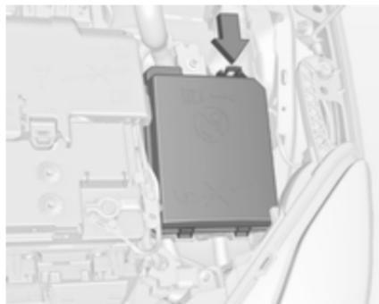
La caja de fusibles está ubicada en la parte delantera izquierda del compartimento del motor.
