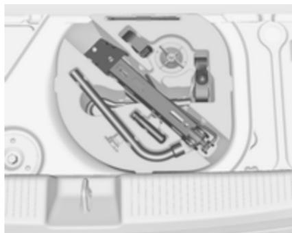
El gato, la llave para tornillos de rueda, las herramientas y dos correas para asegurar una rueda pinchada están en la caja de herramientas, debajo de la cubierta del piso del compartimento de carga  $\diamond 57$ .
