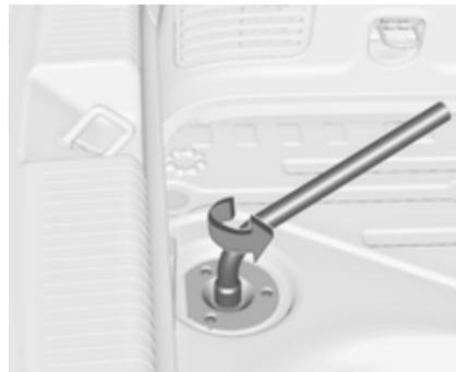
3. Fije la llave para ruedas al tornillo hexagonal junto a la caja de herramientas y gírela en sentido antihorario hasta percibir una resistencia.
