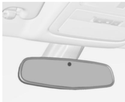
Al conducir de noche, se reduce automáticamente el deslumbramiento de los vehículos de delante.
