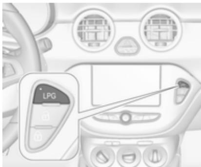
Pulsando **LPG**, el sistema cambia entre funcionamiento con gasolina y con gas licuado en cuanto se hayan
