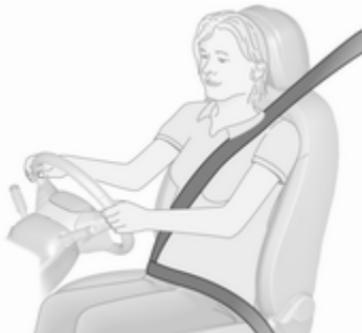
Extraiga el cinturón de seguridad y abroche en el cierre. El cinturón de seguridad no debe estar retorcido y debe quedar bien ajustado al cuerpo. El respaldo no debe estar demasiado inclinado hacia atrás (máximo aprox. 25°).
