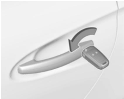
Desbloquee manualmente la puerta del conductor girando la llave en la cerradura. Conecte el encendido y
