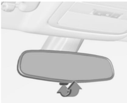
Para reducir el deslumbramiento, ajuste la palanca de la parte inferior de la carcasa del espejo retrovisor hacia delante o hacia atrás. La palanca en la posición intermedia es la posición de conducción normal.
