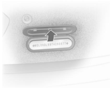
El número de identificación del vehículo está estampado en la placa de características y en el panel del piso, debajo de la cubierta del piso, visible bajo una tapa.
