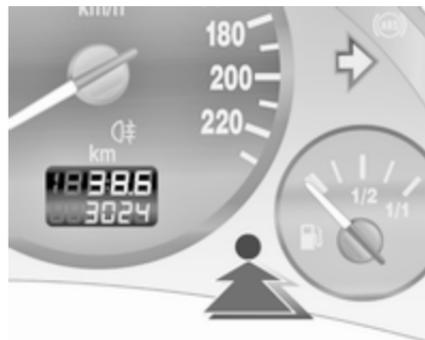
Con el encendido desconectado, pulse brevemente el botón de reinicio y se mostrará el número de kilómetros durante unos 15 segundos.
