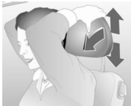
Inclínelo hacia delante para desbloquearlo, sujételo, ajuste la altura y vuelva a soltarlo.
