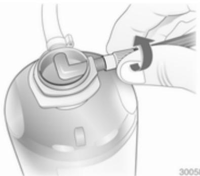
4. Enrosque el tubo flexible del compresor a la conexión del bote de sellador.
