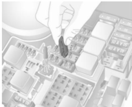
Un fusible defectuoso puede reconocerse porque el hilo está fundido. No sustituya el fusible hasta que se subsane la causa de la avería.
