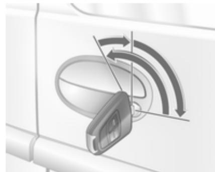
Gire la llave en sentido antihorario más allá del punto de resistencia desde la posición vertical u horizontal, respectivamente, y tire de la manilla de la puerta trasera. Para evitar que el vehículo pueda bloquearse con la llave dentro, la llave no se puede sacar de esta posición.
