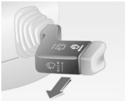
Tire de la palanca. Se pulveriza líquido de lavado sobre el parabrisas y el limpiaventana se realiza el barrido varias veces.
