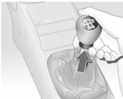
Marcha atrás: con el vehículo parado, espere 3 segundos después de pisar el pedal del embrague, luego levante la anilla debajo de la palanca selectora y engrane la marcha.
