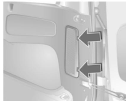
1. Desenclave la tapa presionando las lengüetas de sujeción y desmóntela.
