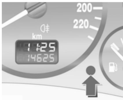
Para ponerlo a cero, pulse el botón con el encendido conectado y el cuentakilómetros parcial activado; mantenga pulsado el botón durante más de 2 segundos.
