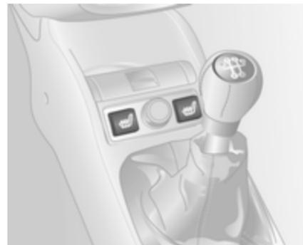
Con el encendido conectado, pulse el botón
