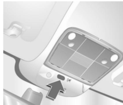
Desactive la vigilancia del habitáculo y de la inclinación del vehículo cuando se queden animales en el vehículo, debido al elevado volumen de señales ultrasónicas y a que los movimientos dispararán la alarma. Desconéctela también si el vehículo va en un ferry o un tren y si la temperatura en el interior del vehículo estacionado puede ser alta.
