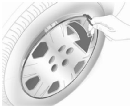
En algunas versiones, el tapacubos se desmonta junto con los tornillos de rueda.
