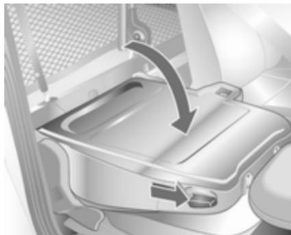
Para ampliar el compartimento de carga se puede girar hacia adelante la parte de la rejilla del lado del acompañante.
