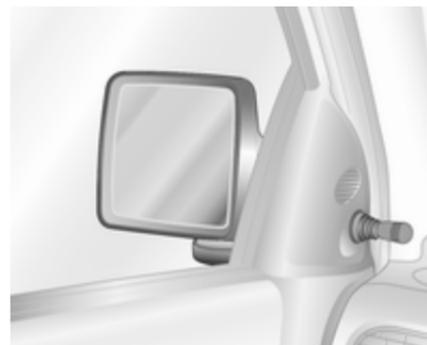
Ajuste los retrovisores basculando la palanca en la dirección deseada.
