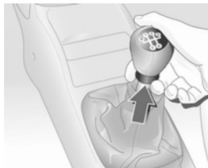
Para engranar la marcha atrás: con el vehículo parado, espere 3 segundos después de pisar el pedal de embrague, apriete el botón de la palanca selectora y engrane la marcha.
