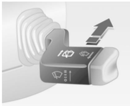
Presione la palanca hacia delante. El limpiaventana funciona a intervalos. Desconéctelo tirando de la palanca.
