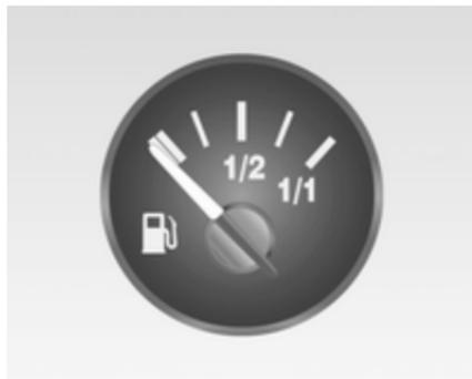
Según el modo de funcionamiento, el instrumento indicador muestra la presión del depósito o el nivel de llenado de gasolina.
