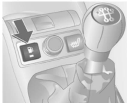
Pulsando el botón
