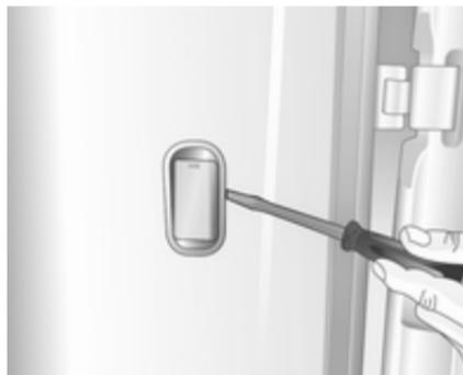
1. Extraiga la lámpara haciendo palanca con un destornillador.
