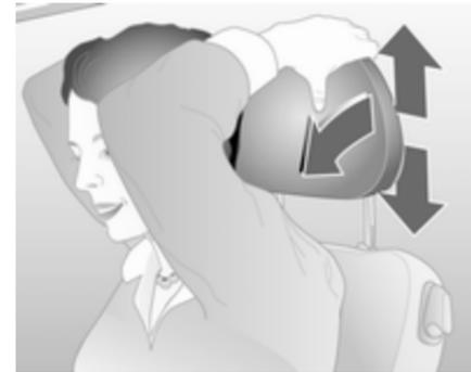
Para ajustarlo, coger el apoyacabezas por los lados, inclinarlo hacia delante, sujetarlo y ajustar la altura.
