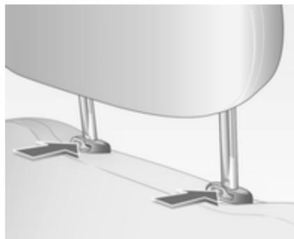
Desbloquear los dos resortes de retención presionándolos y extraer el apoyacabezas. El reposacabezas central trasero no se puede desmontar.
