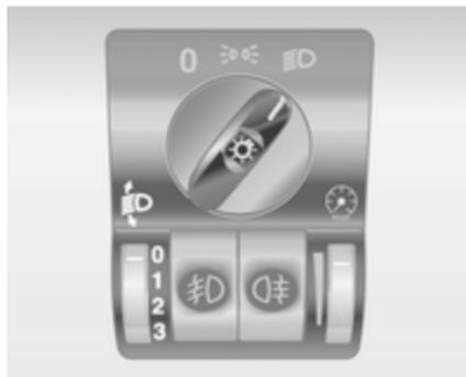
Con la luz de cruce encendida, adaptar el alcance de los faros según la carga del vehículo para evitar el deslumbramiento: girar la rueda moleteada hasta la posición deseada.
