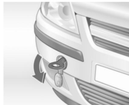
Fije un cable de remolque –o mejor una barra de remolque– a la argolla.
