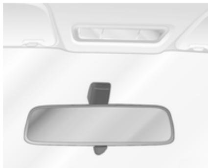
Bascule la palanca en la parte inferior para reducir el deslumbramiento.
