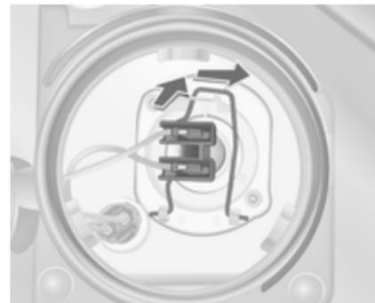
3. Desenclave el clip elástico de la sujeción moviéndolo hacia delante y girándolo a un lado.
