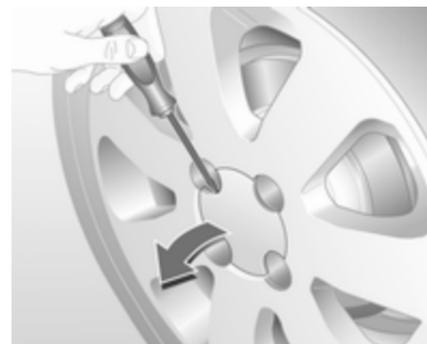
Llantas de aleación con seguro antirrobo: desenrosque el tapón del tornillo de rueda con la llave de seguridad y desmóntelo. Herramientas del vehículo ↻ 128.
