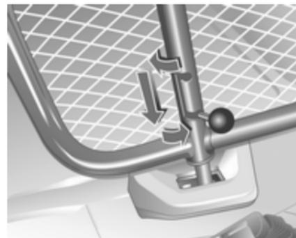
Bloquee la rejilla del compartimento de carga en su alojamiento. Para ello, enclave la palanca en la posición inferior.
